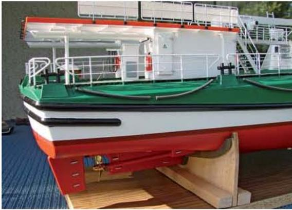
Ein Blick unter das fertige Boot zeigt mit den Opferanoden Liebe zum Detail
