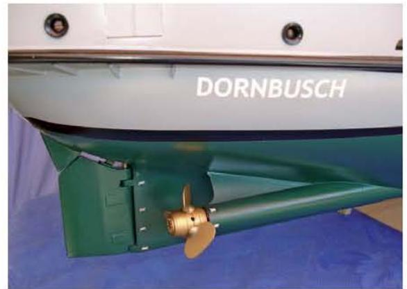
▲ Die konischen Stevenrohre mit den Stützen. Das Ruder ist aus Plexiglas gefertigt, wird aus Sicherheitsgründen aber direkt mit einer Welle angetrieben und nicht mit dem Ruderarm
