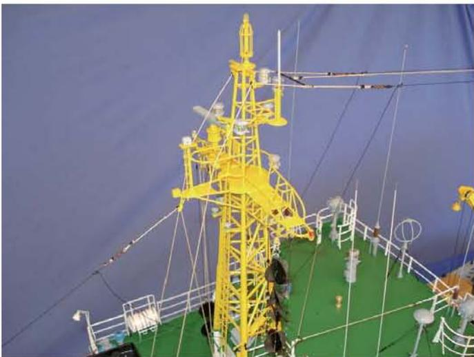
▲ Die abnehmbaren Langdrahtantennen werden mit Hutgummi gespannt, der in der Seilführung eingearbeitet ist. Die Spannseile bestehen aus Garn, die Antennendrähte aus Seidenschnur. Verbunden wird beides mit Isolatoren aus Messingdraht und Schmuckperlen. Die Lampenkörper wurden aus Plexiglas gedreht und mit Klarlack lackiert
