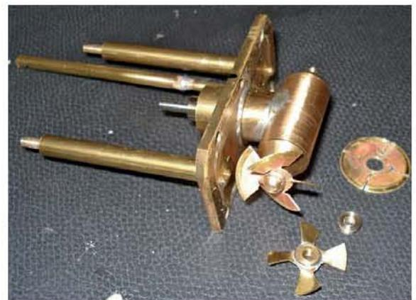
▲ Das Bugstrahlruder ist eine Eigenkonstruktion aus Messing, vierfach kugelgelagert und mit einer externen Schmiermöglichkeit durch ein 4-mm-Messingrohr versehen. Der Deckel wurde mit Silikon abgedichtet. Die erste Version der Propeller war wenig effektiv. Die zweite Version ist als Rohling und montiert zu sehen
