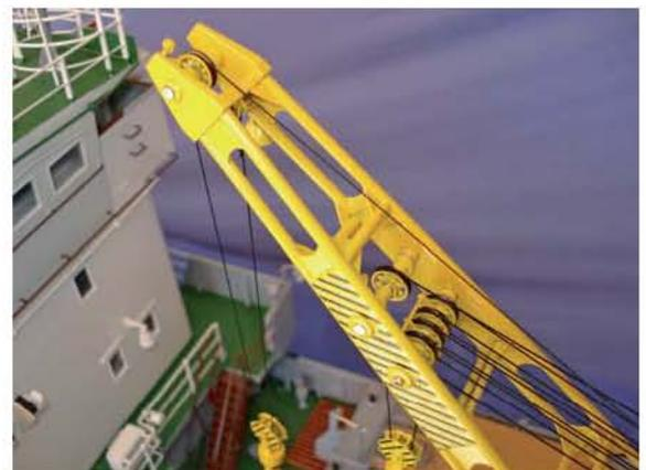
▲ Der Ausleger des Krans ist aus Messingmaterial zusammengelötet, da ohne ein gewisses Gewicht die Flaschenzüge nicht funktionieren. Daher auch das Ausgleichsgewicht. Die Drahtseile bestehen aus 0,5-mm-Seidenschnur. Sie wurde in Weichspüler eingelegt, gestreckt und getrocknet. Der Flaschenzug mit den vier losen Rollen funktioniert so problemlos
