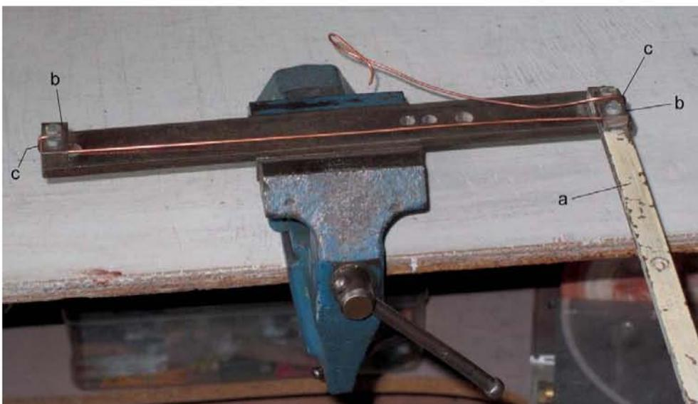
Foto 13: Hier wird ein Stück 1,3-mm-Kupferdraht streckgerichtet.
