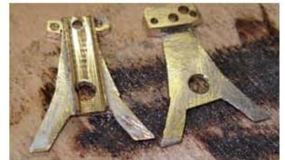
▲ Die ausgeschnittenen Seitenstützen mit allen Bohrungen
