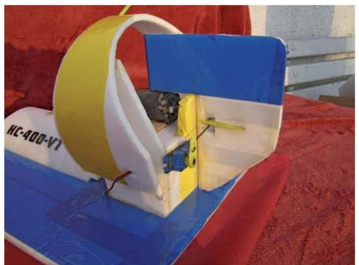
des Motors verkleben; das macht einen Motorwechsel viel einfacher. Den Propellerschutz vorformen, einstecken und mit Hilfe einer eingelegten Scheibe (Durchmesser 140 mm) ausrichten, anpassen und verkleben.
