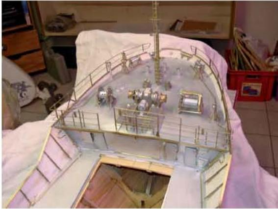
▲ Der Bugbereich mit dem Schanzkleid des Hauptdecks und dessen Stützen. Scheuerleisten aus Messingwinkeln decken die Oberkanten der Bordwände ab. Signalmast, Seilwinden, die Ankerwinde und Reling sind probeweise montiert. Die Winde für die Anker befindet sich hinter dem abnehmbaren Schott an der Back
