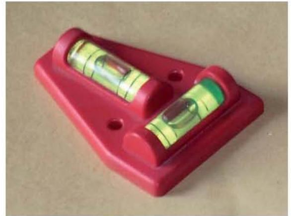
▲ Foto 17: Die „Kreuzlibelle“ könnte man an einer Halterung direkt am Spannhals der Handbohrmaschine befestigen
