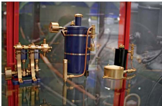
Micro Line: Dampfkessel und Gasheizung mit Dampfmaschine Lilly
