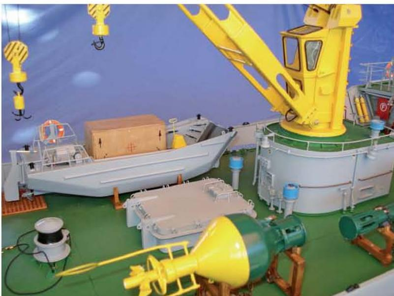
▲ Der Unterbau und das Kranführerhaus. Die Tonne und der Landungsprahm können mit dem Kran ausgesetzt werden. Die Ruder- und Motorfunktion des Landungsprahms sind ferngesteuert. In der Mitte sieht man die große Ladeluke, über die die Schalter der Elektronik zugänglich sind
