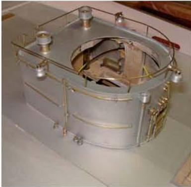
▲ Der Unterbau des Krans, in dem das selbstgefertigte Kugellager samt Antriebseinheit eingepasst wird – befestigt wird der Aufbau nebst Kran durch Gewindestangen, deren Befestigungsschrauben die beiden Lüfter sind
