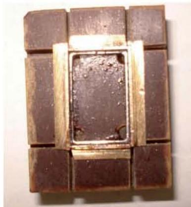
▲ Die Fensterrahmen bestehen aus 2x2-mm-T-Messingprofil mit einem eingelöteten Innenrahmen aus 0,5-mm-Messingdraht für die Fensterscheiben aus Projektor-Folie. Die Fensterrahmen werden mit Spachtelmasse in die Bordwände eingeklebt, um Maßungenauglichkeiten auszugleichen
