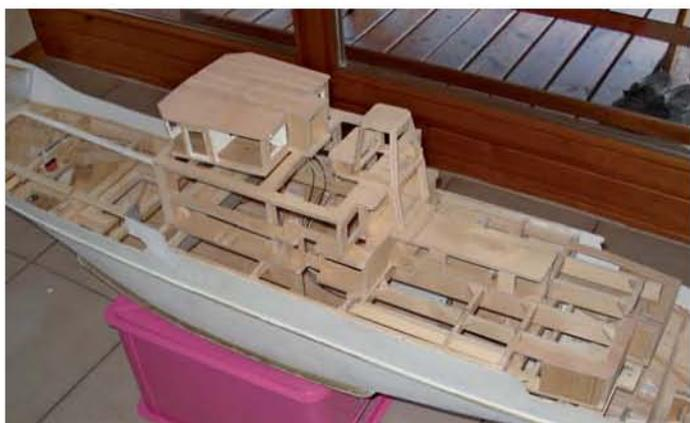
▲ Der Rohbau mit der Scheuerleiste aus 5-mm-Messingrohr und dem Schlingerkiel aus Messing mit der Verstärkung aus 1,5-mm-Draht. Die Schanzkleider des Haupt- und Backdecks und die des Oberdecks aus Alublech sind einlaminiert. Die Unterbauten des Poopdecks, des Kamins und des Deckhauses samt Brückenhaus sind wie die Spanten aus 6-mm-Sperrholz gefertigt
