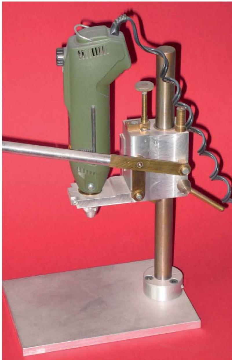
◀ Foto 18: Bohrtiefenan-schlag (höhenverstellbar), Bohrtiefenskala, einstellbare Schwalbenschwanzführung
