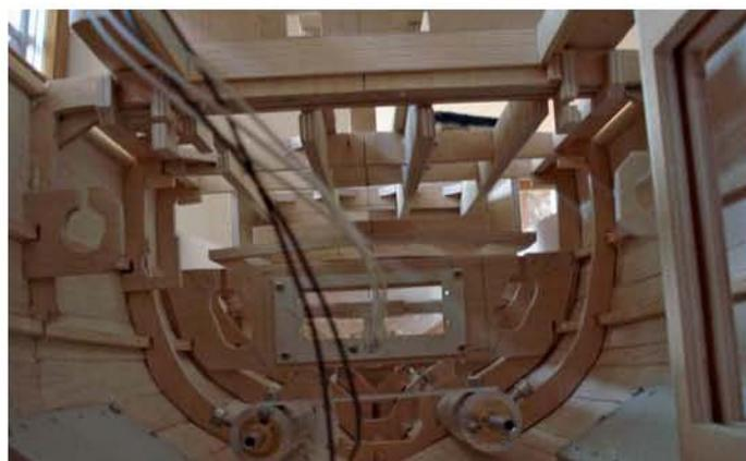
▲ Eine Ansicht an Bord: mittig die Alu-Halterung für die austauschbare Fernsteuerplatte, rechts und links die Motorfundamente und die 35 cm langen Stevenrohre aus konisch gedrehtem 30-mm-Alu. Die Wellen aus 6-mm-VA-Rohr sind zweifach kugelgelagert und mit Wellendichtringen abgedichtet. Die Führungen und Durchbrüche für die Kabel sind zu sehen wie auch die Halterung der Erweiterungsplatte der Fernsteuerung auf 32 Funktionen
