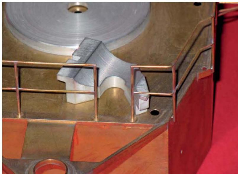
Foto 16: Hier sieht man, dass die Geländerstützen, die auf dem Deck stehen, runde Sockel haben. Für die nötige Genauigkeit habe ich sie mit dem Sockel aus einem Stück gedreht (4) S. 91–96.
