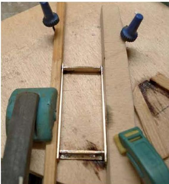
▲ Das Fundament der Winde aus Messing L- und U-Profilen wird mit Schablonen zusammengelötet
