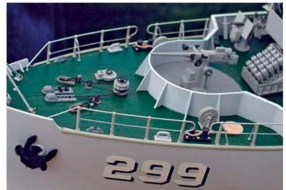
▲ Zwei Anker, doch nur ein Ankerspill – so sparte man an mechanischen Teilen
