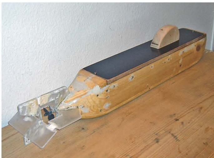
Der Rohbau (hier die XXL-Spook) mit den Rudern aus Makrolon
