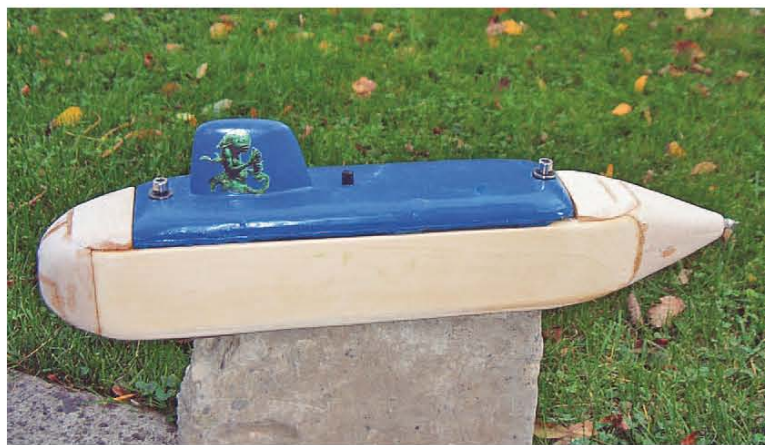
Hier sieht man einige Details (der Deckel stammt vom ersten Boot): Turm mit Harry-Potter-Fabelwesen, Verschraubungen aus Edelstahl sowie das Fahrradventil für den Überdruck. Die Welle ist noch nicht verklebt
