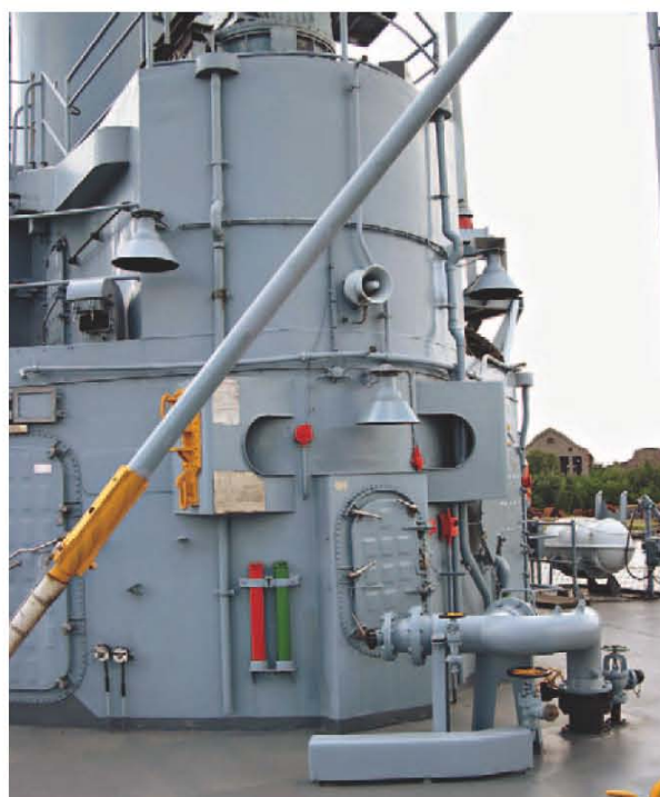
Rechts unten der massive Stutzen für die Treibstoffübernahme in See. Schräg im Bild eine Stütze für einen Übernahmepfosten (Treibstoff, Verpflegung, Munition, Verletzte usw.)
