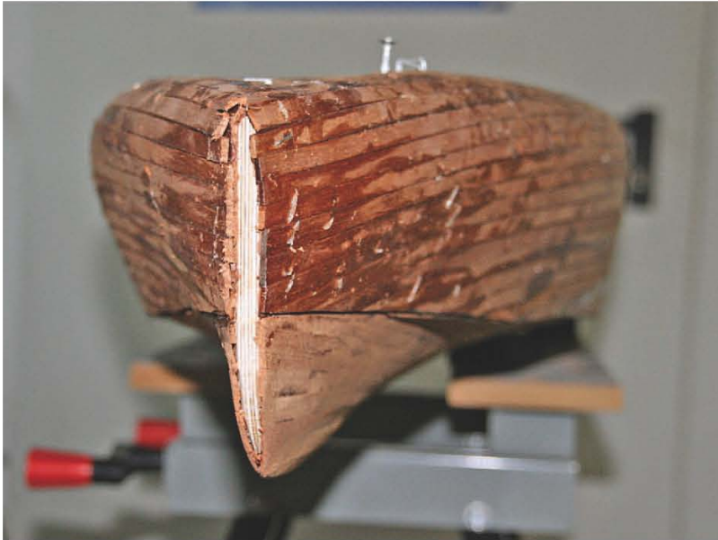
Auch die zweite Plankenschicht wird provisorisch aufgetackert
