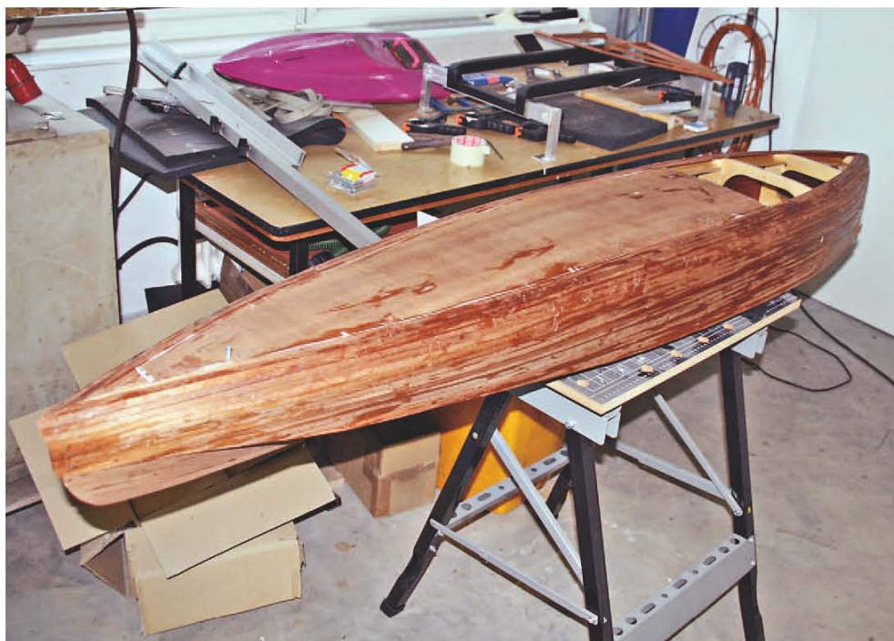
Die erste Plankenschicht ist aufgebracht
