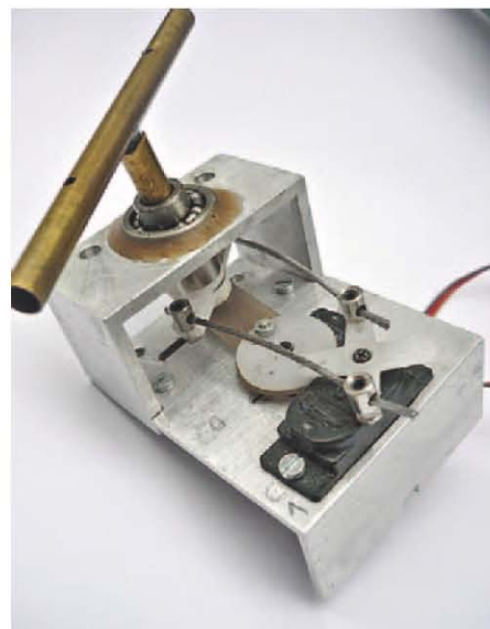
Hier kann man die verschiedenen Bewegungsmöglichkeiten erkennen; im unteren Rahmenteil ist der Führungsschlitz zu sehen
