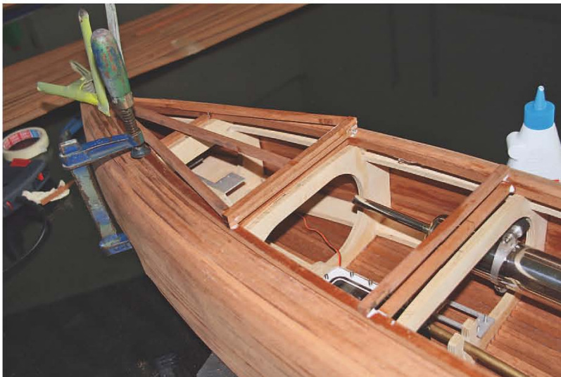
Mit Schraubzwingen wird die eine oder andere Planke in Form gehalten
