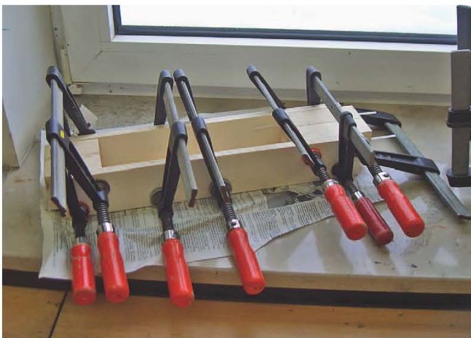
Beim Bau des Bootes sind viele Schraubzwingen hilfreich (aber vorsichtig, wegen des Balsaholzes)
