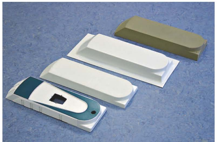
Das Foto zeigt deutlich den Werdegang des Bauteils (von oben nach unten): Tiefziehform, Rohteil, zugeschnittenes Rohteil und fertig lackiertes Bauteil mit Details
