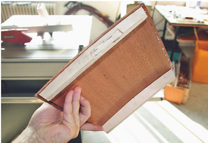
Ein Teil der Decksbeplankung erfolgt in einem Stück
