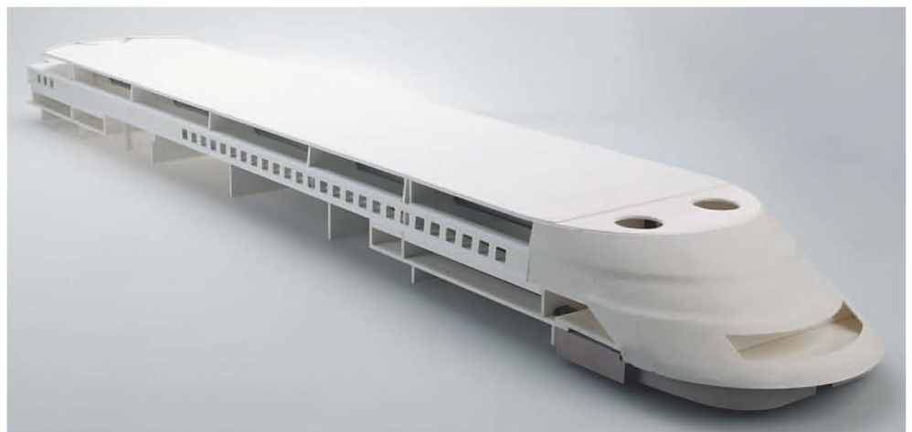
Das Oberteil wird ebenfalls von einem Spantengestell getragen
