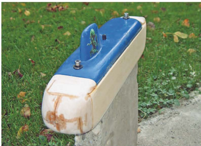
Der Rohbau mit dem Deckel eines vorherigen Modells. Runde Formen senken den Wasserwiderstand und sehen gut aus
