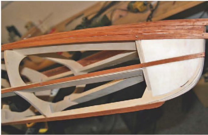
An den Rundungen müssen die Leisten angepresst und vorn zugespitzt werden; mit Zurrgurten hielt ich das Gerüst in Form
