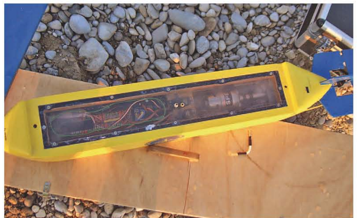
Ein Blick in den Innenraum – hier wurde ein extra Innendeckel aus Plexiglas mit Moosgummidichtung auf einem Rahmen eingesetzt
