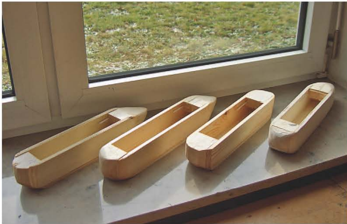
Rumpfhölzchen – rechts fast fertig bearbeitet. Teilweise wurden für die Seiten statt Balsabrettern Kiefern Bretter verwendet, was sich aber nicht bewährt hat
