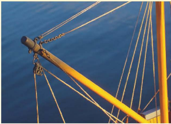
Der Ladebaum konnte bis auf Deckshöhe umgelegt werden
