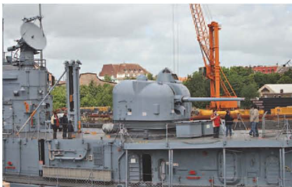
Das achterliche 127-mm-Geschütz, links daneben einer der Übernahmepfosten für die In-See-Versorgung, links oben einer der beiden Radarbeleuchter SPG-51c für die Lenkung der Tartar- und Harpoon-Raketen. Die Parabolspiegel sind übrigens nicht kreisrund, sondern leicht elliptisch; nur in der Schrägstellung (wie in meiner Zeichnung) bilden sie, waagrecht betrachtet, runde Kreise (Foto: Ernst Frey)
