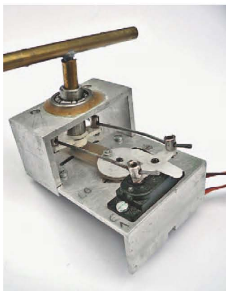
Die fertige Mechanik: vorn das Drehservo, dahinter das Kippservo
