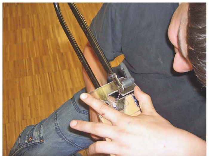
Aussagen der Ruder aus Makrolon oder Acrylglas mit der Laubsäge
