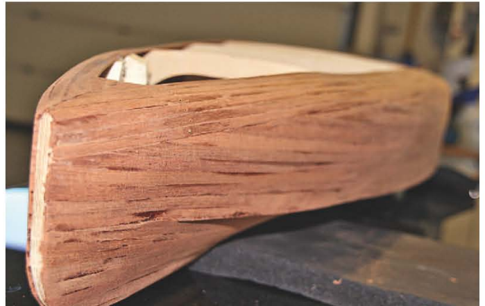
Die Beplankung macht Fortschritte
