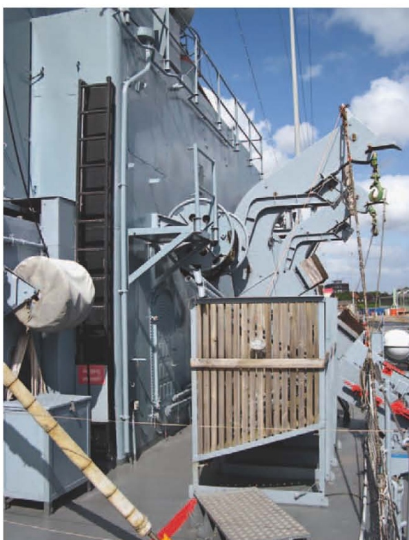
Das achterliche 127-mm-Geschütz, links daneben einer der Übernahmepfosten für die In-See-Versorgung, links oben einer der beiden Radarbeleuchter SPG-51c für die Lenkung der Tartar- und Harpoon-Raketen. Die Parabolspiegel sind übrigens nicht kreisrund, sondern leicht elliptisch; nur in der Schrägstellung (wie in meiner Zeichnung) bilden sie, waagrecht betrachtet, runde Kreise (Foto: Ernst Frey)
