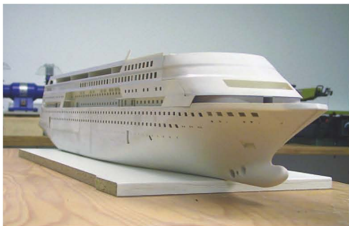
Rumpf mit aufgesetztem Oberteil. Die Teile sind zum Teil schon verspachtelt
