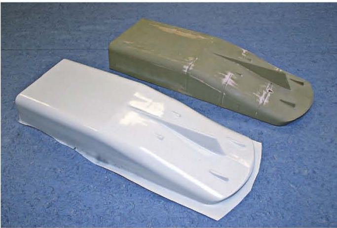
Die fertige Form und das Tiefziehteil des Rumpfhecks
