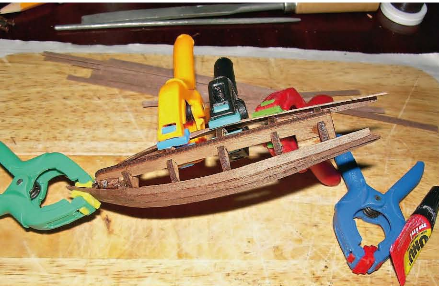
Die Anbringung der Beplankung; Klammern halten die Planken in der richtigen Position
