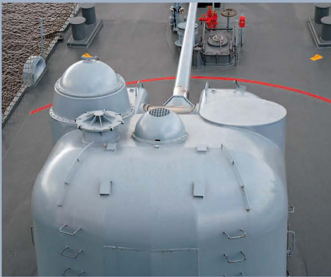
Bild 4: Blick von oben (Brücke) auf das Dach des Backgeschützes. Von der ehemaligen „Reusenantenne“ ist nur noch der Sockel übriggeblieben. Auf dem Deck ist der rote Sicherheitsring für den Schwenkbereich des Rohres aufgemalt (Foto: Jürgen Eichardt)
