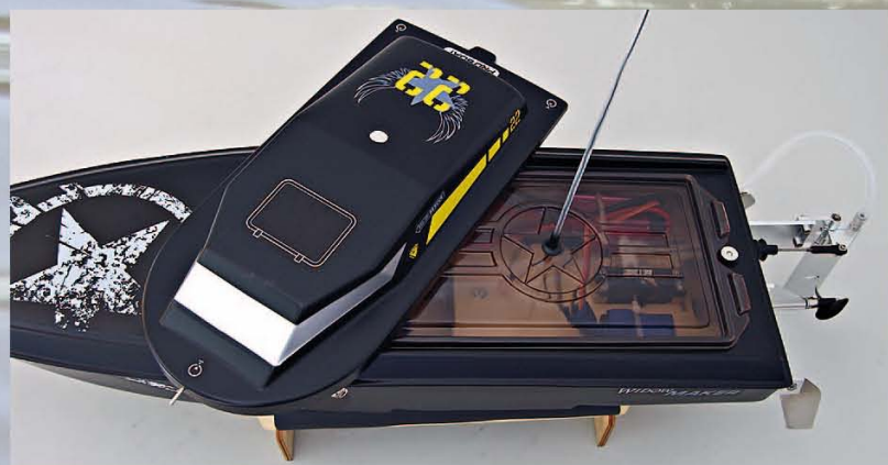
Unter der Haube befindet sich eine zusätzliche, spritzwasserdicht abschließende Abdeckung für die gesamte Rumpfoffnung
