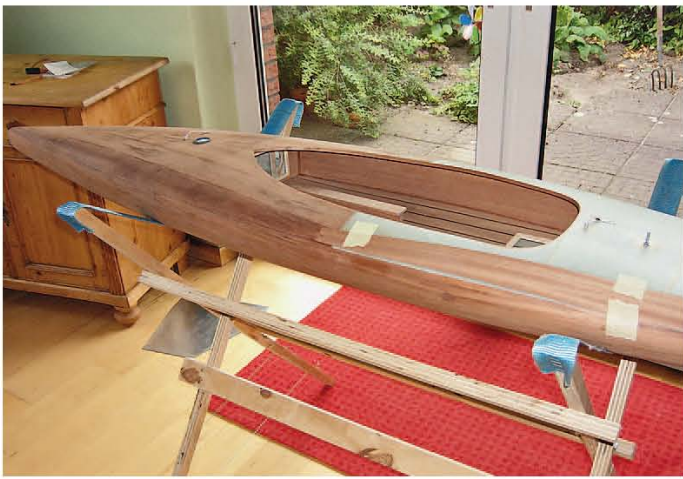
Im heimischen Esszimmer wird das Furnier aufgebracht
