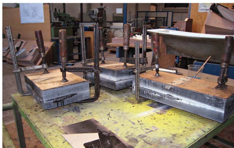
Die Formen werden mit Schraubzwingen fixiert
