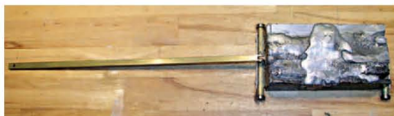
Der Schiebeschlitten des Bleigewichts mit Achsen und Justierstange. Bei einem Gesamtgewicht von über 20 kg ist es wirklich ratsamer, das Ballastgewicht entfernen und gesondert transportieren zu können
