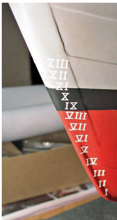
Wie manche andere Teile nicht im Baukasten enthalten: die Tiefgangsmarken
