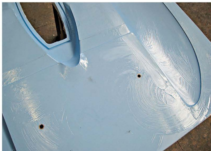
Deutlich ist das noch nicht auspolierte Trennwachs zu erkennen
