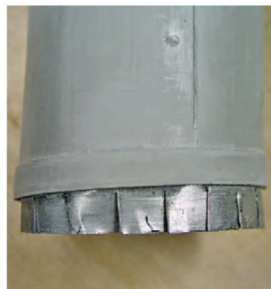
Das Aluminiumblech im Schornstein wird nach dem Aufsetzen umgeklappt und verklebt. Es dient der Stabilisierung
