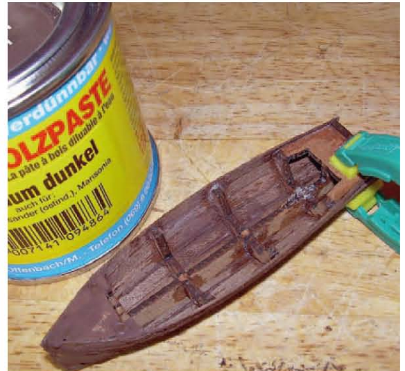
Kleine Spalten werden mit Holzpaste unsichtbar gemacht; nach dem Schleifen wird mit Nussbaum-Beize lackiert
