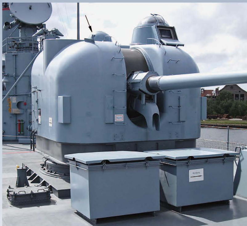
Bild1: Der achterliche 127-mm-Turm auf dem Museums-Zerstörer Mölders. Die Decks-luke links neben dem Waffenstand dient der Munitionsübernahme. In den kurzen Sockel dahinter wird dafür ein kleiner Ladekran gesteckt. Oben sieht man die Halte-rung (Pfeil) für das im Text erwähnte Wasserstrahlrohr (Foto: Jürgen Eichardt)
