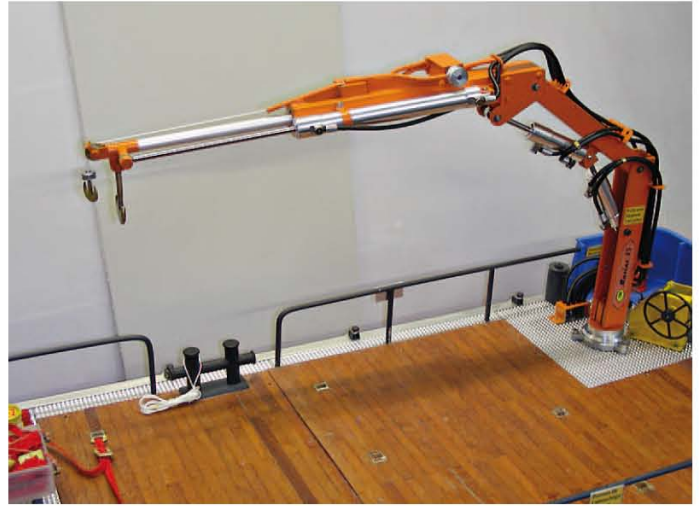
Der Schwenkbereich beträgt 200 Grad
