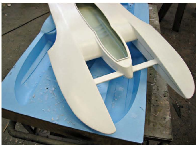
Der fertige besäumte CT06-Rumpf
