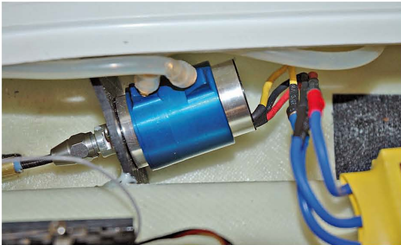
Die Aluminium-Kühlmäntel von MHZ sind blau eloxiert und lassen sich elegant mit zwei O-Ringen auf dem Motor befestigen
