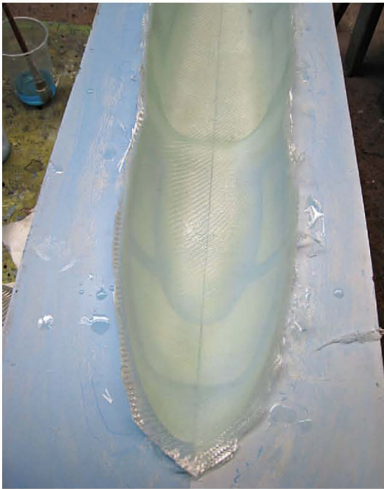
Auch beim Deckel ist es nötig, einige Kanten zu verrunden
