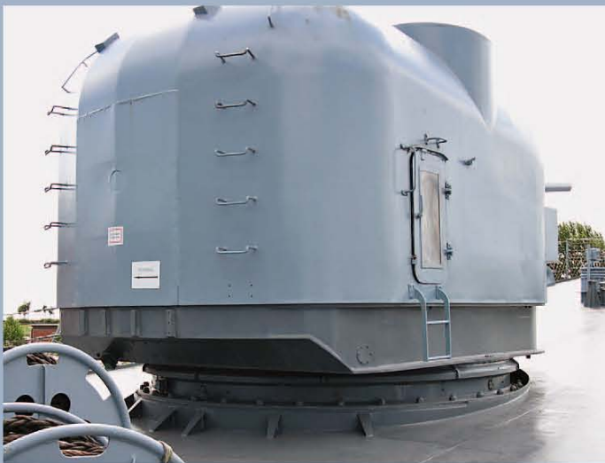
Bild 6: Sockelkonstruktion beim Backgeschütz der Mölders. Das Fenster in der Tür wurde nur für Museumszwecke eingebaut (Foto: Jürgen Eichardt)
