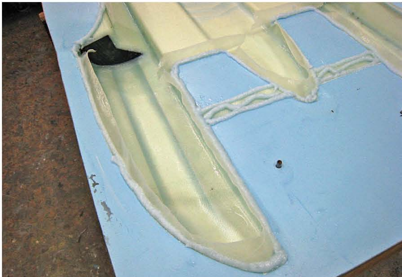
Die erste und die zweite Gewebelage wurden in die mit Harz eingestrichene Form gelegt, das Harz wird nun angetupft und das Gewebe mit der Walze entlüftet
