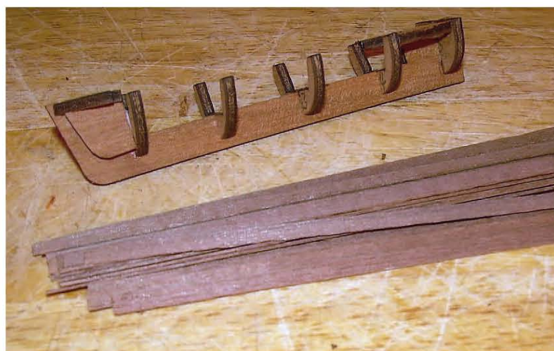
Auch der Dingi-Rumpf entsteht in der Spantenbauweise
