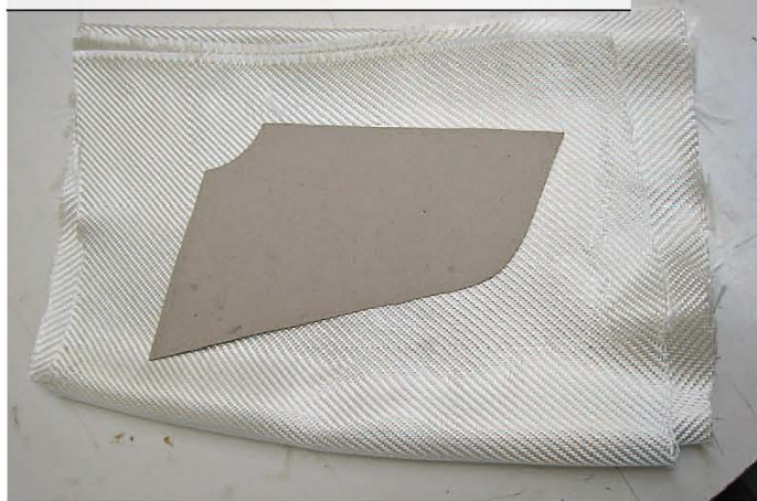
Schnittschablone der Gewebelagen für die Flügel
