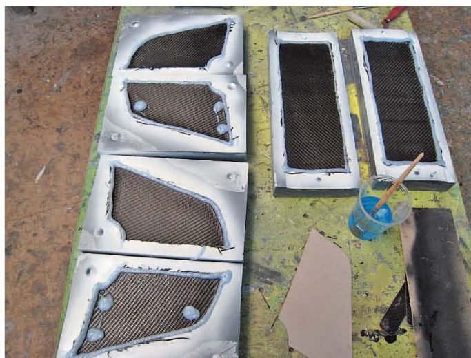
Vor dem Zusammenfügen der Formen wird auf die Schnittkanten ein spezielles angedicktes Harz aufgetragen
