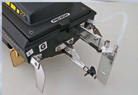
Antrieb und Ruderanlage sind für hohe Belastungen ausgelegt. Turnfins links und rechts unterstützen sowohl die Kurven- als auch die Geradeausfahrt
