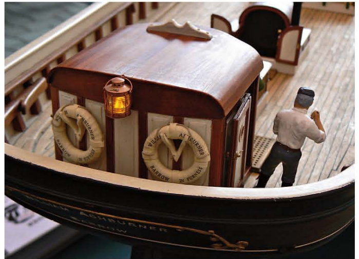
Das Hecklicht der William Ashburner flackert wie eine Petroleumlampe dank LED und Elektronik
