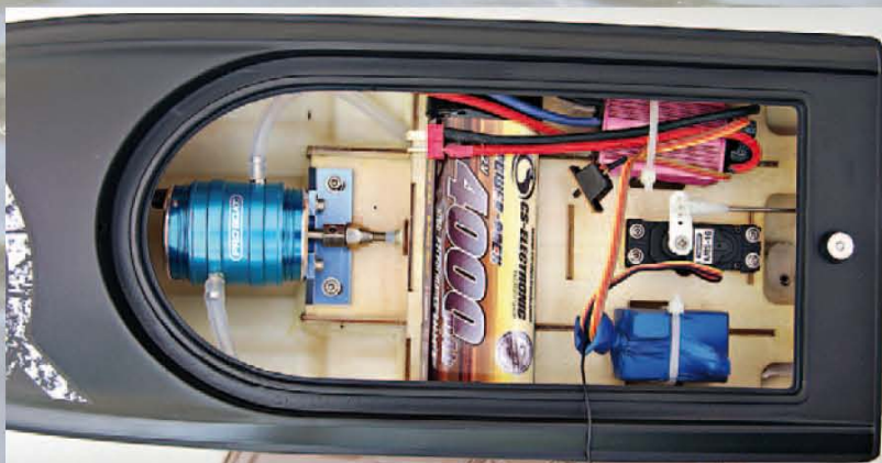
Das stabile Technikgerüst aus Sperrholz ist mit Lack wasserabweisend versiegelt. Auch Regler (vergossen) und Empfänger (Luftballon) sind vor Wasser geschützt
