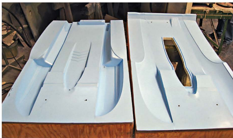
Die beiden Formen für den CT06-Hydroplane-Rumpf
