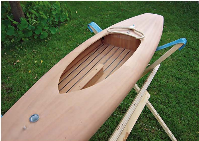
Der Rumpf, geschliffen und mehrfach grundiert
