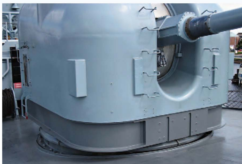
▲ Bild 3: Die unteren zweisprossigen Leitern sind beim Museumsschiff aus Sicherheitsgründen abgenommen. Das Foto lässt erkennen, wie der vordere Teil des Drehsockels beim Buggeschütz quasi in das Backdeck „versenkt“ wurde. Unter dem Rohr sieht man die von einem Deckel verschlossene Hülsen-Ausstoß-Öffnung (Foto: Jürgen Eichardt)
