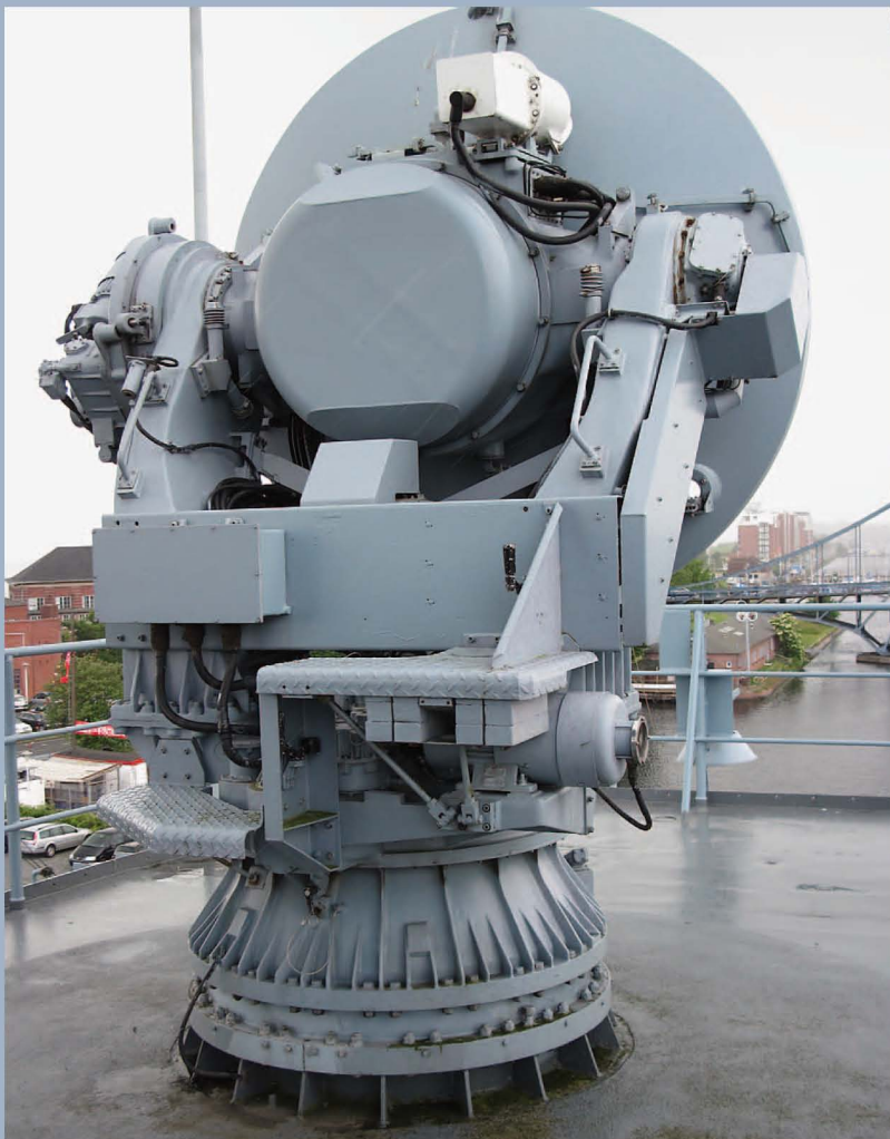
Bild 10: SPG-60 in einer Nahaufnahme von achtern. Ich habe die Mölders gründlich „von Kopf bis Fuß“ fotografiert (Foto: Jürgen Eichardt)
