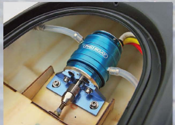
Der Brushlessmotor mit seinem Kühlmantel steht nicht nur für gute Fahrleistungen, sondern bietet auch was fürs Auge
