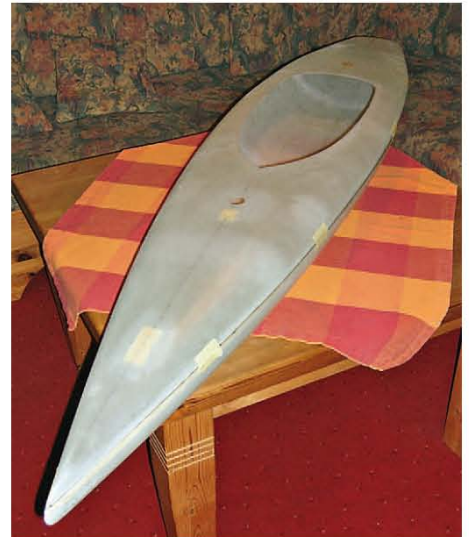
Der fertige GFK-Abzug mit Verstärkungen
