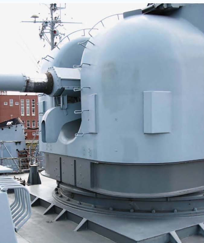
▲ Bild 3: Die unteren zweisprossigen Leitern sind beim Museumsschiff aus Sicherheitsgründen abgenommen. Das Foto lässt erkennen, wie der vordere Teil des Drehsockels beim Buggeschütz quasi in das Backdeck „versenkt“ wurde. Unter dem Rohr sieht man die von einem Deckel verschlossene Hülsen-Ausstoß-Öffnung (Foto: Jürgen Eichardt)
