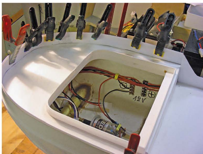
Die Schanzverkleidung aus 0,5-mm-ABS
