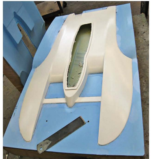
Zur Verstärkung werden mehrere Carbon-Roving-Fasern eingelegt
