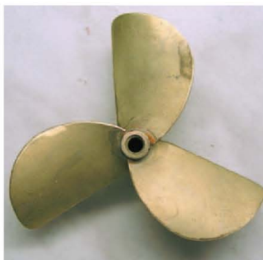
Der selbst gefertigte Propeller, noch sandgestrahlt. Jetzt wird er auf einer Balancewaage ausgependelt und dann auf Hochglanz poliert
