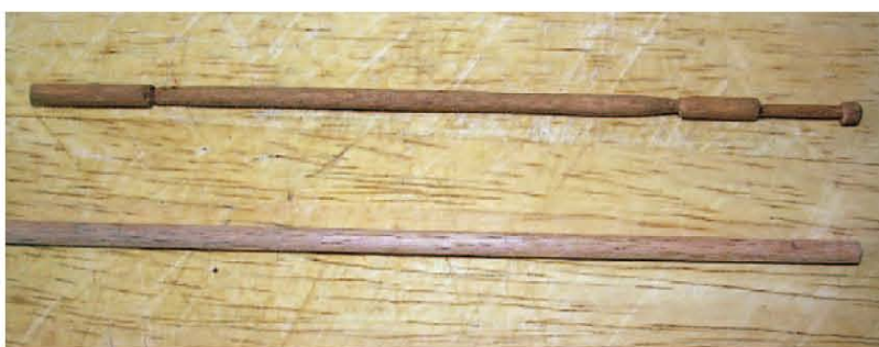
Unten ein 3 mm starkes Buchsbaumrundholz, oben der fertige Barkassenmast
