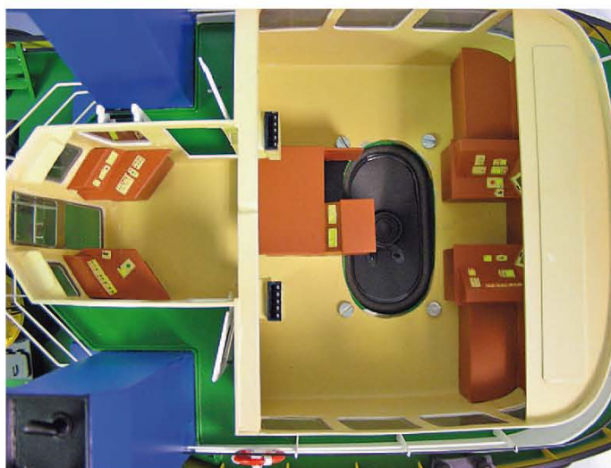
Der Lautsprecher im Brückenhautboden; Brückenhauttüren geöffnet
