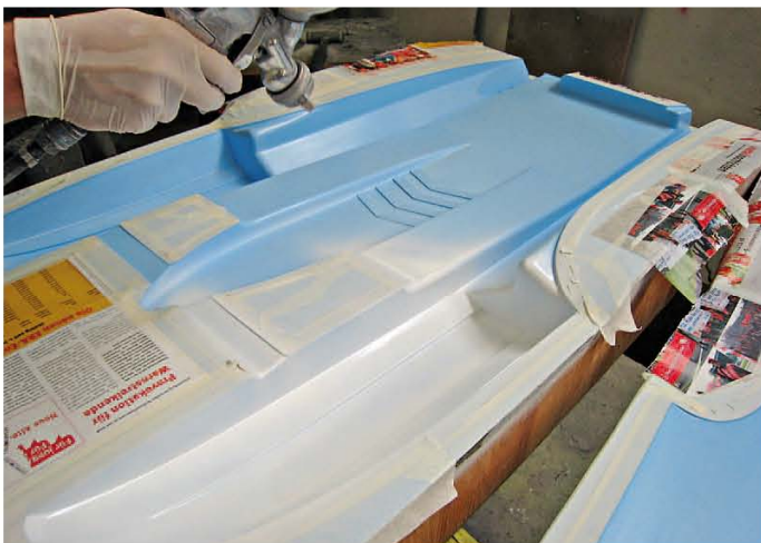
Das Gelcoat wird in die Form eingespritzt
