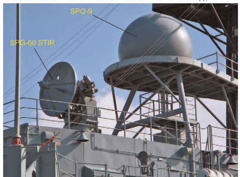
Bild 9: Die neuen Feuerleitgeräte auf der Mölders (Foto: Jürgen Eichardt)
