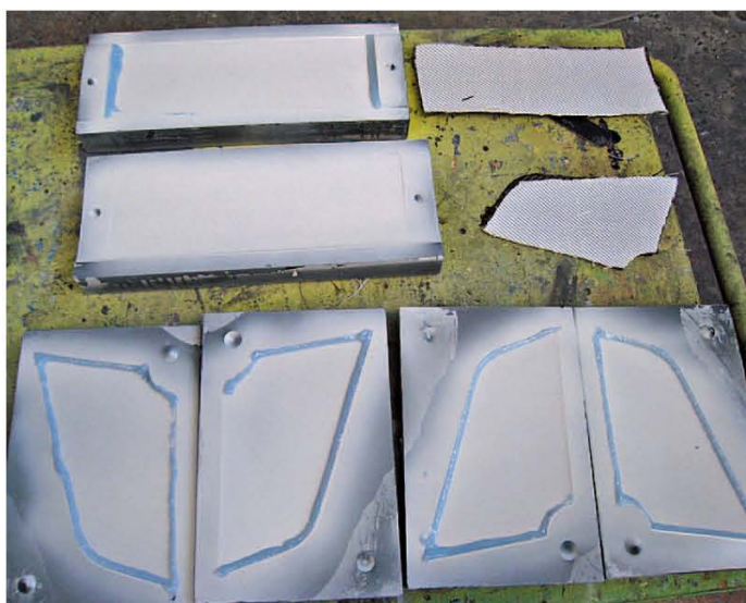
Schnittschablone der Gewebelagen für die Flügel
