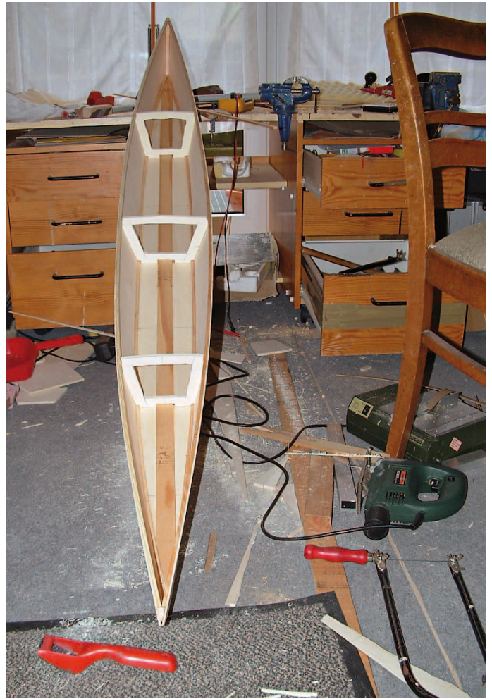
Der Rumpf im Rohbau
