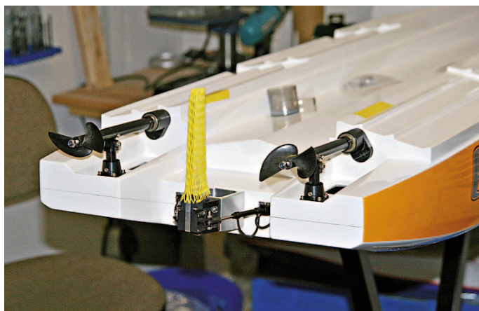
Der umgedrehte Rumpf zeigt deutlich die Katamaran-Ausführung des Modells
