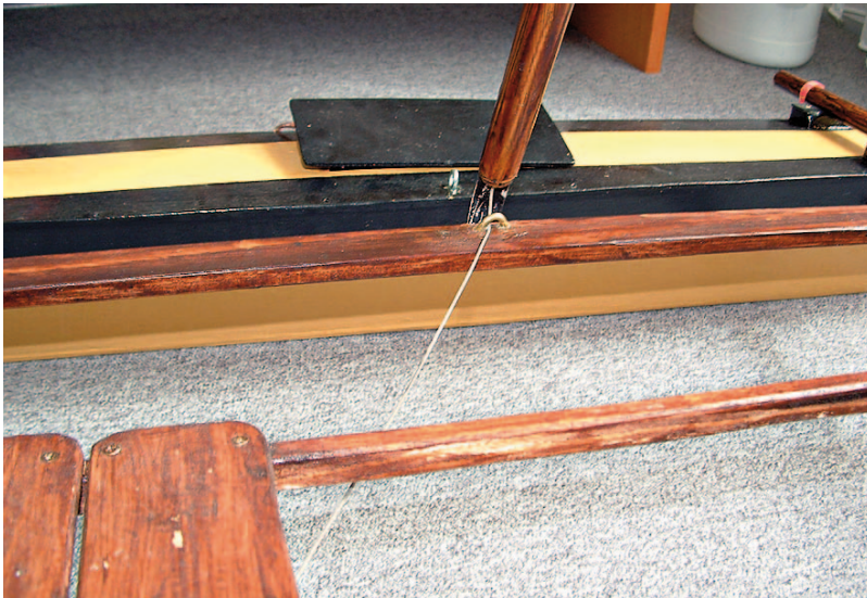
Das Seil führt durch das Außenrohr des Teleskop-Stützasts hindurch und ist am unteren Ende des Innenrohrs befestigt. Durch Ab- bzw. Aufwickeln des Seils wird der Stützast teleskopartig verlängert oder verkürzt
