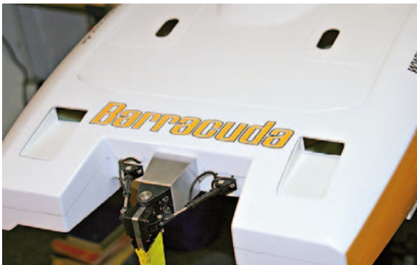
Das Ruder wird über die Hydraulikattrappen angelenkt
