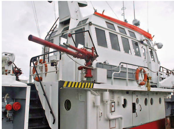
Der Lenkbügel der Löschkanone ist bei Nichtgebrauch nach vorn geklappt. Unter der Löschkanone befindet sich der Quergang (Foto: Egon Wirth)
