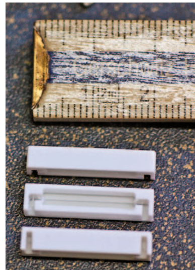
Das passende Gehäuse wurde aus 4 mm starkem Polystyrol gefräst
