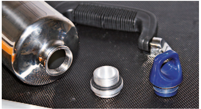
Für den Tank nahm ich eine Edelstahl-Trinkflasche; der Stopfen musste, um Benzin-verträglich zu sein, neu angefertigt werden.
