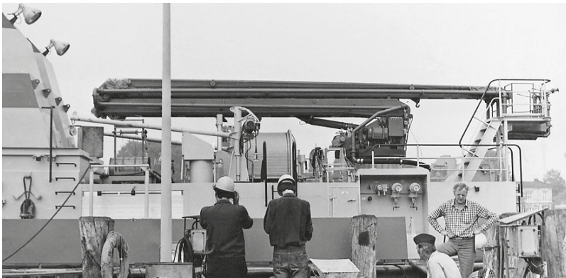
Im Bild der Hubsteiger des FLB-40-2. Dieses Boot hat zum Besteigen der Plattform eine kleine Bühne mit Treppe an Backbord (Foto: Siegfried Borchert)
