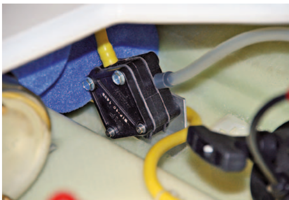
Membranpumpe für die Wasserkühlung
