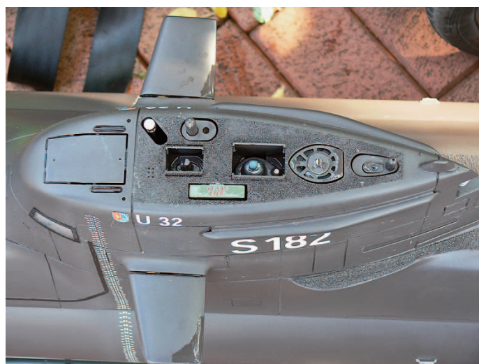
▲ Bild 24 und 25: Die FM- und die Sichtgeräte sind eingefahren ▼
