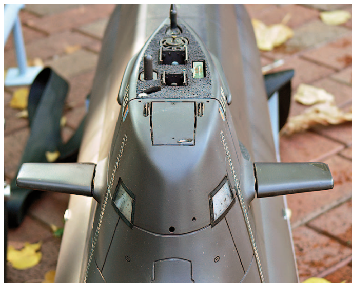
▲ Bild 24 und 25: Die FM- und die Sichtgeräte sind eingefahren ▼
