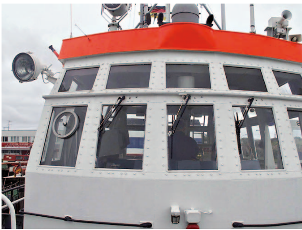
Brückenfront von vorn. Nur ein Schleuderfenster ist eingebaut. Die drei mittleren Fenster haben herkömmliche Scheibenwischer (Foto: Egon Wirth)
