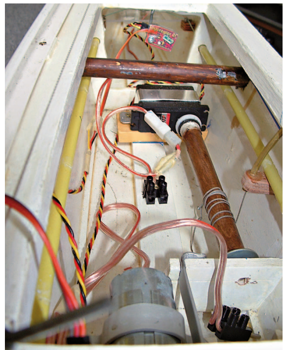
Kenterbremse: Die Winde für den Teleskop-Stützast ist ein Rundholzstab an einer Segelwinde; im Hintergrund ist als rotes Bauteil der um etwa 20° geneigte Lageregler zu erkennen. Er tritt in Aktion, sobald er durch die Krängung des Boots waagrecht liegt bzw. sich nach der anderen Seite neigt
