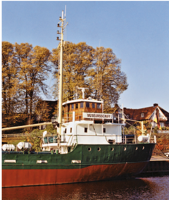
Die Greundiek zeigt ein sehr formschönes Kreuzerheck, optisch sehr ansprechend wirkt auch die mit Hölzern verkleidete Brücke; davor der Mast mit dem Ladebaum und der Winde. Auf der Brücke zu erkennen sind das Radargerät sowie der Peilrahmen und die Funkantennen.
