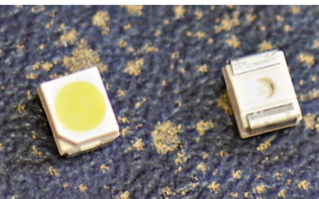
Ober- und Unterseite einer SMD-LED
