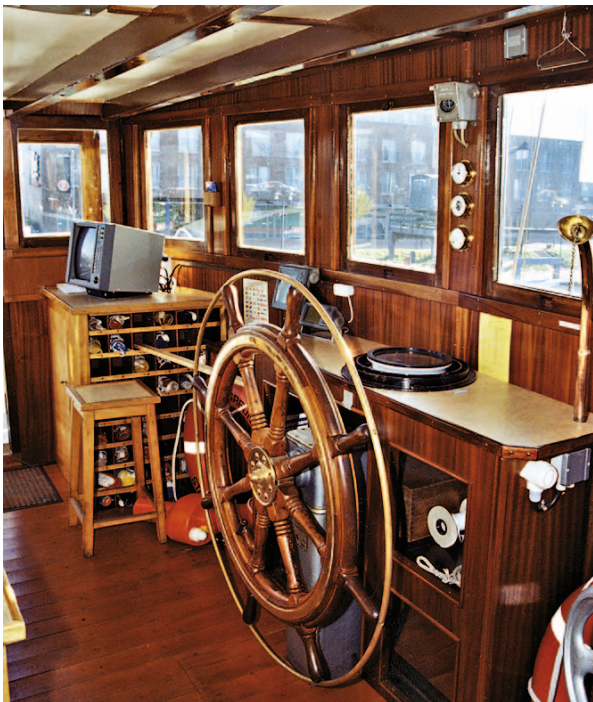
Das Ruderhaus mit seinem imposanten Steuerrad. Im Hintergrund ist der Flaggenschrank zu sehen, auf dem ein Radarschirm steht. Vor dem Steuerrad sind der Kompass und ein Sprachrohr zu erkennen.
