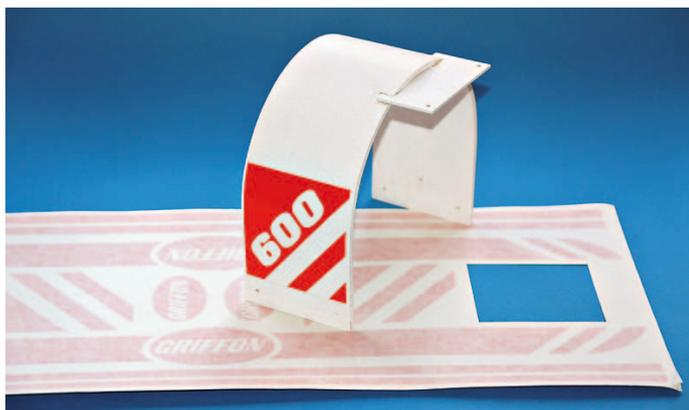
Vor der Montage wird die Dekorfolie aufgeklebt
