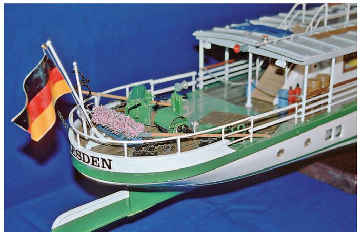
Auf dem Achterdeck sind Ankerwinde, Trossenwinde, Poller, Taue, Ankerdavit, Eimer, Bundstaken und sogar ein Blumenkasten angeordnet
