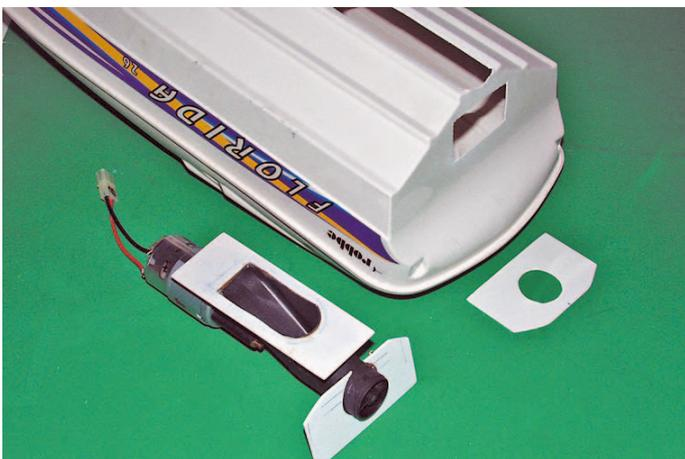
Die Platten werden in den Rumpf eingesetzt und verklebt
