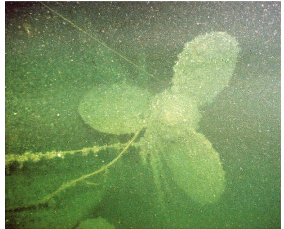
Zwei dreiflügelige Propeller von je 3,5 m Durchmesser verliehen der *Undine* einst über 20 kn Fahrt
