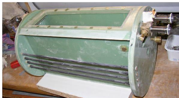
Bild 3: Der Kasten in der Tauchzelle nimmt vier Stromdurchführungen auf
