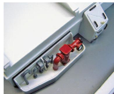
◀ Einer der Auffangkästen mit Füll- und Entlüftungs- stutzen
