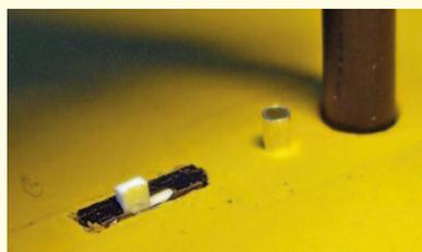
Der Schalter hinter dem Mast lässt sich mit dem Fingernagel bedienen. Durch den leicht erhöht eingebauten Niet zur Schotdurchführung können überkommene Brecher nicht unter Deck gelangen
