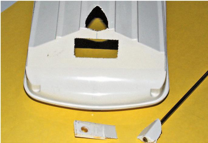
Die neuen Öffnungen für den Jet-Antrieb werden ausgearbeitet
