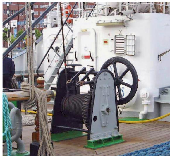
Der grün gestrichene Stahlsockel ist direkt auf das Stahldeck geschweißt
