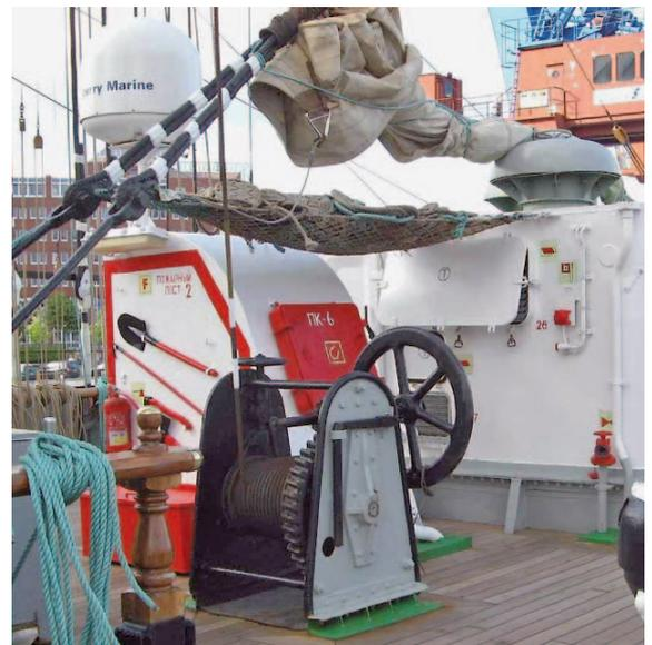
Die Winde ist auch deshalb seitlich versetzt, damit das Zugseil neben dem doppelten Zwischenstag nach oben geht
