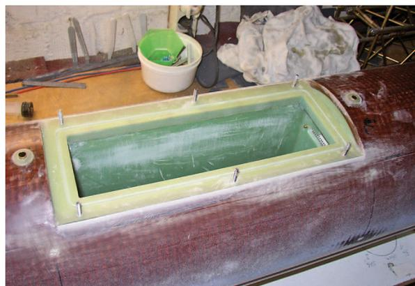
Bild 6: Die Tauchzelle wurde in den Rumpf eingesetzt
