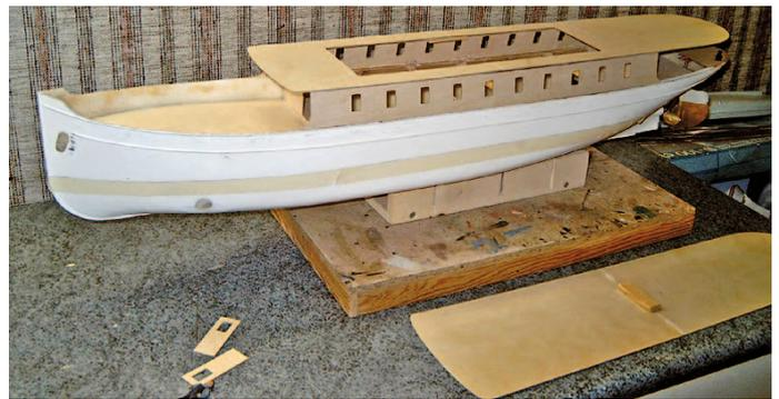
Die Seitenwände fräste mir ein Bekannter exakt aus Sperrholz aus
