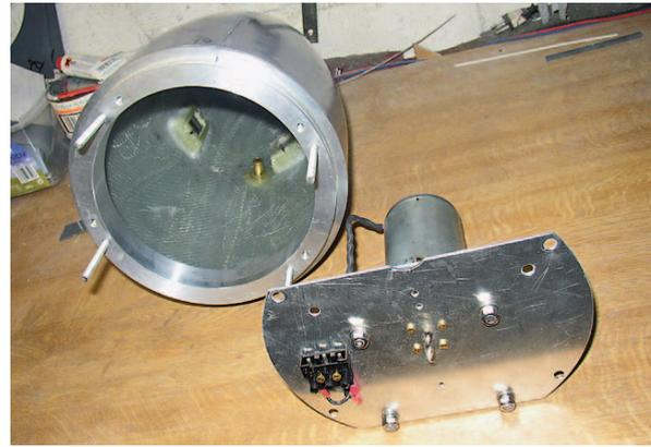
Bild 10: Die Antriebseinheit mit dem Dunker-Motor
