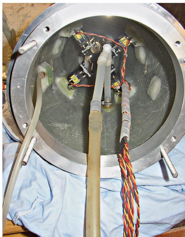
Bild 9: Das Formteil der Hecksektion mit Aluminiumring
