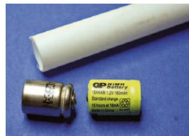
Die Akkus müssen entkleidet werden, um in das Röhrchen zu passen
