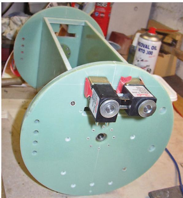
Bild 2: Auf der Einschubseite des Technikgerüsts sind die vorkonstruierten Flutventile angebracht
