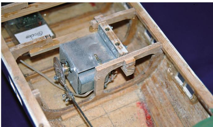
Der Rumpfbau erfolgte in bewährter Manier aus Holz. Die Rudermaschine ist bereits eingebaut
