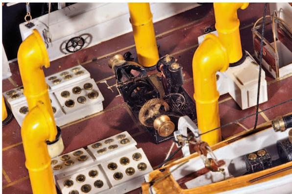
Mittschiffs ist die Dampfwinde aufgestellt
