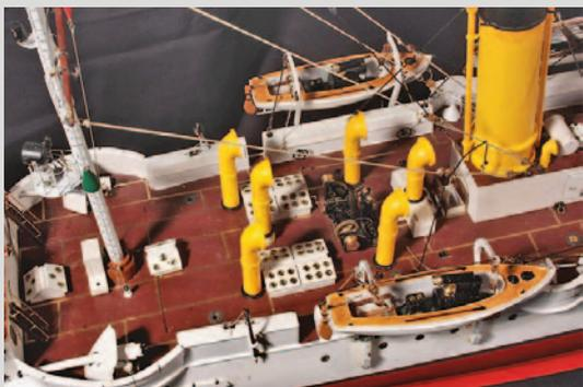
Das Deck des Vorbilds wies einen mit Messingbändern abgesetzten Linoleumbelag auf; er wird im Modell mit passender Farbe nachgebildet
