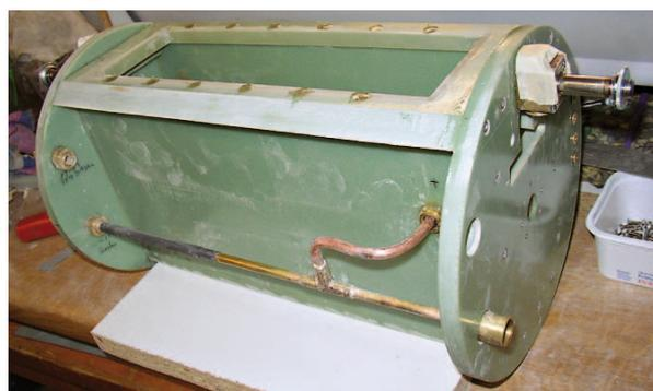
Bild 4: Der Kasten mit der Pressluftdurchführung
