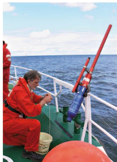
Das Pressluftleinengewehr, fertig zum Abschuss
