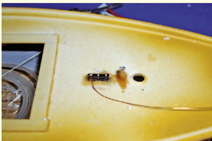
Der Schalter und der Niet für die Schotdurchführung wurden mit Stabilit Express eingeklebt
