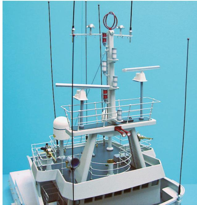
◀ Auf der schmalen Brückenplattform über den Schornsteinen steht der Antennenmast
