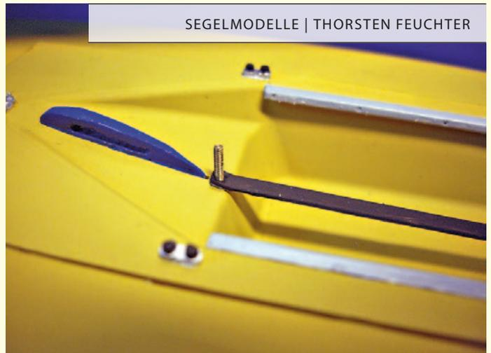
Eine M-1,2-Schraube wurde in den Rumpfboden geklebt; sie ragt durch die Plicht. Mit ihr wird zum einen die Plicht gegen das Auflager gepresst, zum anderen dient sie als Anschlagpunkt für die Schot
