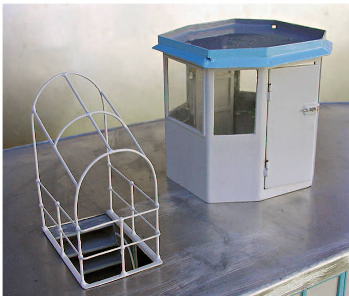
Der Niedergang hinter dem Steuerhaus; die Verstrebung ist eine Löt-konstruktion
