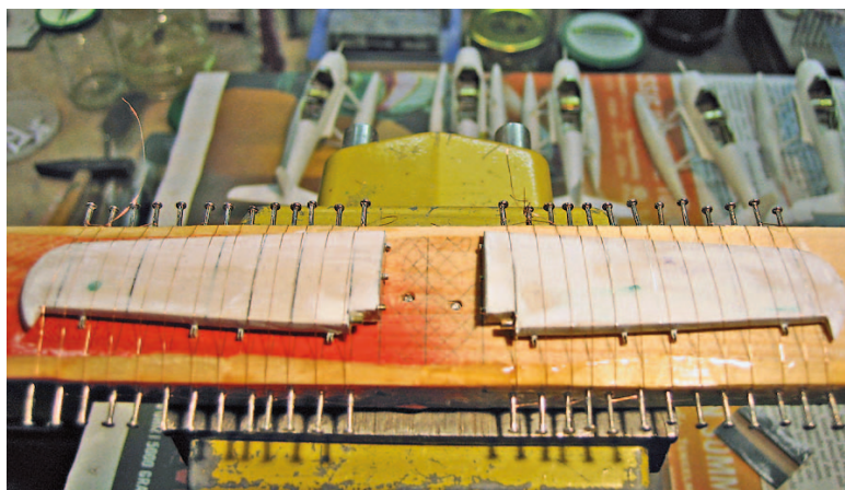
In der heimischen „Flugzeugfabrik“: Arbeit an den Tragflächen; im Hintergrund die Arado-Rümpfe
