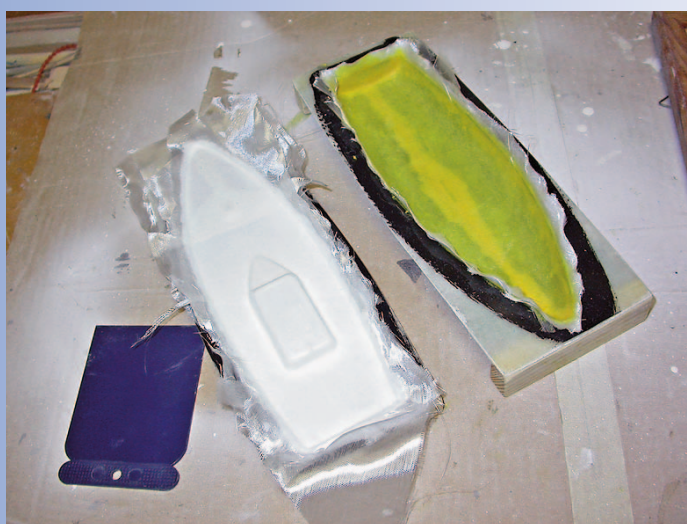
Die Farben wurden bereits bei der Abformung ins Harzgemisch eingestellt
