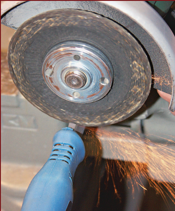
Zuerst wird der Griff mitsamt dem Erl abgeflex ...
