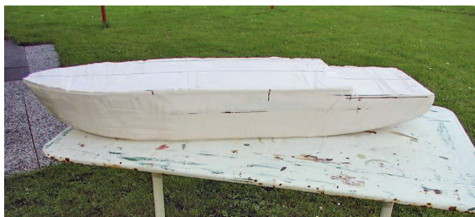
Der Rumpf entstand aus laminiertem Styropor
