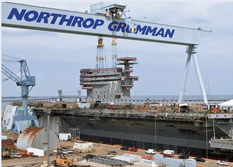
Aufsetzen der „Insel“ auf den Träger (Foto: Rick Thompson/Northrop Grumman)
