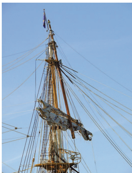
Die Oberbramrah am Fockmast war bereits abgenommen, die Bramstenge war runtergefiert und hing bis zum Top im Eselshaupt der Marsstenge
