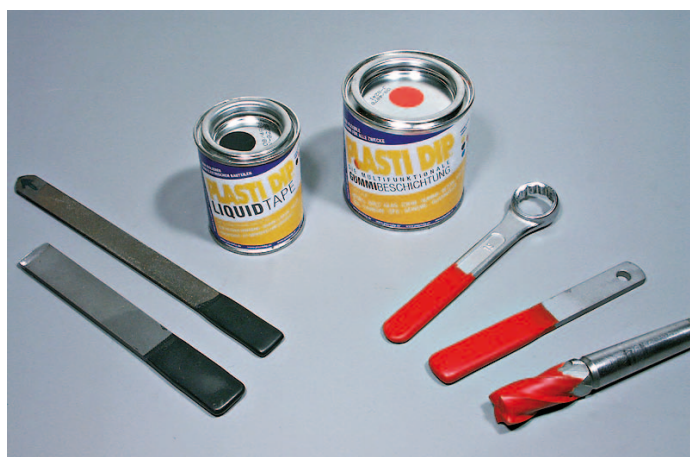
Links meine beiden Drehbank-Feilen, rechts ein Hebel, ein gekürzter Ringschlüssel und ein versiegelter Fräser
