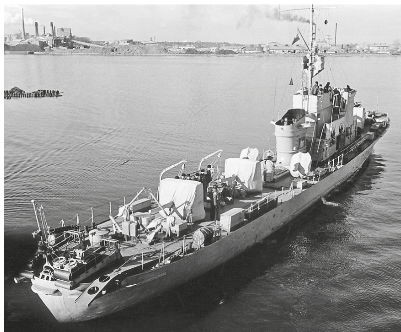
Foto 9: Zwischen der hinteren 37-mm-Flak und den Wabo-Abrollbahnen sieht man neben den Minengleisen die beiden Wabo-Stempelwerfer. Das Nebelgerät steht auf der Backbordseite. Das hier abgebildete Boot entspricht weitgehend meiner Skizze – ein wunderschöner Rumpf! (Foto: Sammlung Malinowski (OW))
