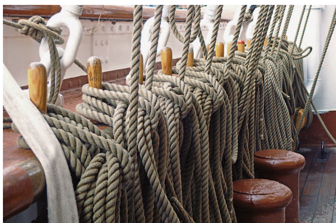
Eine Reihe von Belegnägeln mit aufgeschossenem Tauwerk unterhalb der Wanten
