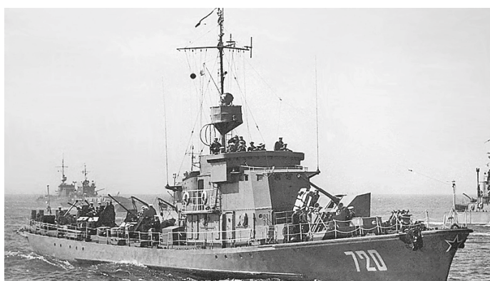
Foto 6: Neben dem Buggeschütz stehen die aufgerichteten Salvenwerfer. Der Pfahlmast hat eine Scheinwerfer-Plattform. Am Bug der obligatorische rote Stern (Foto: „Taifun“, Nr. 46)
