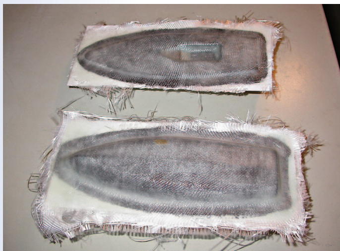
Die erstellte Form wird mit GFK auslaminert
