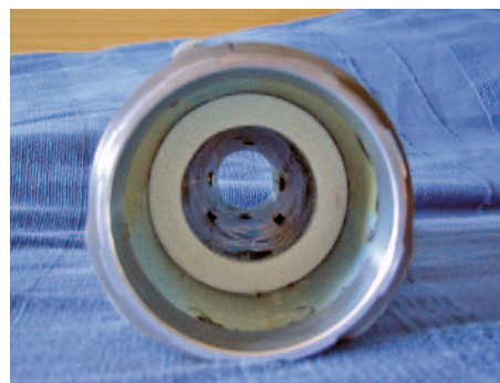
Der eingeklebte Heckspant
