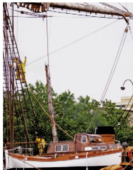
Die Oberbramrah wurde abgenommen und auf Deck gefiert
