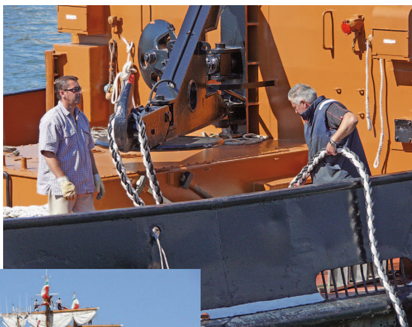
Die Schlepperbesatzung befestigte nach der Übergabe ihre eigene Schleppleine. Sie konnte nun von der Besatzung des Schulschiffes an Bord geholt werden
