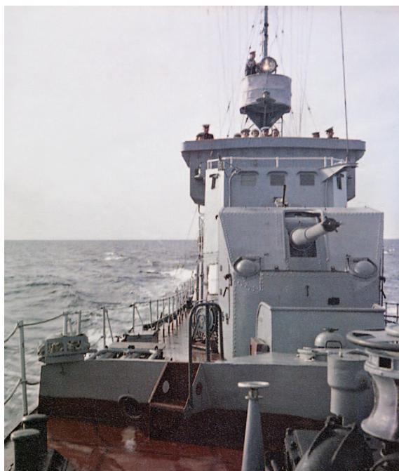
Foto 4: Hinter dem Wellenbrecher auf der Back erkennt man den steuerbordseitigen, niedergelegten Salvenwerfer für reaktive Wasserbomben. Die Brückenfront hat hier drei rechteckige Schiffsfenster
