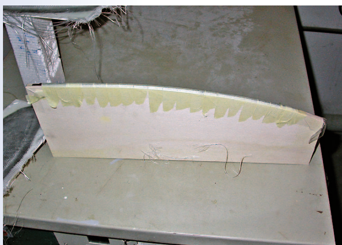
Auf einer Sperrholzhelling wurde ein neuer Mast aus fünf Lagen Kohlefaser in Form gebracht
