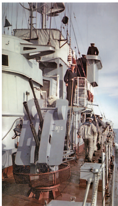
Foto 5: Die 12,7-mm-Zwillingsflak 2M-1 hat hier einen Splitterschutz aus Kunststoff (GFK). Der braunrote Decksanstrich war bei der Sowjetmarine üblich
