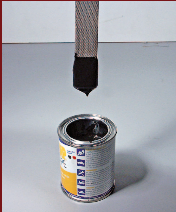
... und dann wird sie mehrfach in Plasti-Dip getaucht
