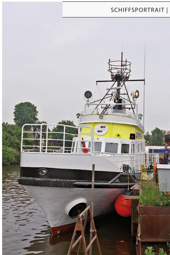
◀ Der Bug der *Emswind* ermöglicht nach den Umbauarbeiten das Absetzen von Arbeitskräften an den Windparkanlagen auf der offenen Nordsee
