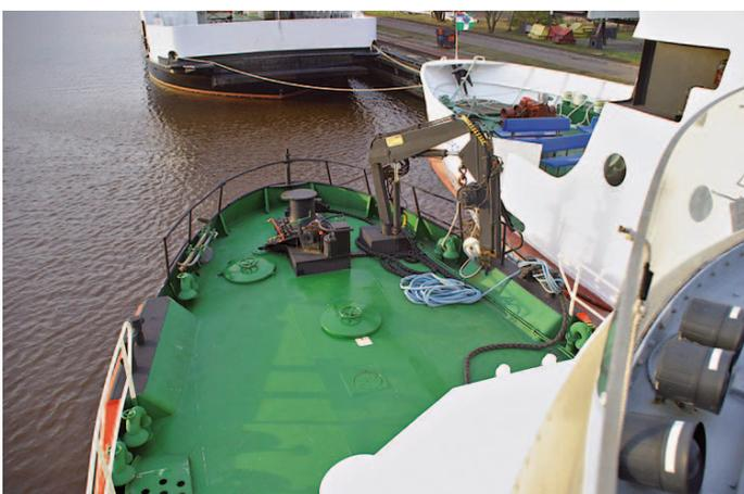
Blick auf das Vorschiff im November 2007. Der Bergungskran stammt von der Firma HIAB, die maximale Last beträgt 2.250 kg
