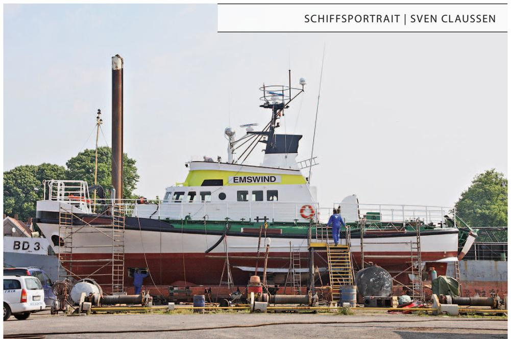
Kurz vor Abschluss der Arbeiten Mitte Juni 2008: Ins Vorschiff wird das Bugstrahlruder eingebaut, die neue Reling ist fertig montiert, die Schlingerkeile sind zu erkennen
