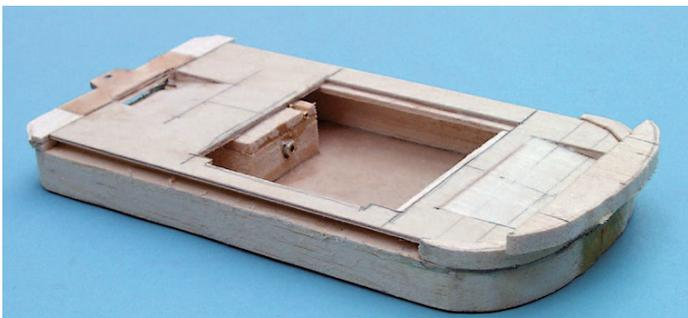
▲ Der Rumpf des Rohmodells. Zu sehen sind das Stevenrohr und schräg darüber der Austritt der Ruderanlenkungsführung. Die Zufahrt zu den Rampen ist etwas abgesenkt
