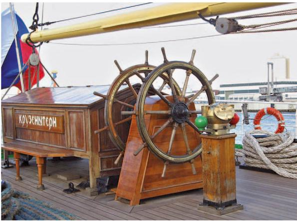
Von links nach rechts: Abdeckung für die Rudermaschine, Steuerrad, Steuerkompass mit den beiden (rot und grün) Weicheisenkugeln für die sogenannte D-Korrektur. Das dünne Stahlseil, das durch die Rolle im Besan-Baum fährt, ist der Ausholer für das Unterbesansegel. Hinten, vor der Flagge, sieht man die mehrscheibige Besanschot
