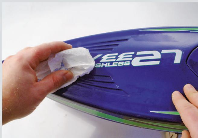
Nach der endgültigen Positionierung wird der Aufkleber festgehalten und das Wasser unter ihm herausgedrückt. Nach einer Trocknungsphase über Nacht haftet das Dekor perfekt
