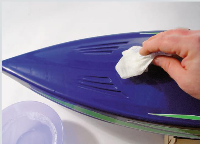
Der Rumpf wird mit Wasser mit wenig Spülmittel flächig benetzt
