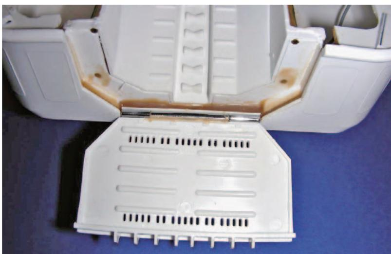
Die Heckklappe mit den neu gefertigten Scharnieren
