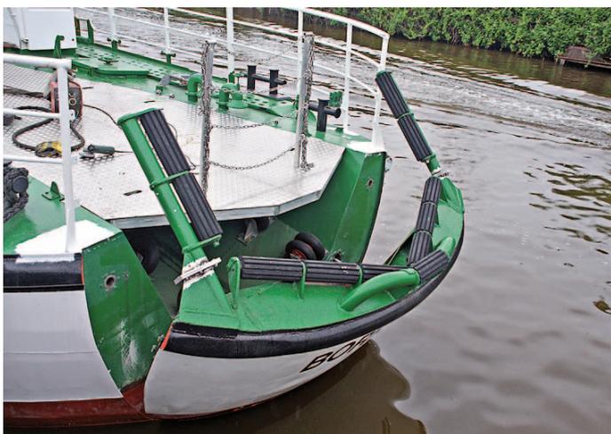
Heckklappe und (mobile) Arbeitsplattform im Achterschiff bei der Erprobung im Juni 2008
