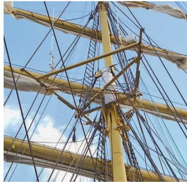
Eine Bramsaling (Kreuzmast) mit ihren Ausreckern von unten. Durch das Scheibgatt unterhalb der Saling fährt das Stahlseil vom Fall des Kreuz-Obermarssegels
