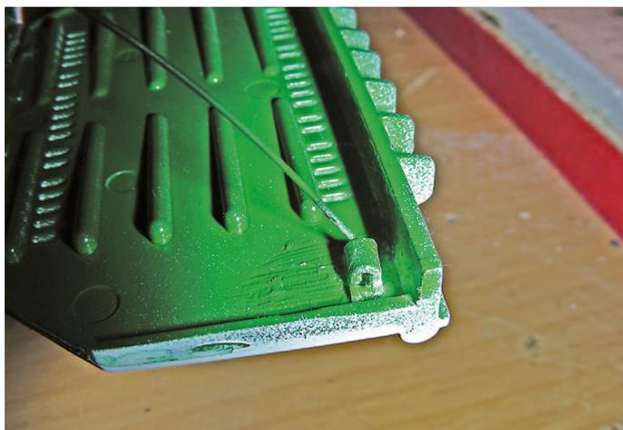
Die alten Scharniere werden durch passende Messingrohrstücke ersetzt
