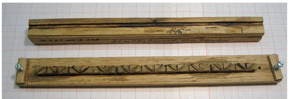
Teile der aus 1×1-mm-Messing-T-Profilen gefertigten Diagonalverstreben mussten auf Gehrung recht genau zugeschnitten und Stück für Stück eingepasst werden. Um die Teile sauber lötten zu können, musste zunächst eine entsprechende Schablone angefertigt werden. Lötshablonen fertige ich in aller Regel aus Holz (Eiche, Buche, Limba), da Holz während des Lötens dem Material so gut wie keine Wärme entzieht und dadurch eine einwandfreie Lötverbindung (Lötwasser verwenden!) gewährleistet werden kann.
