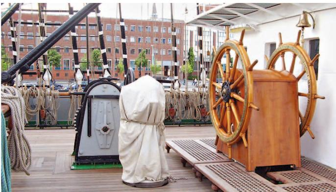
Der Steuerstand mittschiffs, davor der abgedeckte Steuerkompass und neben diesem eine der Rahfallwinden
