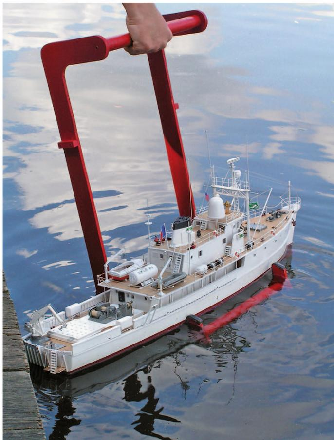
Die Einsetzvorrichtung erleichtert das Wassern des Modells erheblich
