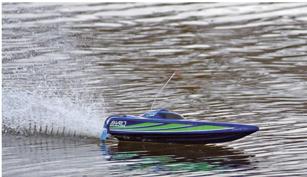
Linksrum geht's auch – aber bedingt durch die Steuerbord montierte Turnfin liegen der Supervee Rechtskurven mehr
