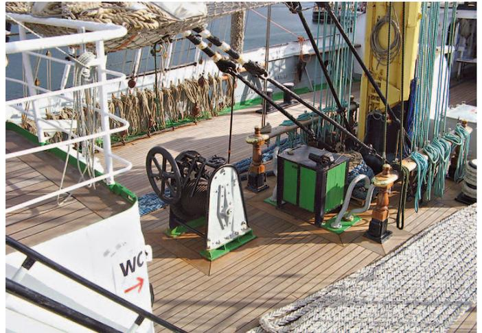
Blick vom Poopdeck (Vorderkante) hinunter in die vordere Kuhl. Unter den Zugstangen für die Spanschrauben der Zwischenstage steht eine kleine Werkbank; in der Bildmitte die Rahfallwinde für die schwere Vor-Obermarsrah
