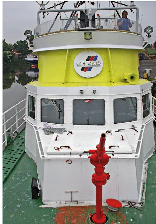
Die Emswind im Juni 2008. Auf dem Vorschiff wurde ein Materialstore ergänzt, der (Original-) Löschmonitor ist wieder auf dem Vordeck montiert
