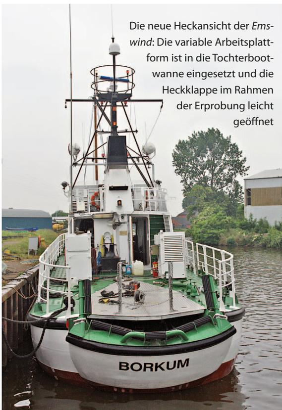
Die neue Heckansicht der *Emswind*: Die variable Arbeitsplattform ist in die Tochterbootwanne eingesetzt und die Heckklappe im Rahmen der Erprobung leicht geöffnet
