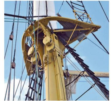
Die Saling des Besanmasts hat zum Durchsteigen große Öffnungen. Hinten quer zwischen den Unterwanten sind Schwichtinge eingewebt, damit man die Besansegel zum Losmachen erreichen kann
