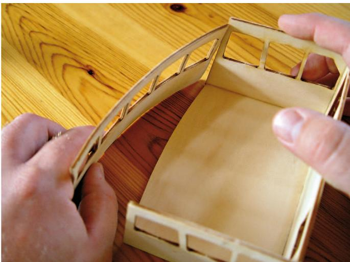
Die vordere Brückenwand sollte nach dem Wässern vorgebogen und dann angepasst werden
