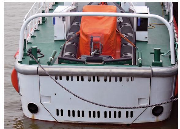
Die Heckklappe mit hinterem Prallschutz
