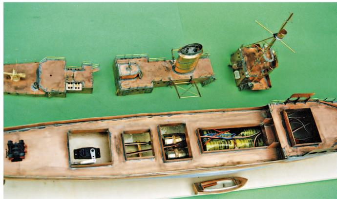
Kein Holz, nur Leiterplatten und Messing dienten mir als Baumaterial für den Rumpf und die Aufbauten
