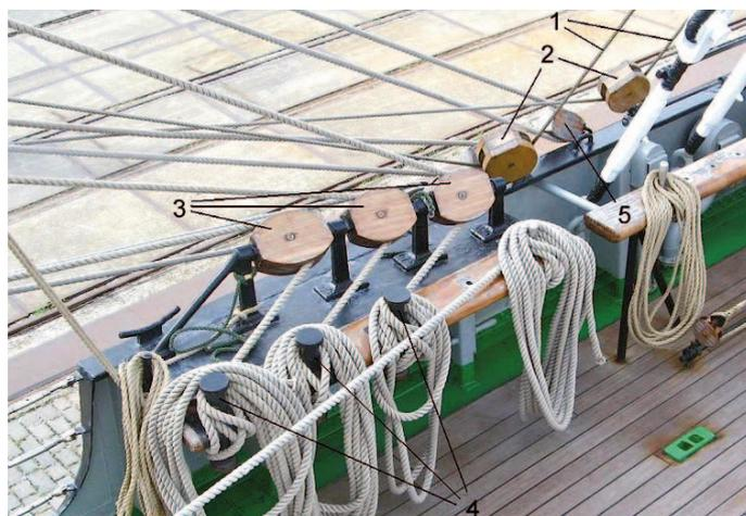
1 = die von oben kommenden Stahlseil-Vorläufer, 2 = Vorläufer-Umlenkböcke, 3 = dreiteiliger Fußblock, 4 = Belegstellen für die holenden Partien der Brassentaljen, 5 = Taljenblock, die beiden anderen sind verdeckt
