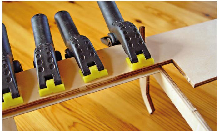
Die Schaffung einer größeren Auflagefläche für den Deckschnitt durch Sperrholzleisten ist durchaus sinnvoll
