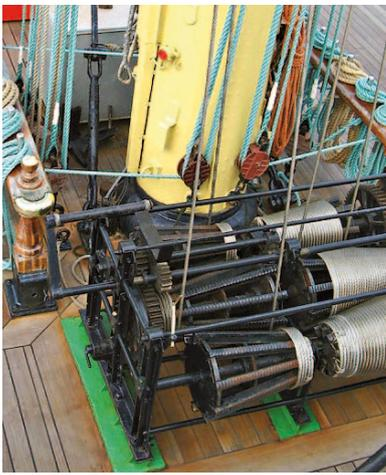
Die Winde ist als schwere Decksmaschine auf (grün gestrichenen) Stahlsockeln montiert. Man erkennt, dass die Vorläufer nahezu parallel nach oben fahren. Hinter der Winde sieht man eine Spannschraube für einen doppelten Zwischenstag
