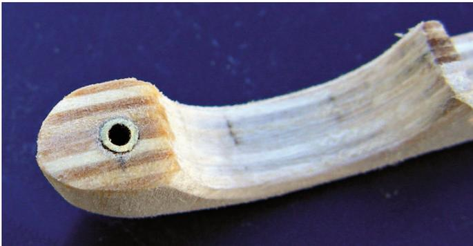
Die Lagerung des Ruders in der Ruderhacke wird mittels eines Messingrohrabschnitts verstärkt
