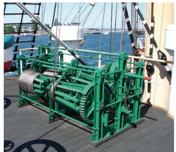
Brassenwinde mit Edelstahlseilen auf der *Passat*. Hier sind die Zahnräder mit Schutzblechen abgedeckt. Auf den linken Spilltrommeln ist das Seil fast vollständig aufgespult, die Rahen sind also nach Backbord gebrast
