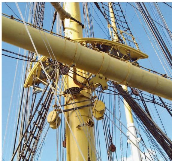
In Bildmitte die vier schweren, an Stangen hängenden Umlenklöcke für die Vorläufer; Stropfs halten sie beieinander
