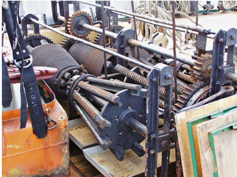
Nahaufnahme einer Brasswinde auf der *Sedov* – oder was der Rost noch davon übrig gelassen hat. Den Verschiebbereich der oberen Antriebswelle kann man hier gut erkennen. Unter die Winde hat man flache Blechschalen gestellt, dass nur kein Öl auf das Deck tropft ...
