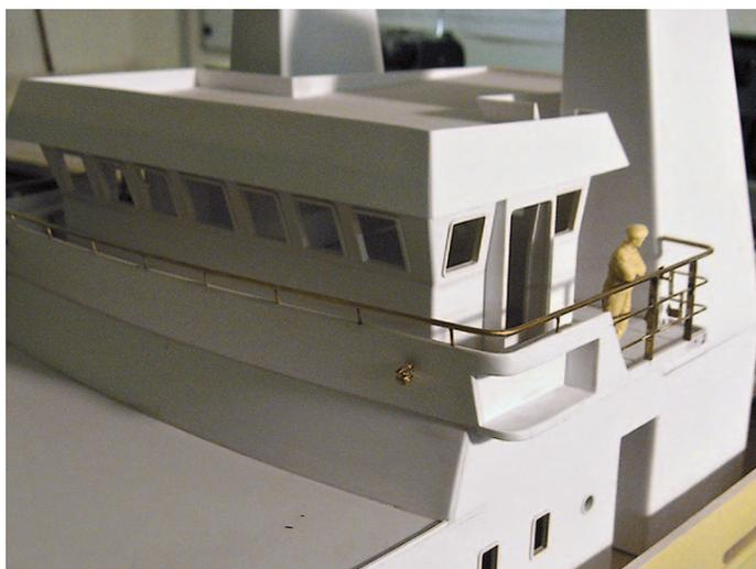
Die Aufbauten aus 2-mm-Polystyrol im Rohbau
