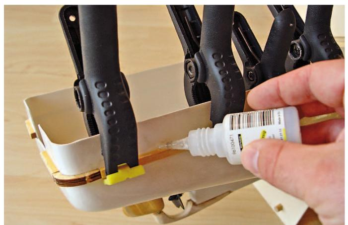
Die Scheuerleisten aus Holz lassen sich am besten mit Sekundenkleber befestigen
