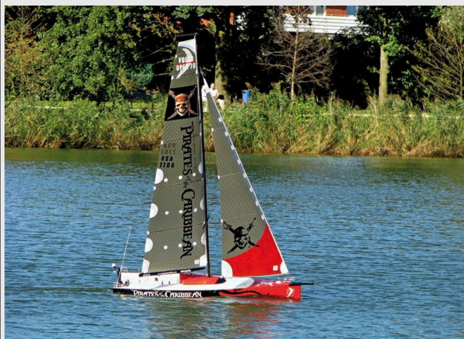
Die Wellen am Bug sind mit einer Schablone abgeklebt
