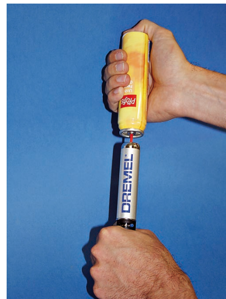
Das Befüllen des Versatip erfolgt mit Feuerzeug-Gas
