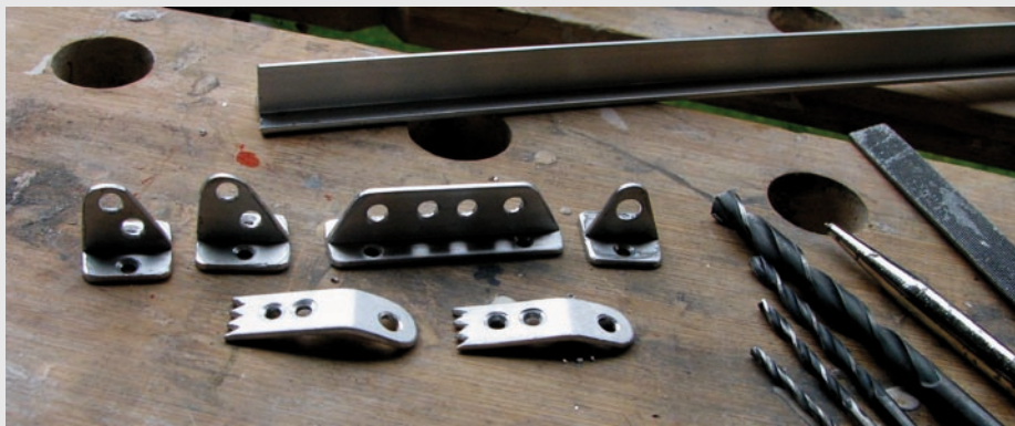
Deckbeschläge gefertigt aus Aluprofilen
