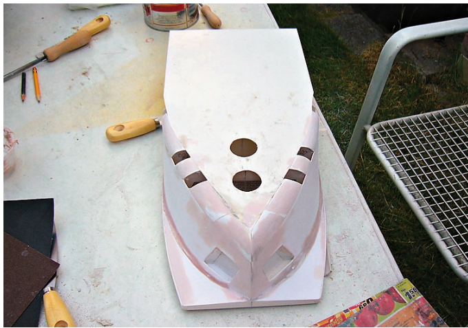
Der Rumpf entstand in Sektionsbauweise
