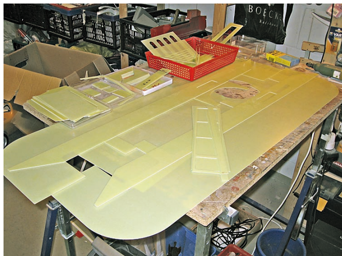
Die CNC-gefrästen GFK-Teile werden in Position gelegt
