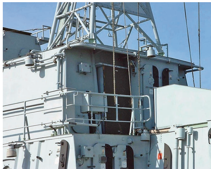
Sicht auf den achterlichen Teil der Brücke. Hinter den beiden Türen oben rechts lagert der Kampfsatz der Strela -Raketen. Foto: Klaus Dieter Rex
