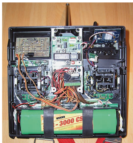
Die mit Nautic- und 2,4-GHz-IFS-Modul ausgebaute Anlage
