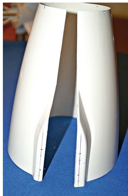
Das Mittelteil wurde unten der Länge nach aufgeschnitten
