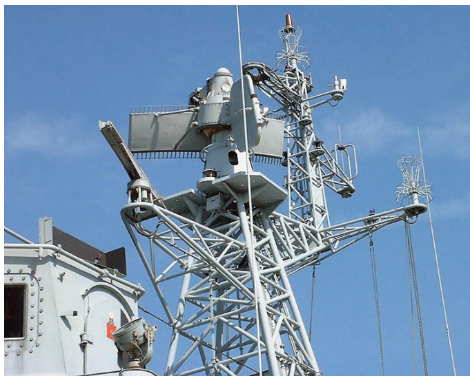
Nahaufnahme des Radarmasts. Auch dieser Gittermast ist aus Aluminiumrohren zusammengeschweißt. Oben auf der Voraus-Konsole fehlt die Freund-Feind-Kennungsantenne. Foto: Klaus Dieter Rex
