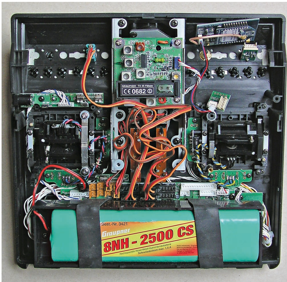
Das Innenleben wirkt sauber und übersichtlich. Auch wenn schon erste Erweiterungen wie hier mit dem IFS-System und Lehrer/Schüler-Buchse vorgenommen wurden
