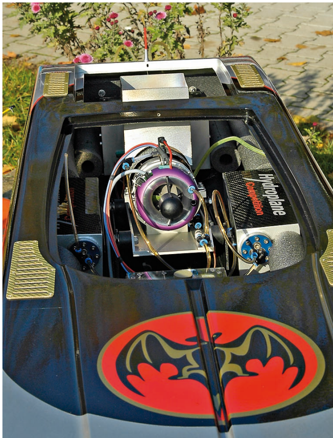
▲ Die Turbine eingebaut in ein Monoboot. Rechts und links die beiden Tanks
