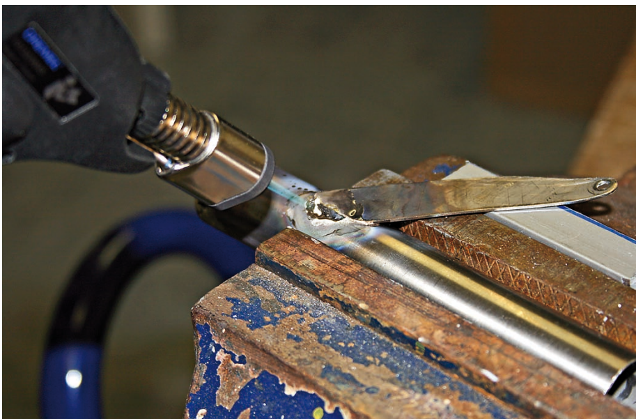
Der Versaflame eignet sich aufgrund der bis zu 1.200°C heißen Flamme auch für Hartlötarbeiten – hier wird eine Haltelasche an einem Krümmer verlötet
