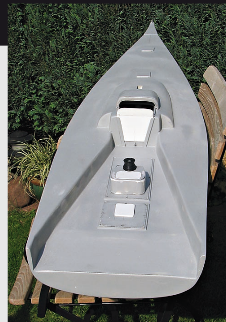
Der Bootskörper ist fertig verschliffen und mit Grundierung versehen
