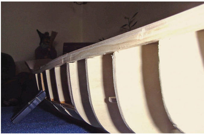
Der Decksbalken ist aufgebracht
