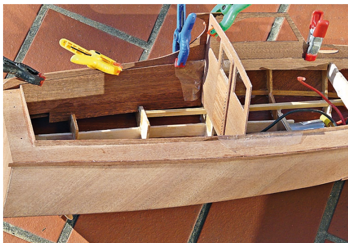
Montage des Aufbaus
