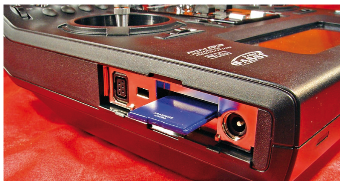
Über den SD-Karten-Slot lassen sich mittels handelsüblicher SD-Karten Updates der Software aufspielen oder Modelldaten speichern und auslesen
