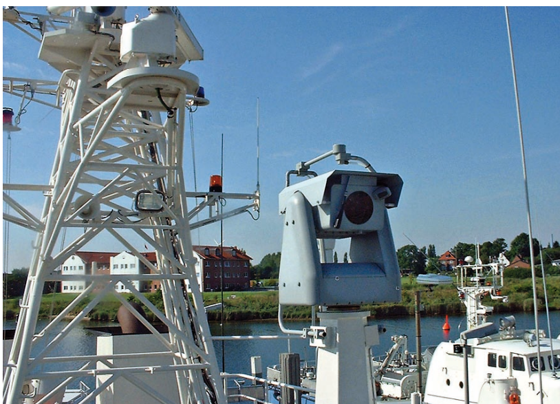
In Bildmitte das Infrarot-Nachtsichtgerät, weiter hinten der Mast mit einer Vorkonsole für einen Radar-Drehbalken. Foto: Klaus Dieter Rex
