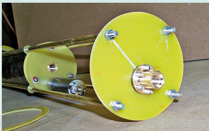
Der Bugspant des Technikgerüsts
