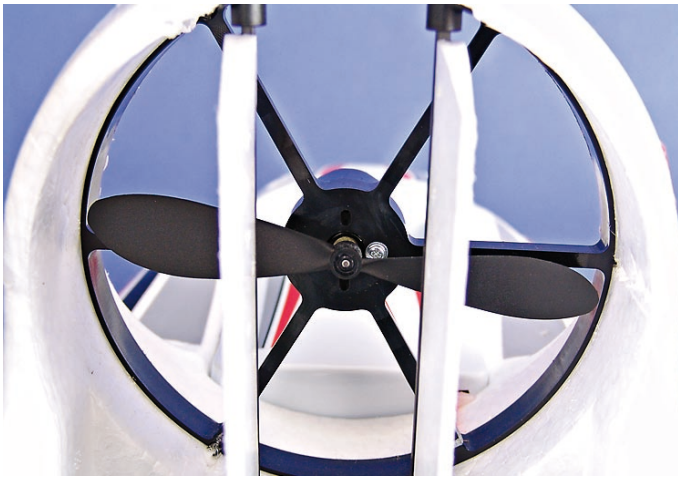
Die serienmäßige Luftschraube mit Kunststoffnabe ist einfach auf die Motorwelle aufgeschoben. Bei hohen Motortemperaturen kann sie sich lösen
