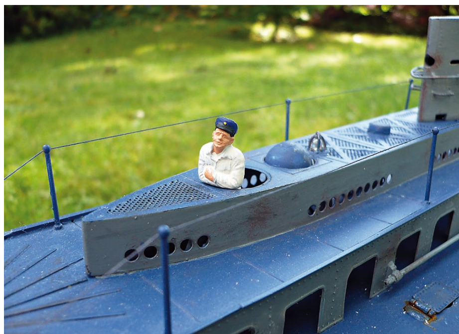
Ein „rastender“ Matrose; hinter ihm sind eine Telefonboje, das Rundumlicht und der Kreiselkompass zu erkennen, im Vordergrund die Decksverstärkung für das 8/8-Geschütz
