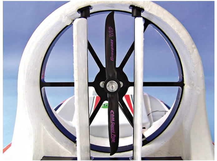
Ein Alu-Mitnehmer in Kombination mit einer passenden Luftschraube hält den Belastungen stand
