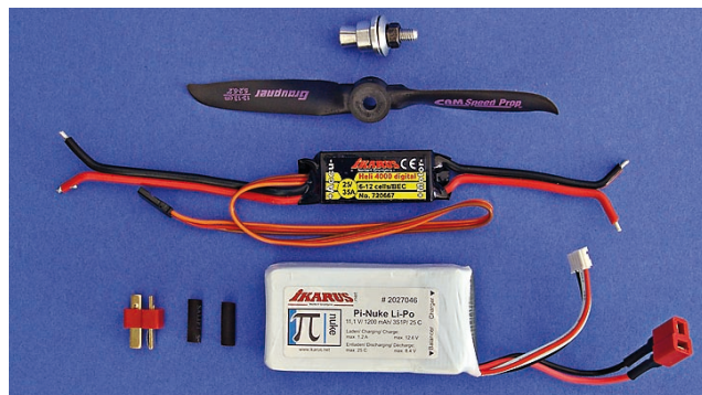
Die Komponenten zur Umrüstung auf 3-S-Betrieb mit getrennter Steuerung von Hub- und Schubfunktion
