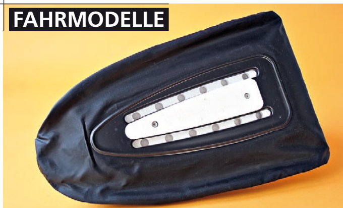
Der Dragstair unter die Schürze geschaut. Eine Acropor-Bremsplatte schützt den Stoff beim Landeinsatz vor Beschädigungen
