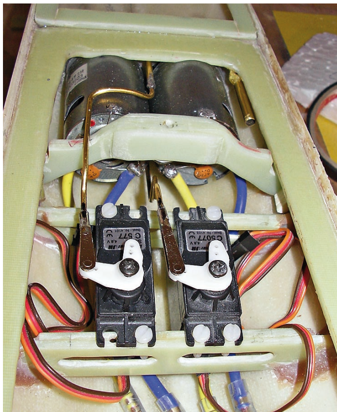
Das einlamierte Heckschott mit den angeflanschten 12-V-Motoren, dem Seitenruder- und dem achterlichen Tiefenruderservo
