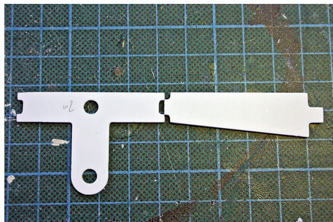
Die Frästeile müssen jeweils leicht nachgearbeitet werden
