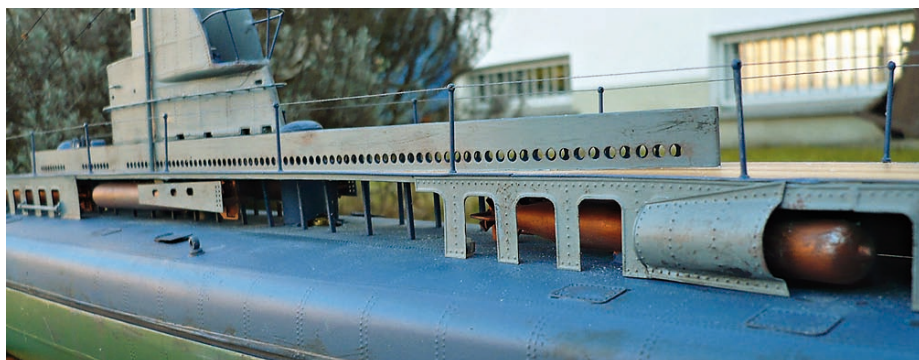
Mittschiffs liegen das Torpedoabwurfssystem Drzewiecky und die nach dem Umbau im Frühjahr 1918 fest nach achtern installierten Torpedoablaufschiene
