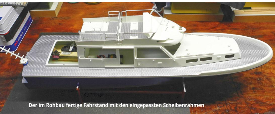
Der im Rohbau fertige Fahrstand mit den eingepassten Scheibenrahmen
