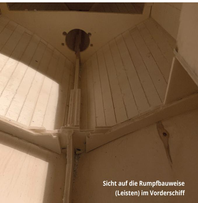
Sicht auf die Rumpfbauweise (Leisten) im Vorderschiff
