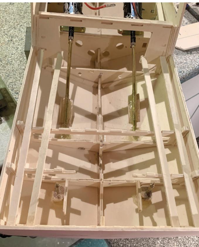
▲ ▼ Der Rumpf mit eingeklebten Wellen bzw. Ruderanlage sowie Motoren
