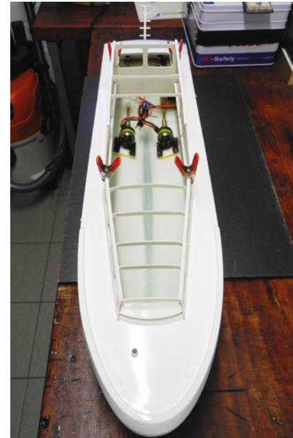
Ausrichten der Spanten und Seitenteile des Aufbaus
