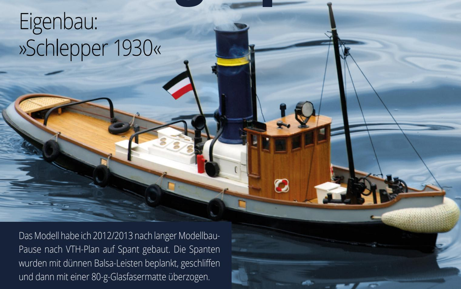
Das Modell habe ich 2012/2013 nach langer Modellbau-Pause nach VTH-Plan auf Spant gebaut. Die Spanten wurden mit dünnen Balsa-Leisten beplankt, geschliffen und dann mit einer 80-g-Glasfasermatte überzogen.
