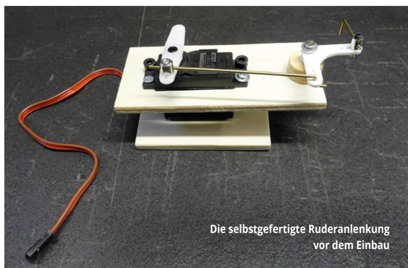
Die selbstgefertigte Ruderanlenkung vor dem Einbau
