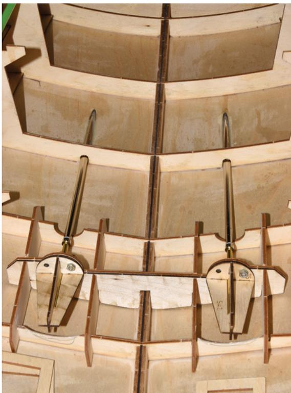
Diese Bauteile garantieren eine genau fluchtende Welle/Motor-Kombination
