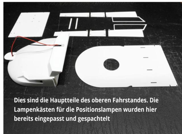
Dies sind die Hauptteile des oberen Fahrstandes. Die Lampenkästen für die Positionslampen wurden hier bereits eingepasst und geschpeltelt
