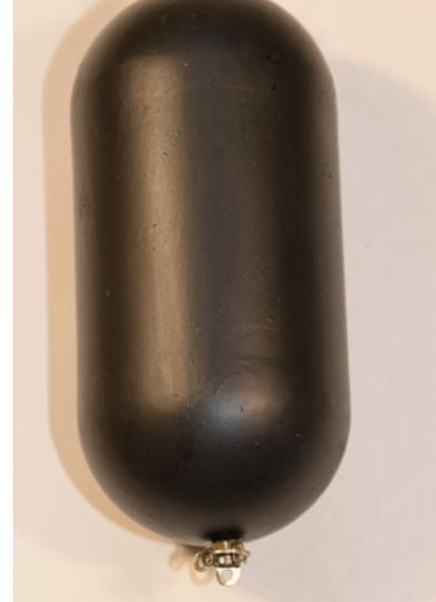
Der fertige Druckkörper ist verspachtelt und lackiert
