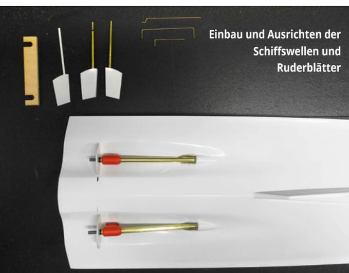
Einbau und Ausrichten der Schiffswellen und Ruderblätter
