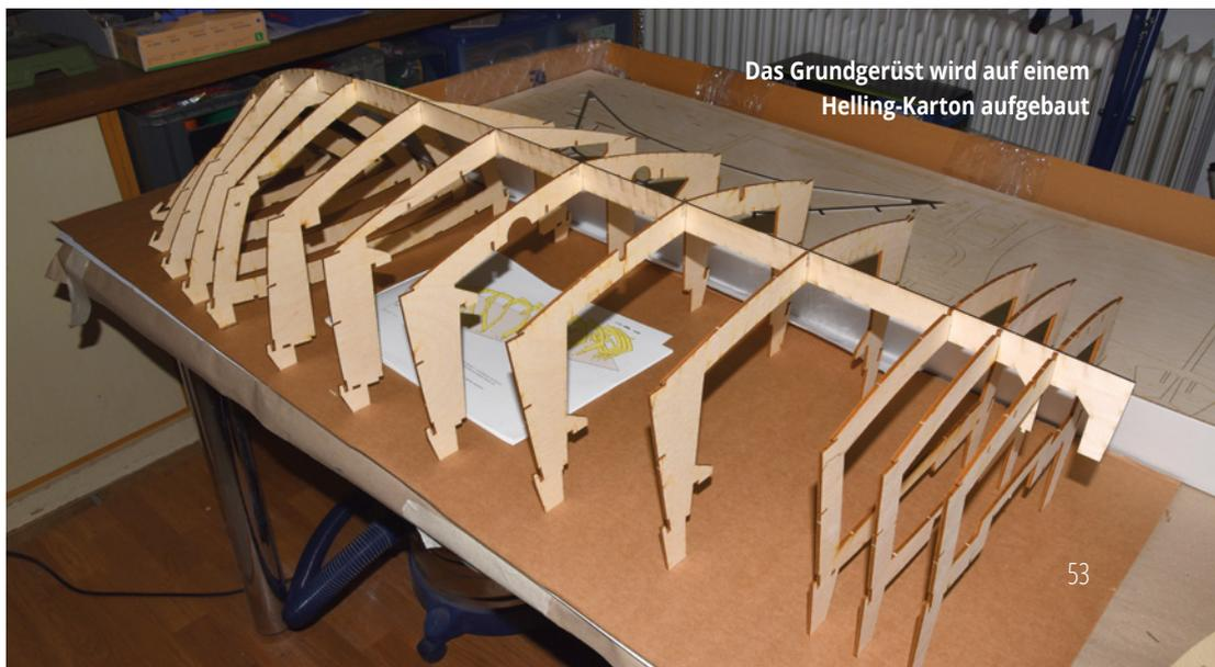
Das Grundgerüst wird auf einem Helling-Karton aufgebaut
