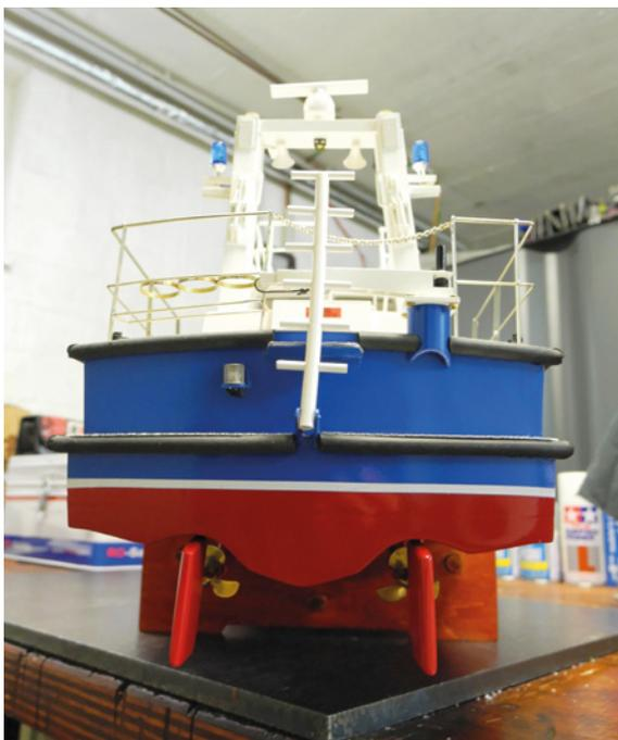
Heckansicht mit dem versetzten Antriebsstrang, der für guten Geradeauslauf des Bootes sorgt
