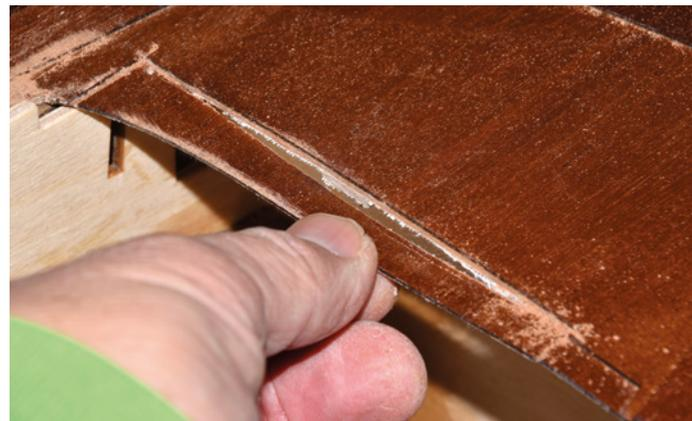
An der Beplankung des Armaturenbretts musste ich noch einen Streifen entfernen, sonst passt der zugehörige Spant nicht
