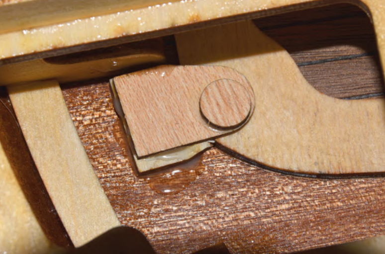
Das Anbringen der Magnete für den Rumpfdeckel hinten erfordert Sorgfalt
