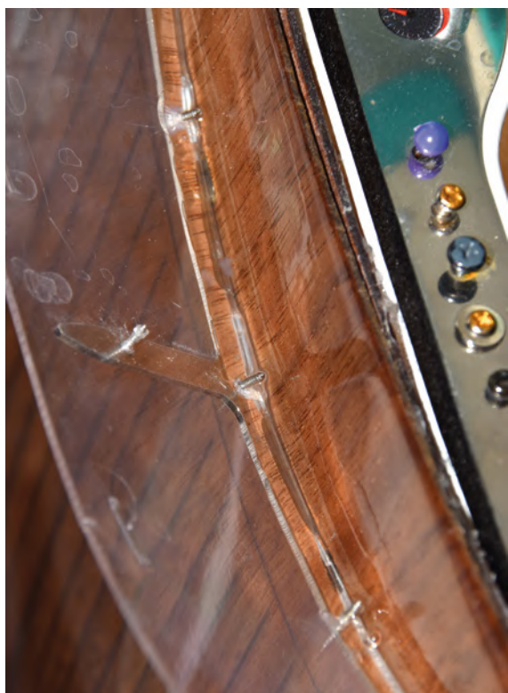
Die Frontscheibe habe ich mit UhuPor abgedichtet
