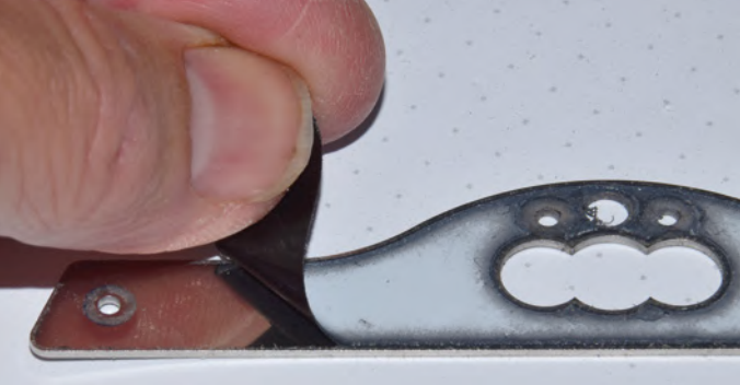
Das Armaturenbrett muss noch von seiner Schutzfolie befreit werden
