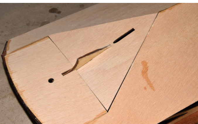
Der Rest der Bepunktung wird passgenau eingeklebt. Viel muss man da nicht schleifen, denn es passt alles recht gut
