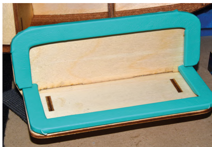
Mit etwas Geschick kann man die Rahmen des Sitzes und das hintere Armaturenbrett fast nahtlos beziehen
