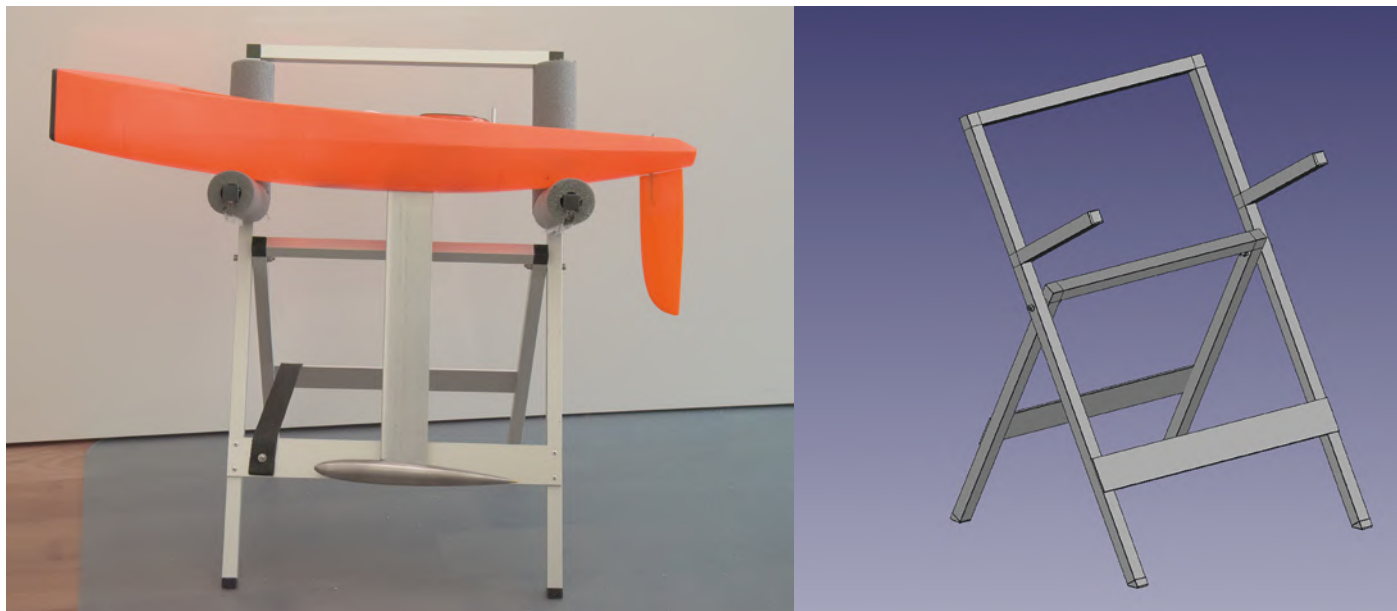
Abb. 1: Der Bootsständer entstand im Wesentlichen aus 15×15-mm 2 -Aluminium-Vierkanthrohr. Füße und Winkelverbinder sind aus TPU gedruckt. Die T-Verbinder für die Auflager sind aus PETG. TPU hatte sich unter der Last schon nach wenigen Tagen dauerhaft verformt
