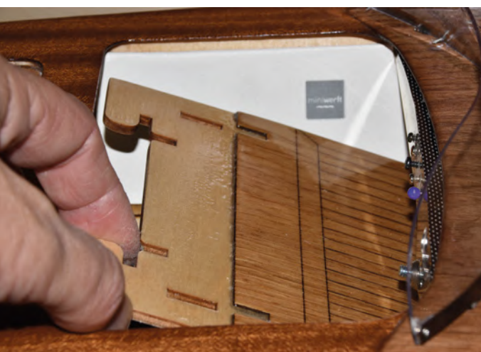
Das Innendeck wird danach eingesetzt und verriegelt. Die Sitzbank habe ich später darauf verklebt. Zum Entnehmen von Deck und Bank muss dann allerdings das Steuerrad vorher abgenommen werden
