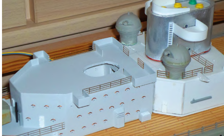
Die Aufbauten entstanden aus Polystyrolplatten
