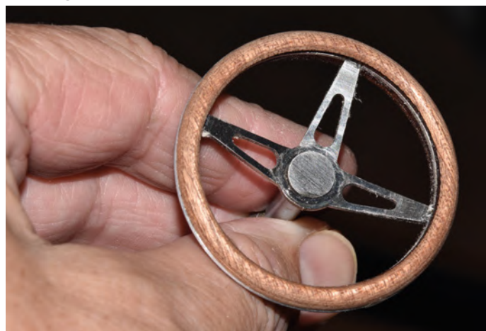
Das fertig verschliffene Steuerrad. Jetzt wird lackiert
