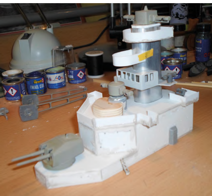
Brückenturm, Schornsteine und die Masten wurden aus Alu- und Messingrohren gefertigt
