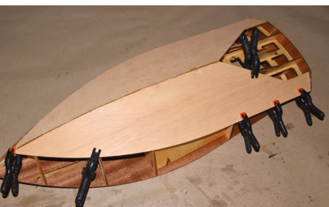
Die untere Bepunktung wird aufgebracht. Mit Klammern kann man sie gut fixieren
