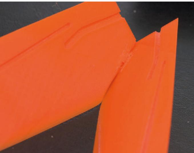
**Abb. 14:** Ethylacetat verschweißt PETG –ein Tropfen genügt. Außerdem zeigt das Bild die beim Druck erzeugten Aussparungen für Ruderwelle und Verstärkung
