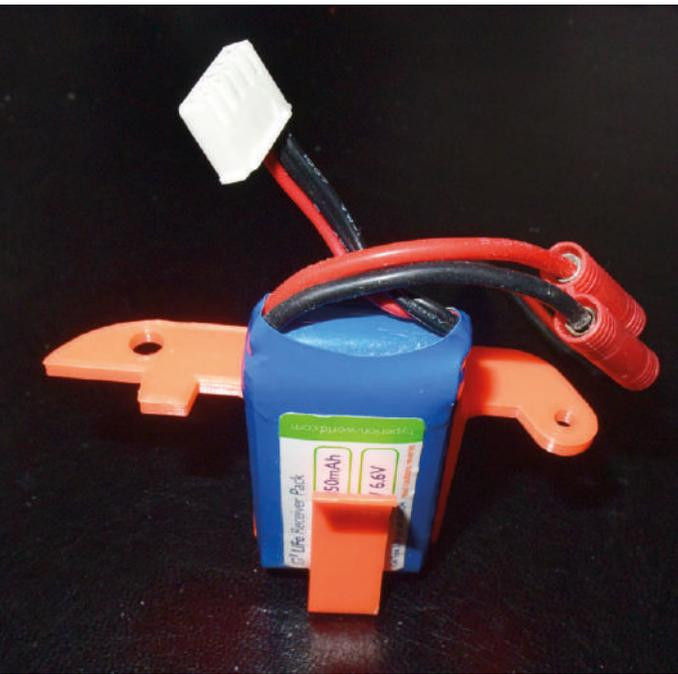
**Abb. 20:** Die Akkuhalterung, die gleichzeitig auch die Lagerung für das Schottröhrchen darstellt, ist eigentlich für NiMH-Zellen gedacht
