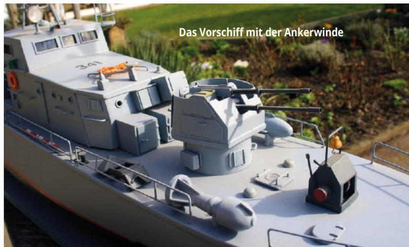
Das Vorschiff mit der Ankerwinde
