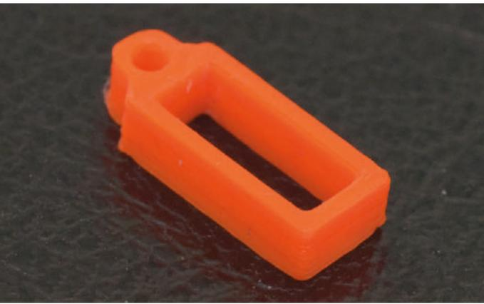
Abb. 24: Nachdem mir als Baumbänder eingesetzte Silikonschläuche schon mehrfach unter Last von den „Leinen“ aufgeschnitten wurden, habe ich erstmals auch diese Teile gedruckt
