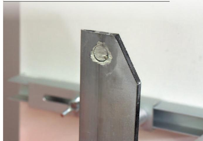
Abb. 11: Die Scheibenmutter im Kielkopf. Das Gewinde geht von oben nach unten durch. Die durch das Ausklinken entstandenen offenen Profilkanten sind mit gedruckten Abdeckleisten verschlossen
