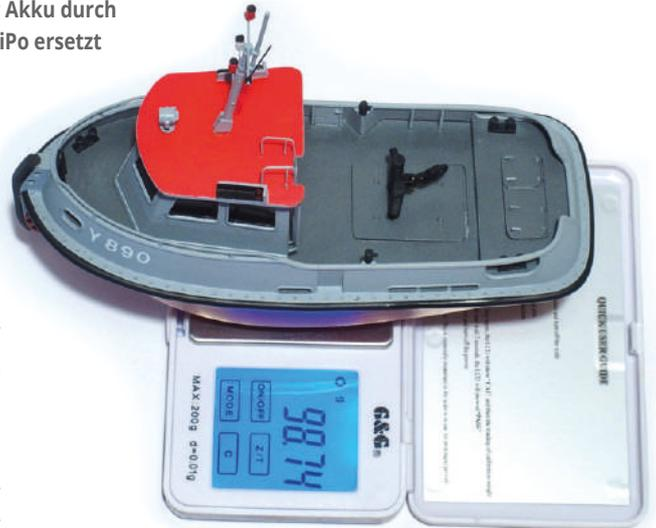
Erneutes Wiegen des Schleppers nach dem Einbau neuer Komponenten
