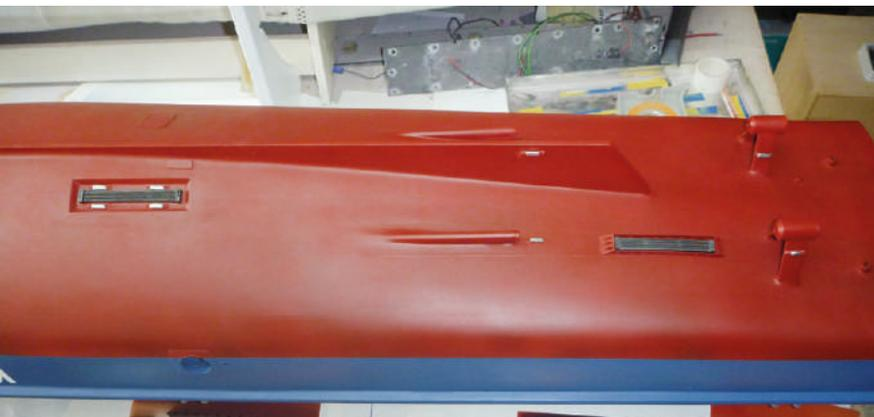
Die beiden Gridkühler, links die eingelassene Bauform, für den Hilfsdiesel; rechts aufgesetzte Bauform, für den Notdiesel
