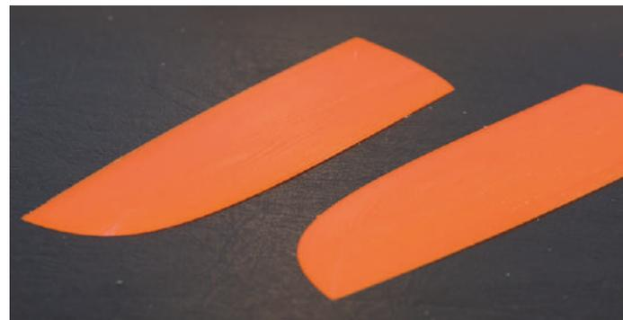
Abb. 12: Die zwei Hälften des in PETG gedruckten Ruderblatts
