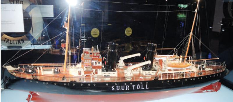
Modell der *Suur Tõll* im Meeresmuseum Lennusadam. Bauzustand um 1930. Gut erkennbar der Bugpropeller und die beiden großen Deckskräne mittschiffs.
