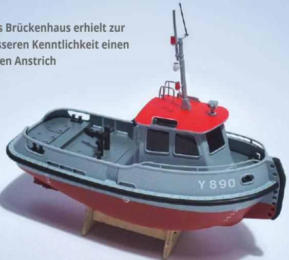
einbauen muss. Danach noch den Fender am Bug ankleben und der Rumpf ist fertig. Am Fender habe ich aber noch eine Änderung vorgenommen: der angedruckte Fender wurde abgefräst und durch einen aus Gummi ersetzt, es gibt dann keine Kratzer, wenn mal ein Schiff geschoben wird.
