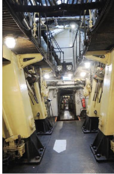
Der Maschinenraum. Blick nach vorn. Die Räume sind durch Schottwände getrennt. Man sieht in der Bildmitte eine nach oben hin geöffnete, mechanische Standkrafttür zum davor gelegenen Kesselraum hin
