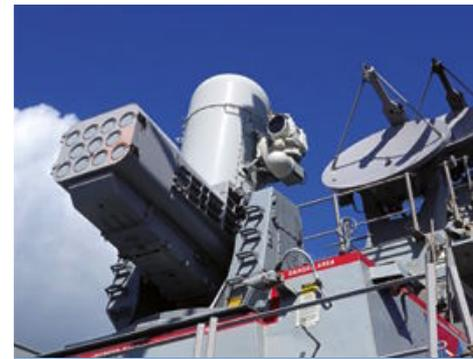
▶ Das Sea Ram an Bord der *Ross* ist eine Weiterentwicklung des Phalanx-CIWS unter Einsatz von RIM-116 Rolling Airframe Missile Lenkkraketen
