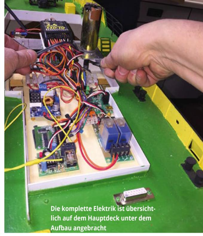
Die komplette Elektrik ist übersichtlich auf dem Hauptdeck unter dem Aufbau angebracht
