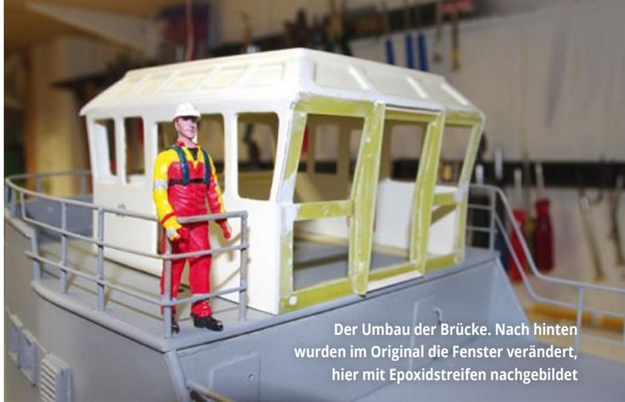
Der Umbau der Brücke. Nach hinten wurden im Original die Fenster verändert, hier mit Epoxidstreifen nachgebildet
