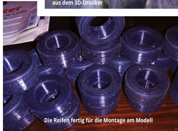
Die Reifen fertig für die Montage am Modell
