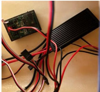
Regler und Schaltbaustein liegen anschlussfertig im Schiff
