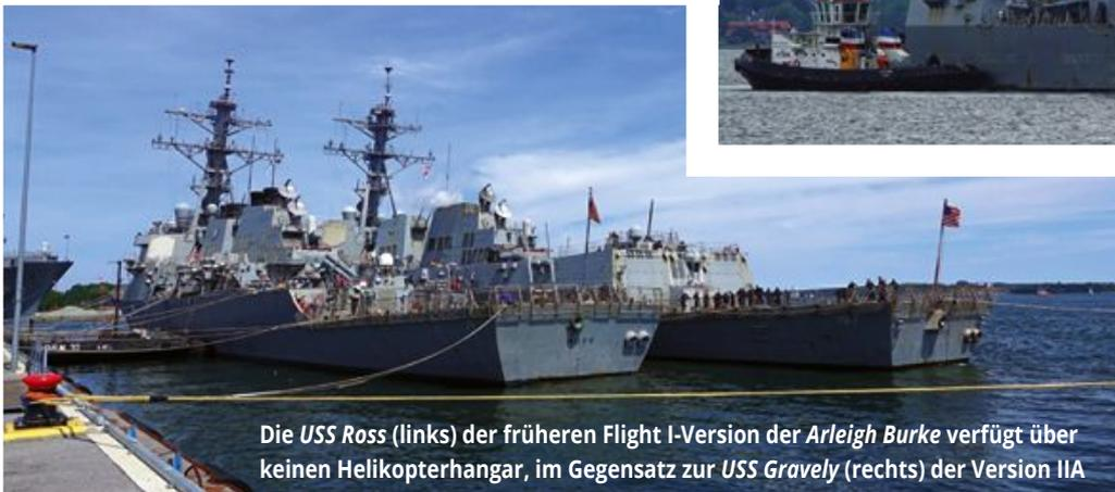
Die *USS Ross* (links) der früheren Flight I-Version der *Arleigh Burke* verfügt über keinen Helikopterhangar, im Gegensatz zur *USS Gravelly* (rechts) der Version IIA
