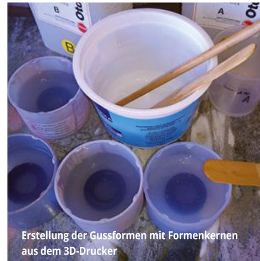
Erstellung der Gussformen mit Formkernen aus dem 3D-Drucker
