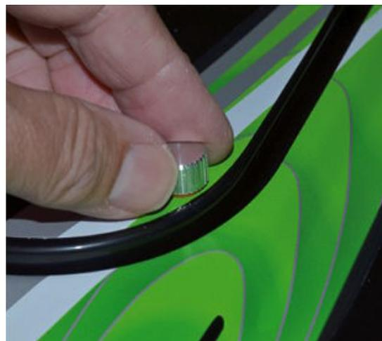
Vier solcher Rändelschrauben halten das Deck nicht nur sicher, sondern auch dicht. Es ist kein Klebeband nötig
