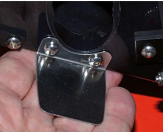
Solide befestigt und durch Zurechtbiegen verstellbar – die Trimbleche
