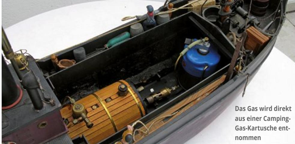
Das Gas wird direkt aus einer Camping-Gas-Kartusche entnommen
