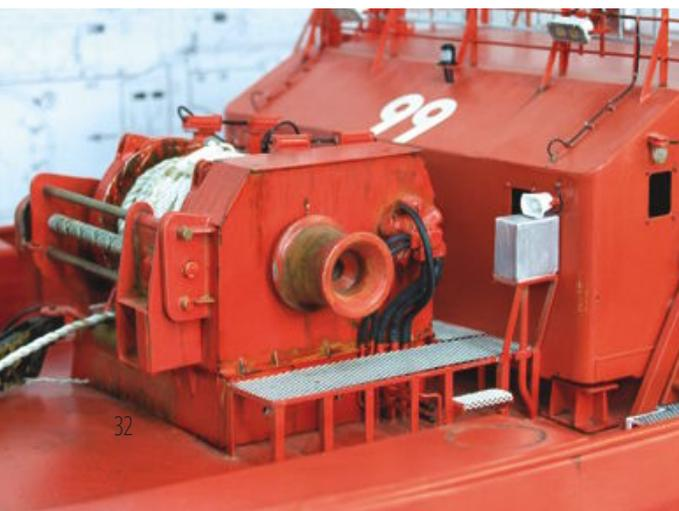
Der Rahmen ist genau so groß, dass der Sockel der Winde über diesen Rahmen passt. Die Winde wird nun beidseitig mit je zwei M3-Schrauben festgeschraubt. Um aber eine erhöhte Festigkeit dieser Schraubverbindung zu erreichen, wurden auf der Innenseite der Schraublöcher im Rahmen noch passende M3-Muttern angelötet. Diese Verbindung ist nun nur noch per Schraubendreher oder mit viel Gewalt lösbar. Für die Belastungen eines Schleppmanövers ist diese Verbindung sicher mehr als ausreichend.
