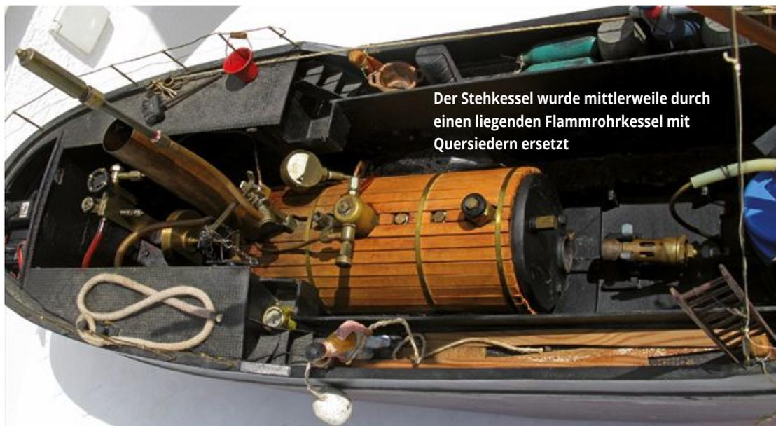
Der Stehkessel wurde mittlerweile durch einen liegenden Flammrohrkessel mit Quersiedern ersetzt
