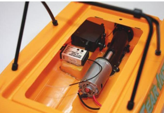
Einblick in das kleine Modell mit bereits verbautem Lenkservo und Empfänger
