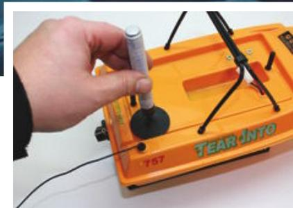
Das Anzeichnen der Decköffnung mittels rundem Servohorn
