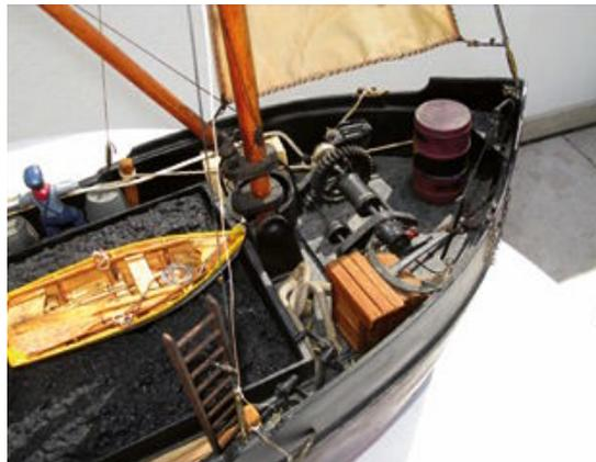
Detailaufnahme des Vorschiffs mit Ankerwinde, Beiboot und Kohleladung
