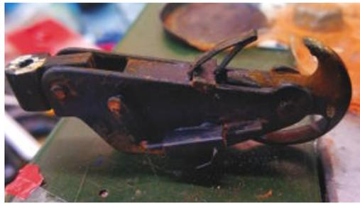
Der Schlepphaken kurz vor dem Einbau. Nagelneu und trotzdem schon völlig verrostet
