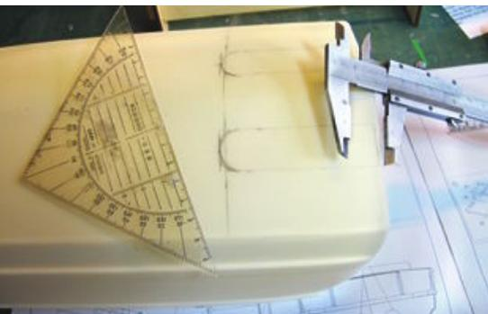
Die Öffnungen für die Jets. Anhand der Bauanleitung müssen alle relevanten Maße auf der Rumpfschale exakt markiert werden
