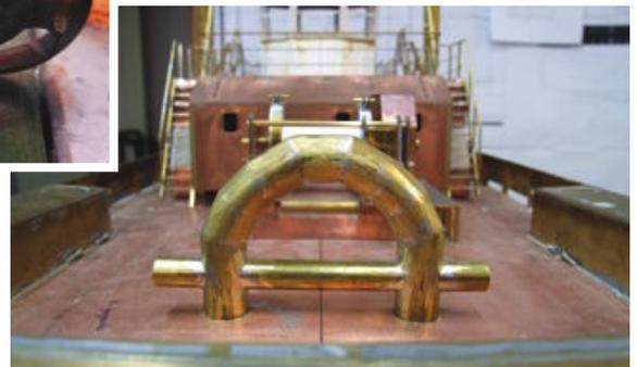
Der Schleppbock aus Messingrohr mit den gut sichtbaren Segmenten
