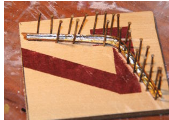
Der Heckkran entsteht in der Lehre mit Nägeln
