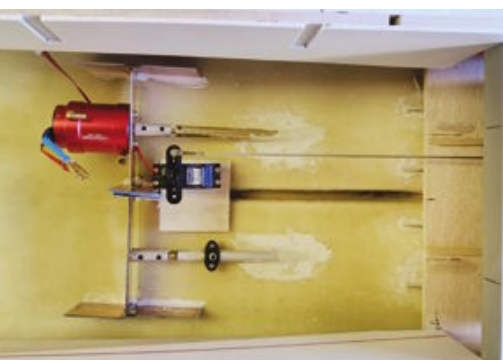
Stevenrohre, Ruderservo und ein montierter Motor
