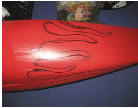
Auf der Maskierfolie wird direkt die Krackenlackierung ausgeschnitten
