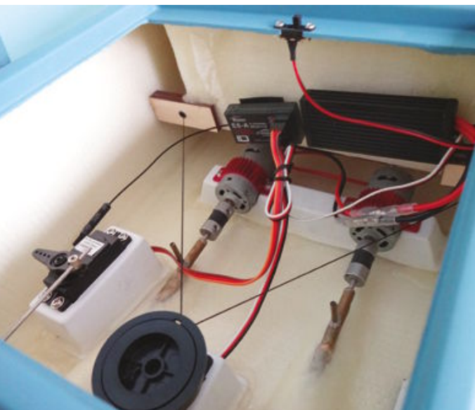
Die Technik ist bereits komplett eingebaut und verkabelt
