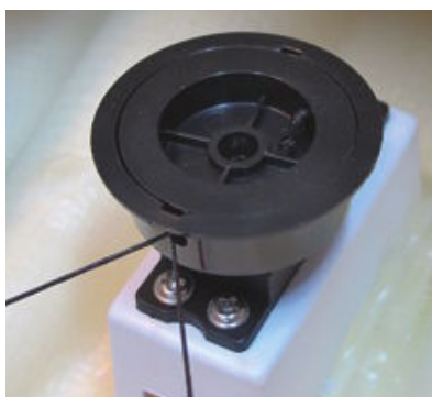
Die Bugklappenwinde dient zum Öffnen der vorderen Landungsöffnung
