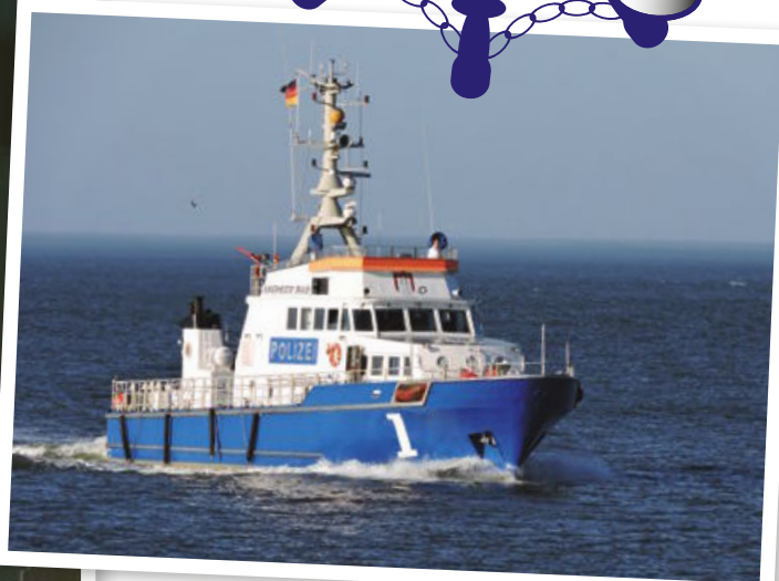
Das Polizeiboot Bürgermeister Brauer hat eine Länge von 29,5 m, eine Breite von 6,4 m und einen Tiefgang von 2,0 m. Angetrieben wird es von zwei Deutz-Motoren mit einer Leistung von je 654 kW für eine max. Geschwindigkeit von 23 Knoten. Gebaut wurde es bei der Fassmer Werft in Berne an der Weser. Die Aufnahme entstand vor Cuxhaven (Foto: Joachim Dunekacke).
