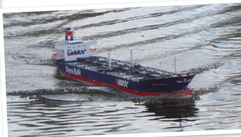
Die Stena Arctica in voller Fahrt. Das Modell ist 2,15 m lang und verdrängt gut 45 kg. Der 6-cm-Propeller und Brushless-Motor verleiht dem Schiff so viel Schub, dass die Stoppstrecke knapp 8 m beträgt. Das Modell ist ein Nachbau des DDR-Tankers Schwedt , der noch vor der Wende an Stena verchartert wurde und nach der Wiedervereinigung an Stena Line verkauft wurde (Foto: Andreas Müller, Flensburg).
