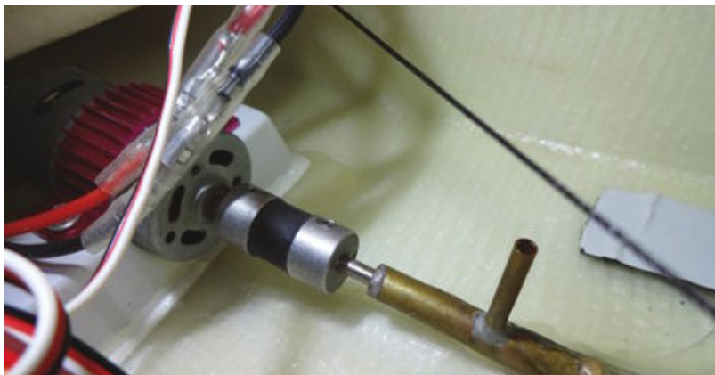
Der Motor, die Welle und die Kupplung des Landungsbootes
