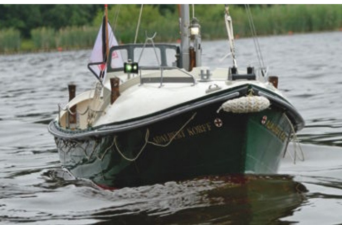
MS-Schriftzug am Bug, das Hansekreuz-Relief aus dem 3D-Drucker
