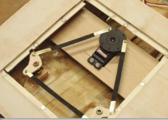
Ruderservo mit Anlenkung
