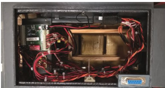
Blick in den Rumpf. Zu sehen ist das Multimodul (links), der Empfänger (oben) und der D-SUB Verbinder zum Aufbau (unten rechts). Der 12-V-Akku wird im Holzgestell platziert
