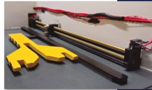
Der Spindel-antrieb des Helischlittens, noch mit offen liegenden Leitungen
