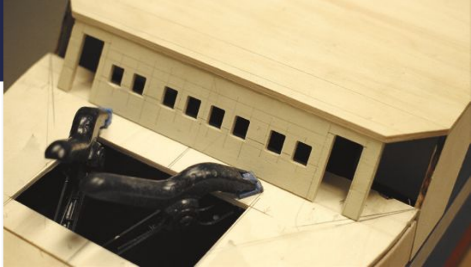
Erste Wände der Aufbauten mit ausgefrästen Fensteröffnungen
