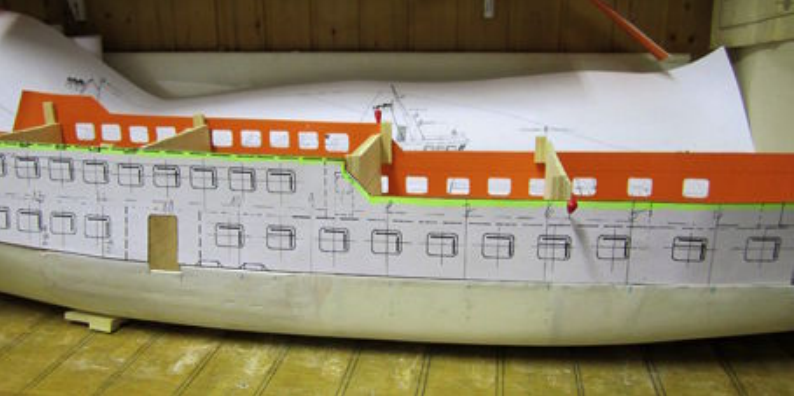
Die Schablonen für die Seitenteile sind auf dem Rumpf aufgesetzt
