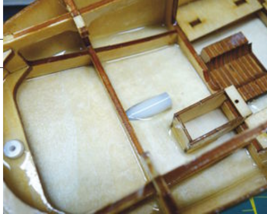
Das Rumpffinnere wurde mit Epoxid versiegelt
