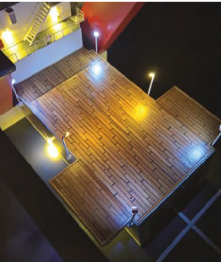
Das Arbeitsdeck besteht aus einzeln verlegten Planken
