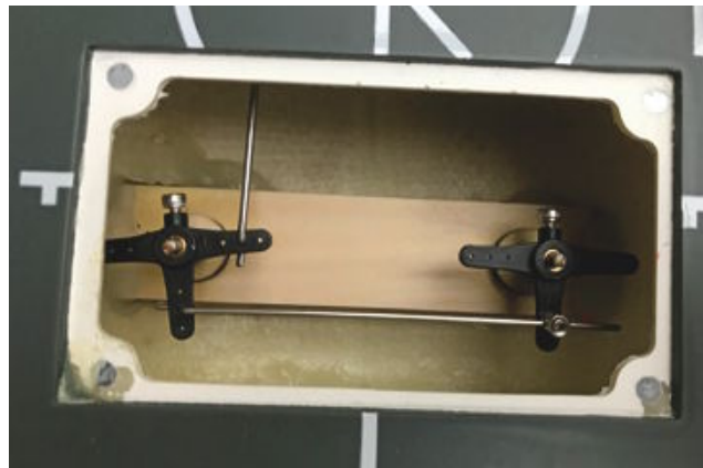
Blick in den Rumpf auf die Ruderanlenkung
