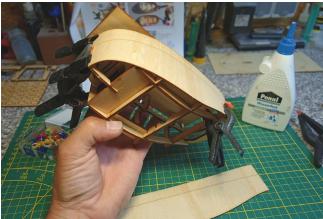
Die Außenhaut aus 1-mm-Sperrholz wird aufgeleimt
