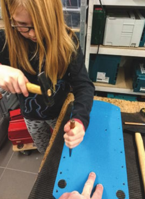
Zusätzliche Sicherung der Aufbauwände durch kleine Nägel
