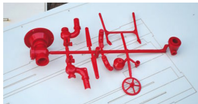
Bauteile für einen der Löschmonitore
