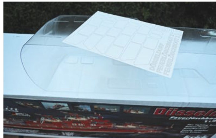
Der transparente Aufbau als Tiefziehteil, Masken aus Klebefolie für die Fenster
