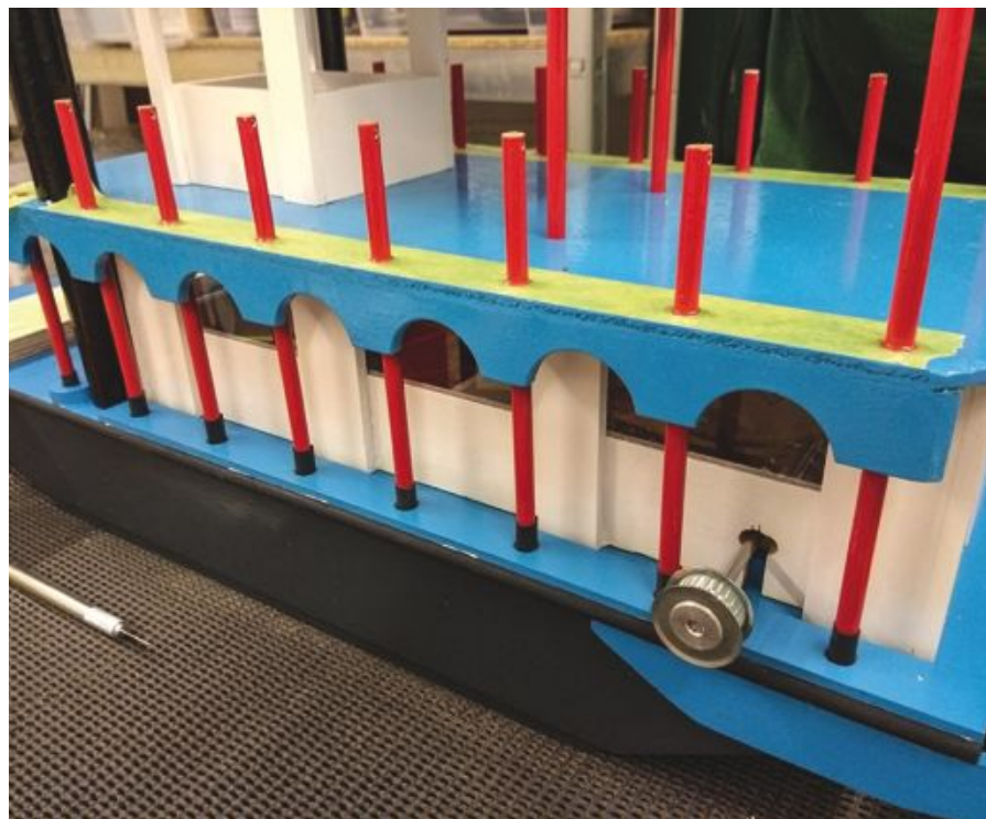
Beim Verkleben werden die Relingstützen in den Aufnahmebohrungen durch Schrumpfschlauch zentriert
