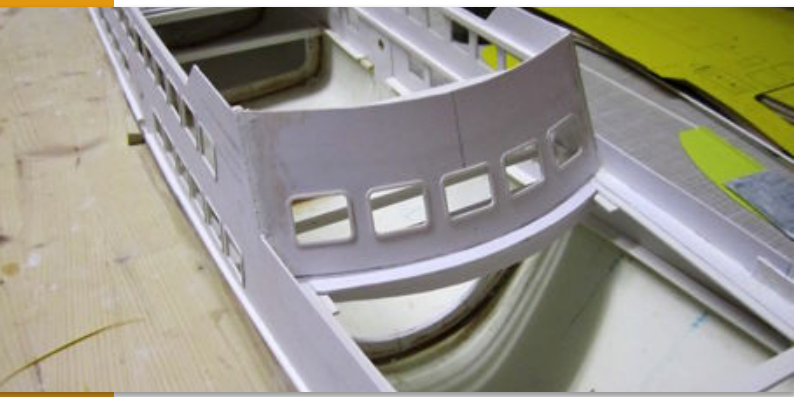
Die Seitenteile sind aufgesetzt, die Salonfront mit den Seitenteilen verbunden
