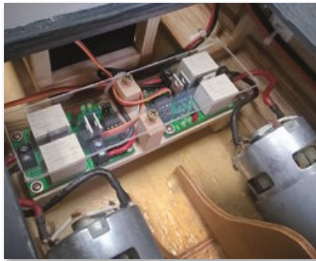
Der Spindel-antrieb des Helischlittens, noch mit offen liegenden Leitungen
