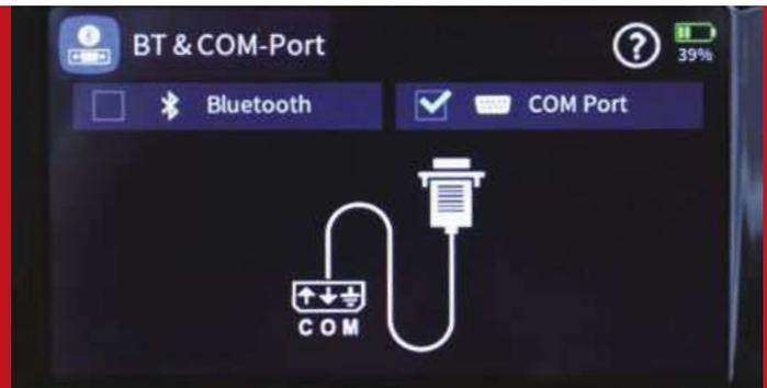
Unter dem Menüpunkt „Bluetooth“ kann sowohl eine serielle COM Port-Verbindung oder eine Bluetooth-Verbindung, z.B. zum Smartphone oder Kopfhörer, hergestellt werden.
