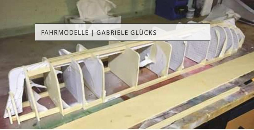
Der Rumpf ist in der Klebeband-Bauweise gefertigt worden, erstmals kam farbloses Klebeband zum Einsatz. Das Gerippe wird herausgebrochen
