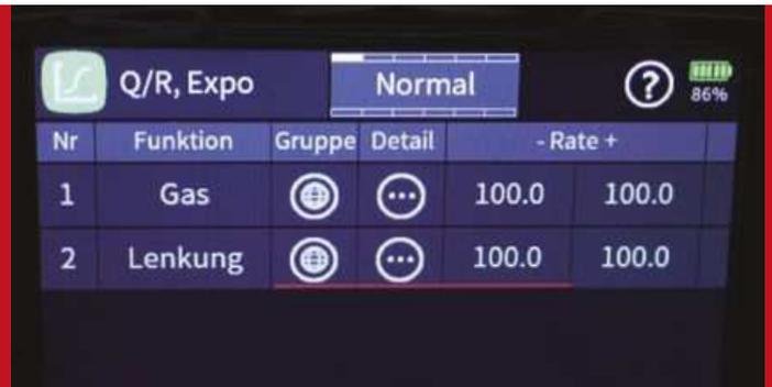
Unter Q/R Expo erfolgen die Dual-Rate- und Expo-Einstellungen. Dies kann phasenabhängig geschehen und für jede Richtung getrennt, z.B. kann für „Links“ ein größerer Expo-Wert eingestellt werden als für „Rechts“
