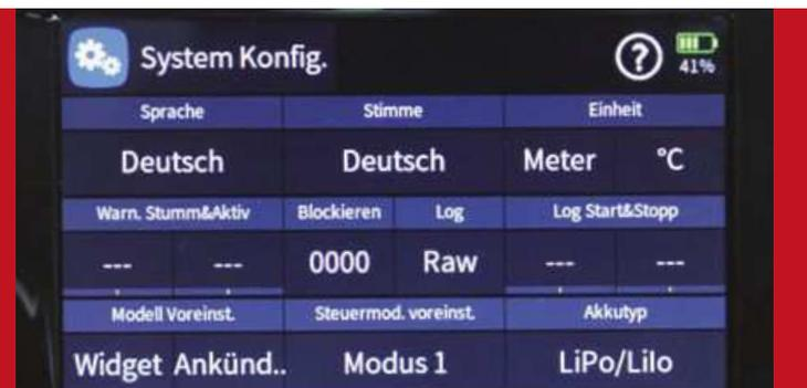
Unter System-Konfiguration erfolgt u.a. die Auswahl der Sprache, Einheiten, Akkutyp und des Steuer-Modus.
