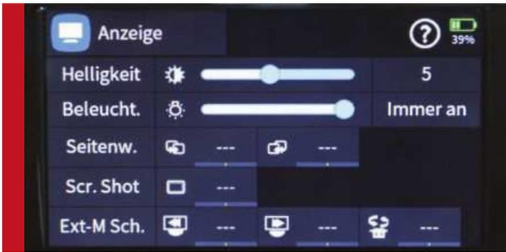
Die Einstellungen für das Display werden unter „Anzeige“ vorgenommen. Hier besteht auch die Möglichkeit, einen Screenshot vom Bild des Displays zu speichern, z.B. für eine bessere Kommunikation mit dem Service.
