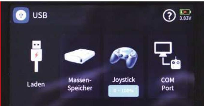
Dieses Bild wird im Display angezeigt, wenn bei eingeschaltetem Sender der Micro-USB-Anschluss mit einer USB-Stromquelle verbunden wird. An einen Computer angeschlossen, können nun Daten übertragen werden.
