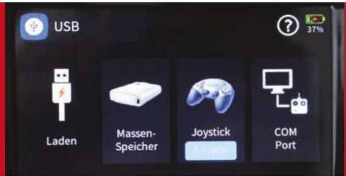
Unter „USB“ kann die USB-Funktion ausgewählt werden. Hier kann der Akku geladen, auf den Massenspeicher zugegriffen, ein Joystick angeschlossen oder der COM Port für Zusatzfunktionen aufgerufen werden.
