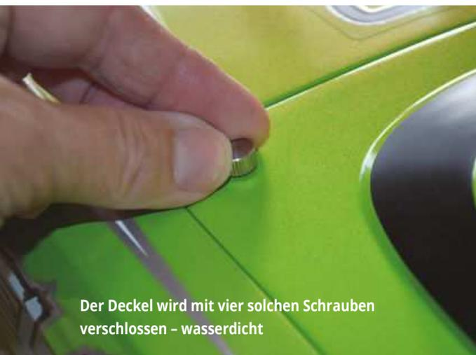
Der Deckel wird mit vier solchen Schrauben verschlossen – wasserdicht
