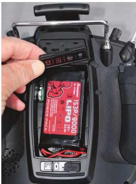
Die Rückseite mit geöffneter Akku-Klappe und abgenommenen Schutzabdeckungen. Hier finden sich der Audio-Anschluss, der DATA-Anschluss zum Anschließen einer Smart-Box, eine COM-Schnittstelle und ein DSC-Anschluss.
