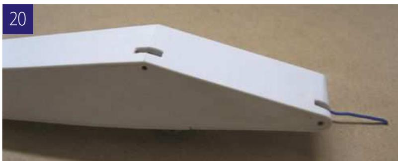
Zuleitung und eine Masseleitung der LEDs und als dritte Ader der geschaltete Pol herausgeführt. Die Umschalt-diode wird dann mittels Minirelais im Rumpf geschaltet. Somit müssen die dicken Stromkabel für die Winde nicht bis zur Auslegespitze geführt werden. Bild 21 zeigt die Kranspitze mit Seilführung und Beleuchtung.
