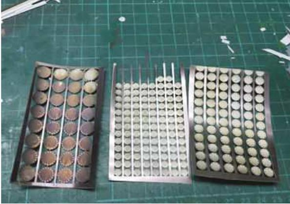
Die Flansch-Ätzteile wurden für die Saugleitungen hergestellt
