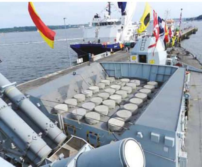
Vor der Brücke der *Monmouth* befinden sich 32 Abschussbehälter der Sea Wolf-Luftabwehrraketen, die sowohl gegen tieffliegende Seezielflugkörper als auch gegen Flugzeuge eingesetzt werden können
