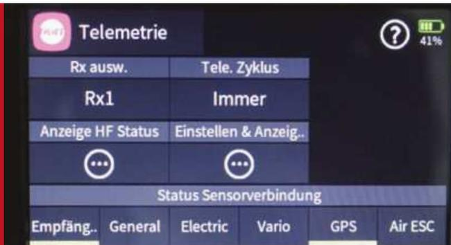
Unter Telemetrie werden die verbauten Sensoren angezeigt und ggf. derjenige Empfänger bestimmt, welcher die Telemetriedaten überträgt. Zudem kann hier die Verlangsamung des Zyklus eingestellt oder ausgeschaltet werden.
