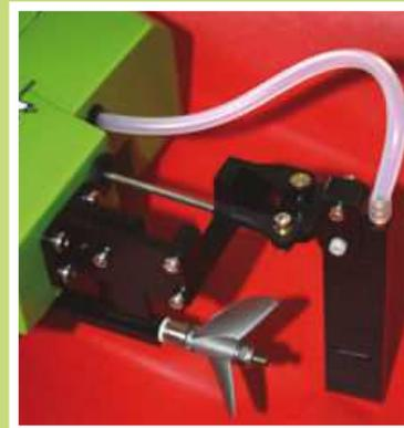
Eine sehr solide Ruderanlage zusammen mit einer ebenso soliden und verstellbaren Antriebswelle sorgt für die Übertragung der Kräfte ins Wasser. Bei 5S sind das immerhin 2,6 Kilowatt
