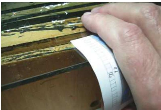
deren aber kann man große Teile über eine Tischkante ziehen, indem man sie auf dem Tisch oder einer anderen festen Auflage mit einer Hand fixiert und dann mit der anderen Hand über die Kante zieht. Oder man legt das Teil je nach Größe in eine Hand oder in beide und zieht mit der Fläche über die Kante. Bei kleineren Teilen reicht der Finger. Man kann auch eine nicht zu weiche Unterlage nehmen, das zu formende Teil darauflegen und mit einem runden Stab arbeiten.
