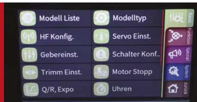
Im Basis-Menü werden die Grundeinstellungen eines Modells vorgenommen. Hier erfolgt die Auswahl eines Modells aus der Modellliste, in welcher bis zu 999 Modelle gespeichert werden können.
