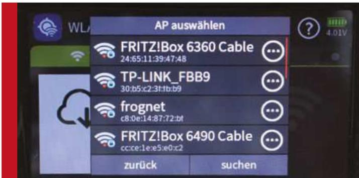
Wird der Button „WLAN“ angeklickt, wird die Umgebung auf vorhandene WLAN-Netze gescannt und diese angezeigt. Mit diesen kann der Sender verbunden werden, sofern die Berechtigung dazu vorliegt.
