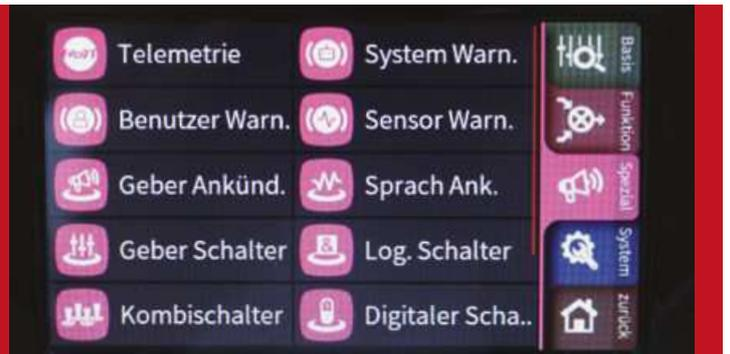
Im Spezial-Menü erfolgt die Auswahl und Einstellen aller benötigten Schalter, der verschiedenen Warnhinweise, der Ankündigungen und der Telemetriefunktionen.
