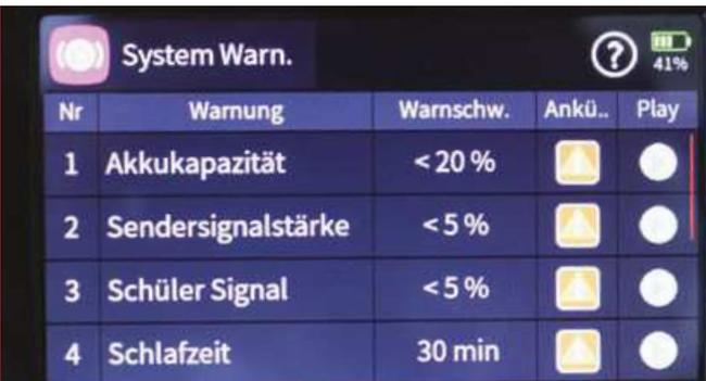
Die mz-32 verfügt über zahlreiche Warneinstellungen, unterteilt in „Systemwarnungen“ (im Bild) und „Benutzerwarnungen“. Hier sind jeweils zuweisbare und konfigurierbare Warnungen wählbar. Jeder Warnmeldung kann eine Warnschwelle, Alarmton, Vibrationsalarm und die Ansage des Wertes zugeordnet werden.
