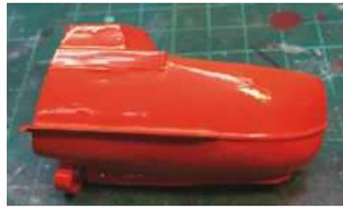
Das Freifallrettungsboot entstand auf Grundlage eines Spantenplans aus einem Internetforum
