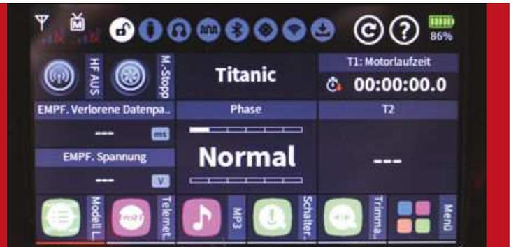
Das Hauptdisplay stellt eine Fülle an Informationen an Daten und Betriebszuständen bereit. Die Hintergrundbeleuchtung ist zum „Stromsparen“ in ihrer Dauer in mehreren Stufen bis hin zur Dauerfunktion einstellbar.
