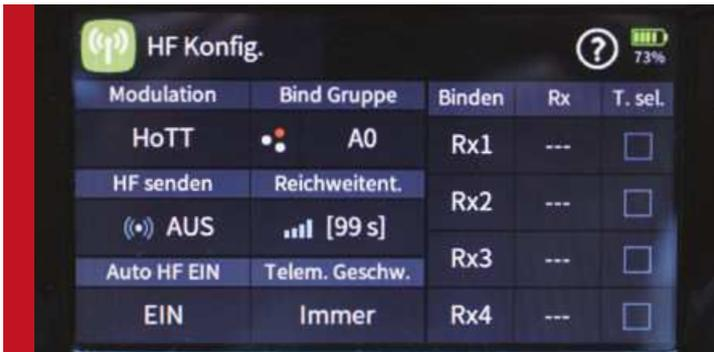
Das Binden eines Empfängers kann im Rahmen einer Bindungsgruppe (Bind Gruppe) für bis zu vier Empfänger oder global erfolgen. Global bedeutet, dass derselbe Empfänger später auch in einem weiteren Modell gebunden werden kann. Gruppen-spezifisch gebundene Empfänger reagieren dagegen nur auf die Signale der ihrer Bindungsgruppe zugeordneten Modellspeicher.
