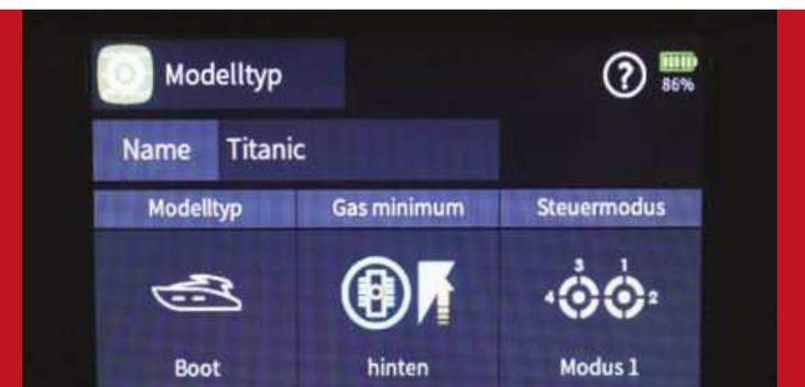
Unter Modelltyp stehen fünf verschiedene Modelltypen für Boote, Flugmodelle, Helikopter, Multicopter und Fahrzeuge zur Auswahl. Für jeden Modelltyp werden spezielle Untermenüs angeboten.
