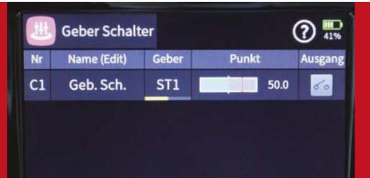
Unter Geberschalter kann ein Geber zur Auslösung einer Funktion eingestellt werden, z.B. der Start der Stoppuhr für die Motorlaufzeit durch den Gasknüppel. Hier sind nahezu alle erdenklichen Kombinationen möglich.
