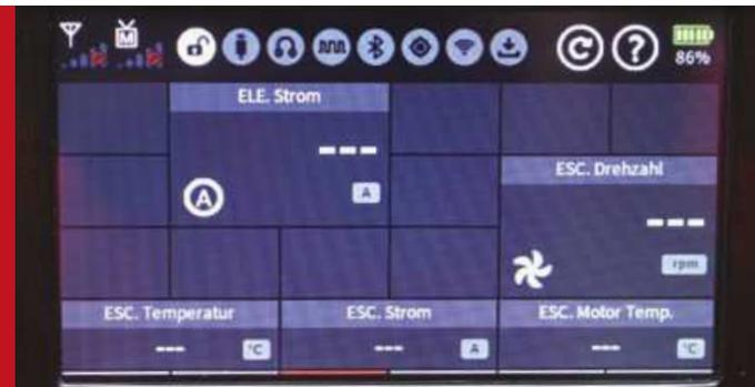
... wird nach dem Bestätigen dieses Menü als „Widget“ am Bildschirm dargestellt. In der gezeigten Darstellung wurde die dritte Seite mit Widgets zur Antriebsüberwachung eines Elektromodells gestaltet, in diesem Fall für den Motorstrom.
