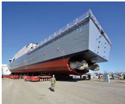
Die USS Indianapolis (LCS-17) wird am 30. März 2018 aus der Produktionshalle gezogen. Man erkennt das flache Unterwasserschiff, die Klappen der Heckrampe und die Austrittsöffnungen der Jets (Foto US Navy/Courtesy Marinette Marine by Val Ihde/Released)
