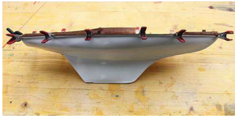
Die Klebestellen müssen über Nacht aushärten. Deck und Rumpf passen exakt aufeinander
