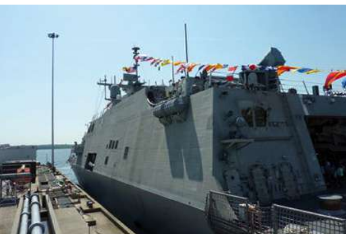
Der geknickte Rumpf in Stealth-Bauweise zur Ablenkung ankommender Radar-Strahlen ist in der Schrägsicht gut erkennbar
