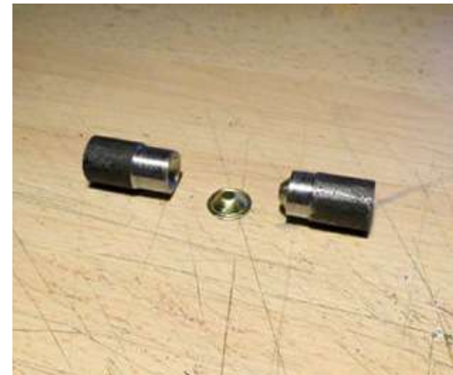
Die Düsen werden aus 3-mm-MS-Blech gefertigt
