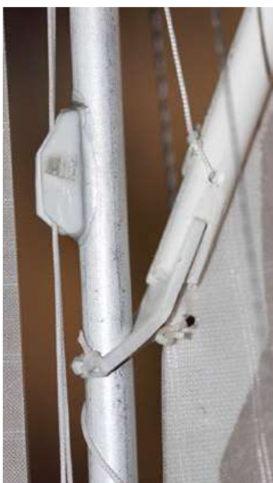
Die Gaffelklaue muss an den Gaffelbaum angeklebt werden
