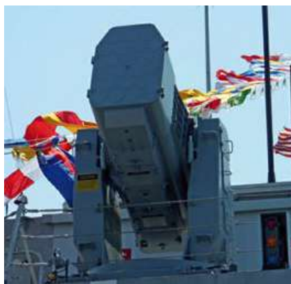
Das Nahbereichsverteidigungssystem RIM-116 RAM (Rolling Airframe Missile) mit 21 Flugkörpern dient der Abwehr von einfliegenden Seezielflugkörpern
