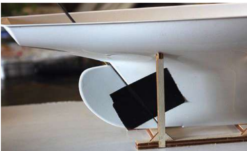
Der Ruderkoker wird eingesetzt, dazu wird das Ruder fixiert
