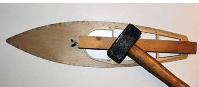
Der Deckrahmen wird auf der Unterseite verklebt
