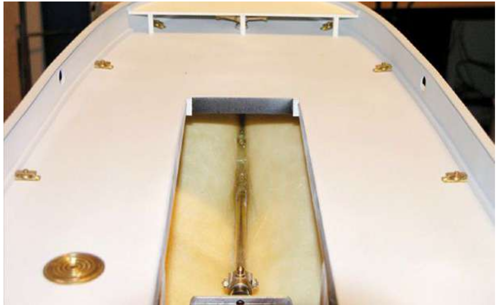
Die Welle ist eingearzt, Motorträger und Motor sind montiert
