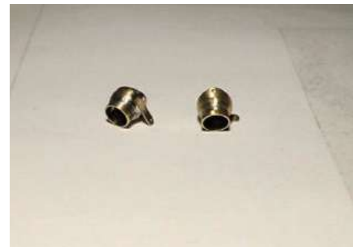
Die Lenkdüsen wurden aus jeweils drei Röhrchen hergestellt, die miteinander verlötet und verschliffen werden
