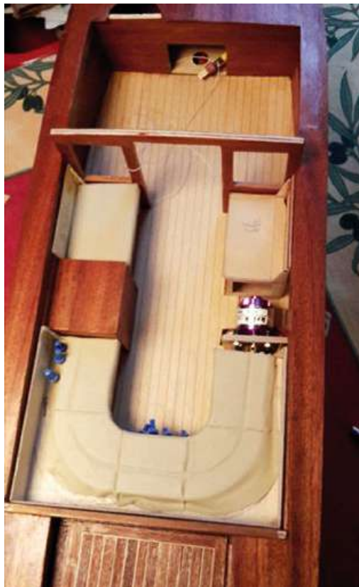
Der Innenausbau beginnt – hier ist noch die erste Version mit Batterieschacht im Vorschiff zu sehen
