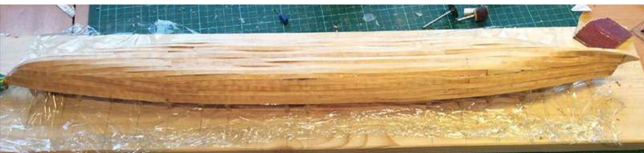
Das Modell der Liburne entstand in der „Kiel-Oben-Bauweise“. Die Beplankung erfolgte mit dünnem Furnier und danach mit Abachibrettchen
