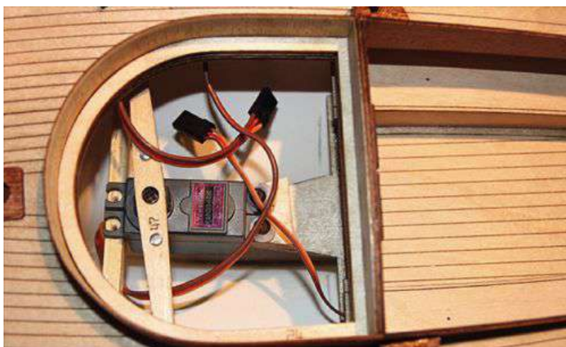
Das Segelservo kann nun an der zusätzlichen vorderen Halterung verschraubt werden
