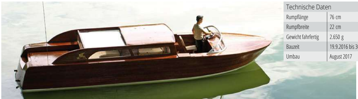
Das Boot in Fahrt nach dem erfolgten Umbau. Die Batterien aus dem Vorschiff wurden nach achtern in den Kabinen-Innenraum verlegt
