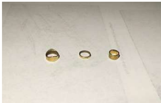
Die Lenkdüsen wurden aus jeweils drei Röhrchen hergestellt, die miteinander verlötet und verschliffen werden
