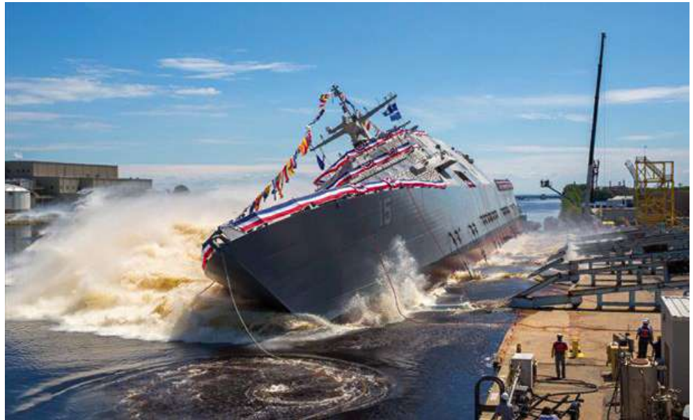
Die zukünftige USS Billings (LCS-15) wird mit einem seitlich ausgeführten Stapellauf am 01. Juli 2017 in den Menominee River in Marinette, Wisconsin zu Wasser gelassen (Foto US Navy/Courtesy Lockheed Martin/Released)
