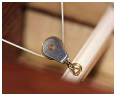
Die Umlenkrolle für die Großschot wird am Traveller angebracht
