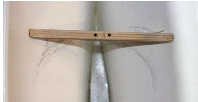
Die zusätzliche Halterung für das Segelservo ist in den Rumpf eingeklebt
