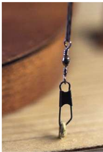
▲ Richtig eingehakt. Die kleinen Karabiner aus dem Anglerbedarf erweisen sich als hilfreich
