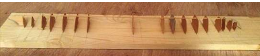
Das Modell der Liburne entstand in der „Kiel-Oben-Bauweise“. Die Beplankung erfolgte mit dünnem Furnier und danach mit Abachibrettchen
