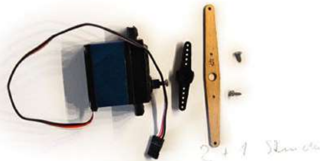
Der Arm für das Segelservo muss aufgeschraubt werden
