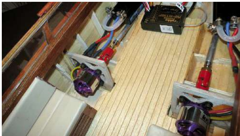
Blick auf die verbaute Boottechnik. Man erkennt das Ruderservo im Heck
