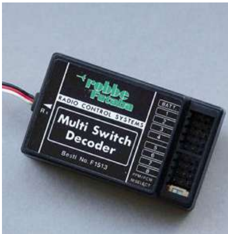
Ein gängiger Multiswitch-Decoder-Baustein. Hier ein Modul der Firma robbe Futaba
