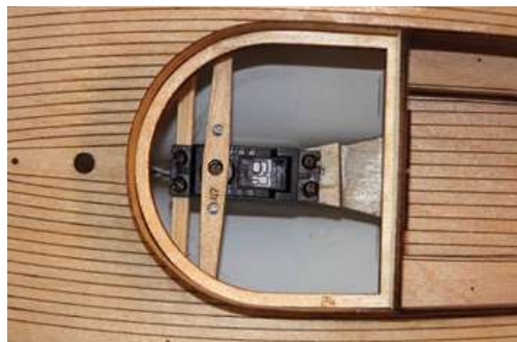
Die zusätzliche vordere Halterung für das Segelservo
