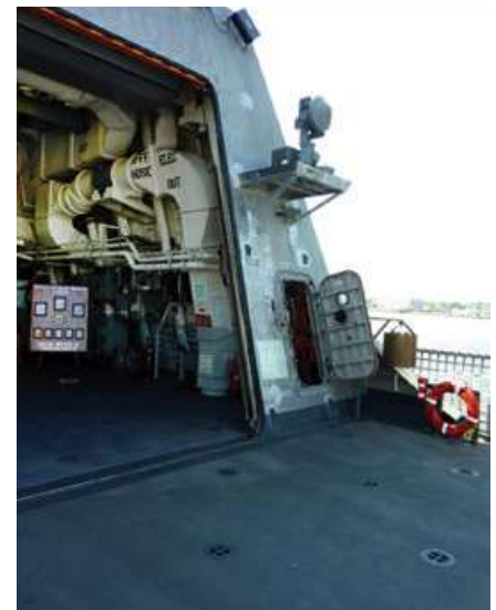
Die Aufbauten der Little Rock und ihrer Schwesterschiffe bestehen aus Aluminium
