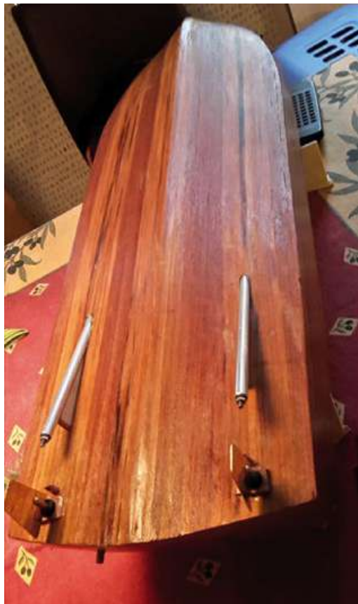
Das beplankte Unterwasserschiff
