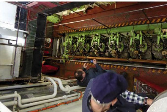
Der 8-Zylinder-Schiffsdieselmotor von Klöckner-Humboldt-Deutz aus dem Jahr 1958 wurde innerhalb von fünf Jahren komplett restauriert
