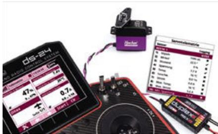
So lassen sich laut Hacker zum Beispiel fundierte Aussagen über die Ruderkräfte machen. Im Falle von langen Servokabeln hilft die Ditex-Servotelemetrie durch die Spannungsüberwachung, die richtige Entscheidung für die Verkabelung und Stecksysteme zu treffen. Um die neuen Funktionen nutzen zu können, ist das Update 4.27 für die Jeti-Duplex-Sender und die Firmware 1.10 für die Jeti-Rex-Empfänger notwendig.
