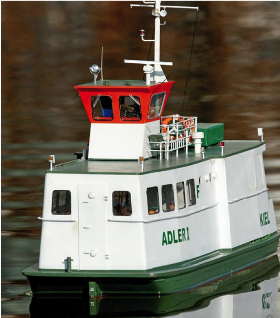
men da knapp 7 kg auf die Waage, das ist für ein 68 cm langes Modell schon eine ganz ordentliche Verdrängung, dies kommt natürlich der Fahrstabilität zugute. Denn durch den hohen Aufbau und den ganz unten liegenden Antrieb neigt das Modell wie auch das Vorbild zum Aufschaukeln.
