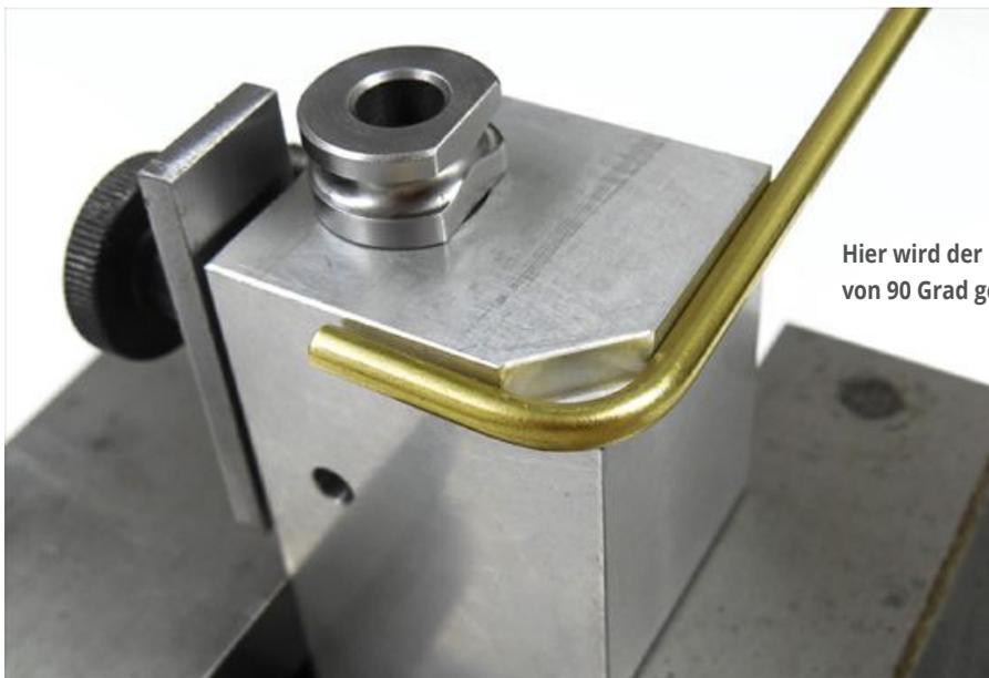
Hier wird der Bogen auf den Winkel von 90 Grad geprüft
