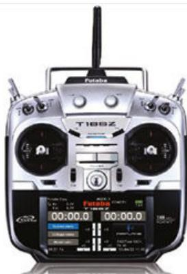
Ripmax bietet die Futaba T18SZ auch in einer **Potless-Edition** an. Da es bei dieser Technik im Gegensatz zum Knüppel mit Poti keinerlei mechanische Berührung zwischen Steuerknüppel (Magnet) und dem Signalaufnehmer (Magnetsensor) bei der Abtastung der Steuerknüppelbewegungen mehr gibt, sollen Verschleißerscheinungen der Vergangenheit angehören. UVP (inklusive R7008SB-M1- oder R7008SB-M2-Empfänger): 1.269,- €.
