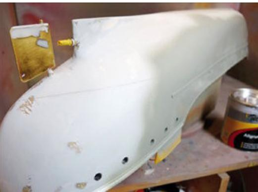
Auf den geschliffenen Rumpf kommt eine erste Schicht Primer
