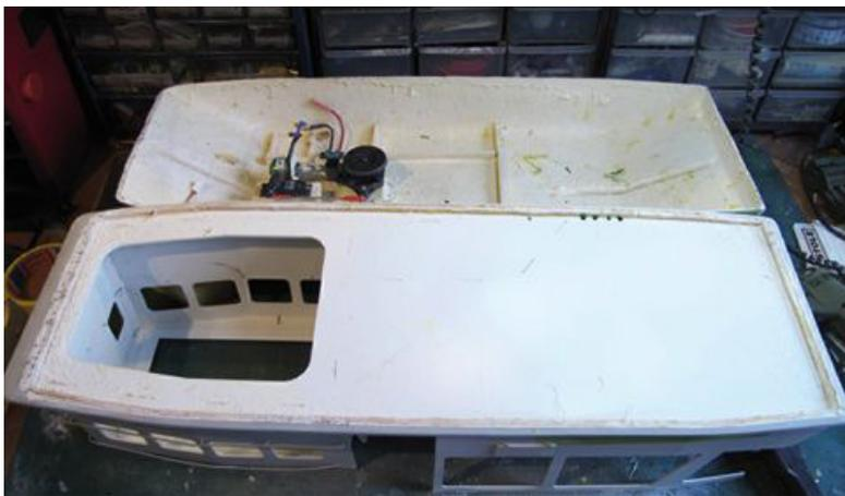
Die Trennung von Rumpf und Aufbau ist vollzogen
