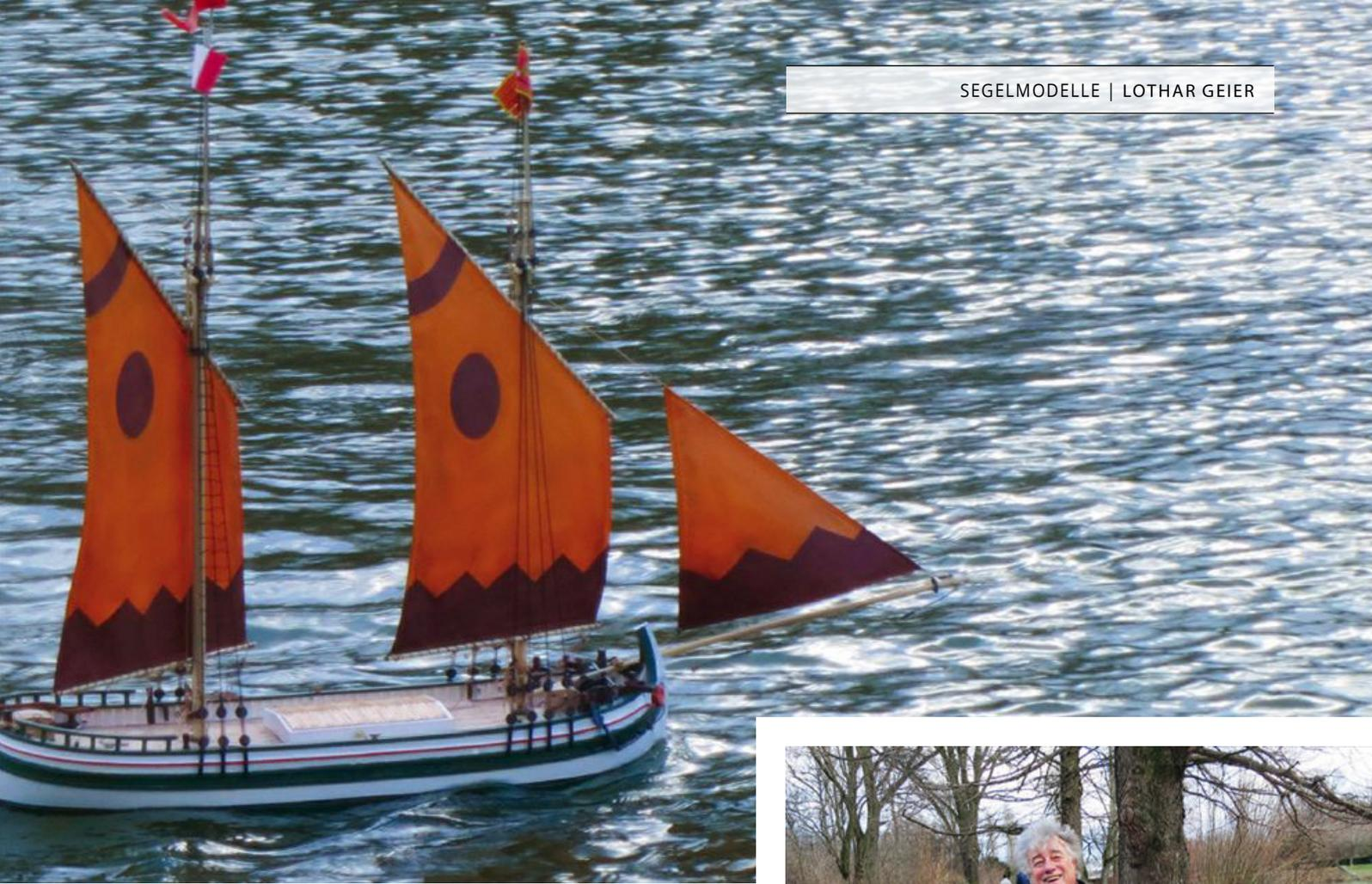
Einsätzen am Eselshaupt ein. Die beiden Masten wurden im Rumpf befestigt (im Gegensatz zu meinen anderen Modellen, die mit abnehmbaren Masten ausgestattet sind). Für die Fockschot wurde der Steven durchbohrt und ein Rohr für die Schot-
