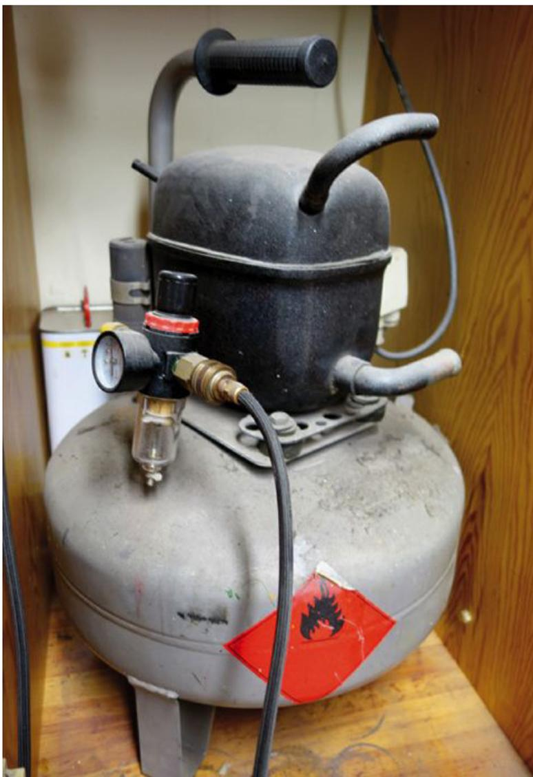
Ein Kompressor mit 150-l-Luftleistung und einer 24-l-Speicherlinse. Außerdem Öl-, Wasserabscheider und Druckreglung
