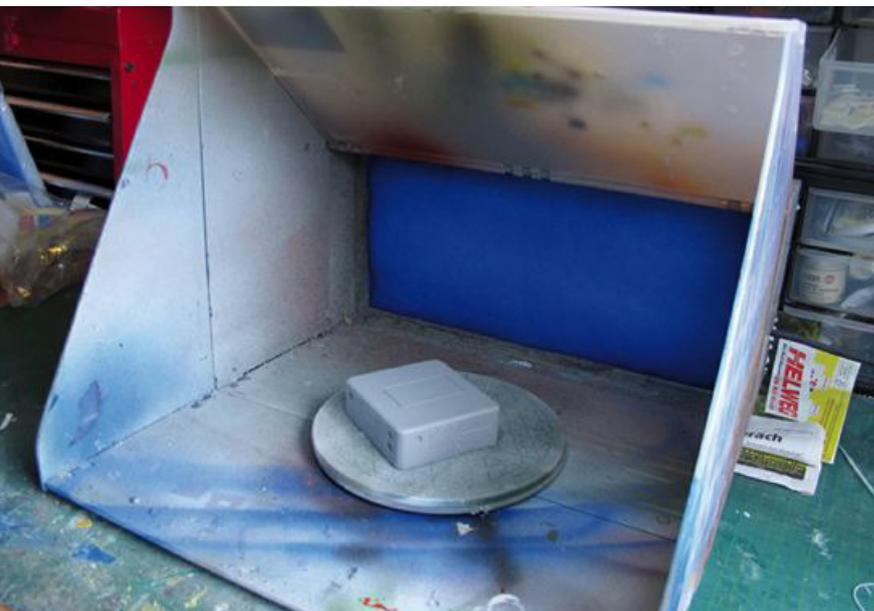
Eine einfache Tischkabine mit Filter und Absaugung der Luft durch die Rückseite
