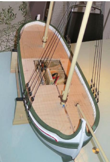
Der Deck-Unterbau in 1 mm Sperrholz
