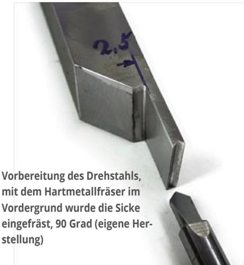
Vorbereitung des Drehstahls, mit dem Hartmetallfräser im Vordergrund wurde die Sicke eingefräst, 90 Grad (eigene Herstellung)
