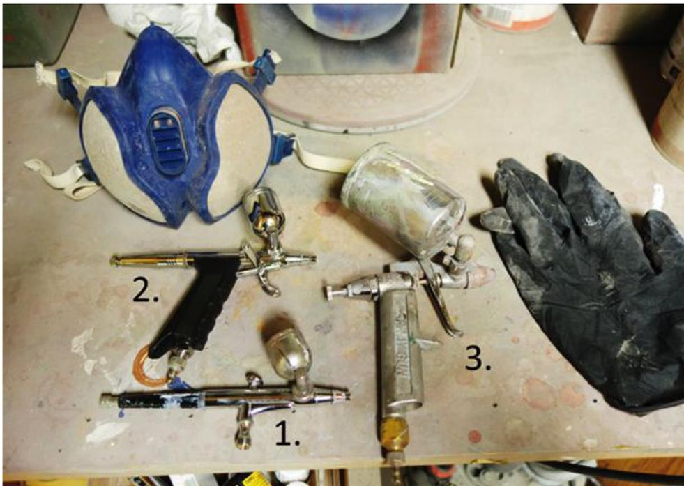
Meine Pistolen. 1. Airbrush mit 0,3 mm Düse und 4 ml Topf, 2. mittlere Airbrush mit 0,5 mm Düse und 11 ml Topf, 3. Lackiererpistole mit 0,8 mm Düse und 125 ml Topf
