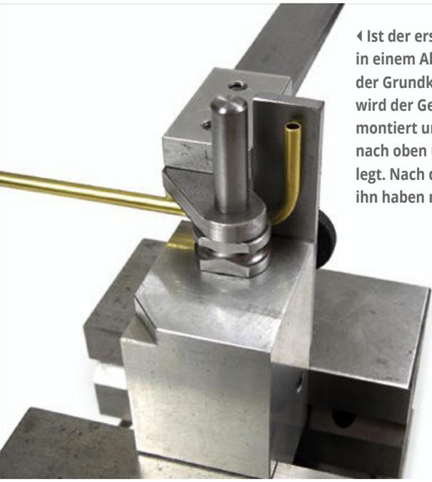
◀ Ist der erste Bogen fertig, und der nächste Rechtsbogen soll in einem Abstand von 15 mm sein, geht das nicht mehr, weil der Grundkörper zu breit ist. Damit man diesen biegen kann, wird der Gegenhalter auf die andere Seite des Grundkörpers montiert und der Biegehebel umgedreht. Nun steht der Bogen nach oben und wird an den verlängerten Gegenhalter angelegt. Nach dem Biegen hat man den Bogen genau dort wo man ihn haben möchte
