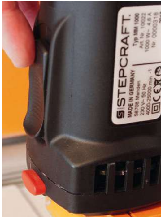
... beim Ausschalten springt der Schalter durch leichten Druck auf das hintere Ende in den Aus-Zustand
