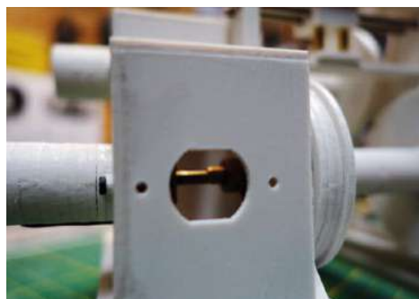
Eine der Serviceöffnungen am Getriebekasten, von hier werden die Kupplungen zwischen Motor und Wellen festgeschraubt ▶
