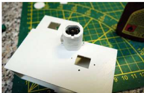
Ein wenig müssen wir noch selbst machen. Eine Aussparung fürs Kabel und die drei Löcher für den Motorhalter müssen noch selbst gebohrt werden
