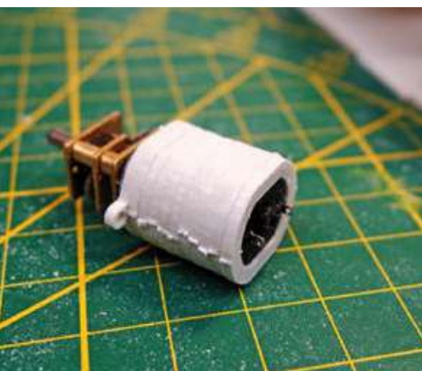
Einer der beiden Antriebsmotoren wird in die gelaserten Halteringe eingesetzt
