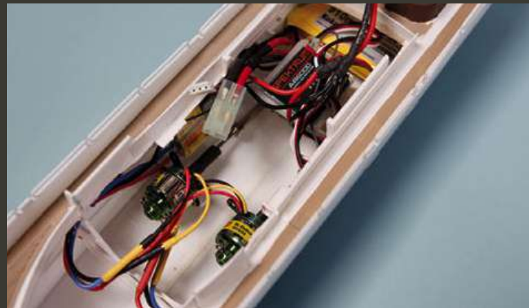
Der Einbau der RC-Technik schreitet voran. Aus dem Standmodell entsteht ein High Speed-Fahrmodell
