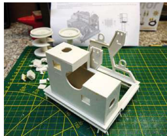
Der Getriebekasten nimmt Form an
