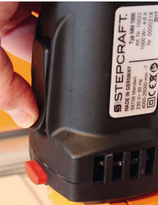
Beim Einschalten bewegt man den länglichen Schiebeschalter gegen einen Federwiderstand, ...
