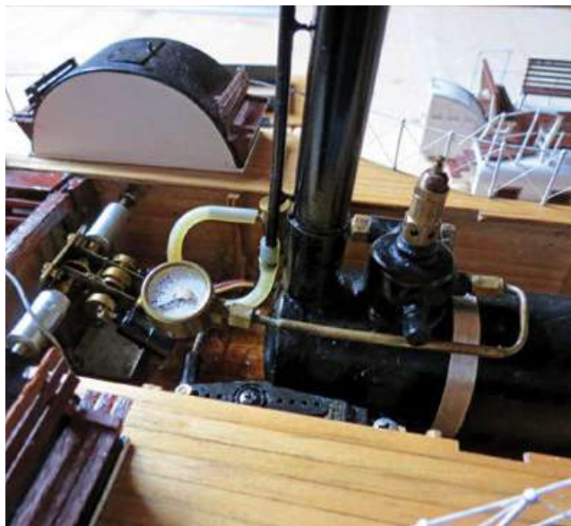
Ein kleiner Flammrohrkessel liefert genügend Dampf
