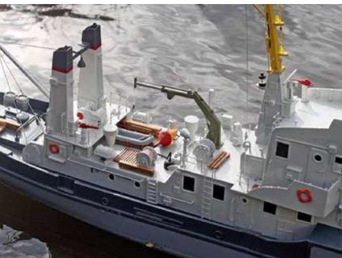
Die Hauptaufbauten basieren auf den geretteten Aufbauten des ersten Modells, die zeichnerisch vom Maßstab 1:50 auf den Maßstab 1:33 vergrößert und neu gebaut wurden
