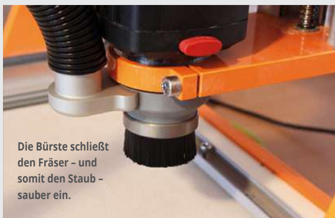
Die Topfbürste wird einfach mittels Magneten am Absaugadapter befestigt.
