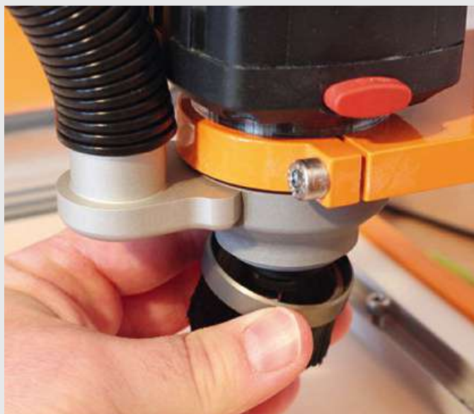
Die Topfbürste wird einfach mittels Magneten am Absaugadapter befestigt.
