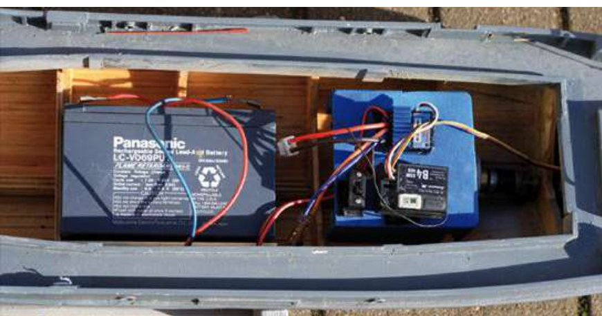
Blick auf die verbaute Technik. Das Arbeitsschiff wird von einem 6-Volt-Langsam- läufer angetrieben, der Saft kommt aus einem 6-Volt-„Bleisammler“
