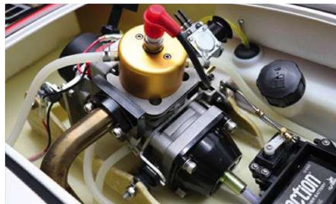
Der Zenoah 300 Pum mit Fliehkraftkupplung und Gas-Anlenkung
