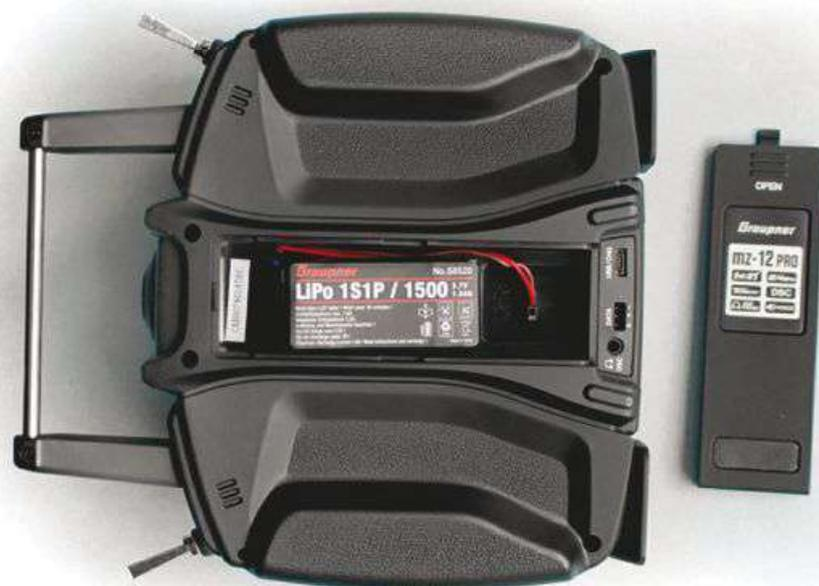
Das Akkufach wird mit einem Schiebe- deckel werk- zeugfrei geöff- net. Der LiPo ist im Liefer- umfang ent- halten
