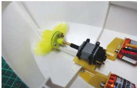
Der Bugstrahler mit Motor wurde von innen in den Rumpf geklebt
