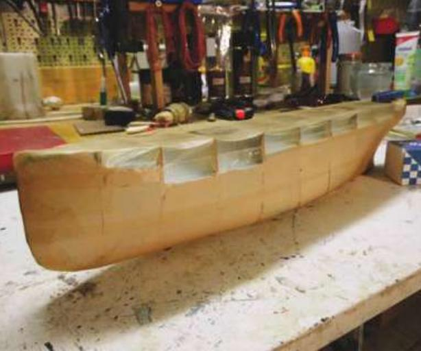
Das fertige Urmodell mit Nylonstrumpf überzogen
