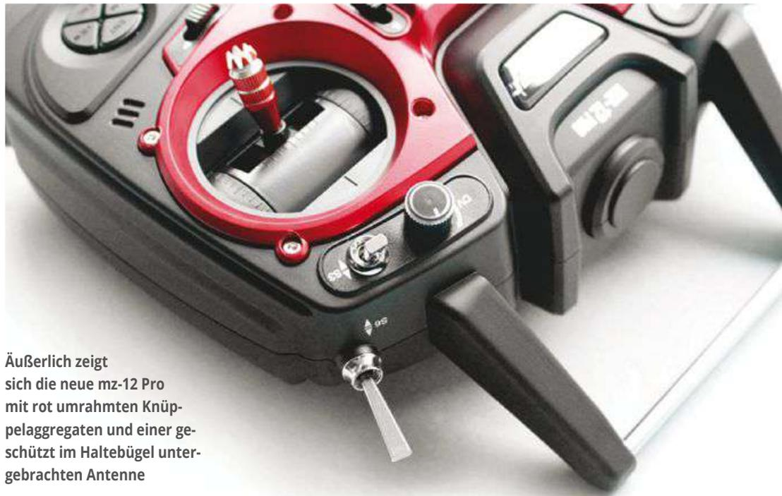
Äußerlich zeigt sich die neue mz-12 Pro mit rot umrahmten Knüppelaggregaten und einer geschützt im Haltebügel untergebrachten Antenne
