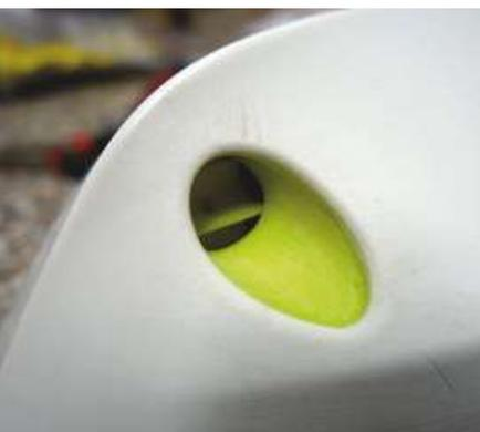
Der ausgeschnittene Fluttunnel mit den abgeschliffenen Schnittkanten
