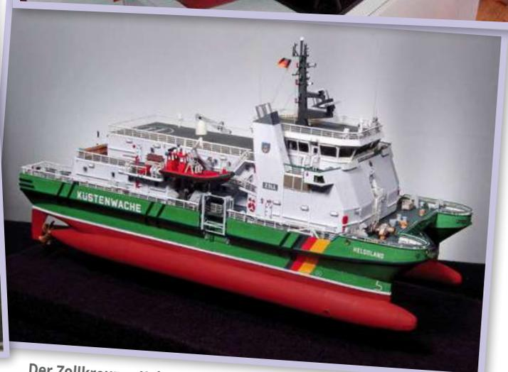
Der Zollkreuzer *Helgoland* im Maßstab 1:200 entstand auf der Grundlage des HMV-Kartonmodellbausatzes im Maßstab 1:250. Zur Verschönerung und größeren Detaillierung kamen geätzte Reling-Detaillierungssätze zur Anwendung (Foto: Hartmut Brenneis).
