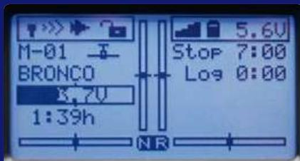
In der Grundanzeige werden Modelltyp, Modellspeicher, der Name des Modells, Uhren und die Betriebsspannung von Sender und Empfänger sowie die Stellung der Trimmhebel dargestellt
