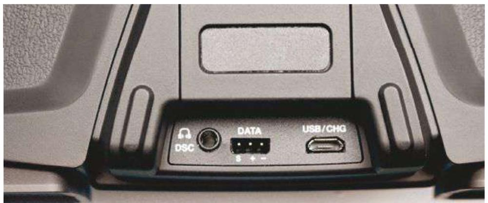
Unter dem Batteriefach befinden sich die Buchse zum Anschluss eines Kopfhörers, die DATA-Buchse für eine optionale Smart-Box und die Mikro-USB-Buchse
