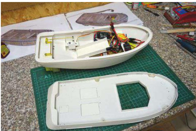
Der Rumpf ist fertig, nun kann das Deck auf den Hilfsrahmen aufgesetzt werden
