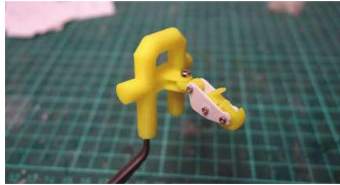
Der gedruckte und montierte Schlepphaken. Er kann per Servo unter Deck funktionsfähig gemacht werden
