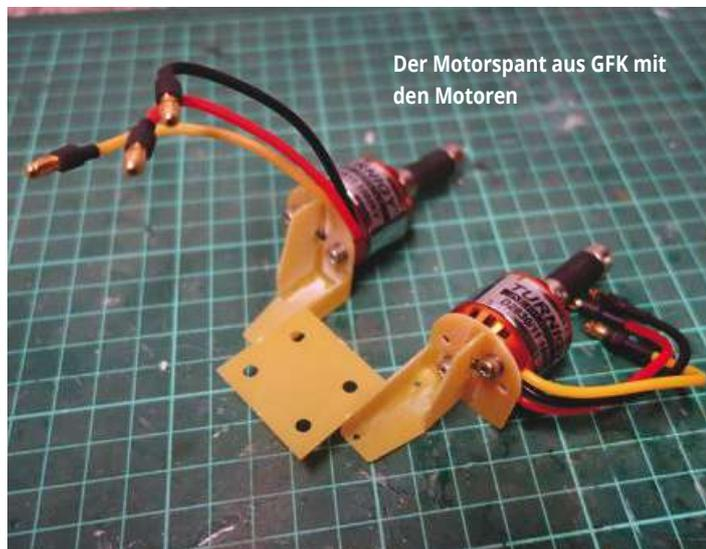
**Der Motorspant aus GFK mit den Motoren**
