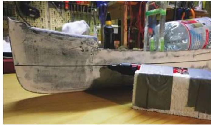
Für die Scheuerleisten wurde der Wasserpass angezeichnet
