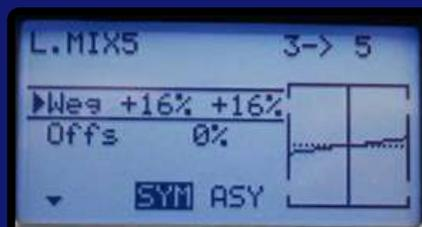
Die Einstellung der Mischer ist symmetrisch (für beide Richtungen gleich) oder unsymmetrisch möglich. Die Einstellung wird grafisch dargestellt. Die Mischerfunktionen sind per Schalter zu- oder abschaltbar
