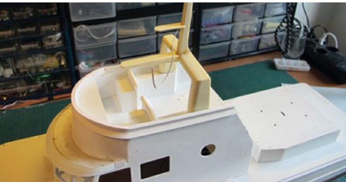
Der Mast wird in einer Stellprobe auf dem Aufbau angebracht
