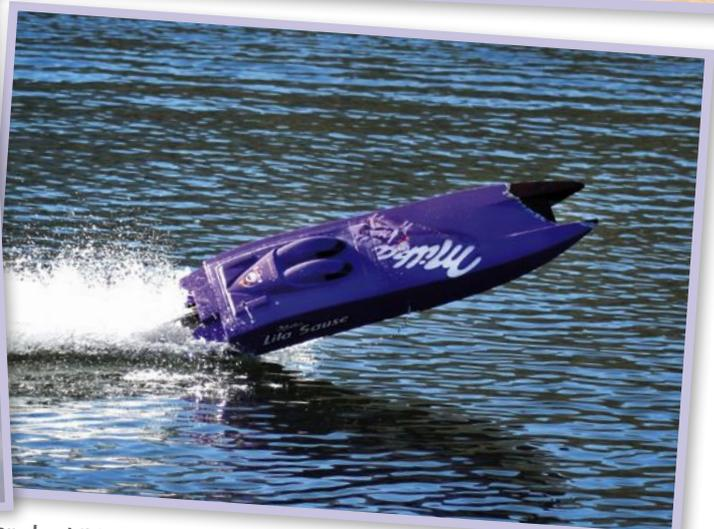
Der abgebildete Katamaran im auffälligen Lila-Schokoladendesign ist ein *Isiklar* von MHZ Zavarsky, angetrieben von einem luft-wassergekühlten Lehner-Motor 2280/8 und 2x4S-LiPos mit 5.000 mAh. Die Höchstgeschwindigkeit liegt bei 100 km/h, die Aufnahme entstand am Stubenbergsee in der Steiermark. (Foto: Paul Pinter, Riedlingsdorf/Österreich).
