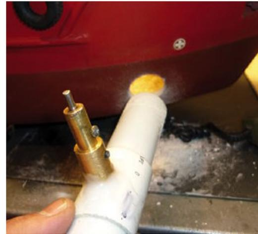
Der komplett verklebte Antrieb mit Flutkanal, bereit zum Einbau in den Rumpf
