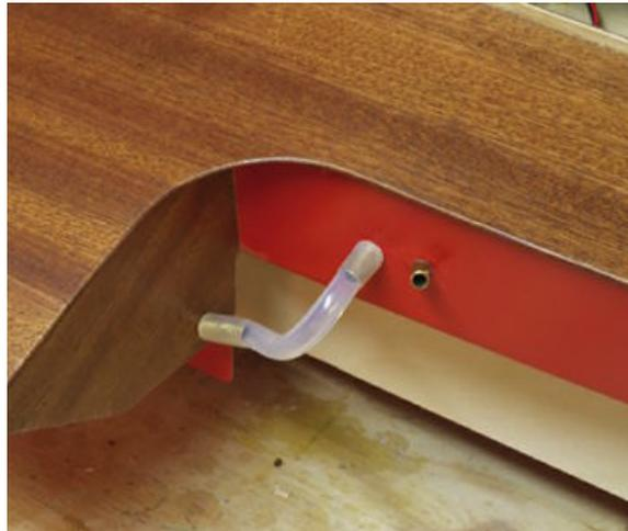
Der Kühlwasseranschluss für den Motor
