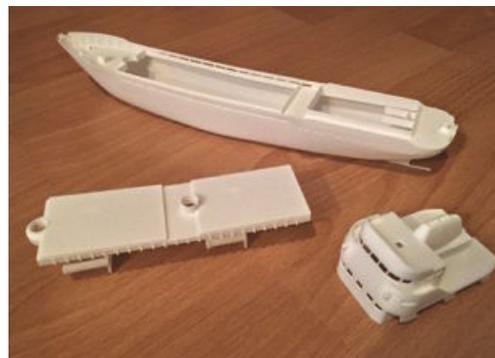
Die 3D-Druckteile des Rumpfes und des Aufbaus, noch ohne Lackierung
