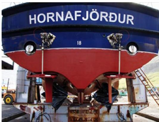
Am Heck finden sich bei einigen Aruns hydraulische Trimmklappen
