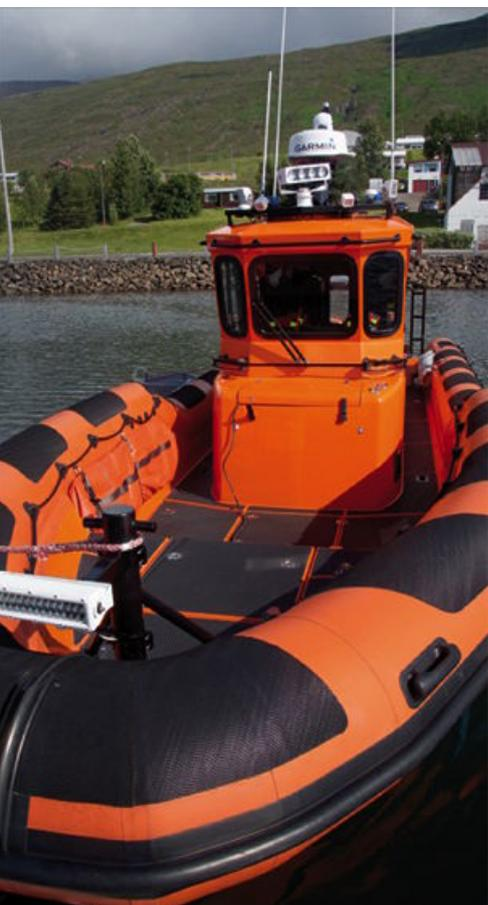
Deutlich erkennbar sind die Stufen im Deck und Schlauch der *Hafdis*
