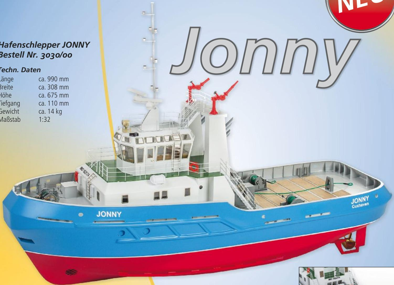
Der Bausatz dieses modernen Schleppers besteht durch sehr hochwertige Materialien und belohnt durch ein perfektes Ergebnis. Der voluminöse Rumpf wird aus GfK gefertigt, alle Positionen für Rumpfoffnungen sind angeformt. Das Modell wird mit 2 Wellenantrieben und 2 Rudern ausgeliefert, eine Kortdüse kann nachgerüstet werden. Der Antrieb ist auch mit Schottelantrieb möglich, für dessen Einbau entsprechende Spanten beiliegen.
