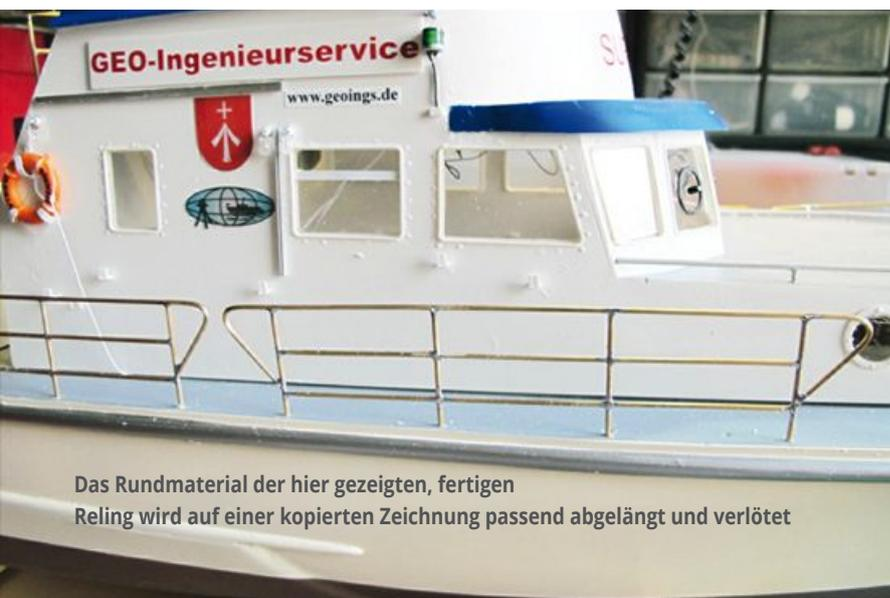
Das Rundmaterial der hier gezeigten, fertigen Reling wird auf einer kopierten Zeichnung passend abgelängt und verlötet
