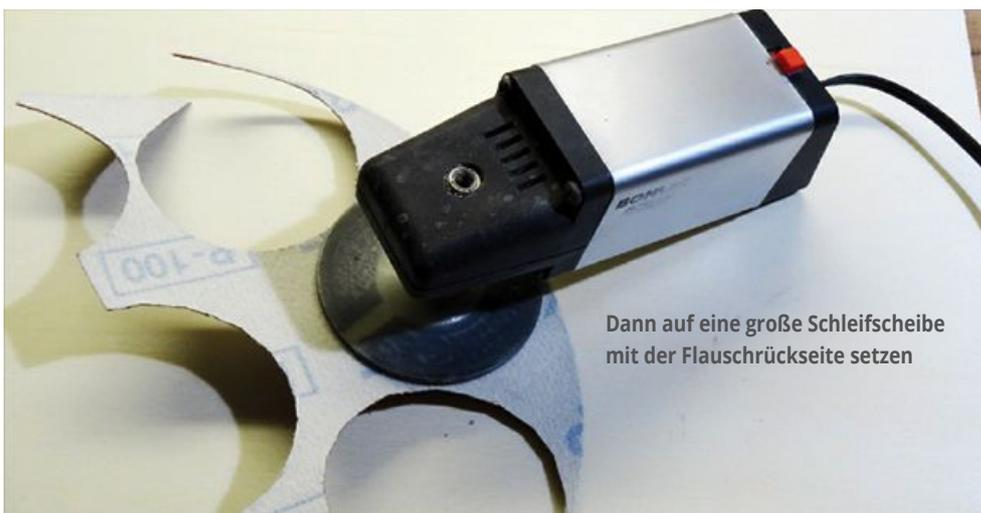
Dann auf eine große Schleifscheibe mit der Flauschrückseite setzen
