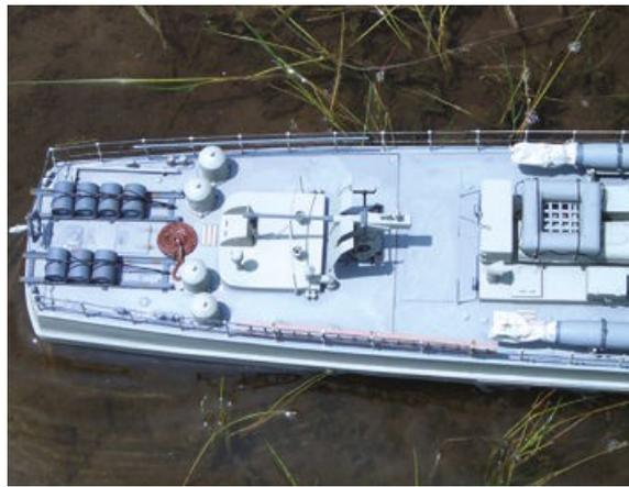
Einige der Details am Heck, darunter die Minenlegevorrichtung
