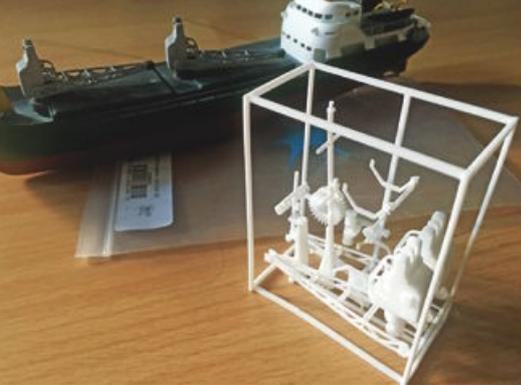
Details und Besagteile an einem Spritzling – zum Schutz der Teile beim Versand ist dieser Spritzling als „Käfig“ geformt
