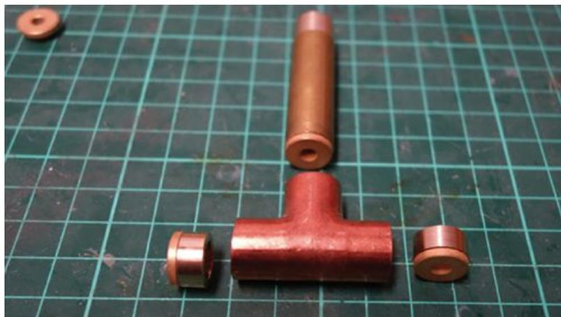
Abschnitte des Messingrohrs mit eingesetzten Sinterlagern für den unteren Wellenstrang
