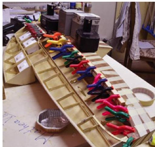
Die erste Deckshälfte wird verbaut
