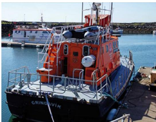
Die *Oddur V. Gislason* in Grindavík, eine 52ft-Arun mit eckigem Heckspiegel
