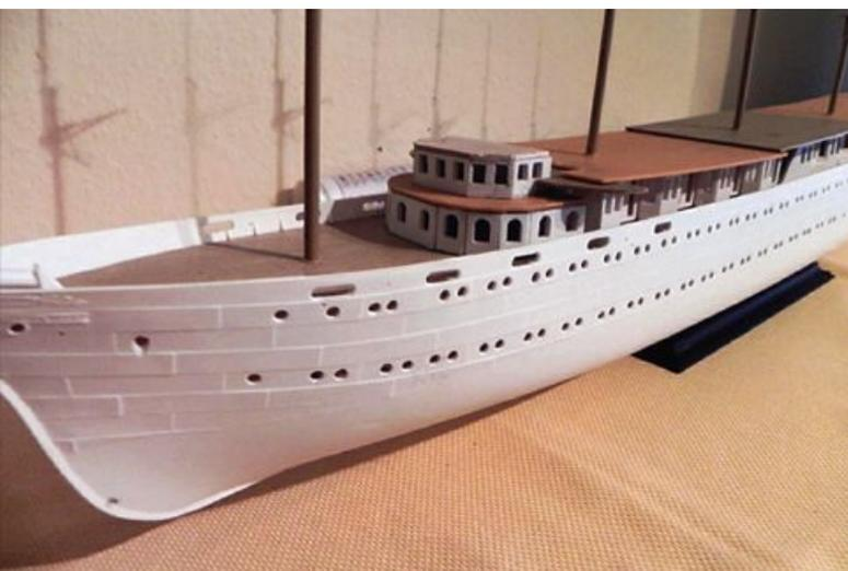
Die Decksaufbauten entstanden aus 3 mm weißem Styrol
