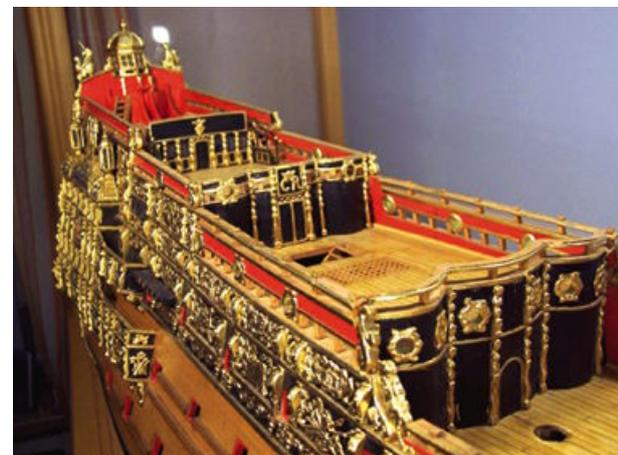
Für den Decksaufbau kam 1,5-mm-Sperrholz zum Einsatz, darauf wurden Decksplanken aus 1-mm-Ahorn angebracht
