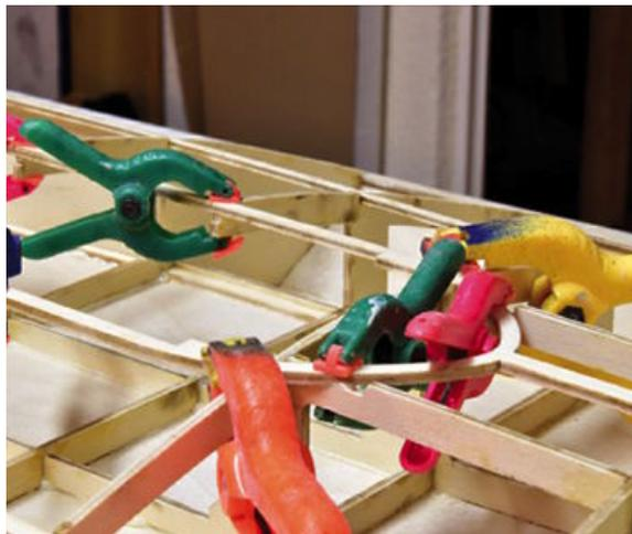
Der Einsatz des Rundspantes für das Deck und die Aussparung für den Aufbau
