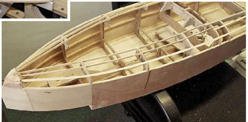
**Die Unterbeplankung im Boden- und Seitenbereich ist fertig gestellt**
