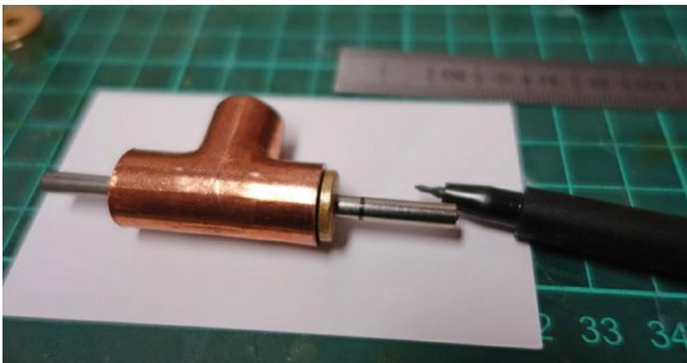
Die untere Welle wird an der Stelle angezeichnet, bis zu der das Gewinde geschnitten werden darf
