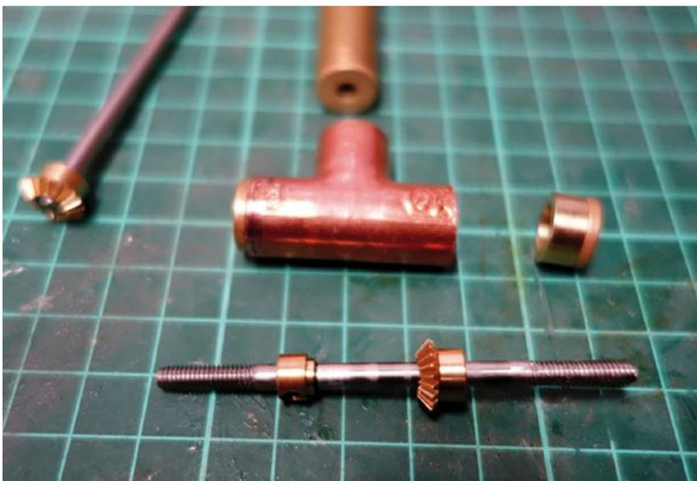
Die untere und obere Welle fertig mit Gewinde und je einem Kegelzahnrad sowie dem Stellring als Drucklager
