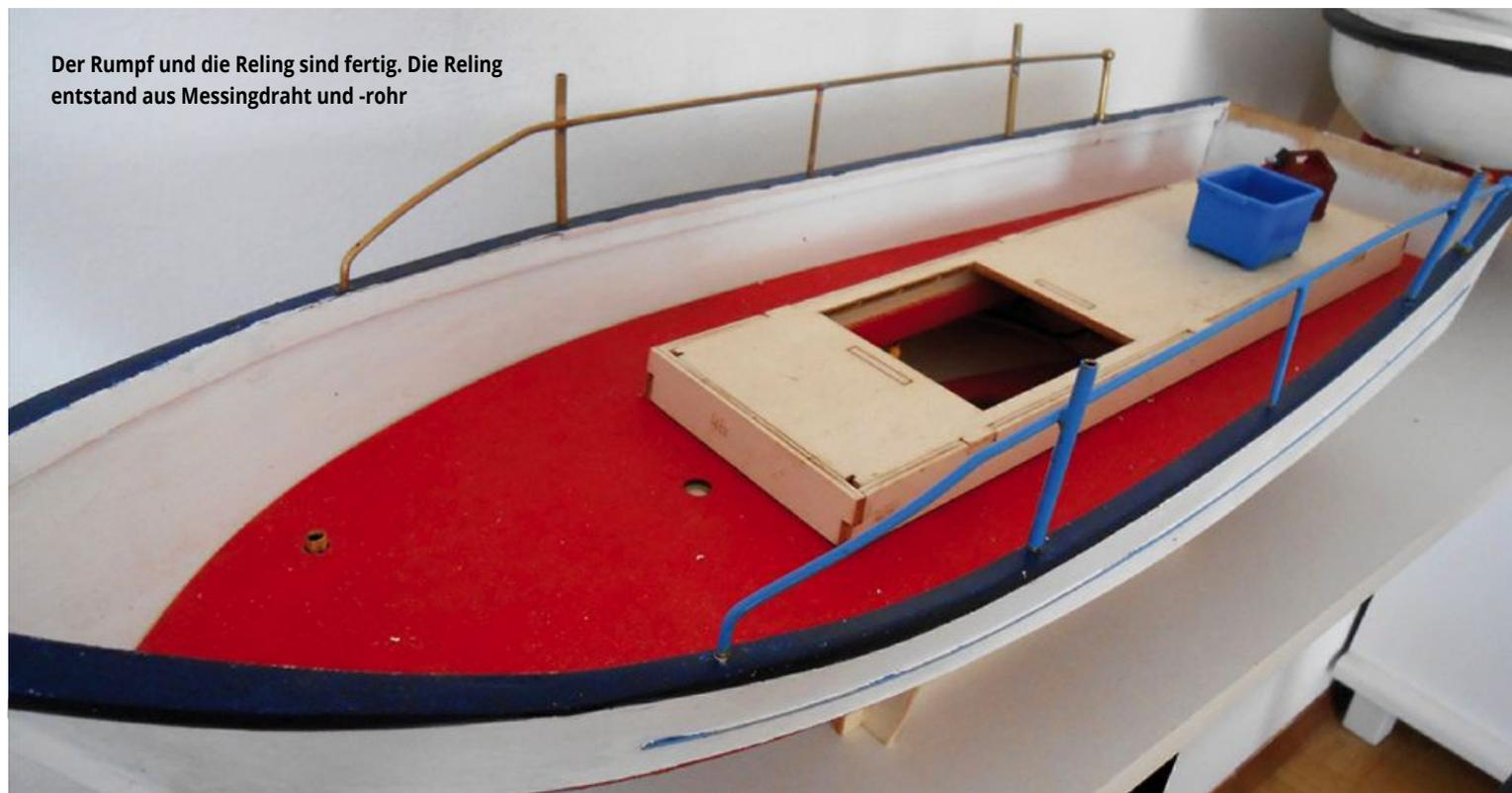
Der Rumpf und die Reling sind fertig. Die Reling entstand aus Messingdraht und -rohr
