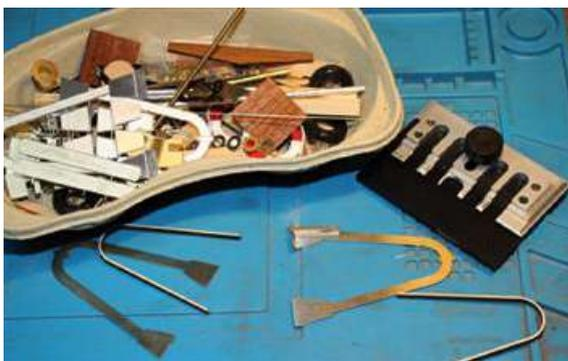
Bei den Ätzteilen kommt es auf scharfe Biegekannten und saubere Ausrichtung an. Entgegen der Anleitung verlötete ich die Teile soweit möglich zugunsten der Stabilität
