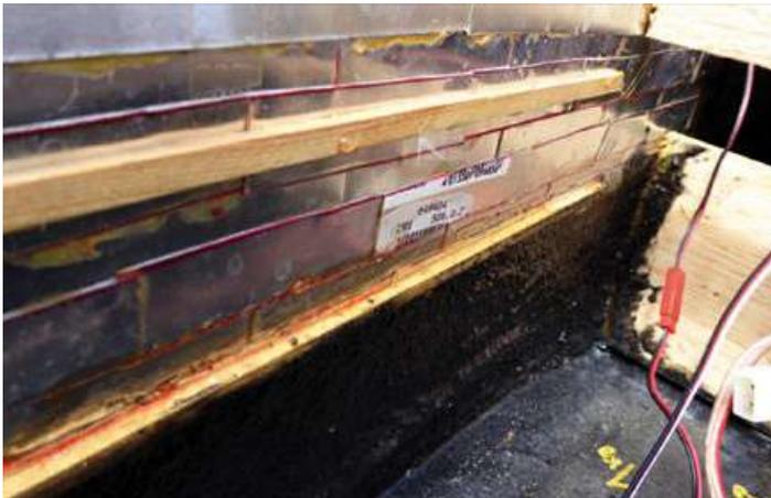
**Blick auf die Innenseite:** Gut zu erkennen sind die einzelnen mit Pattex verklebten Aluminiumplättchen, die innen eine Abstützung durch Holzleisten erfahren. Der schwarze Kunststoffanstrich musste später zum Abdichten aufgebracht werden
