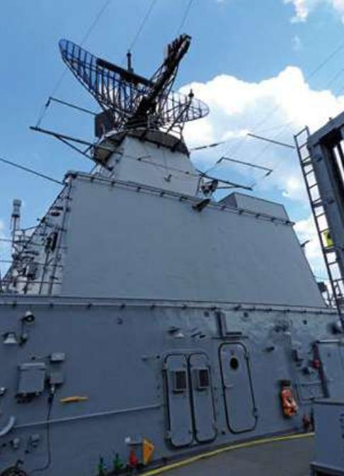
Auf dem hinteren Aufbau befindet sich das 2D-Weitbereichs-Luftraumaufklärungsradar LW 08 auf einem hydraulisch stabilisierten Drehtisch
