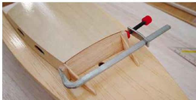
Das Vorderende der Kajüte wird eingeklebt
