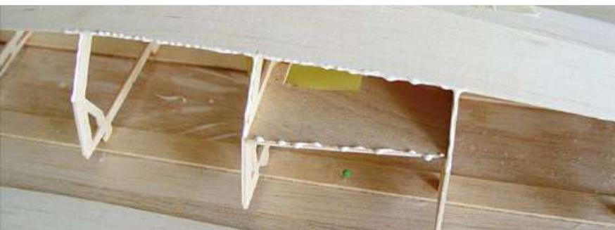
Die weiteren Planken werden nach dem gleichen Schema angebracht
