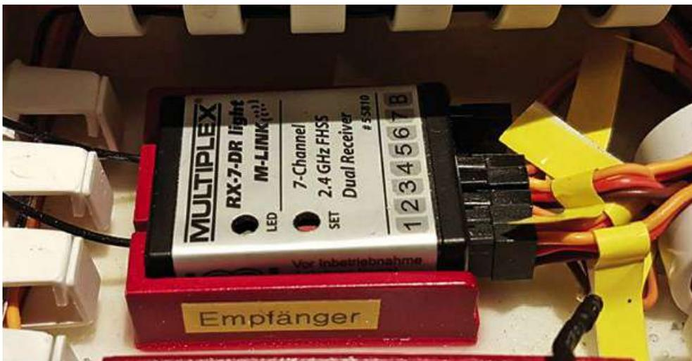
Die Kabelbeschriftung der Servokabel, um die Übersicht zu behalten
