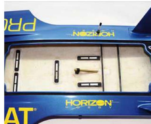
Der Aufnahmehalter für die RC-Grundplatte im Rumpf der *UL-19*
