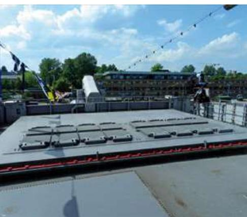
Blick von der Brücke auf die 16 Zellen des Vertical Launching Systems (VLS), indem die Sea Sparrow-Raketen gelagert sind – und aus dem sie verschossen werden
