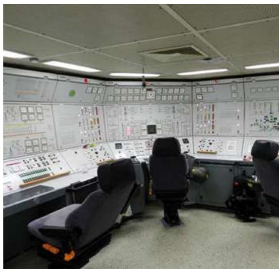
Im Schiffstechnischen Leitstand werden sowohl die Stromversorgung (linker Bereich), der Antrieb bestehend aus Gasturbinen und Dieselmotoren (Mitte) als auch die Munitionbestände (rechts) überwacht
