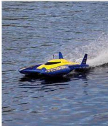
Hydroplanes laufen immer Gefahr, dass sie beim Start abtauchen – deswegen muss mit Vollgas gestartet werden
