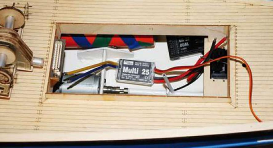
Die Akkus platzierte ich rechts und links des Motorspantes. Der Multi25 sorgt für komfortablen Vortrieb, ist aber auch etwas „oversized“
