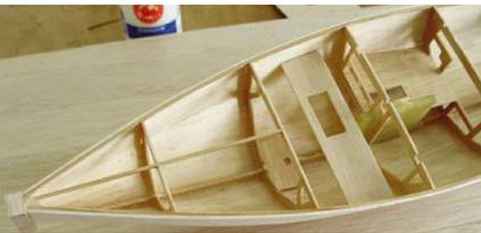
Die Oberkanten der Bordwände sind bereits verschliffen, um das Deck aufzunehmen
