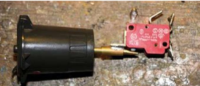
Um das Modell einzuschalten, wird eine Mülltonne an Deck gedreht. Unter Deck wird hierüber ein Mikroschalter betätigt
