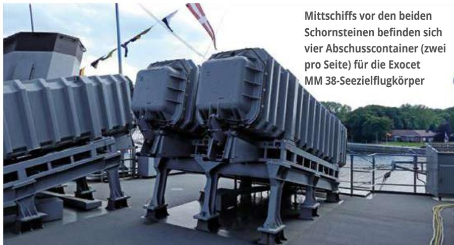
Mittschiffs vor den beiden Schornsteinen befinden sich vier Abschusscontainer (zwei pro Seite) für die Exocet MM 38-Seezielflugkörper
