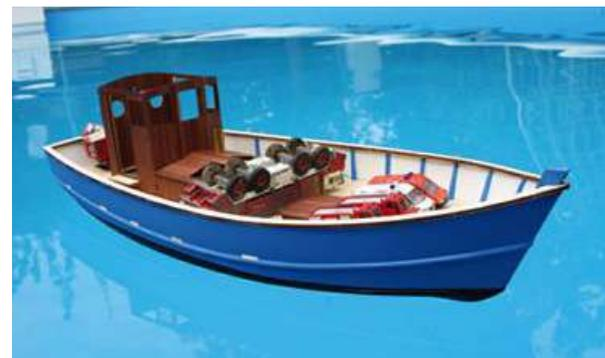
Ein erster Test im Planschbecken soll die Tragfähigkeit ermitteln. Bei 3.900 g ist die Wasserlinie erreicht
