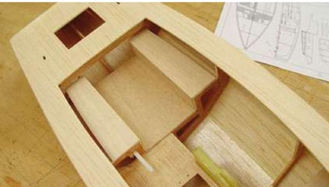
Ausbau der Plicht; die Führung der Ruderanlenkung ist bereits eingebaut, die Querstege der Spanten sind herausgetrennt
