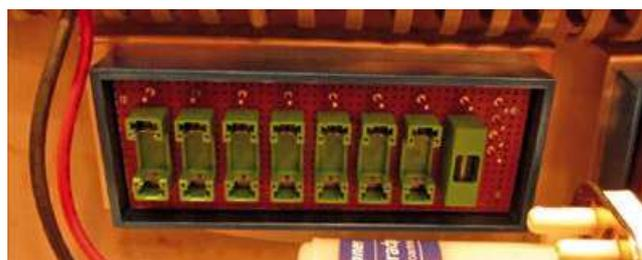
Der Sicherungskasten wurde auf der Platine im Schiffsrumpf eingebaut und für die Verdrahtung vorbereitet
