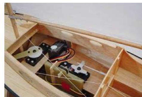
Einbau der RC-Anlage im Rumpf
