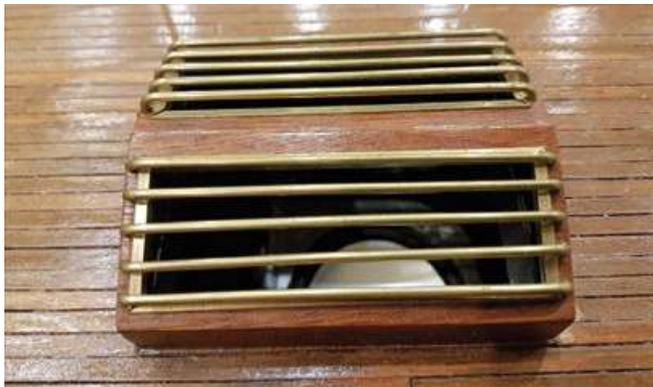
Decksluke auf dem Vordeck des Wasserschutzpolizeibootes WS14. Darunter ist der Lautsprecher inklusive Box versteckt
