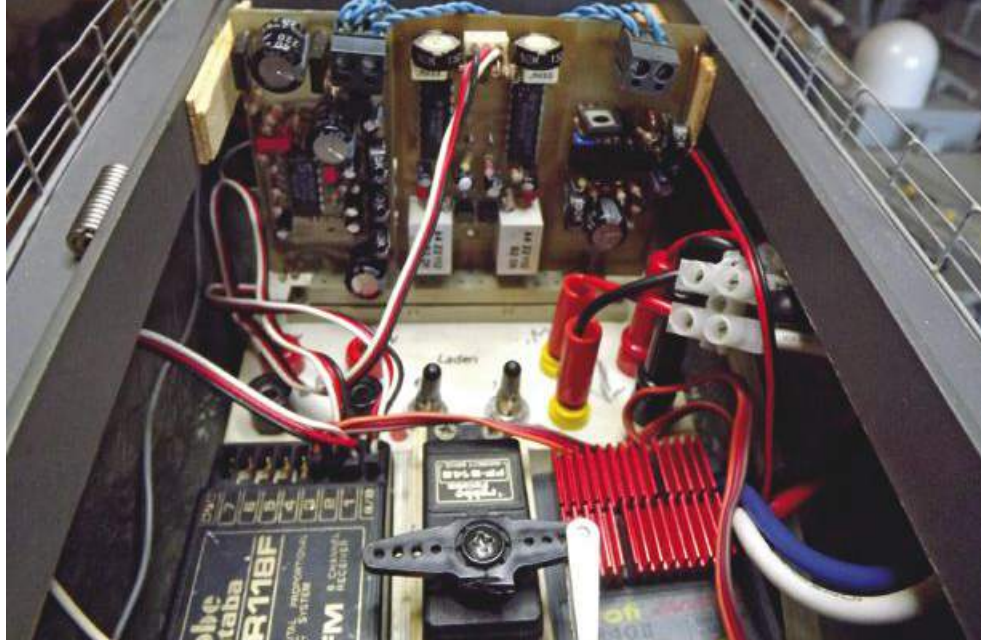
Oben: die Zerstörer-Sirene, der 2-Kanal-Schaltbaustein für das Radar und den Heli, ganz rechts die Tiefhorn-Platine. In der Mitte: der Hauptschalter und die Ladebuchsen. Unten: links der alte 40-MHz-Enfänger, daneben das Ruder-Servo, rechts davon der Jamara-Fahrtregler
