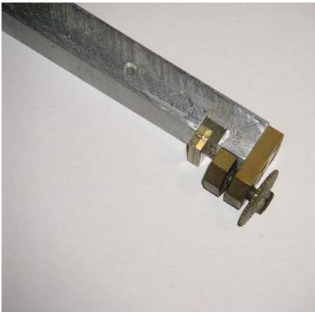
Gut zu sehen hier die vergossene Nut am Führungsstück
