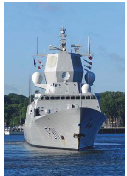
Die norwegische Luftabwehrfregatte Roald Amundsen (F-311) der Fridtjof Nansen-Klasse basiert auf der spanischen Álvaro-de-Bazán-Klasse und nutzt das amerikanische Aegis-Kampfsystem – erkennbar an den beiden vorderen achteckigen SPY-1F-Radarantennen auf dem Aufbau über der Brücke
