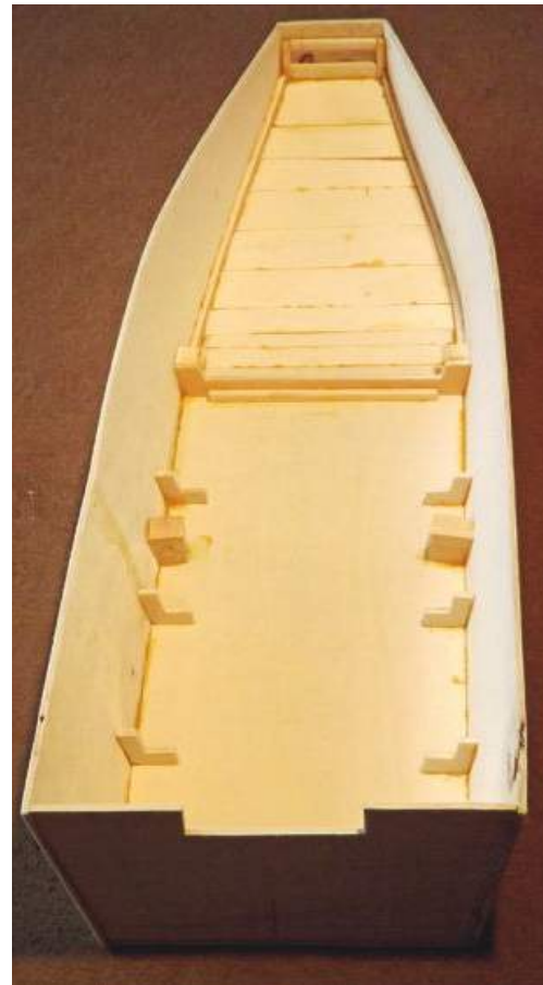
Die fertige Rumpfschale – die Grundauslegung des THW-Bootes ist erkennbar
