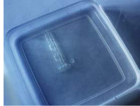
Spülen des Druckteils in Alkohol
