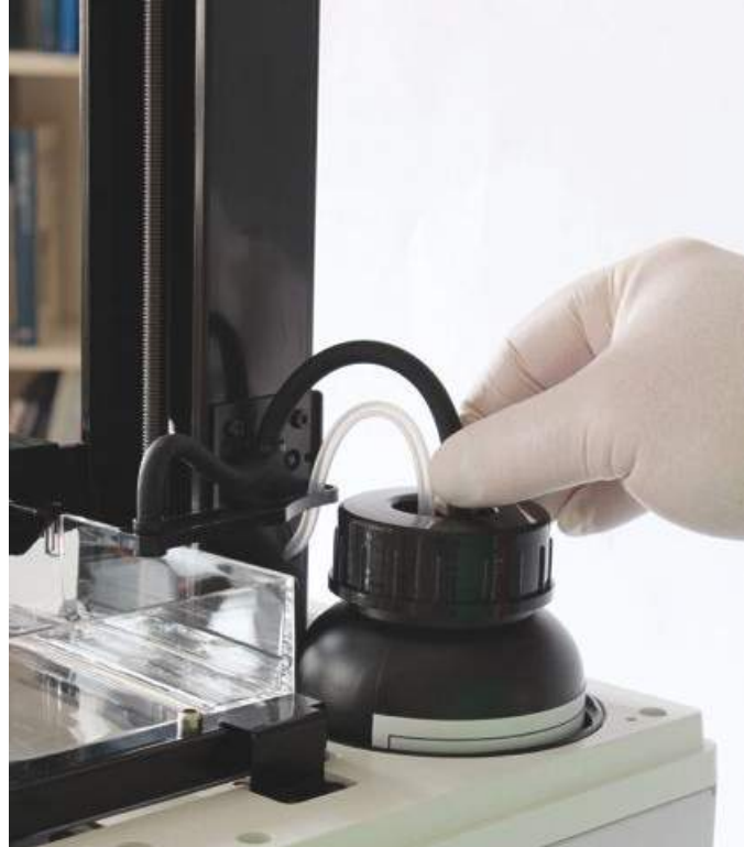
Vorbereitung der Harzflasche für den ersten Druck – schütteln nicht vergessen!
