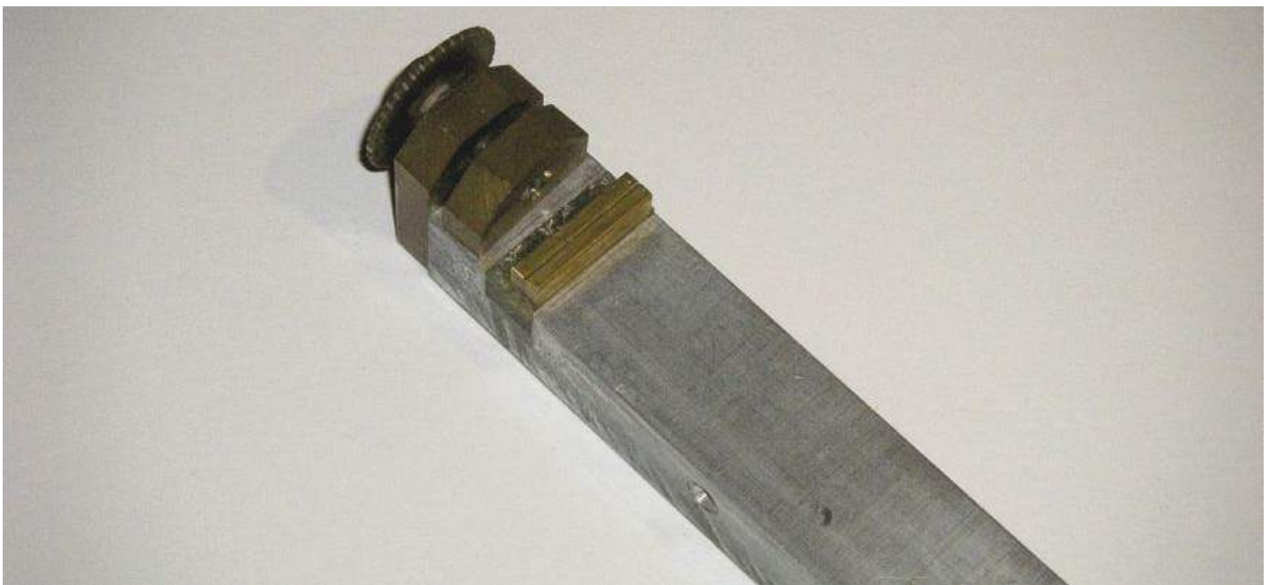
Führungsstück und Druckplatte bilden eine gute Einheit zur Fixierung des Anschlags
