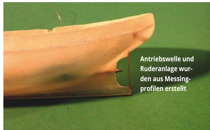
Anhand des Vollrumpfes von Artitec entstand zunächst eine Silikonform. Mit feiner Glasfasermatte und sparsamer Verwendung von Epoxidharz wurde daraus ein leichter Rumpf laminiert
