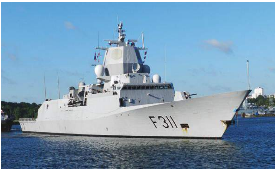
Die norwegische Luftabwehrfregatte Roald Amundsen (F-311) der Fridtjof Nansen-Klasse basiert auf der spanischen Álvaro-de-Bazán-Klasse und nutzt das amerikanische Aegis-Kampfsystem – erkennbar an den beiden vorderen achteckigen SPY-1F-Radarantennen auf dem Aufbau über der Brücke
