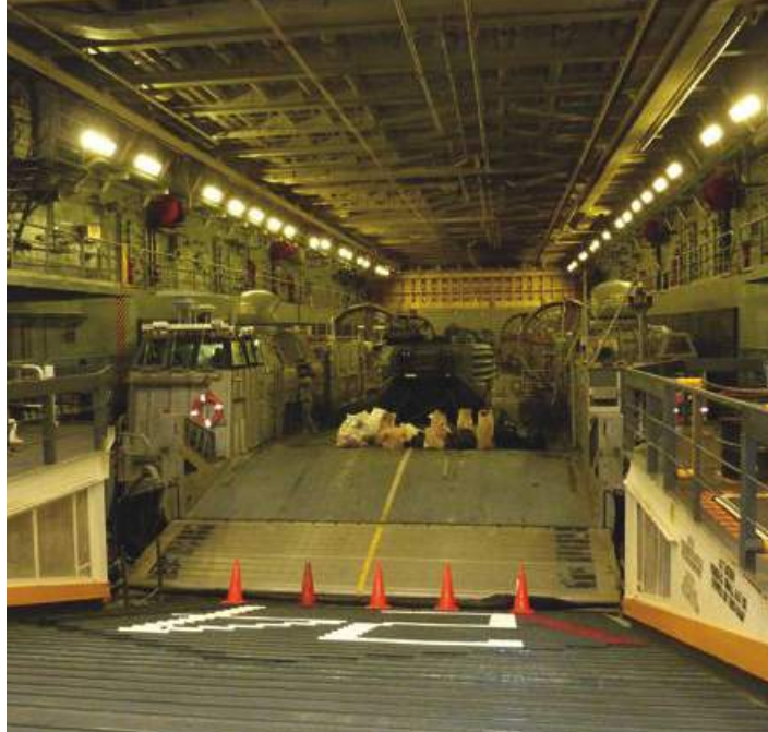
Blick auf das 55 Meter lange Welldeck der Arlington . Im Vordergrund sieht man ein von Textron Systems gebautes 26,4 Meter langes Luftkissen-Landungsfahrzeug vom Typ LCAC (Landing Craft Air Cushion), mit dem während einer amphibischen Landungsoperation Truppen und Fahrzeuge an Land gebracht werden
