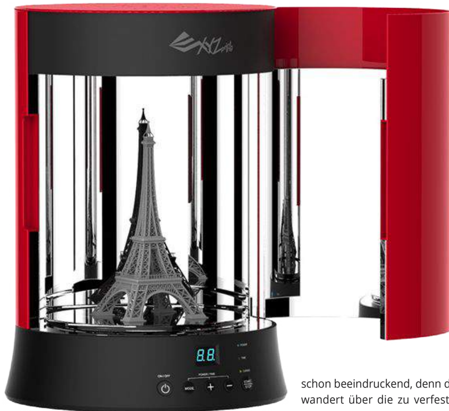
Die Curing Chamber dient dazu das Harz komplett mittels UV-Licht auszuhärten (Bild: XYZprinting)
