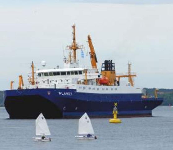
Das Wehrforschungsschiff Planet (Klasse 751) wird von der Deutschen Marine mit einer zivilen Crew betrieben. Das SWATH (Small Waterplane Area Twin Hull)-Schiff fährt aufgrund der beiden Auftriebskörper unterhalb der Wasseroberfläche besonders ruhig und lagestabil – auch bei stärkerem Seegang
