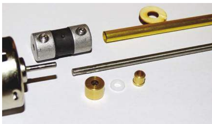
Die Kleinteile der Wellenanlage mit dem Motor
