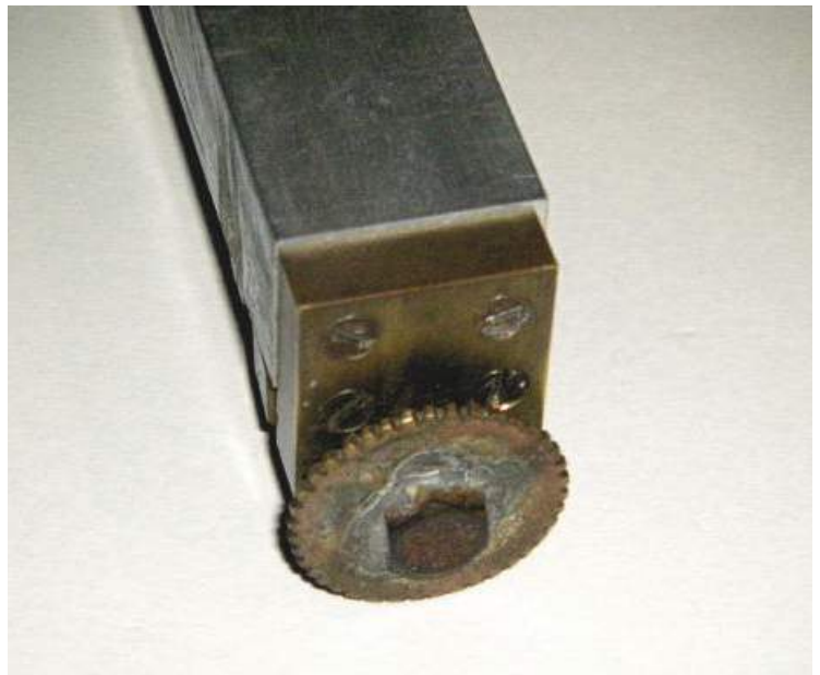
Zum Festsetzen des Anschlags dient ein kleines Messingzahnrad
