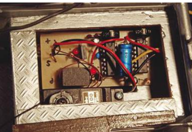
Die in einem der Staukästen befindliche Elektronik und das Servo
