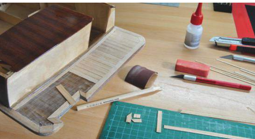
Die Badeplattform wird beplankt
