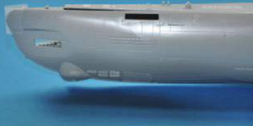
Diese Öffnungen müssen geschlossen und gut abgedichtet werden
