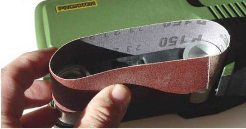
Zum Wechsel lässt sich das Schleifband bequem von der Maschine abziehen
