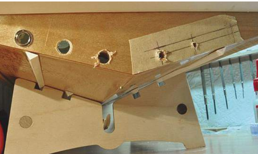
Von rechts nach links erkennt man die verschiedenen Schritte zur Anfertigung der Unterwasserbeleuchtung
