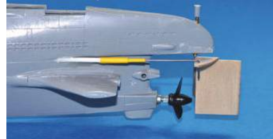
Der Schrumpfschlauch dient als Dichtung. Im dünnen Messingrohr verläuft die Ruderachse
