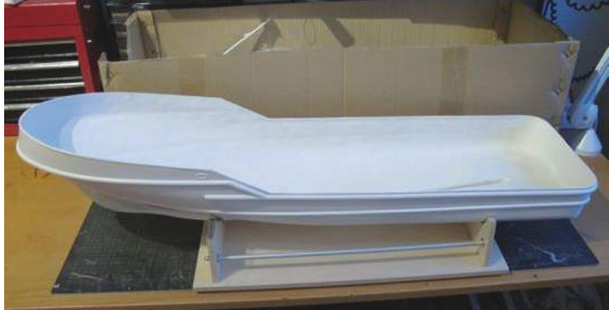
Der überaus stabile GFK-Rumpf samt seiner Oberfläche überzeugt
