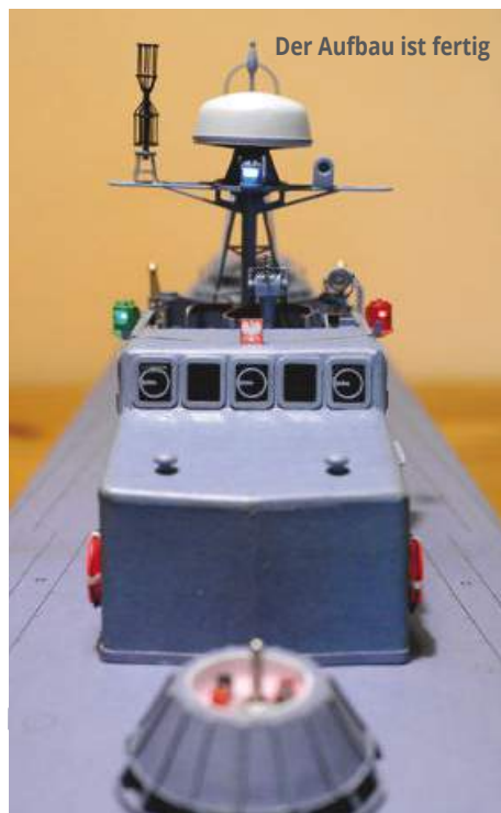
Das Geschütz wird mittels Magneten auf dem Rumpf gehalten
