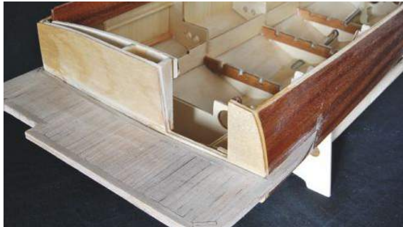
Die Einzelteile des Scheibenrahmens werden verklebt
