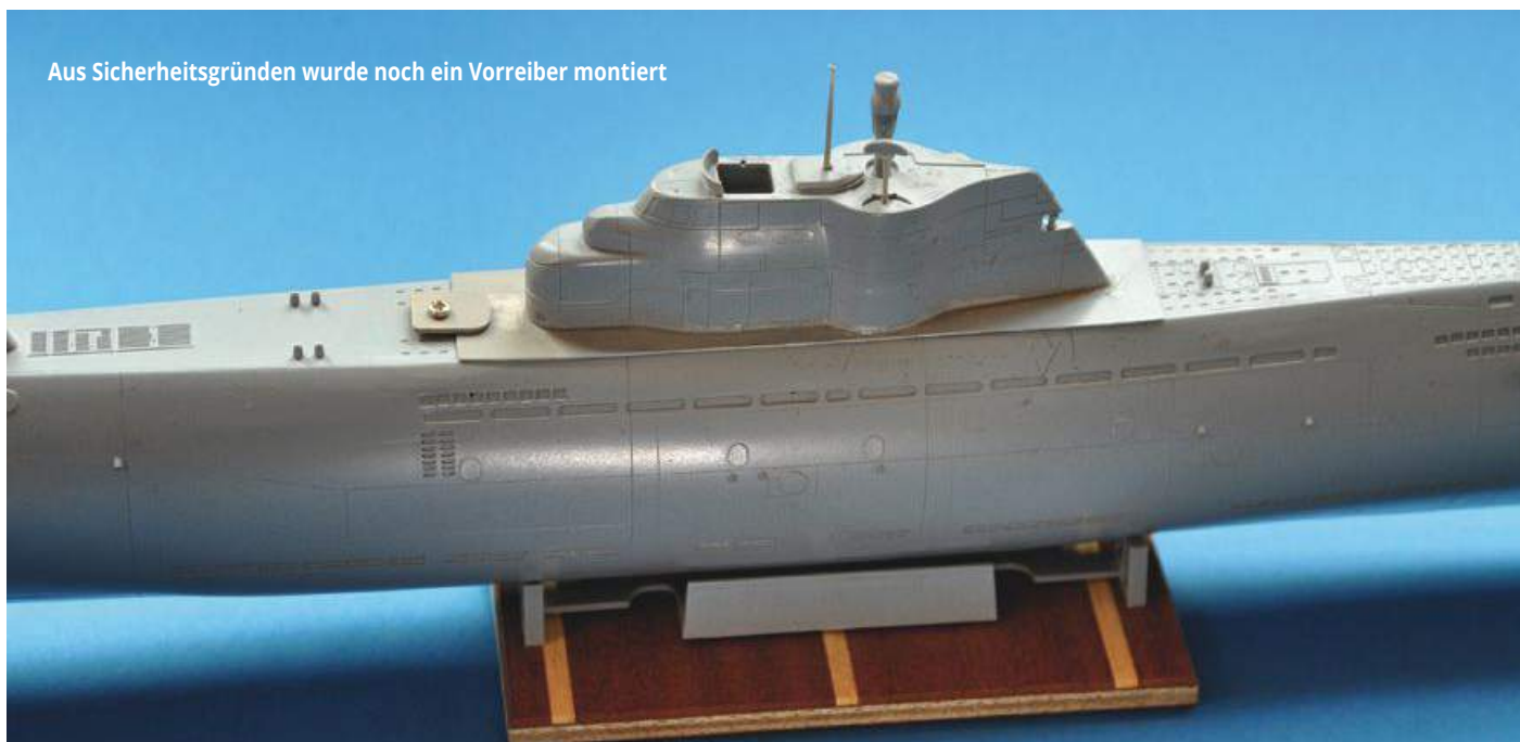
Der Deckel für den Turm besteht aus 1-mm-Polystyrol. Auf seiner Unterseite klebt die Moosgummidichtung
