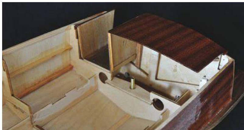
Das achtere Deck wird aufgesetzt
