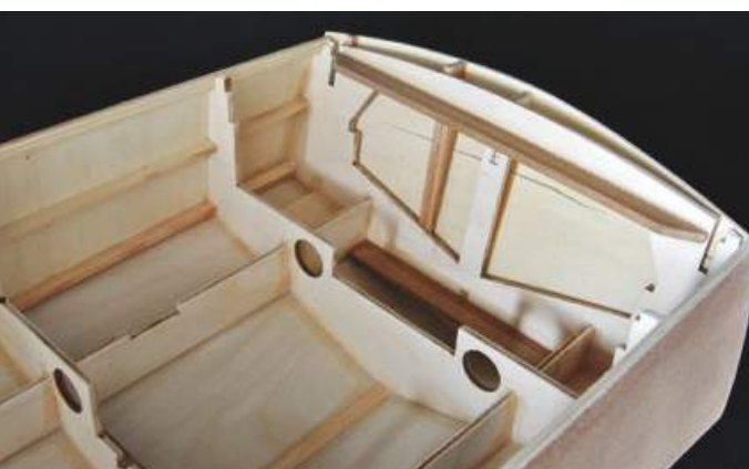
Am Heckspiegel wurden Verstärkungen durch zwei zusätzliche Hölzer angebracht
