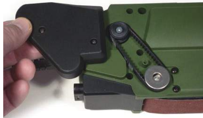
Der Antriebs-Zahnriemen verbirgt sich hinter einer seitlichen Abdeckung
