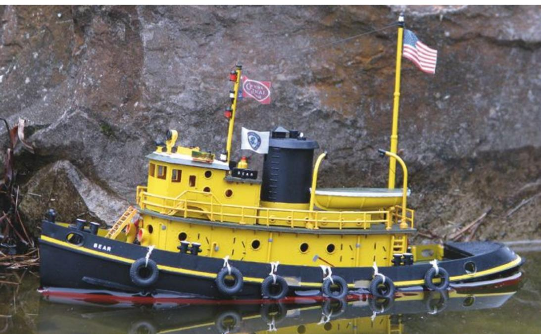
Die Beschriftung des Modells besteht am Rumpf aus einzelnen Reibebuchstaben mit einer Höhe von 1,5 mm. Am Aufbaudach fanden Nassschiebebuchstaben mit 1 mm Höhe Verwendung, die nach dem Aufbringen noch mit Klarlack versiegelt wurden.
