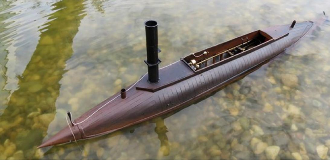
Ende hin nach oben abgewinkelt. Ein Teil der Länge lag direkt kaum sichtbar neben dem Kessel, wurde jedoch während der Feuerung über Gebühr erhitzt, deshalb verwendete ich später einen konventionellen Gastank. Die Antriebsanlage war relativ problemlos einzubauen, im Leerlauf funktionierte sie einwandfrei. Welche Überraschungen würden sich bei der Trimmung zeigen?
