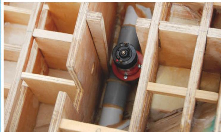
**Das Bugstrahlruder wird montiert**
