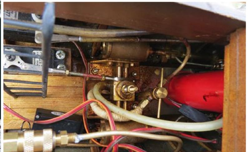
Dampfkessel mit Brenner und Manometer, links vom Kessel der lange kupferne Gastank
