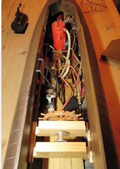
Blick in den zylindrischen Rumpf der *David*. Links hinter dem Steuerrad das Servo für die Maschinenansteuerung
