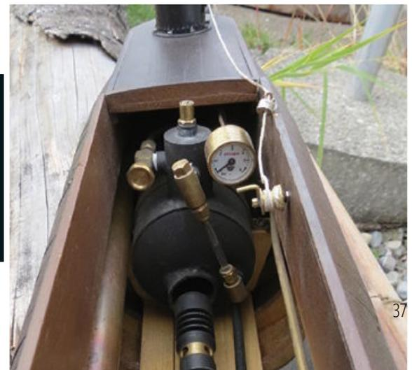
Fast alle meine Modelle sind mit Dampfmaschine angetriebene Funktionsmodelle. Weil auch die *David* von einer Dampfmaschine betrieben wurde, lag es nahe, diesen äußerst interessanten Antrieb auch im Modell zu übernehmen. Die originale Länge des Bootskörpers betrug ca. 50 Fuß (15,25 m), mit dem Maßstab 1:11 müsste es ohne weiteres möglich sein, eine Dampfmaschinenanlage einzubauen.
