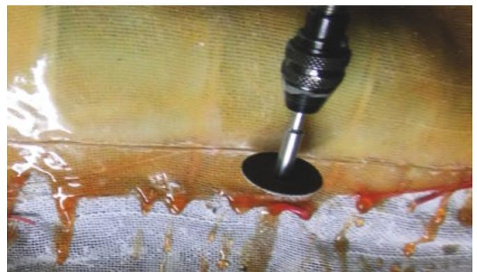
An der Schanzkleidmarkierung wird die Schale abgetrennt
