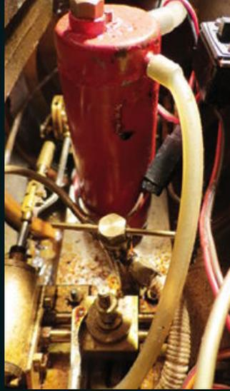
Die Maschine: Links das Ruder-gestänge. Vorn Ansteuerung des Fahr- und Umsteuerventils
