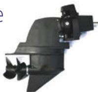
Der **Schottel 70BM** ist besonders leise. Features: mehr Vortrieb durch vom Original skalierte Propeller und Düse, komplett kugelgelagert, wasserdicht durch Wellendichtring, hoher Wirkungsgrad, Antrieb und Drehbewegung mittels Zahnriemen T2,5, profilierte Düse, profilierte Propeller Ø65mm rechts und links enthalten. Lieferbar ab April 2017. Die Propeller sind bereits als Austauschteil erhältlich. Preis: 119,- €.
