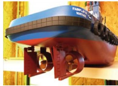
Ruderanlage und Propeller. Alle Fender sind aus richtigem Gummi
