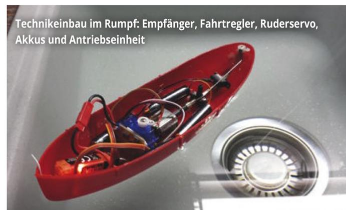
Technikeinbau im Rumpf: Empfänger, Fahrtregler, Ruderservo, Akkus und Antriebseinheit
