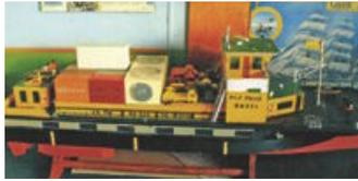
**Container Schiff PLZ-Palüe**, Länge: 115 cm, Breite: 35 cm, 2 Motoren à 6 Volt, 1 Akku Volt 7,2 ah für die gesamte Licht Anlage 1 Akku 6 Volt 6,4 AH für die Motoren, Sonderfunktionen, Positionbeleuchtung, Radar, Blinker Nacht, Licht Scheinwerfer, Innenbeleuchtung, Dennebaumbeleuchtung, Harvarie Lampen auf dem Steuerhaus. Boot ist fahrbereit, Beladen mit verschiedenen Transportfahrzeugen. VB 450,-EUR. Tel.: 0 26 37 / 25 12.
