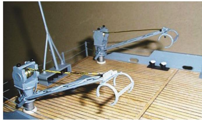
Die zwei Kranausleger für die Räumgeräte sind aus einzelnen Kupferdrähten zusammengelötet worden. Die Seilrolle am Ausleger ist ein Spannschloss
