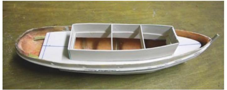
Das Deck ist lose eingelegt und um den Süllrand entstehen die Aufbauten
