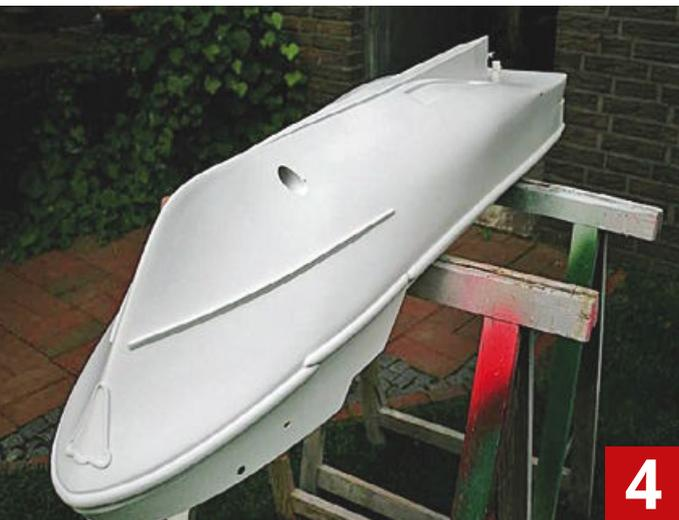
erstellen, aus dem Detlef zunächst ein Urmodell formen sollte. Daraus würde dann die Negativ-Form entstehen, aus der Detlef als der „Laminator“ dann letztendlich den fertigen Rumpf entstehen lassen wollte. Währenddessen würde ich mich mit dem Deck und den Aufbauten befassen. Der Prototyp sollte dann eigentlich bis zum nächsten
