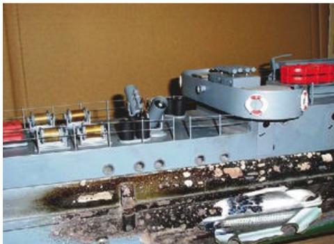
Bedingt durch eine von Unrat blockierten Propellerwelle brannten der Motor und der Fahrregler durch und am Ende sogar der Schiffskörper
