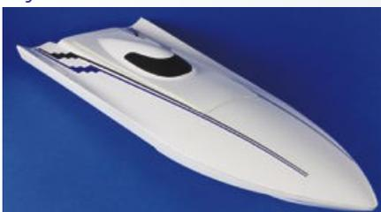
Die **Firefly WE** ist das neue Mini-Eco von Hydro&Marine. Features: längsgestuftes Unterwasserschiff mit flächigen Gleitkeil für stabilen Geradeauslauf, gestufte Stringerkanten für stabile Kurvenlage und besseren Wasserabriss, asymmetrisch geformtes Unterwasserschiff, rechtes Unterwasserschiff
