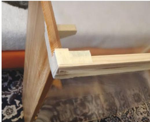
Die Fixierung der fertigen Rahmenkonstruktion an der Grundplatte
