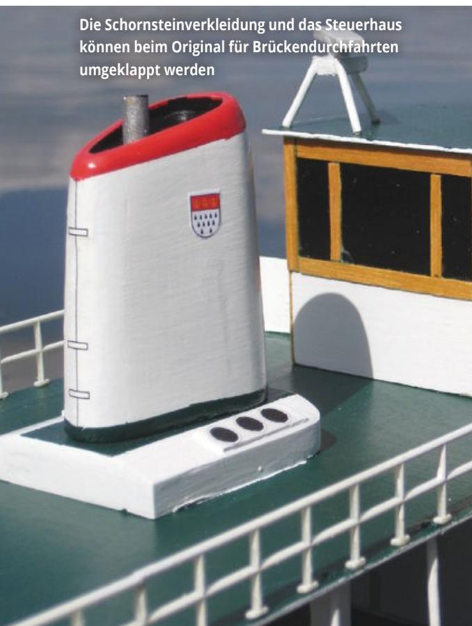
Die Schornsteinverkleidung und das Steuerhaus können beim Original für Brückendurchfahrten umgeklappt werden
