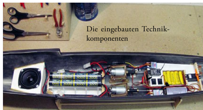
Die beiden Antriebsmotoren von Krick im Rumpf
