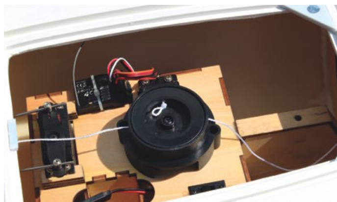
Die gesamte Ausrüstung sitzt fertig eingebaut im Technikgerüst aus Sperrholz
