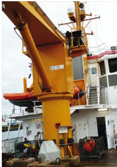
Deckkran mit einer Tragkraft bis 8,5 t. Er kann bis 15 m ausgefahren werden
