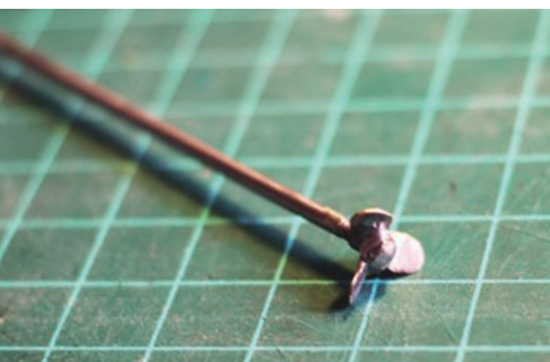
Das Stevenrohr und der Propeller wurden aus Messingteilen gelötet
