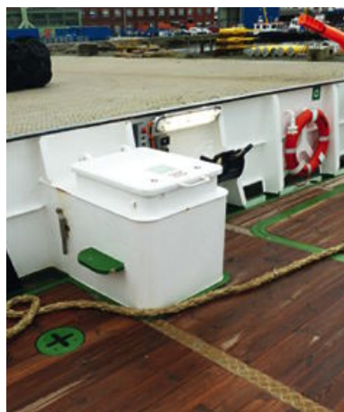
Notausstieg vom Maschinenraum
