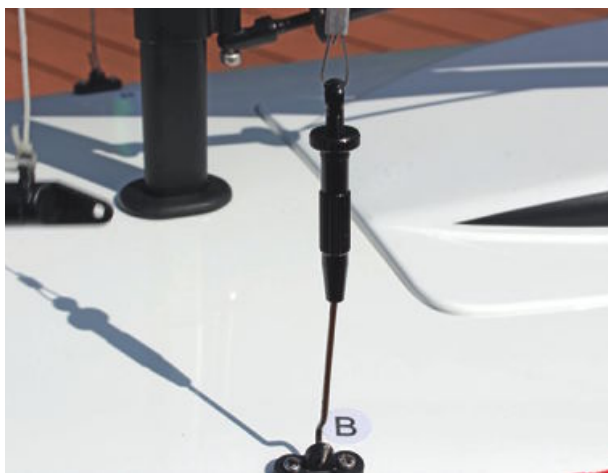
Die Spanner für Wanten und Achterstag erlauben ein sehr gutes Nachstellen
