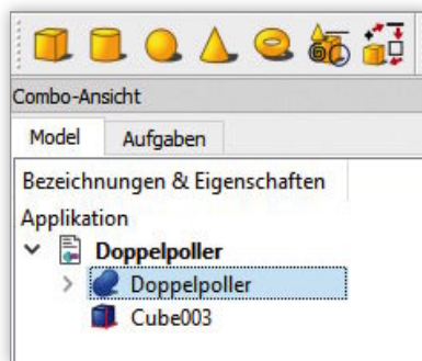
Zum Ausschneiden wird als Erstes der zu erhaltende Doppelpoller markiert
