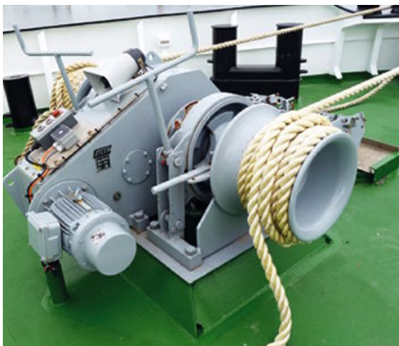
Vorholwinde und Ankerspill auf dem Backdeck
