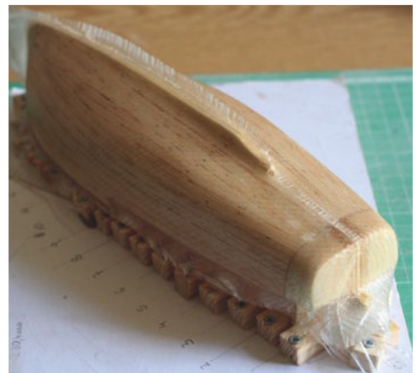
Eine Schicht GFK dient der Formung des Rumpfes...
