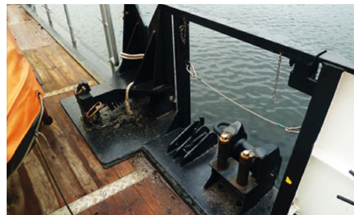
Kettenstopper auf der Backbordseite. Deutlich erkennbar die Deltaform
