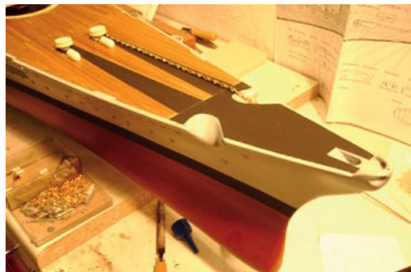
Abgeklebt – das Deck wird mit Bootslack eingelassen
