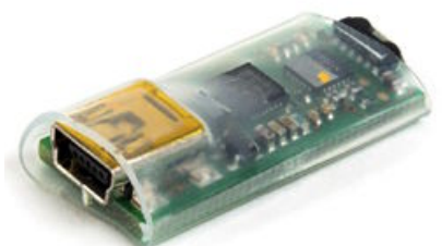
Mit dem USB Infrarot Datalink wird das Lichtsetup vom PC auf das Lichtmodul übertragen
