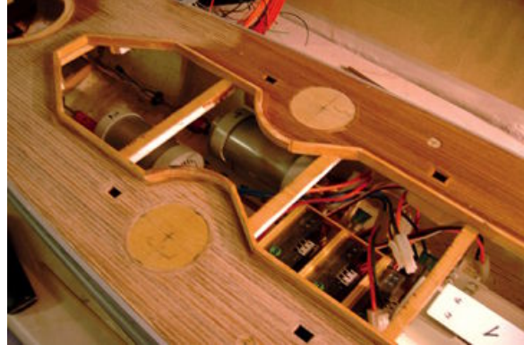
Der zweite Anschliff der Decksbeplankung
