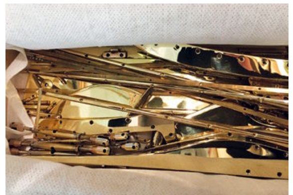
Fertig gelötet und poliert geht's jetzt zum Galvanisieren
