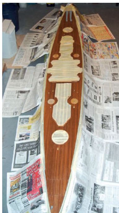
Abgeklebt – das Deck wird mit Bootslack eingelassen
