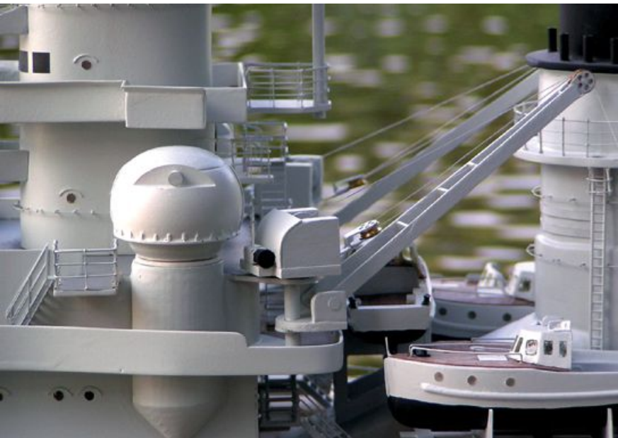
Wackeltöpfe und Bordkran für die Beiboote
