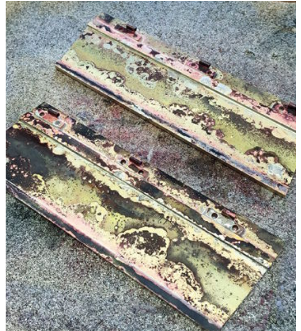
Viele Beschläge werden jetzt hartgelötet. Hier die Trimmklappen
