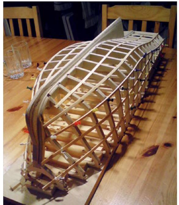
Die Spanten sind aufgestellt und auf Helling verkeilt, die Stringer eingepasst und angeleimt
