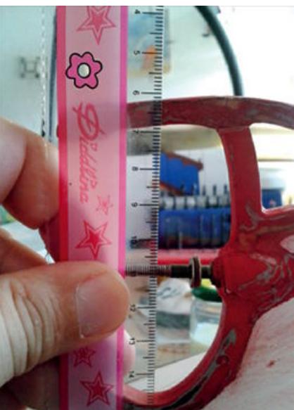
Platzermittlung für die drehbare Kortdüse
