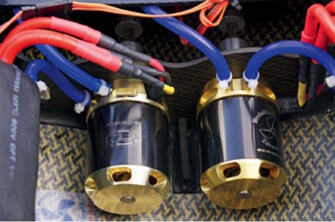
Zwei BL-Motoren am CFK-Motorträger, der mit Karosseriekleber verklebt wurde
