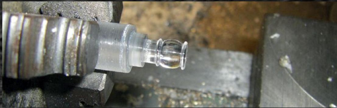
Die Lampen gläser werden via Drehbank selbst angefertigt und danach aufpoliert
