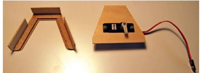
Einbaurahmen und Montagebrett für das Segelverstellservo
