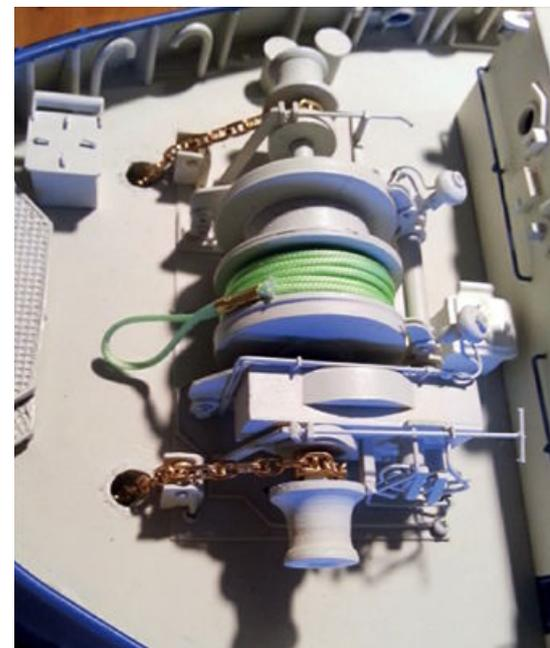
Fertige Winde, die Ankerkette läuft frei über die äußere Welle (Stb), die mittlere Trommel ist angetrieben, die Kette auf Backbord ist nur Deko
