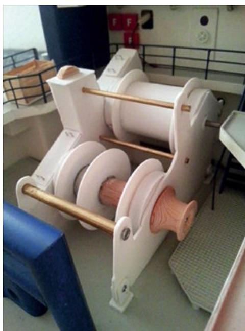
Hintere Schleppwinde, Holzteile mit ABS, der Antriebsmotor sitzt in der oberen Rolle
