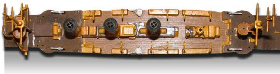
Nach dem Austausch des Fahrtreglers und mit den Motoren im Parallelbetrieb lief die Emden deutlich gleichmäßiger
