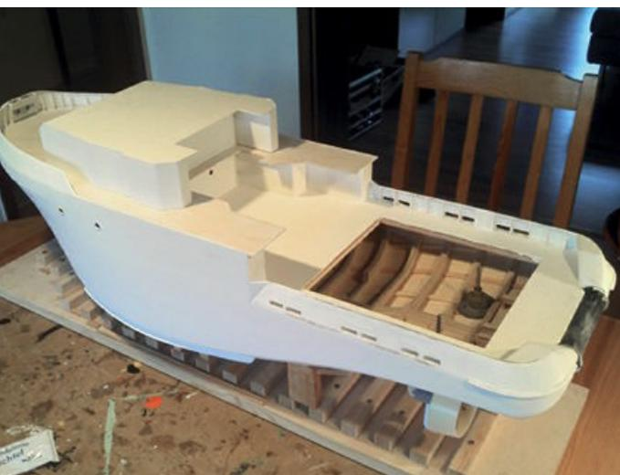
Die ersten Aufbauten entstehen, Schanzkleid und Klüsen sind ausgearbeitet, Antriebe eingebaut und Bullaugen eingesetzt
