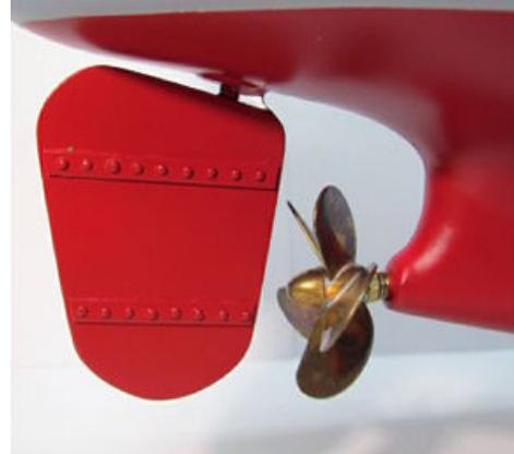
Der U-Jäger wird von einer 5-Blatt-Messingschiffschraube mit 45 mm Durchmesser angetrieben
