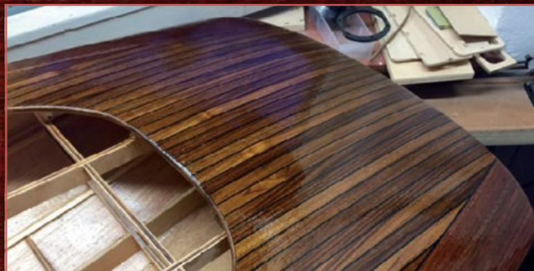
Die erste Schicht Eposeal ist aufgetragen
