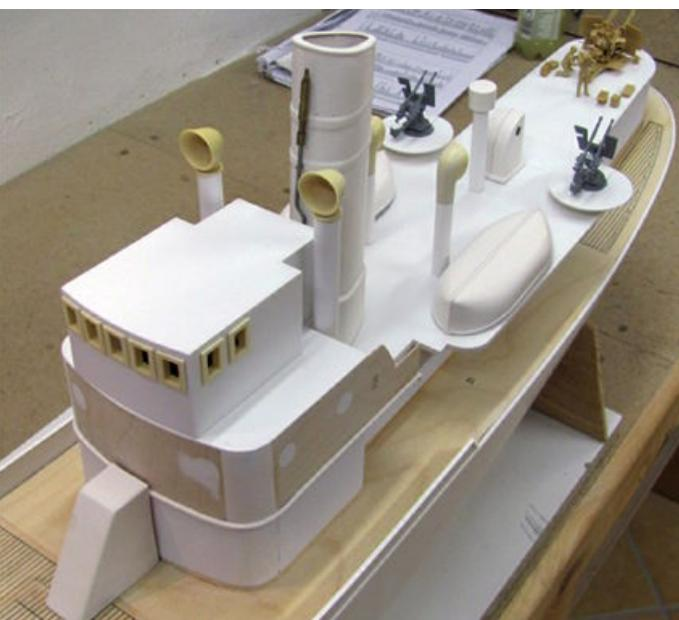
Die Grundlage der gezeigten Aufbauten ist ein Gerüst aus verschiedenen Holzplatten und Vierkantholzleisten
