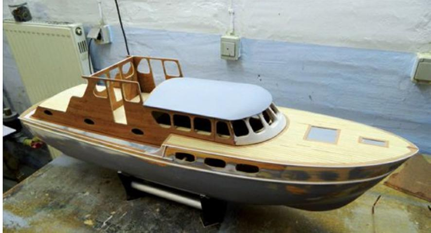
Das Kabinendach fertig, der Rest noch im Rohbau
