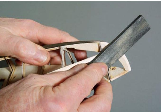
Das Spantengerüst wird verschliffen
