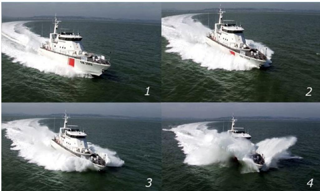
Bildimpression der Werft beim Stoppen aus voller Fahrt – Innerhalb von vier Sekunden
