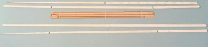
Die Stöße der Masteinzelteile wurden schräg angeschliffen
