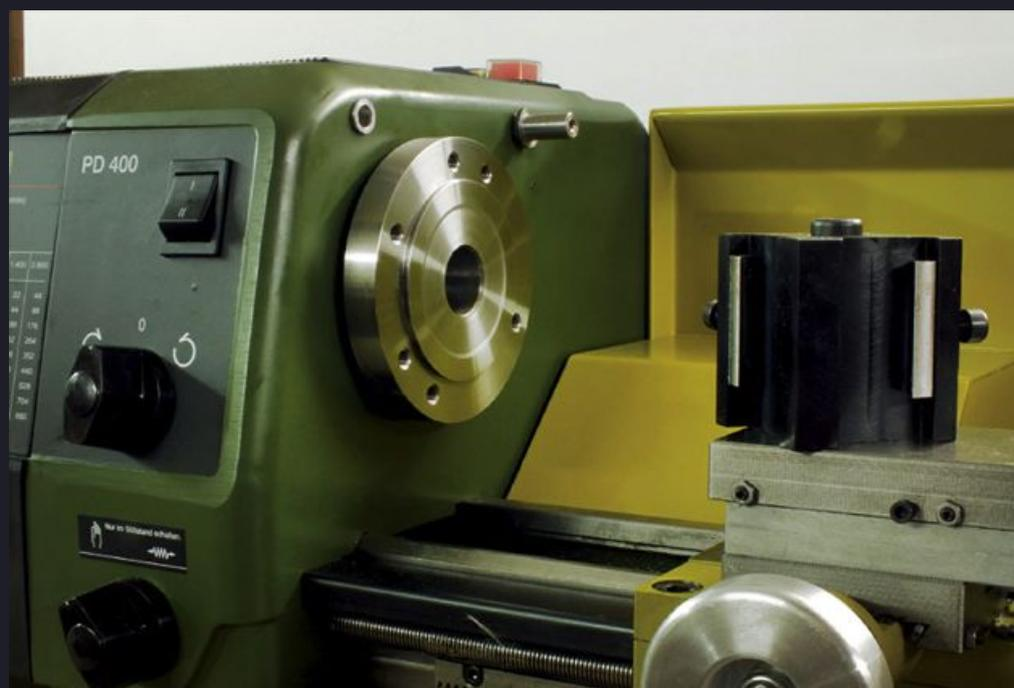
Futterflansch, Aufnahme in der Spindelbohrung MK3
