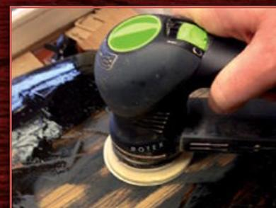
Überschüssiges Epoxid wird abgeschliffen
