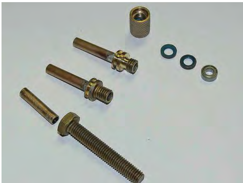
▲ Die einzelnen Baustufen sind gut erkennbar: Schraube roh mit Messingrohrabschnitt; Abgedreht, gebohrt und verlötet; auf Länge abgestochen und mit der O-Ring Dichtungsnut versehen. Daneben der eigentliche Dichteinsatz mit dem davor liegendem Inhalt: Lippringe und dem Kugellager
