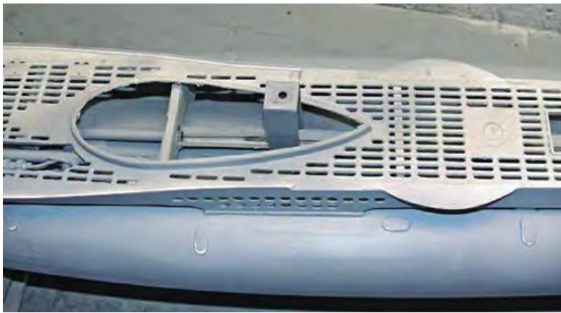
▲ Die Gestängeführung der Tiefenruder war eine etwas aufwendigere Konstruktion ▲
