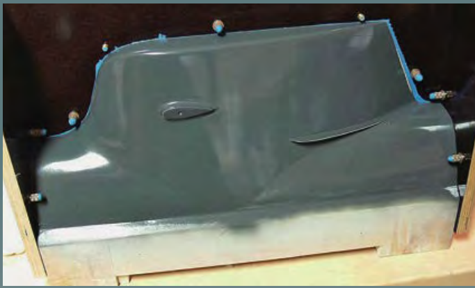
▲ Urmodell in Trennbrett eingebettet, die Lücken zum Trennbrett sind mit Knete verschlossen
