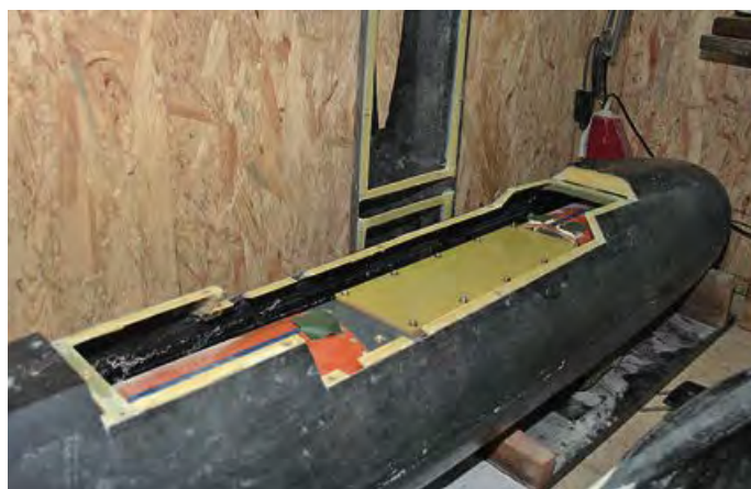
Im Rumpf sitzt das KG-Rohr, welches die Technik aufnimmt
