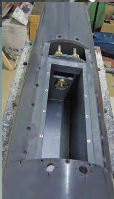
▲ Tank vor dem Verkleben im Druckkörper, in der Mitte eine der beiden Zentralverschraubungen mit denen das Boot geschlossen wird. Das Drehteil nimmt ein Kugellager auf, in dem die Schraube gehalten wird
