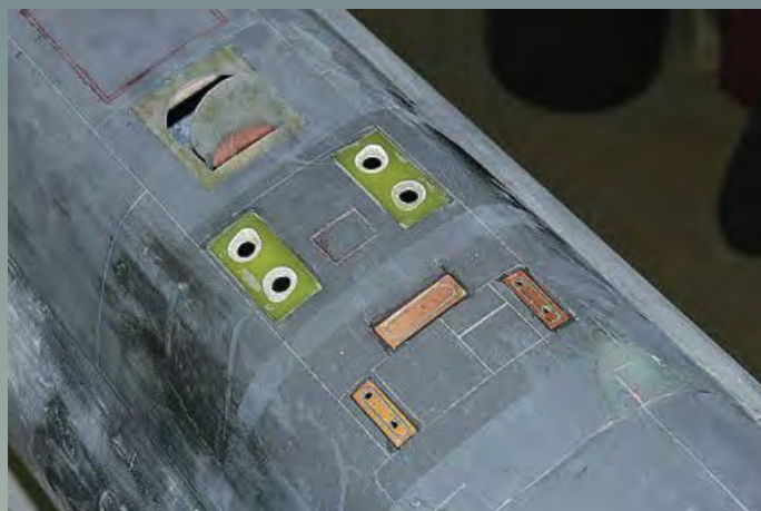
▲ Pollerbank und vordere Einstiegs Luke, unter der sich eine der beiden Befestigungsschrauben des Oberdecks befindet
