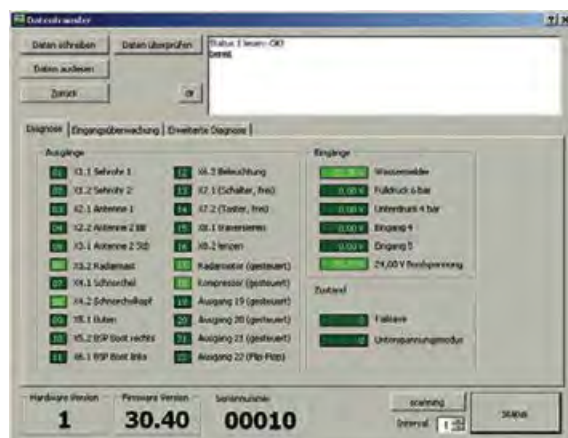
▲ Der Mehrkanalschalter MKS lässt sich sehr komfortabel programmieren
