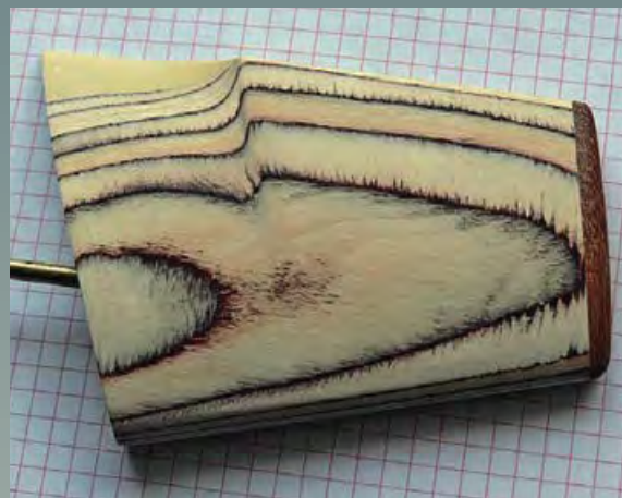
▲ Das Ruderblattrmodell aus Mehrschichtplatte
