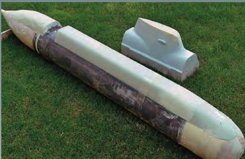
▲ Urform des Turms aus verleimten Multiplexplatten
