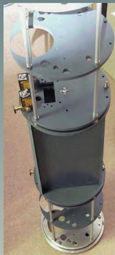
▲ Tank vor dem Verkleben im Druckkörper, in der Mitte eine der beiden Zentralverschraubungen mit denen das Boot geschlossen wird. Das Drehteil nimmt ein Kugellager auf, in dem die Schraube gehalten wird
