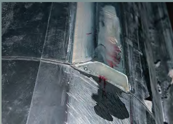
▲ Kielquerschnitt an der Trennstelle nach Harzverguss
