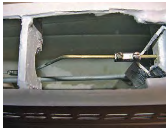
▲ Die Gestängeführung der Tiefenruder war eine etwas aufwendigere Konstruktion ▲
