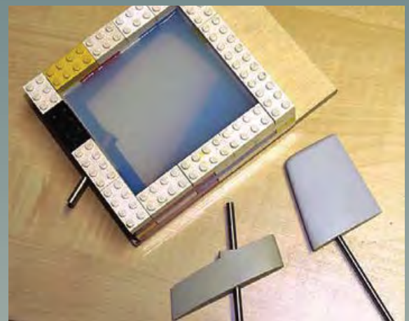
▲ Ruderform nach eingießen der zweiten Hälfte
