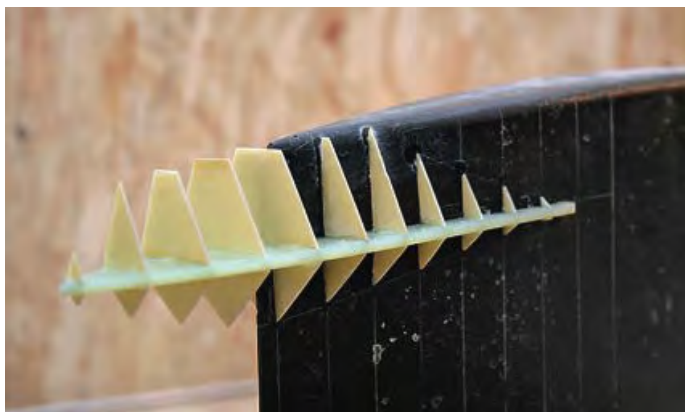
Die spezielle Anformung am Turm wird mittels Spanten ...
