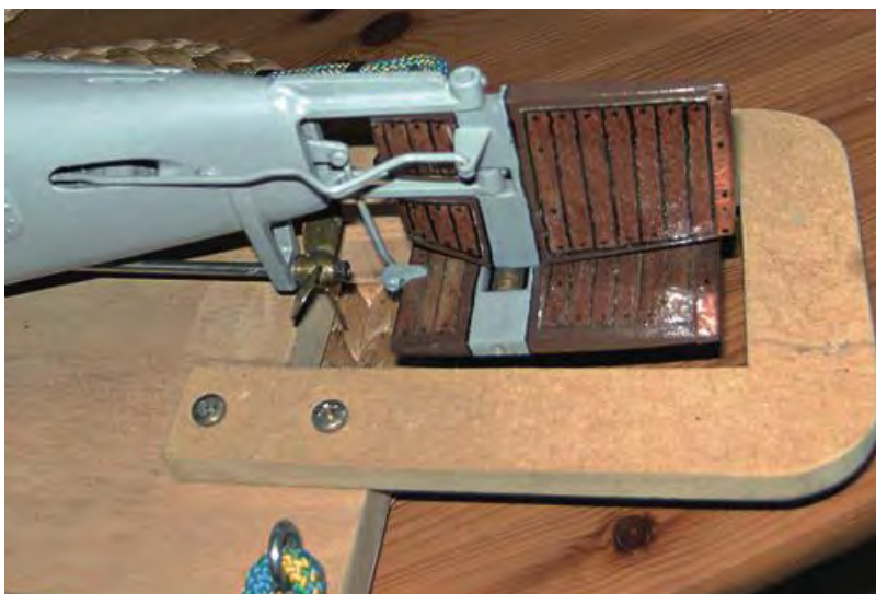
▲ Blick auf die Holzrunder und die kompliziert abgewinkelte Anlenkung des Seitenruders
