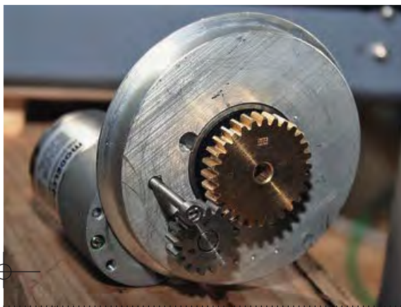
▼ Selbst gefertigter Antrieb einer Trimmzelle
