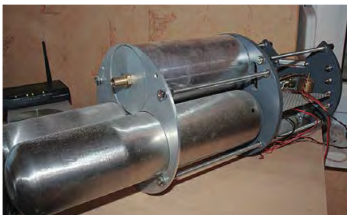
▲ Der vordere Teil des Technikgerüsts nimmt unter anderem die Kompressoren, Druckluftbehälter und die vordere Trimmzelle auf
