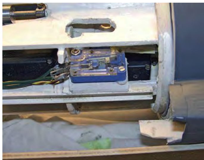
▲ Das Ein- und Ausschalten des Modells erfolgt mit einem einfachen Mikrotaster
