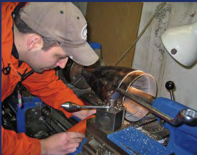
▲ Ablängen des Heckkegels auf der Drehbank
