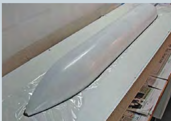
Durch die Verwendung von Frischhaltefolie als Trennmittel kann nichts passieren
