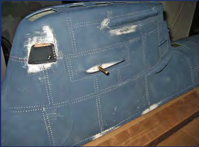
Die nachgebildeten Verschraubungen, hier am Turm
