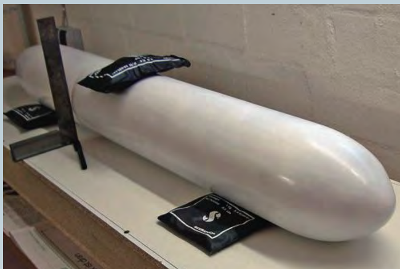
Übertragung der Umrisse des Urrumpfes auf die Platte der Trennebene
