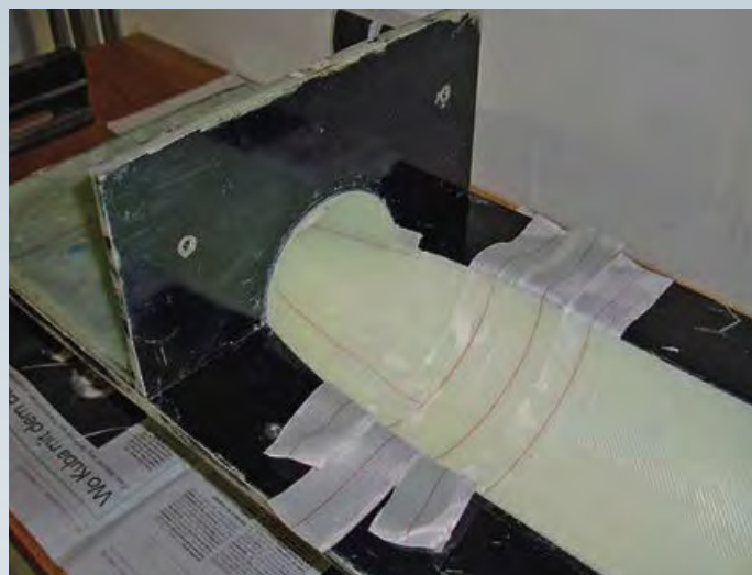
▲ Die beiden Rumpfteile werden getrennt laminiert ... ... und erst dann zusammengefügt ▼
