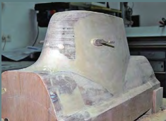
▲ Urform des Turms aus verleimten Multiplexplatten
