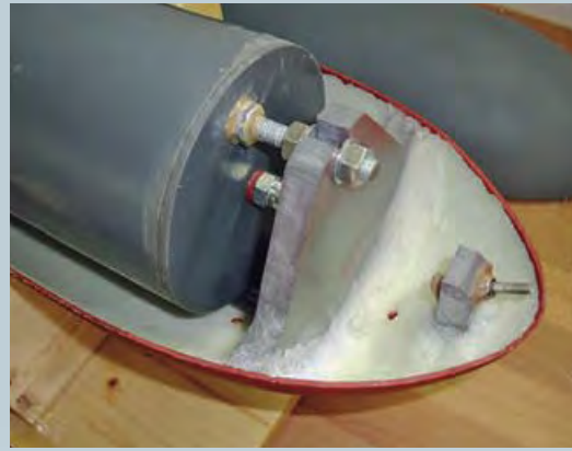
Vordere (▲) und hintere Halterung (►) der Technik im Rumpf. Unten die mit Blei gefüllten Ballastrohre
