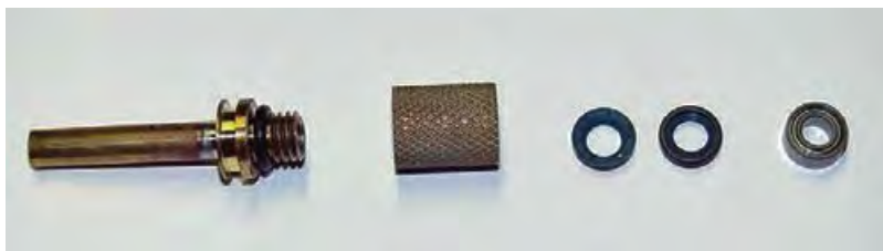
▲ Hier ist die komplett einbaufertige Einheit zu sehen. Wird der Ruderkoher kürzer gestaltet, ist die Abdichtung auch für Bootstypen interessant die keine feststehenden Ruderteile haben. Wasserseitig lässt sich der Ruderkoher eventuell mit einem Sinterlager bestücken
