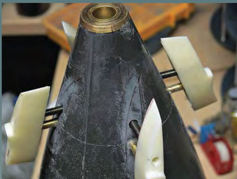
▲ Vor der Verklebung sind die Gewinde gut zu erkennen
