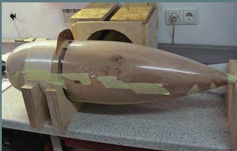
▲ Urform von Bugnase und Heckkegel
