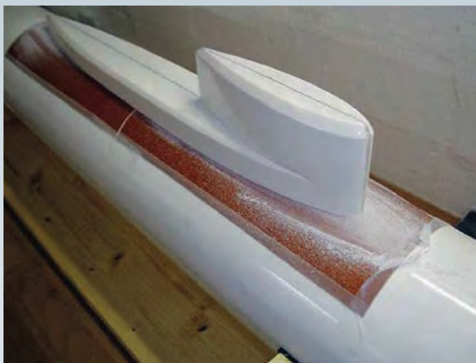
▲ Anpassung von Turm und Zwischendeck an den Rumpf durch Schleifpapier
