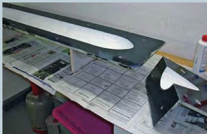
▲ Die beiden Rumpfteile werden getrennt laminiert ... ... und erst dann zusammengefügt ▼
