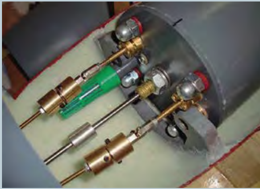
▲ Hier zu sehen die Verbindung der Technik mit den Einbauten im Rumpf. Unten der Filter für das Wasser aus dem Aquarienbedarf
