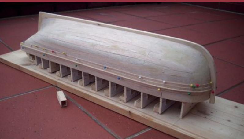
Der Rumpf wurde mit Epoxydharz gestrichen, das Unterwasserschiff mit Gewebe verstärkt
