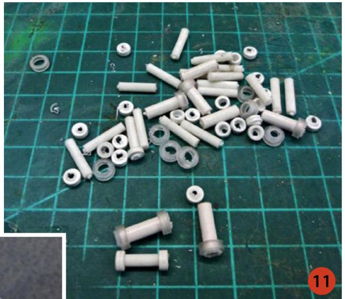
Bild 11 zeigt die Zuschnitte und Bild 12 ein montiertes Ventil. Diese Ventile stellen dann mit ABS-Rundmaterial als Hydraulikleitung die Hydraulikversorgung der großen Antriebsmotoren der Winden dar (Bild 13).
