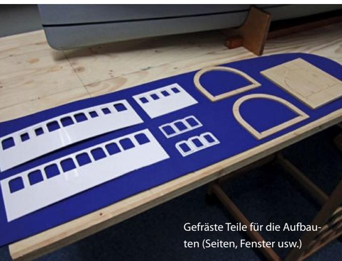
Gefräste Teile für die Aufbauten (Seiten, Fenster usw.)
