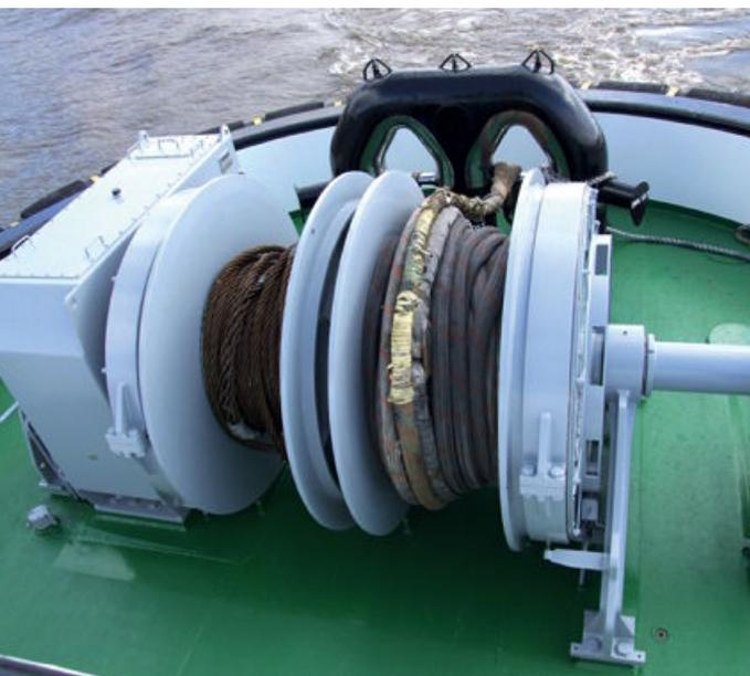
Auf dem Backdeck steht eine Doppeltrommelwinde mit Spillkopf und Ankerkettennüssen
