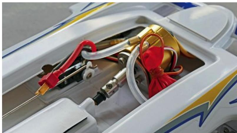
Der Wellenstrut kann verstellt werden, die Einstellung aus der Box ist allerdings in Ordnung
