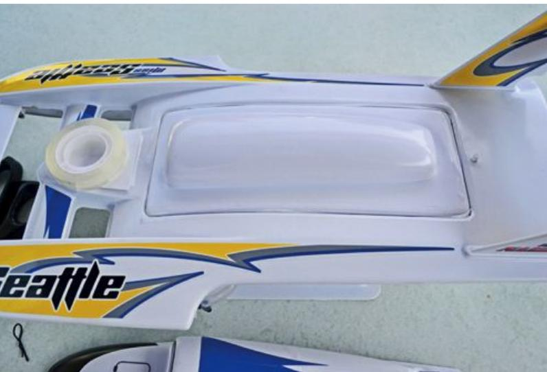
Der Deckel kann separat verklebt und die Haube anschließend aufgesetzt werden. Eine pfiffige Lösung
