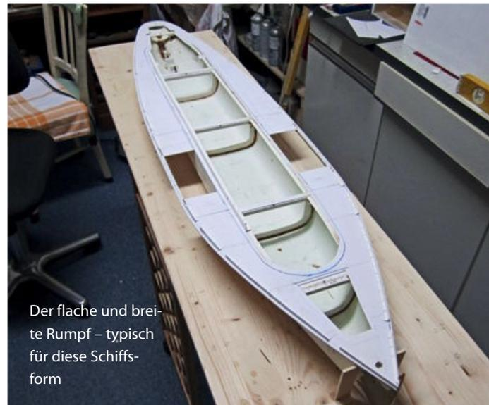
Der flache und breite Rumpf – typisch für diese Schiffsförm
