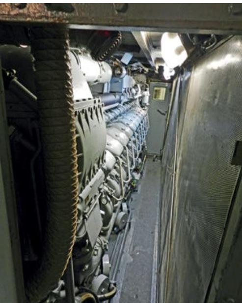
Die Antriebsdiesel vom Typ MTU 20V 956 TB 92 werden nur für Geschwindigkeiten bis 21 Knoten genutzt. Bei höheren Geschwindigkeiten kommen die Gasturbinen zum Einsatz
