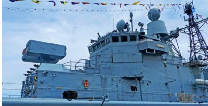
Vor der Brücke der Sea Sparrow-Starter, direkt über den vorderen Brückfenstern das Nucleus 2-Navigationsradar, dahinter das Feuerleitradar STIR, erhöht das Radom des Feuerleitradars WM25
