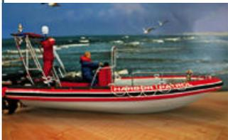
**Harbour Patrol, Modell eines Polizei- und SAR-RIBs im Maßstab 1:20**, Länge 370 mm, vorgesehen für eine Motorisierung mit zwei Außenbordern. Rumpf/Deck aus GFK, Aufbauten aus ABS/Resin/Messing. Bausatz-Preis 69,95 €.
