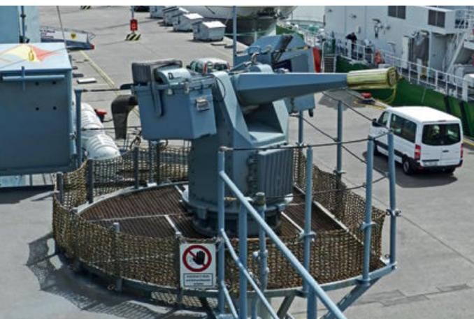
Das Marineleichtgeschütz (MLG) 27 vom Kaliber 27 mm des Herstellers Rheinmetall baut auf der Mauser BK 27 auf. Die *Lübeck* hat zwei solcher Automatikgeschütze an Bord, hier sieht man die Backbordwaffe
