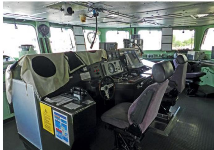
Die Höchstgeschwindigkeit der *Lübeck* ist geheim, sie liegt aber bei mehr als 32 Knoten. Über den Fahrhebeln ist der Kompass als Rundinstrument zu sehen
