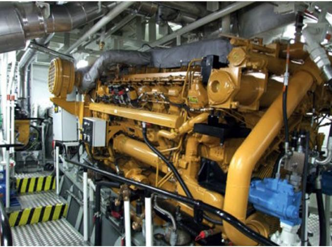
Die Backbord-Hauptmaschine von Caterpillar mit kurzer, gerader Welle
