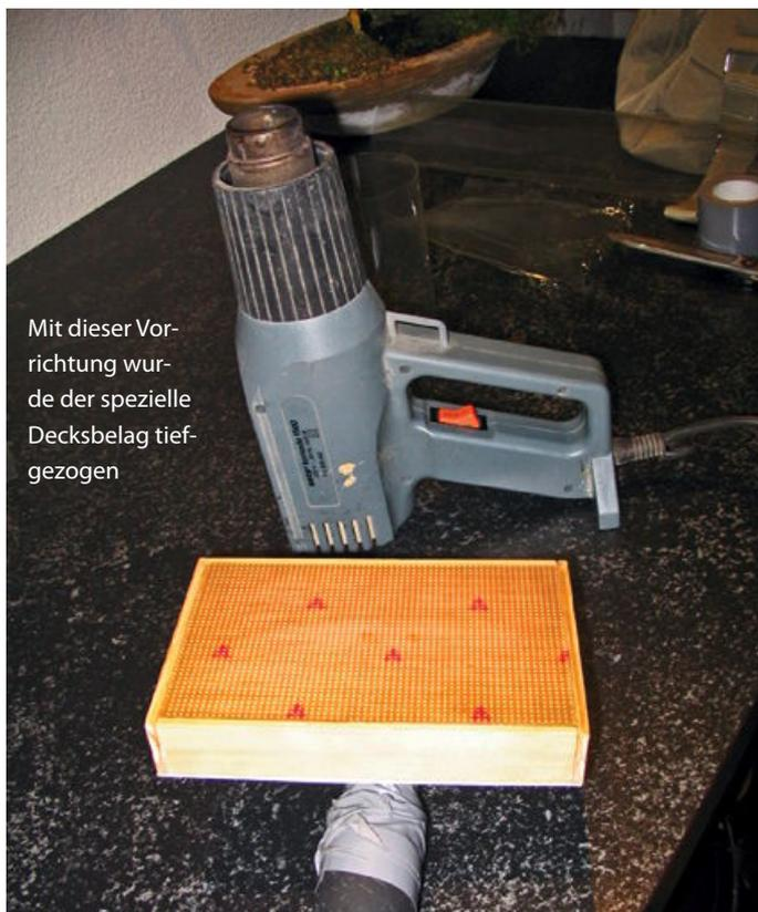
Mit dieser Vorrichtung wurde der spezielle Decksbelag tiefgezogen
