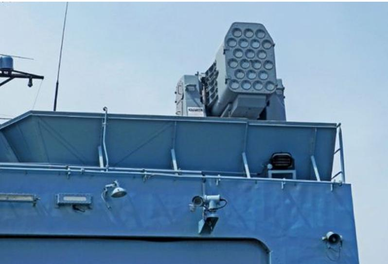
Auf dem Dach des Hangars befinden sich zwei RAM (Rolling Airframe Missile)-Starter mit jeweils 21 Zellen, aus denen der Nächstbereichsflugabwehrkörper verschossen wird. RAM basiert technisch auf der Luft-Luft-Rakete AIM-9 Sidewinder
