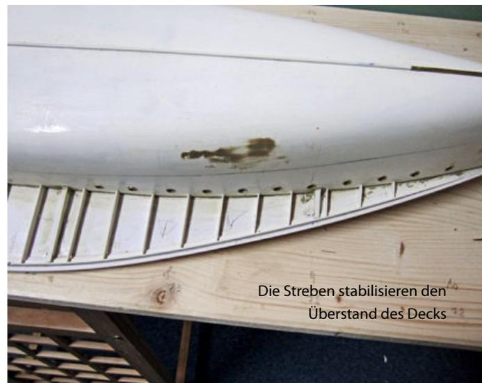
Die Streben stabilisieren den Überstand des Decks
