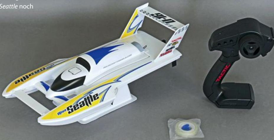
Die beiden Sponsons bieten eine separat angebrachte glatte Lauffläche mit scharfer Abrisskante. Das verhilft zu höherer Geschwindigkeit und ruhigerer Fahrt
