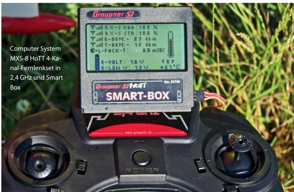
Computer System MXS-8 HoTT 4-Kanal-Fernlenkset in 2,4 GHz und Smart Box
