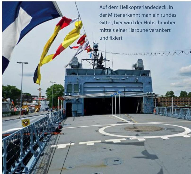
Auf dem Helikopterlandedeck. In der Mitte erkennt man ein rundes Gitter, hier wird der Hubschrauber mittels einer Harpune verankert und fixiert
