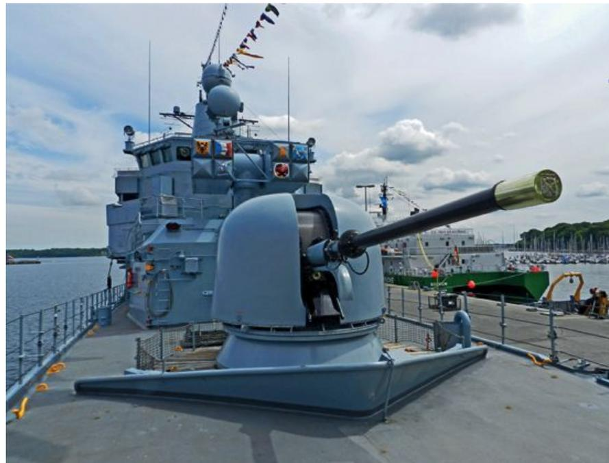
Das 76/62 Compact-Schiffsgeschütz des italienischen Herstellers Oto Melara kann maximal 85 Schuss pro Minute abfeuern. Um ein Überhitzen zu verhindern wird nach dem ersten Schuss eine Rohrkühlung eingeschaltet
