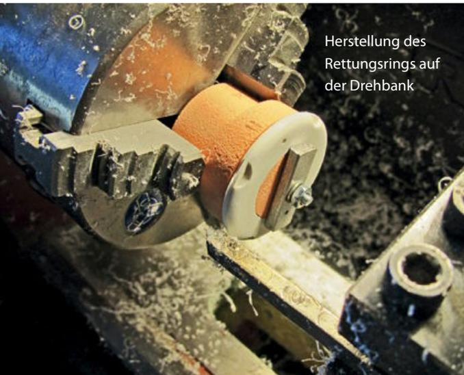
Herstellung des Rettungsringes auf der Drehbank
