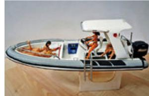
**Miami, RIB-Sportboot im Maßstab 1:20**, Länge 330 mm, vorgesehen für eine Motorisierung mit ein oder zwei Außenbordmotoren. Rumpf/Deck aus GFK, Aufbauten aus ABS u. Resin. Bausatz-Preis 69,95 €.
