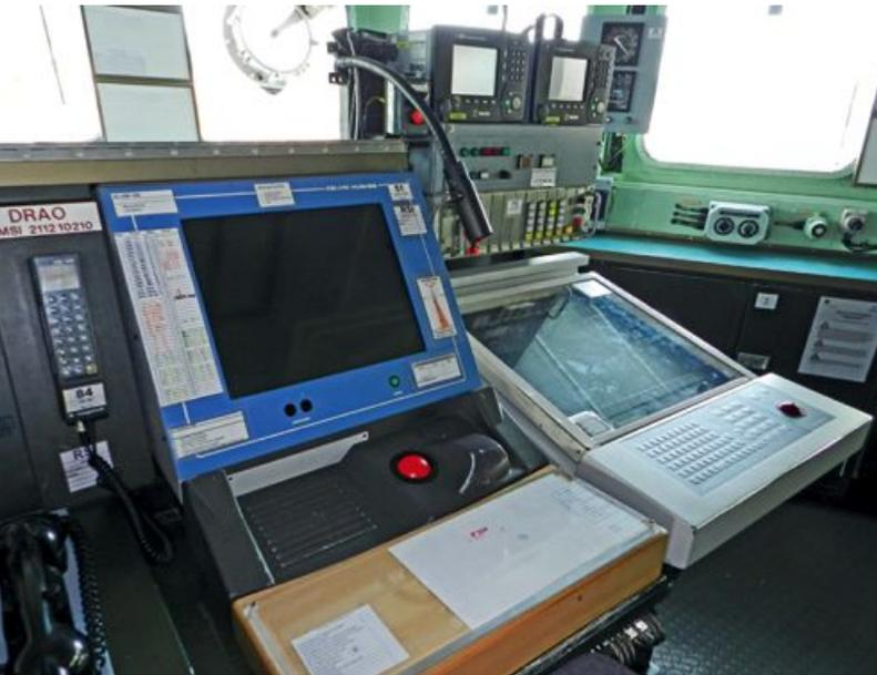
Unmittelbar neben dem Steuerstand angeschlossen befindet sich die Bedienkonsole des Navigationsradars Nucleus 2. Mit dem roten Trackball kann die Darstellung von einzelnen Radarkontakten ausgewählt werden
