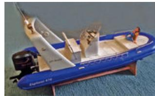
**Explorer 676, Modell eines Sportboot-RIBs im Maßstab 1:10**, Länge 676 mm, Rumpf und Deck aus GFK, Aufbauten aus ABS, VIVAK, Resin. Vorgesehen für Außenborder der 500er-Motoren-Klasse bis 650er-Motoren-Klasse bzw. vergleichbare Brushless-Motoren. Bausatz-Preis 149,90 €.
