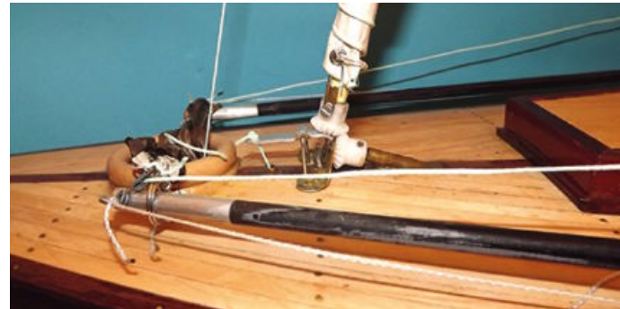
Ein Blick auf die Rollfock-Mechanik: Einrollen – Kegelzahn-räder greifen ineinander, ...
