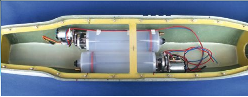
Position der Tauchpumpen
