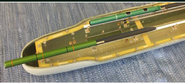
Bei abgenommenem Oberdeck: Sirena ausgefahren, die Minen befinden sich noch im eingefahrenen Zustand
