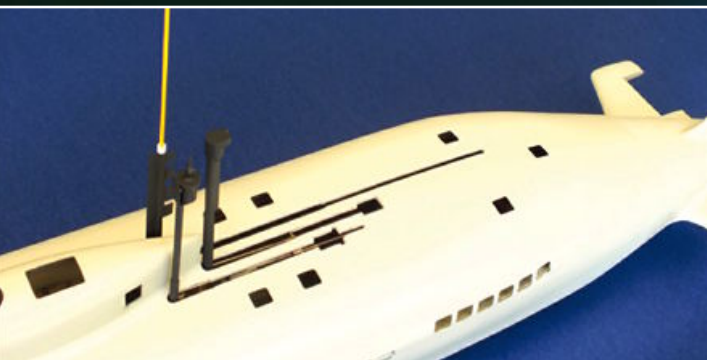
Aufrichtgeräte im Oberdeck ausgefahren
