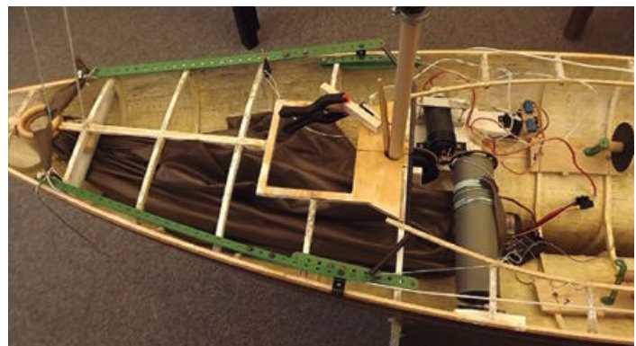
Hier die Ruhestellung: Der Spi ist durch die „Trompete“ auf dem Vorschiff (Holzring ganz links im Bild) von einer Walze (grau) unter das (noch nicht vorhandene) Deck hereingezogen und zum Teil aufgewickelt worden. Die Spi-Bäume (grüne Flach-Metall-Stangen), an denen die unteren Schothörner des Spis befestigt sind, liegen auf dem (imaginären) Vorderdeck
