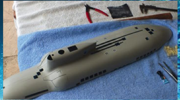
Erste Flutschlitze im Oberdeck
