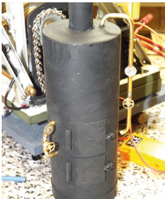
Der Kessel wird von einer Plexiröhre dargestellt, darin befinden sich Akku, Empfänger und Regler
