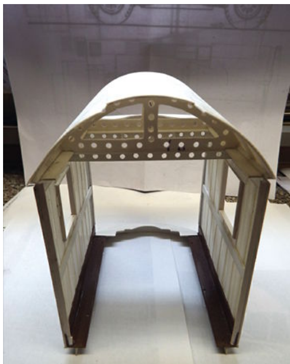
Die Kranhütte wurde aus ABS-Kunststoff verschiedener Stärken hergestellt
