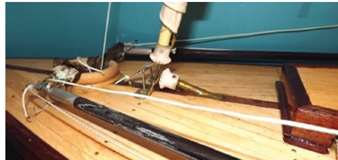
Ein Blick auf die Rollfock-Mechanik: Einrollen – Kegelzahn-räder greifen ineinander, ...
