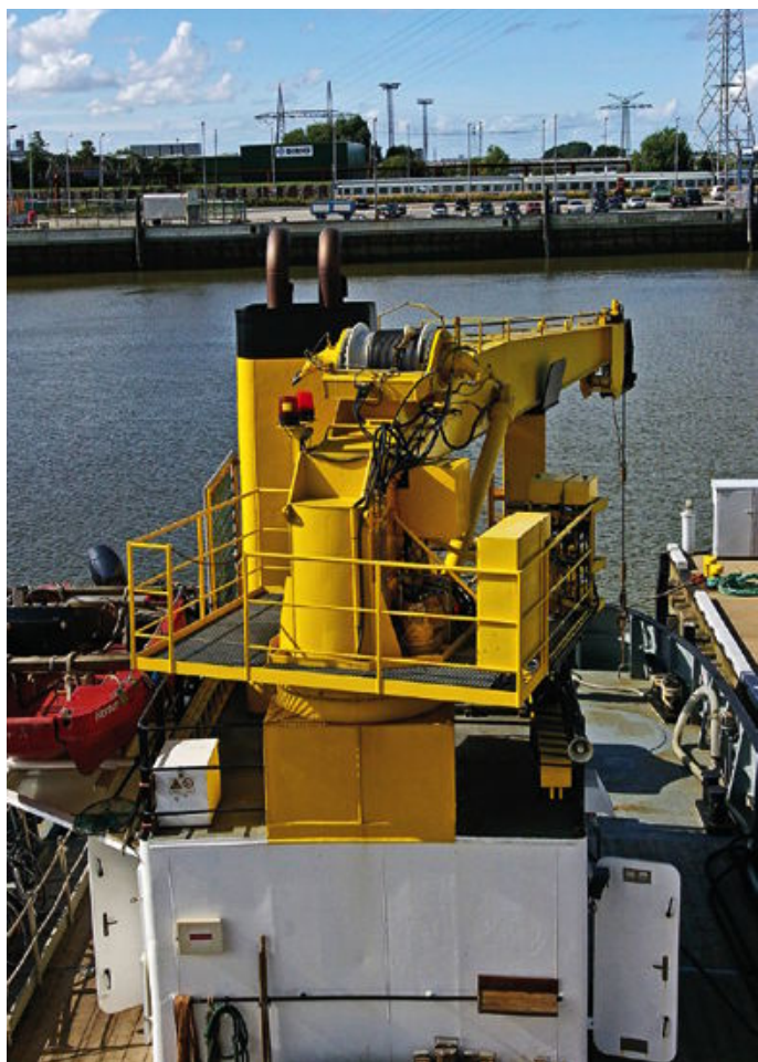
Der Kran sitzt bei der Norden auf dem hinteren Aufbau
