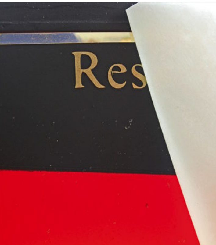
Nach dem Abziehen des Transfermaterials haftet die Folie am Untergrund
