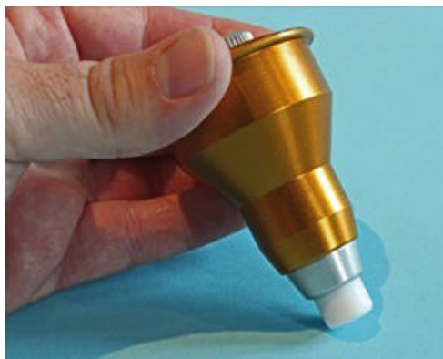
Das Messer kann um bis zu einen Zentimeter einfedern, sodass es auch bei unebener Fläche stets sauber am zu schneidenden Material aufliegt
