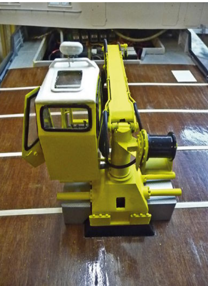
Der Kran mit Winde und Scheinwerfer
