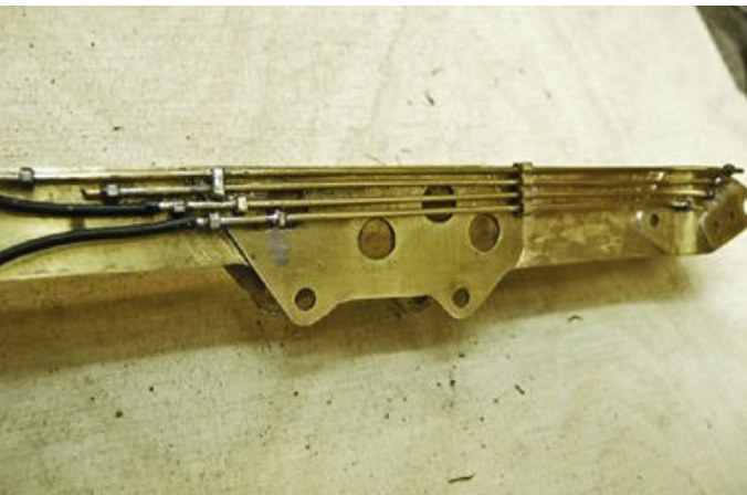
Die Hydraulikleitungen sind angebracht
