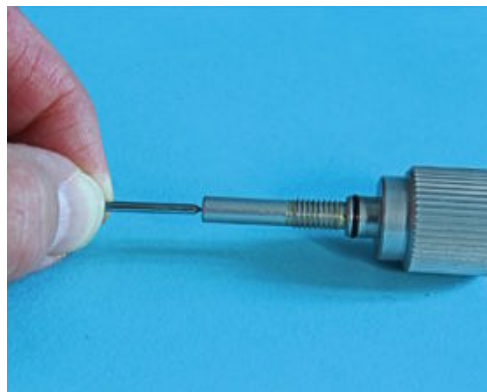
Die Berührungsfläche des Schleppmessers am Magneten ist ein Punkt, es kann sich perfekt drehen
