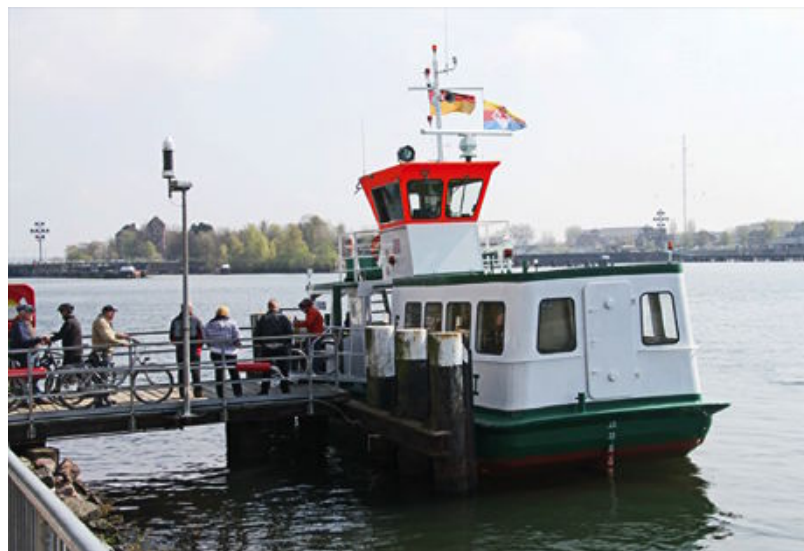
Den Landgang, oder auch Gangway, kann der Fährführer hydraulisch hoch- und runterfahren
