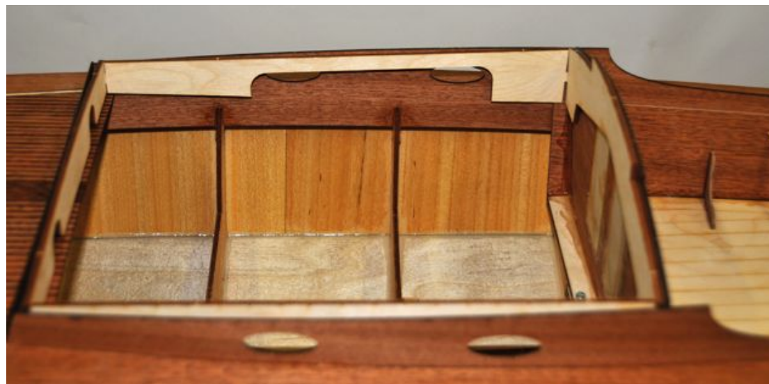
Zum Verkleben des Kajütdaches werden die Seitenwände wieder mit Trennfolie abgedeckt. Hier werden aufgeschnittene und in Streifen geschnittene Frischhaltebeutel verwendet
