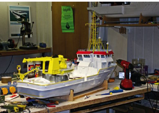
Abschnittsweise wurde das Modell in den Grundfarben lackiert
