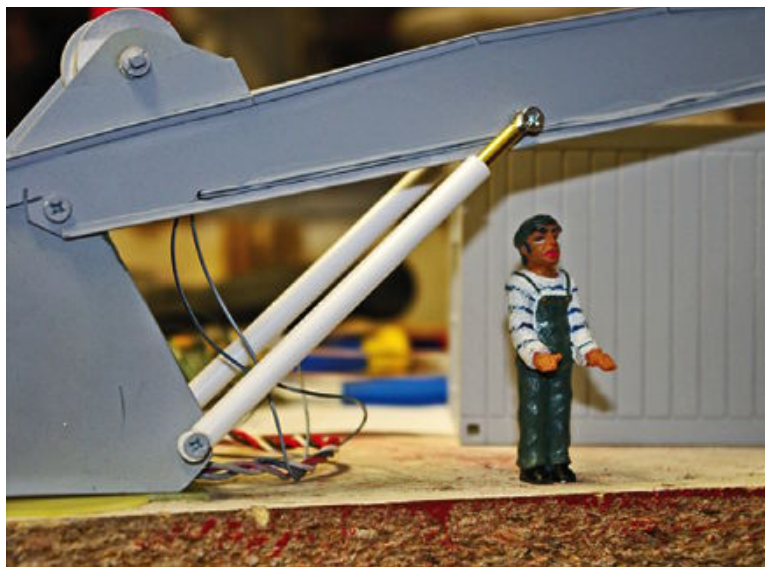
Die Attrappen der Hydraulikzylinder aus Polystyrol und Messing ▶
