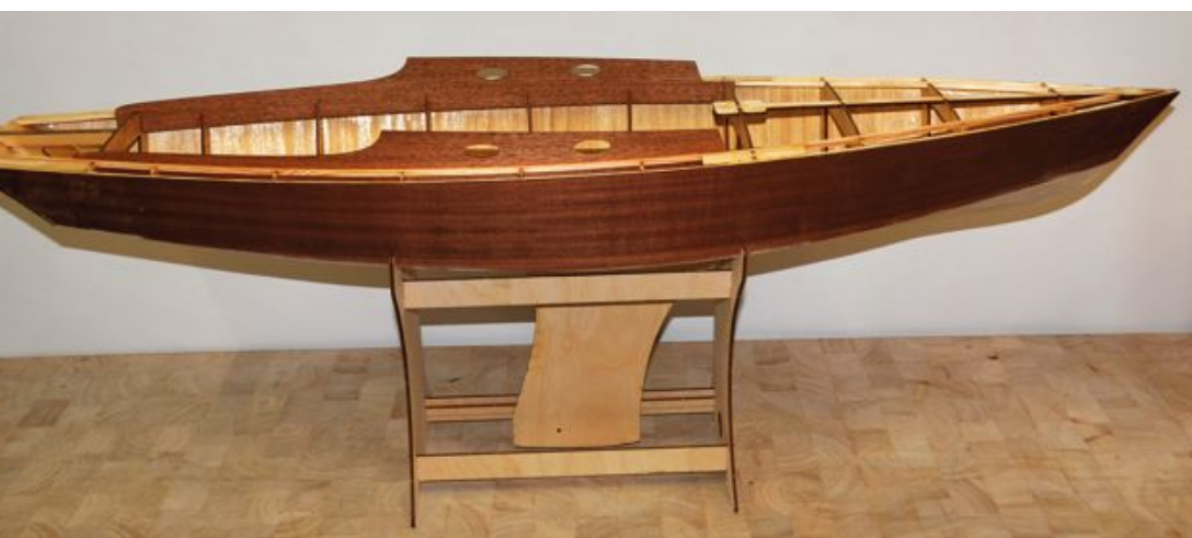
Die Seitenteile des Aufbaus und die Decksstringer sind eingebaut. Die Stringer werden ordentlich verklebt, die Seitenwände nur geheftet und später mit dem Deck verklebt. Jetzt wird der Rumpf innen versiegelt und so gegen Feuchtigkeit geschützt
