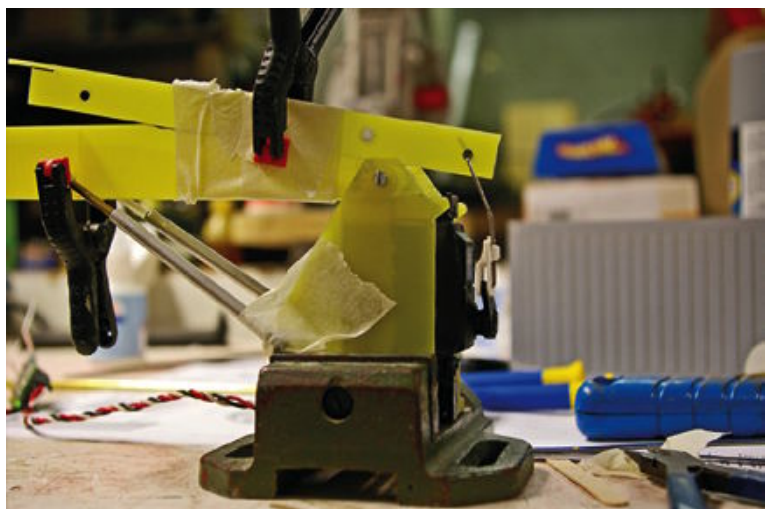
▲ Die Komponenten des Krans aus Leiterplattenmaterial sind probenhalber montiert
