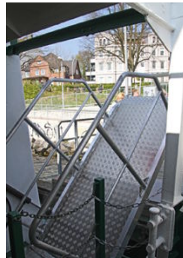
Den Landgang, oder auch Gangway, kann der Fährführer hydraulisch hoch- und runterfahren
