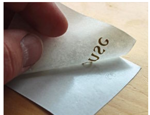
Mittels Transferpapier oder -folie wird die geschnittene Beschriftung übertragen
