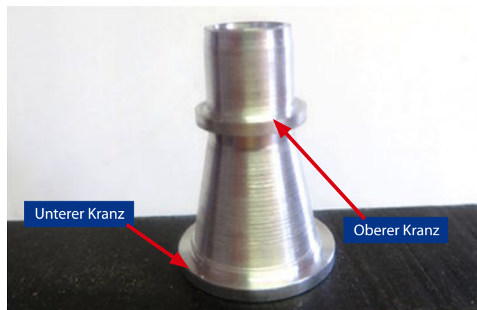
Der Fuß des Löschmonitors nach der Bearbeitung in der Drehmaschine
