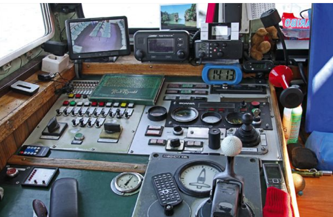
Am Steuerstand der „Adler 1“ geht es eng zu: nur wenig Platz benötigt dabei die Steuerung des Schottelantriebes (vorn rechts)
