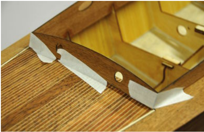
Die Vorderwand der Kajüte wird, ebenso wie das Deck, mit angedicktem 30-Minuten-Epoxi eingeklebt, denn die Teile sind vor dem Einkleben schon mit Lack imprägniert
