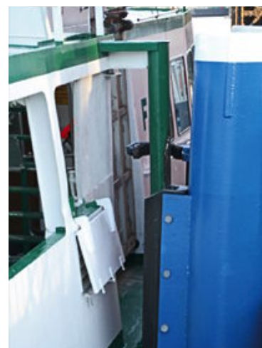
Mit der Haltestange an Bord muss der Kapitän den Fanghaken am Anleger genau treffen, um die Fähre exakt zu positionieren
