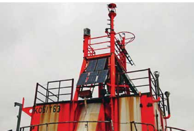
Nur der kleine graue Kasten am Mast ist heute noch für die Funktion als Seezeichen notwendig
