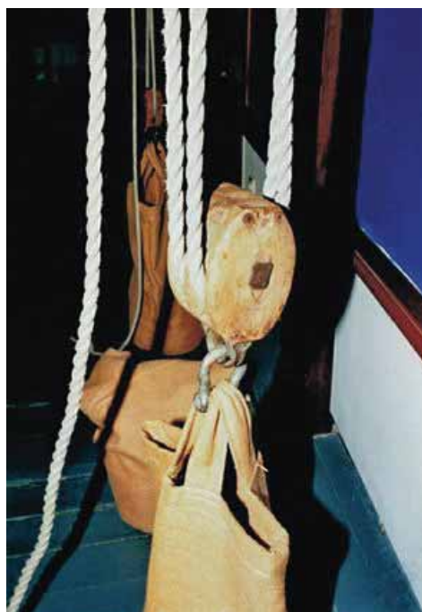
Umlenkrolle bzw. Block zum Heben von Lasten auf Fehnschiffen
