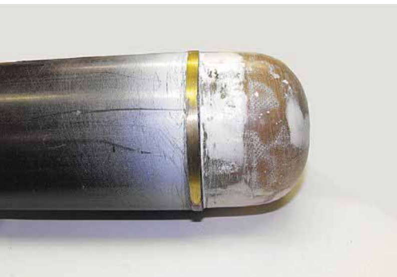
Ein Überraschungsei war das Urmodell für den Bug aus GFK
