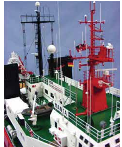
Das Peildeck mit Hauptmast und Signalmast ▶
