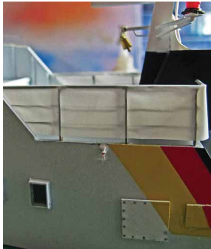
Die Stoffbespannung der Reling beim 1:50-Boot entstand aus einer Plastiktüte
