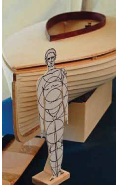
Kleines Vorbild, großer Maßstab, der „Maßstabsmann“ aus Pappe macht die Größenverhältnisse des im Bau befindlichen Rumpfes deutlich
