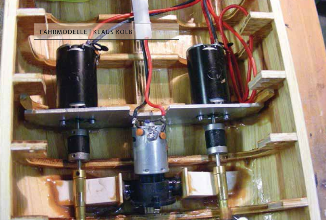
Der Antrieb mit Hochlastkupplungen
