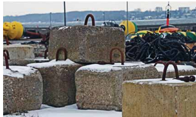
Die Standarttonnen werden nur mit Ankersteinen auf Position gehalten
