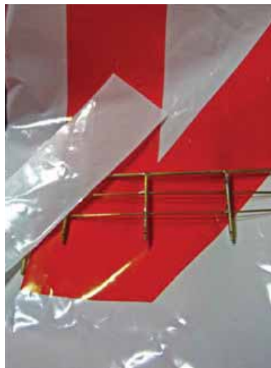
Die Stoffbespannung der Reling beim 1:50-Boot entstand aus einer Plastiktüte
