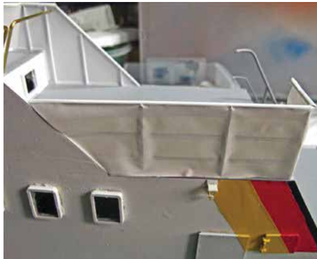
Für den Maßstab 1:30 eignet sich Gewebefolie von Oracover, die aufgebügelt wurde
