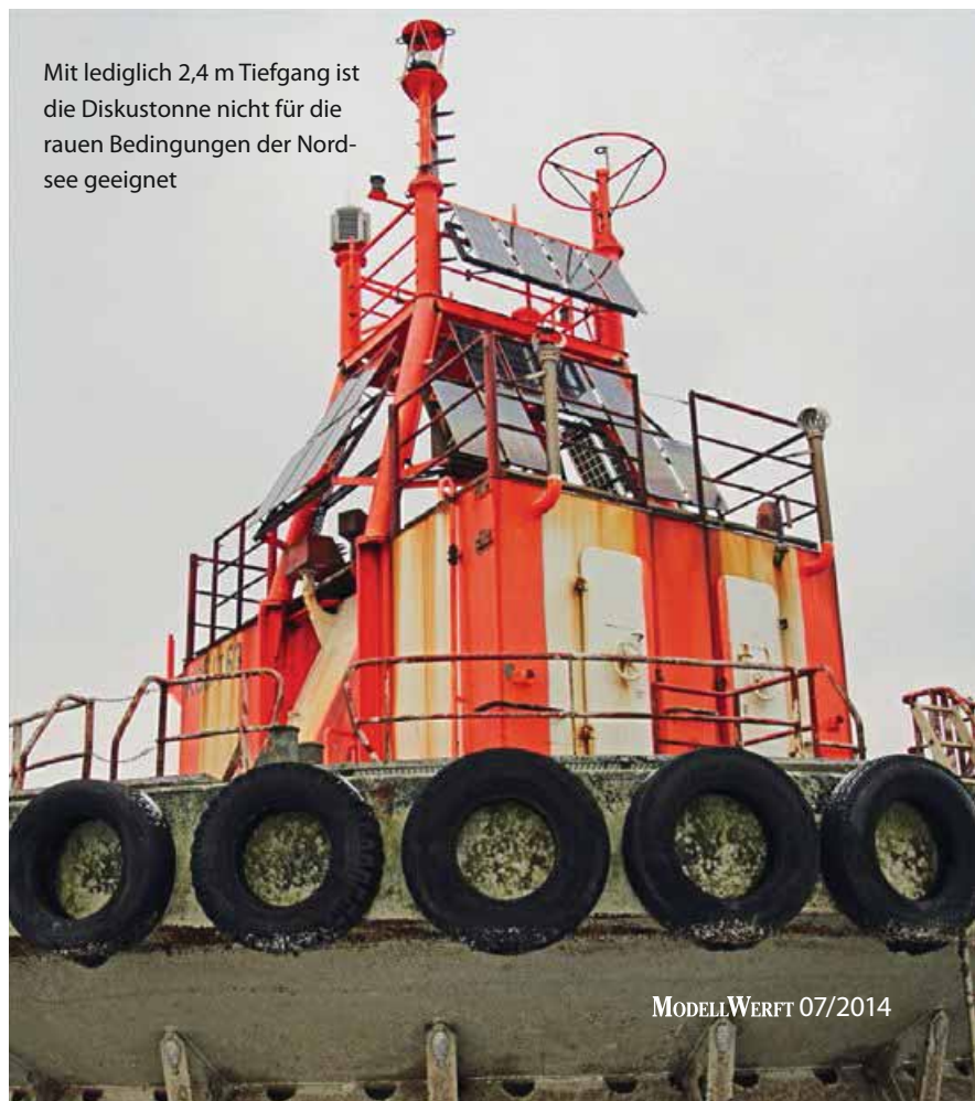
Nur der kleine graue Kasten am Mast ist heute noch für die Funktion als Seezeichen notwendig
