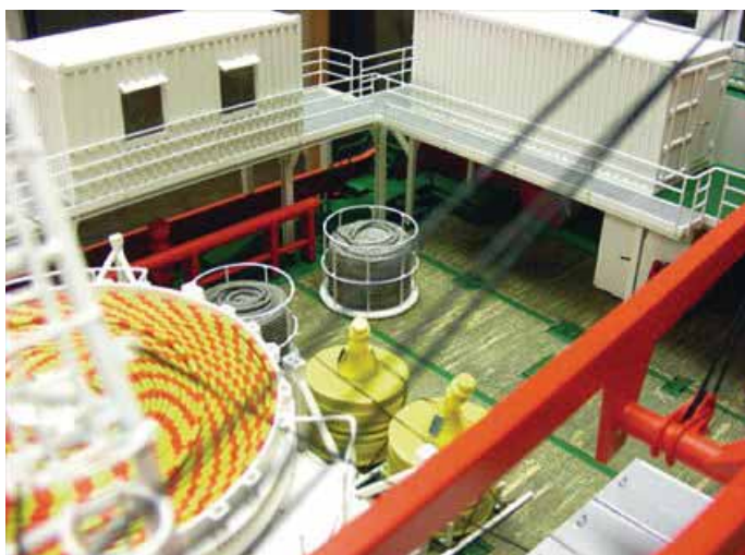
Der Kabeltank auf dem Arbeitsdeck mit den Funkbojen
