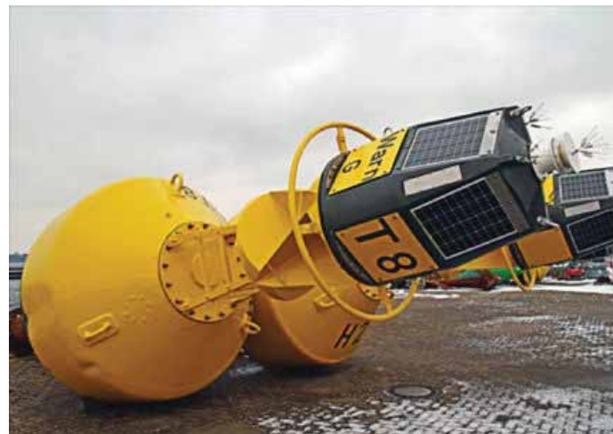
Die Tonne vom Typ LT 81 wird in vielen Varianten eingesetzt, hier in der Ausführung als Warngebietstonne
