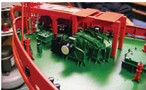
Die Ankerwinde und die Kettenstopper
