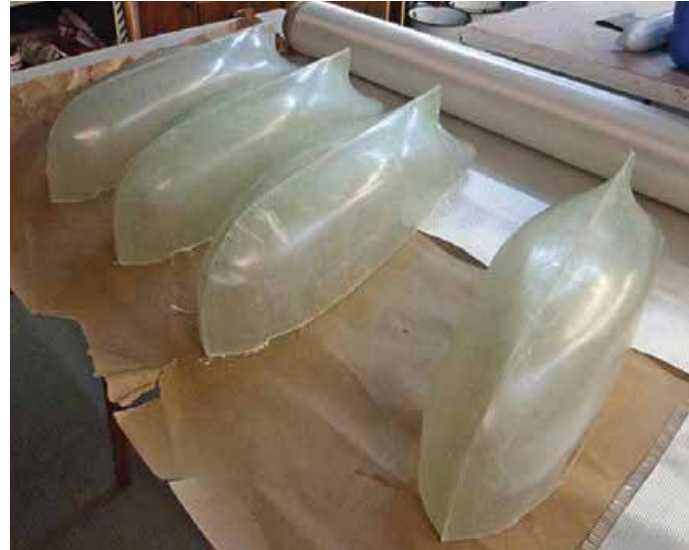
Die ersten ausgeformten Rümpfe
