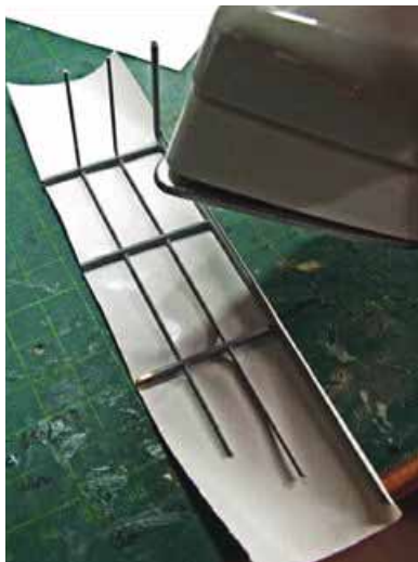
Für den Maßstab 1:30 eignet sich Gewebefolie von Oracover, die aufgebügelt wurde
