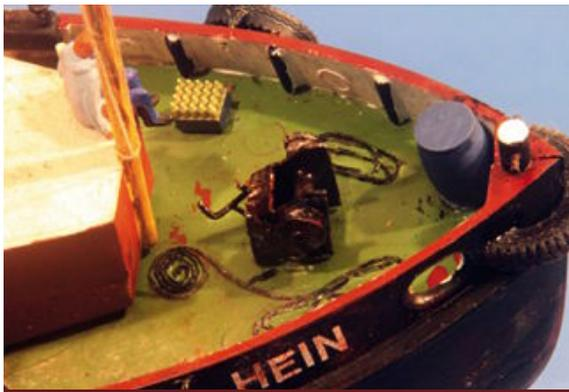
Die Bierkiste tarnt den Einschalter und unter der Bugwinde sitzt die Ladebuchse
