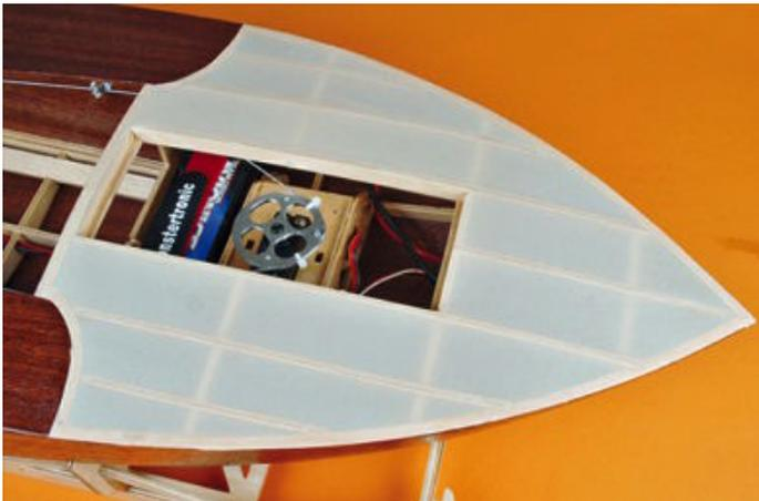
Folien-Überstand allseitig abschneiden, nach dem Föhnen ist das Deck fertig
