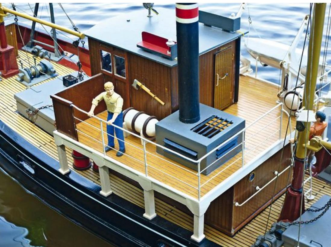
tigkeit) zu sehen. Also schliﬀ ich das Deck so gründlich ab, dass schließlich auch nichts mehr von diesen Flecken übrig blieb. Mit einer dünnen Spritze füllte ich die Spalten zwischen den Planken mit verdünntem, schwarzem Kunstharzlack und überzog nach dem Trocknen des Lackes das Deck mit zwei Schichten mattem 2K-Acryl-Klarlack.
