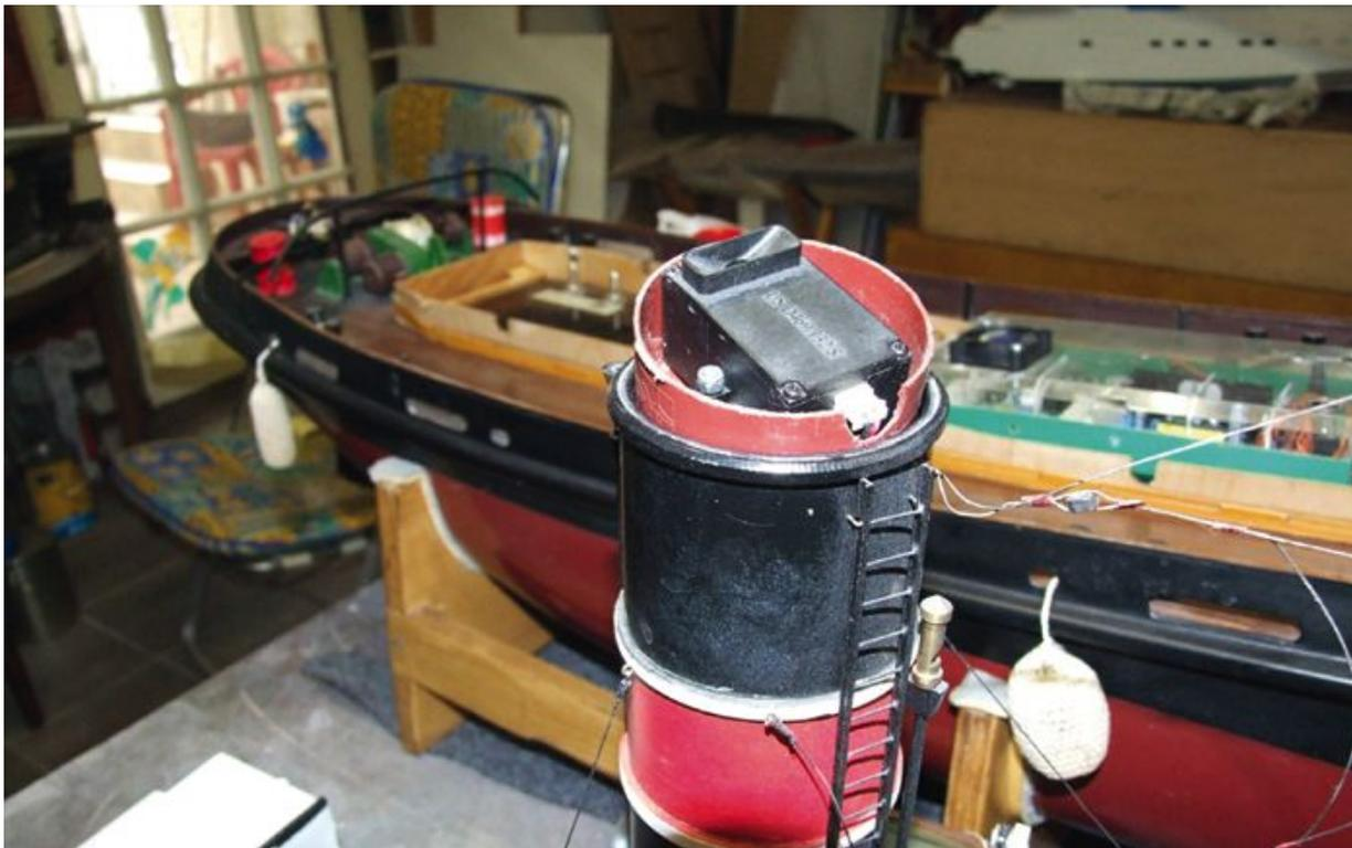
den Abstand zur Wärmequelle nach Möglichkeit zu vergrößern. Schalter und Kabel wurden anders angeordnet bzw. verlängert und neu verlegt, um den Gegebenheiten Rechnung zu tragen.
