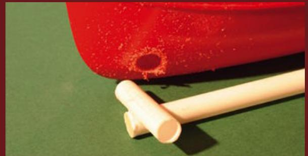
Aus zwei 6-mm-Evergreen-Rohren entsteht die Aufnahme des Bugstrahlruders
