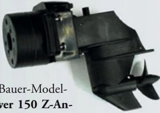
Neu bei Bauer-Modelle: **G-Power 150 Z-Antrieb**, geeignet für kleine und mittelgroße Motorboote (nicht geeignet für Rennboote). Alle Wellen sind mit Edelstahl-Kugellager doppelt gelagert. Features: Messingkegelräder, Neigungswinkel verstellbar, Lieferung ohne Motor, Preis 90,- €.
