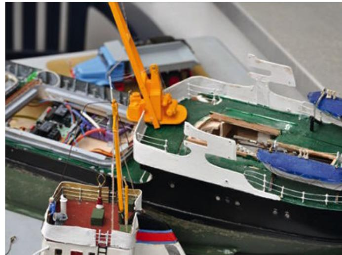
Der Zugang zum Inneren erfolgt über Ladeluken und Aufbauten
