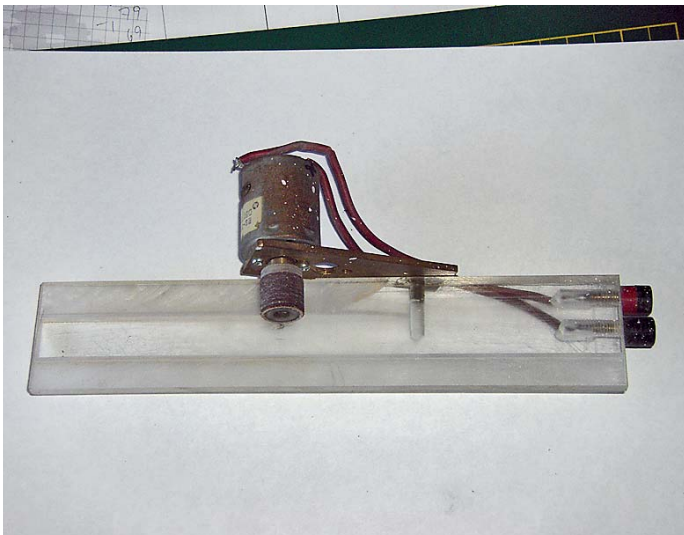
Kein Kabelsalat: Die Buchsen für die Spannungsversorgung sind in die Grundplatte integriert
