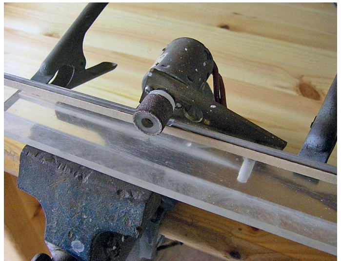
Am festgeklebten Anschlag werden die Leisten sicher geführt
