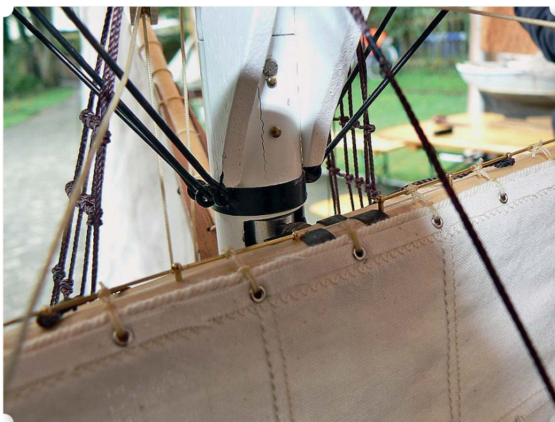
◀ Detail: Rah-verstellung bei der Seaflower
