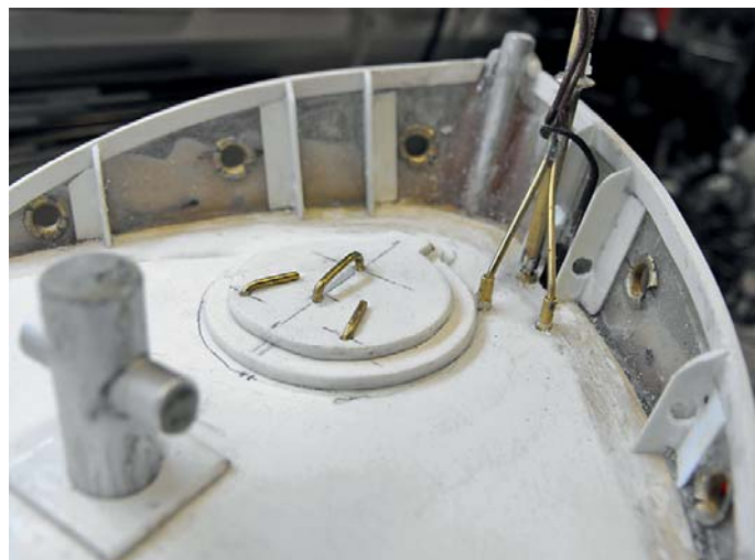
Viele Details aus Messingdraht und -röhrchen verschönern das Modell
