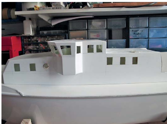
Alle Öffnungen sind eingefräst
