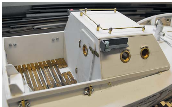
Deck und Aufbau bestehen aus Polystyrol, das sich hervorragend verarbeiten lässt
