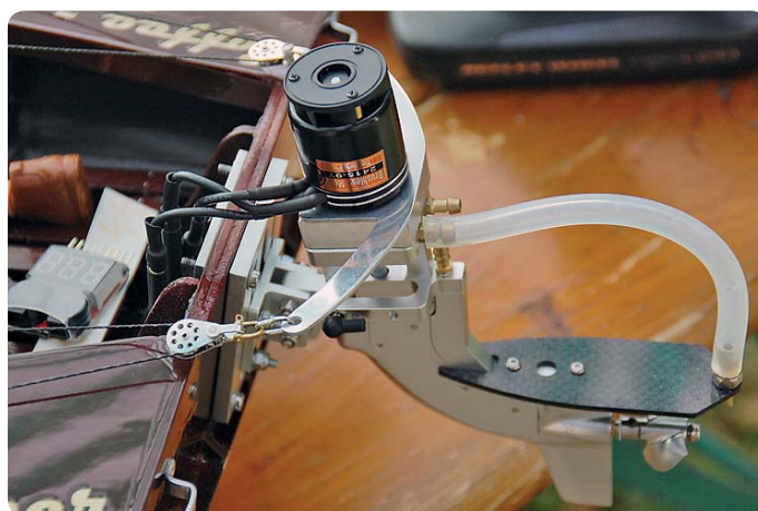
Trotz Problemen mit dem mangelhaften Wellenlager hat sich der TFL-Außenborder als sehr preisgünstige Alternative zu höherwertigen Antrieben etabliert (Foto: Eberhard Gericke)
