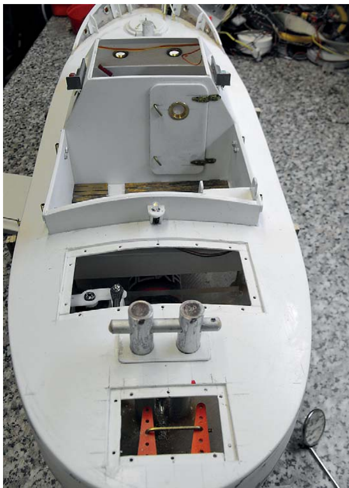
▲ Blick auf die Anlenkung des Doppelruders
