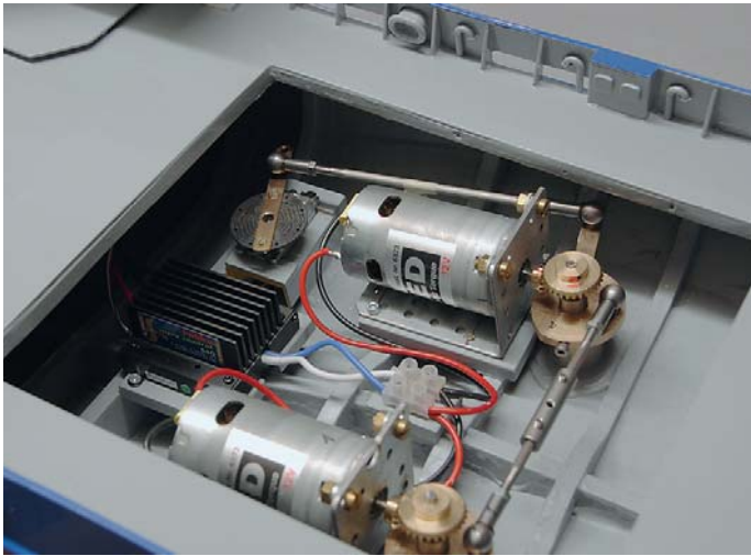
Zwei Speed 900 BB Torque von Graupner treiben die Schottel über ein Winkelgetriebe an
