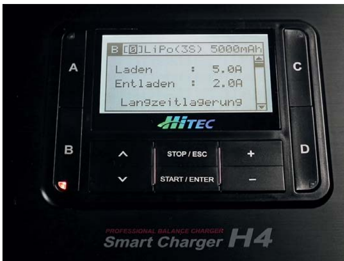
Zehn Tasten und ein riesiges hintergrundbeleuchtetes Display sorgen im Zusammenspiel mit der updatefähigen Software für Übersicht und einfache Bedienung
