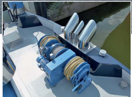
Heckwinde mit Edelstahlauspuffanlage
