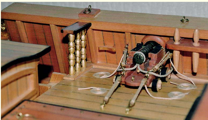
Aufstellung und Befestigung der Achterkanone mit Brook- und Rückstoßtauen sowie dem Richtkeil des Kanonenrohres
