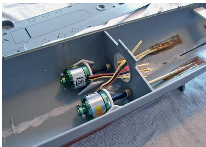
Zwei 3-Blatt-Propeller mit 20 mm Durchmesser treiben die Fletcher an
