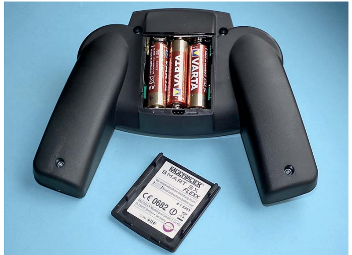
Unter dem Batteriedeckel auf der Rückseite ist ein Port versteckt, mit dem der Sender per USB-Adapter bei Bedarf mit aktualisierter Software auf den neuesten Stand gebracht werden kann
