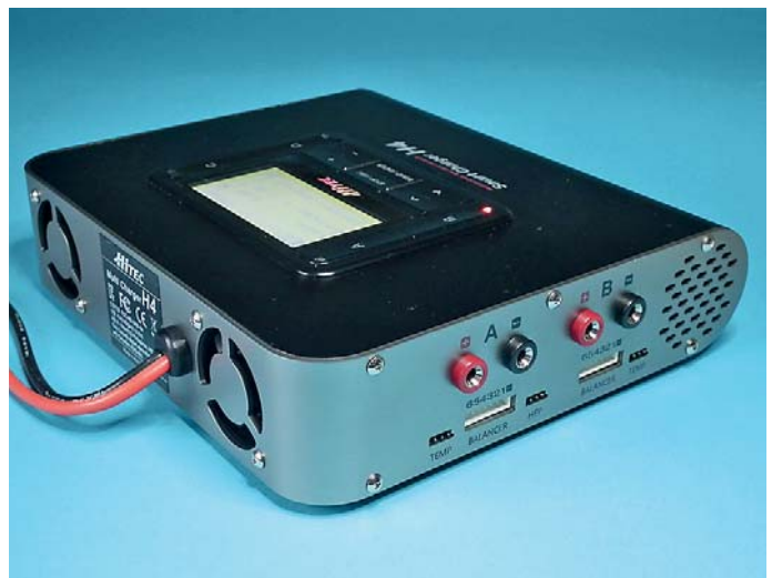
Zwei Ladeports (A und B) sind mit Balancer- und Temperatursensor-Buchsen auf der linken Seite untergebracht, hinten ist der Versorgungsanschluss
