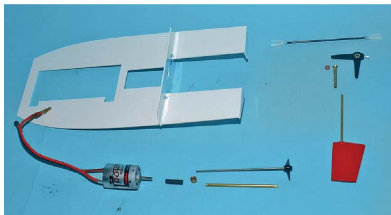
Vorbereitung für den Einbau in den Rumpf
