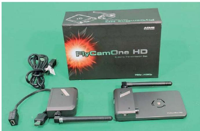
Der Schritt Richtung „FPV“ ist dann mit dem 5,8-GHz-Transmission-Set getan. Außer dem Sende- und Empfangsmodul finden wir hier ein weiteres USB-Ladekabel und ein Buskabel im Lieferumfang
