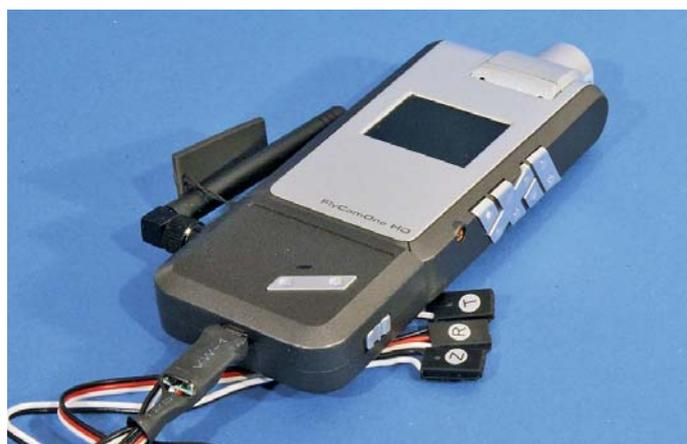
Sehr sinnvolles Zubehör ist das RX-Kabel. Über entsprechende Servokanäle können Zoom, Schwenk und Aufnahme gesteuert werden. Außerdem wird die Kamera darüber mit Strom versorgt. Hat man dann noch die V-Eyes mit dem passenden Schülerkabel, geht die Ansteuerung auch per Kopfbewegung
