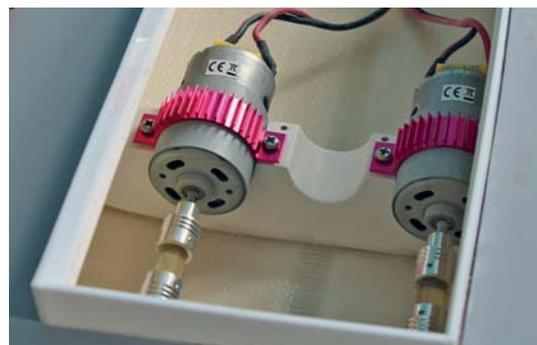
Die Motoren sind bereits fertig eingebaut und mit den Wellen verbunden
