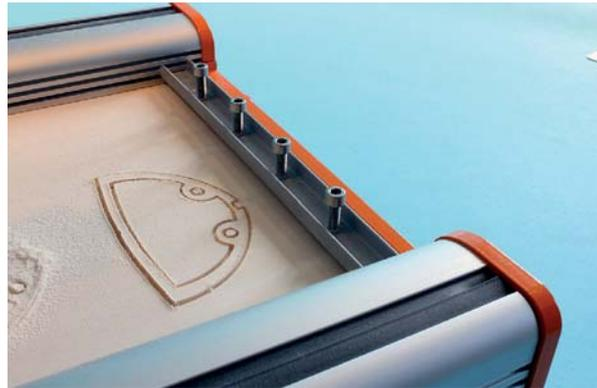
◀ Ein pfiffiges Detail sind die integrierten Spannbrücken
