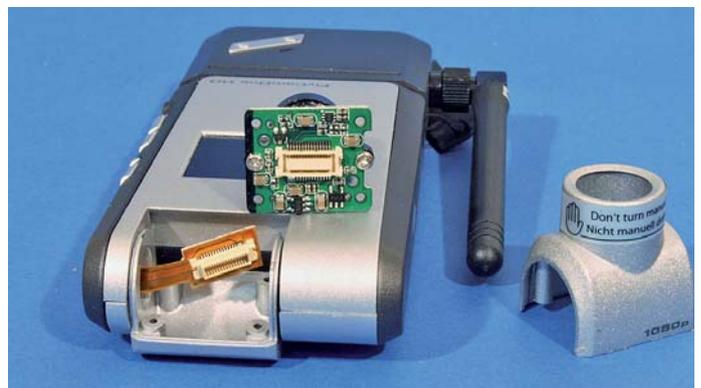
Das Flachbandkabel ist über einen kleinen Stecker mit der Kamera verbunden
