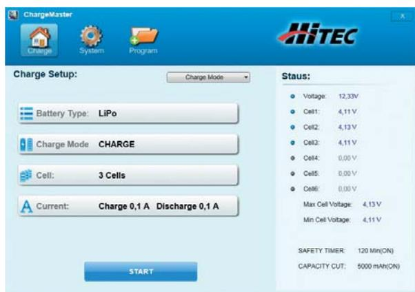
Schließt man einen Akku an den Lader an und ruft den ChargeMaster auf, sind in vier Untermenüs Akkutyp, Ladeart, Zellenzahl und Ladeparameter einstellbar
