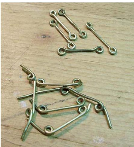
Rohlinge: vorne unbearbeitet aus der Lehre, hinten fertig bearbeitet und bereit zum Zulöten der Augen
