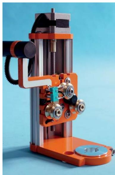
Die fertig montierte Z-Achse
