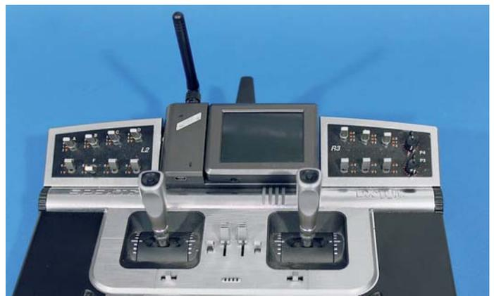
Die perfekte Symbiose. Die Empfangseinheit lässt sich mit etwas Klettband direkt am Sender befestigen und ist so immer dabei. Auch für die V-Eyes ist diese Art der Befestigung gut geeignet. Allerdings: durch die räumliche Nähe der Antennen fällt die Reichweite etwas geringer aus
