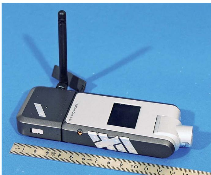
Mit montiertem Sender hat die FlyCam etwa 14 cm Länge
