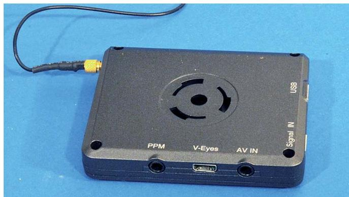
Das Basismodul verfügt über Anschlüsse für die Brille; PPM, also das Schülerkabel, und AV-In, an dem ein weiterer Monitor angeschlossen werden kann. Außerdem die Bedienelemente für Zoom, Lautstärke und dergleichen. Alternativ zu der Lehrer/Schüler-Anbindung kann auch die Linx-Verbindung zur Steuerung der Kamera benutzt werden
