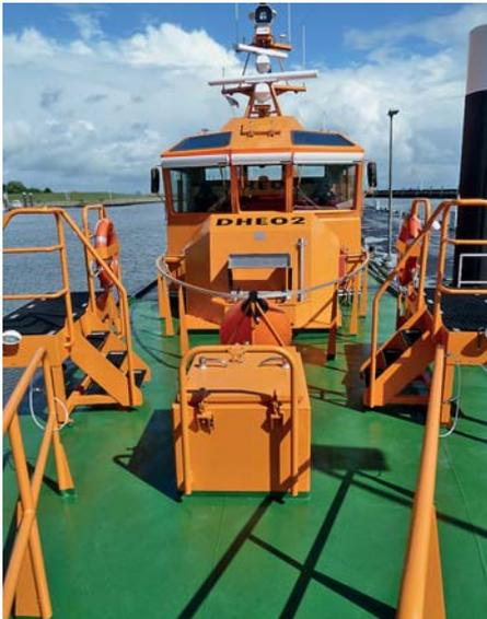
Das Vorderdeck der Warnemünde. Deutlich sichtbar: der Handrundlauf, in dem der Sicherheitsgurt läuft
