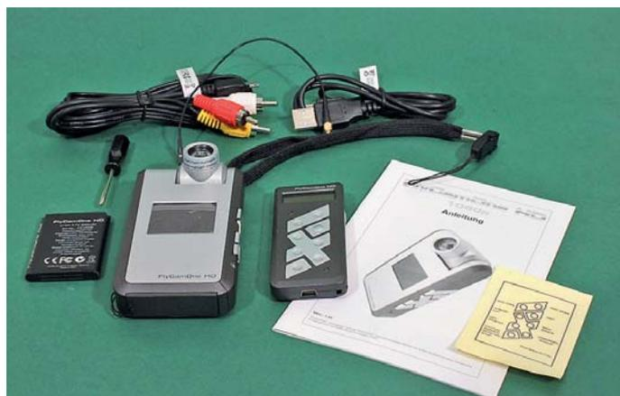
Nach dem Auspacken kommen außer Kamera und Fernsteuerung noch AV-Kabel, Akku, USB-Ladekabel und die Anleitung ans Licht
