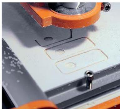
Polystyrol lässt sich mit dem STEPCRAFT-System und der empfohlenen Proxxon-Spindel genauso gut fräsen wie verschiedene Holzarten
