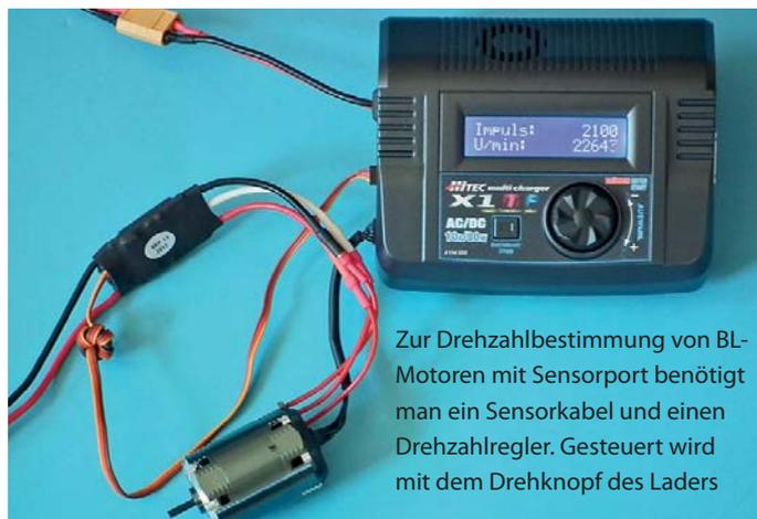
Zur Drehzahlbestimmung von BL-Motoren mit Sensorport benötigt man ein Sensorkabel und einen Drehzahlregler. Gesteuert wird mit dem Drehknopf des Laders
