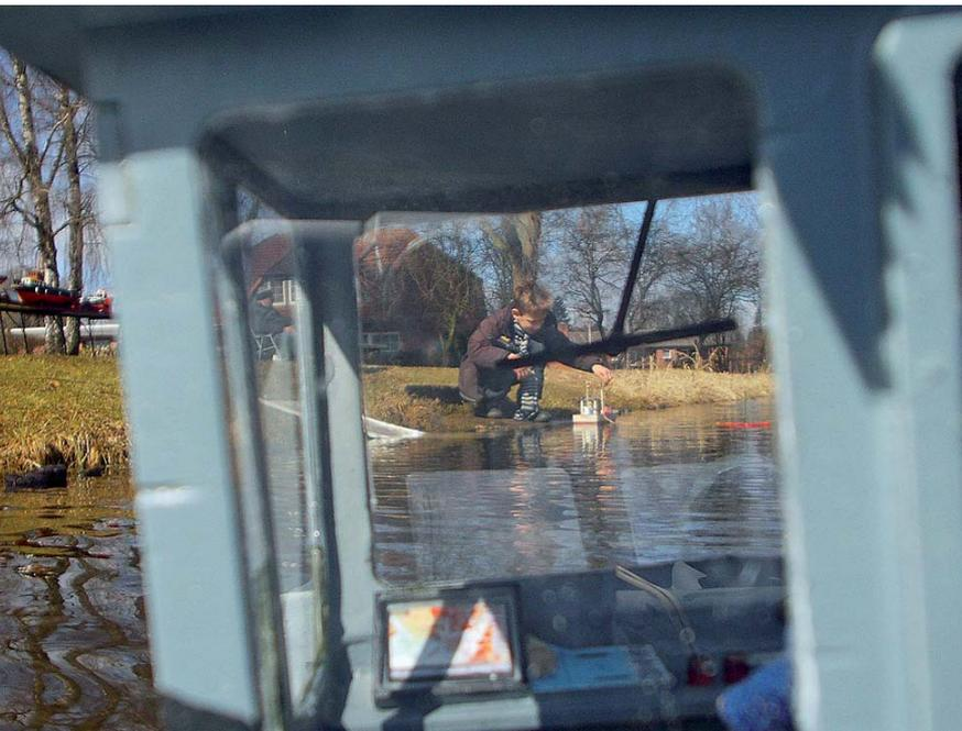
Hat die Brücke auch achtern Fenster, kann die Kamera einfach dahinter befestigt werden und muss nicht aufwendig im Inneren installiert werden
