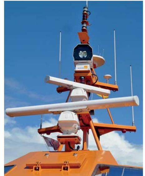
Eine der zwei Radaranlagen dient nur für den Notfall. Deutlich ist im Mast der Halogen-scheinwerfer zu erkennen
