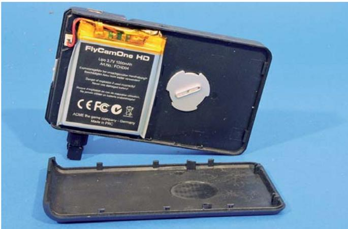
Zum Verriegeln des Monitors muss der Akkudeckel der Empfangseinheit abgenommen werden. Erfreulicherweise kann somit auch der 1.000-mAh-Akku schnell gewechselt werden
