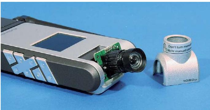
Nach dem Lösen von vier Schrauben kann man die Objektivs wechseln. Leider ist es nicht möglich, das Kameramodul um 90° zu drehen, um die Schwenkfunktion sinnvoll zu nutzen
