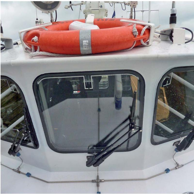
Die Frontscheiben mit regulierbaren Parallelscheibenwischern sind zum Deck hin geneigt; das dient dem besseren Abfluss der Gischt
