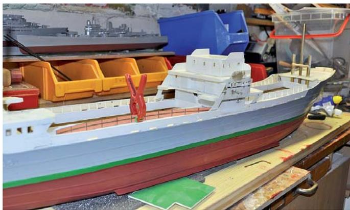
Die Aufbauten der Bleichen entstanden aus 0,5-mm-Polystyrol
