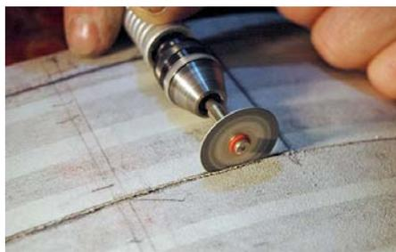
Aufgrund der geringen Drehzahl kann man sehr genaue Schnitte mühelos durchführen
