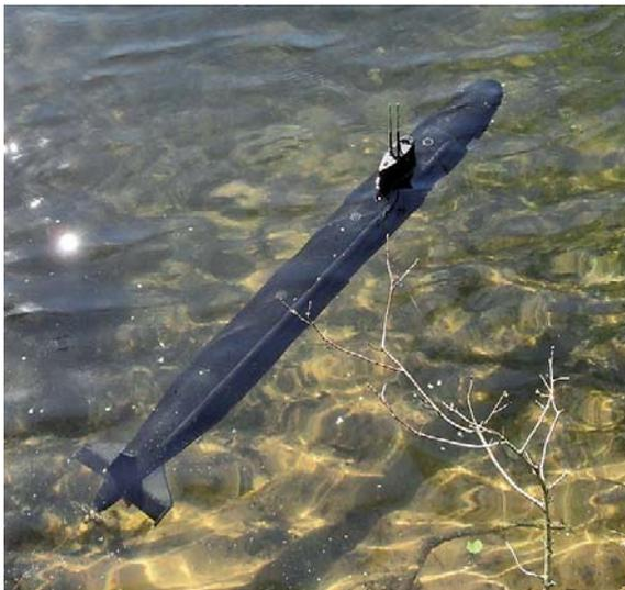
Das Tauchsystem besteht im Wesentlichen aus einem Gummisack, der mittels einer Schlauchpumpe gelenzt wird. Der Antrieb der Pumpe ist ein Bürstenlosmotor, der auch bei geringen Drehzahlen ein hohes Drehmoment hat. Gesteuert wird über ein Drehpotenziometer am Sender. Ein Lageregler steuert das Modell automatisch in der Längsachse.
