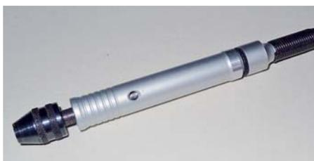
▲ Das Alu-Handstück ist doppelt kugelgelagert; bei Werkzeugwechsel einfach das Griffstück mit einem Einsteckstift arretieren ▶
