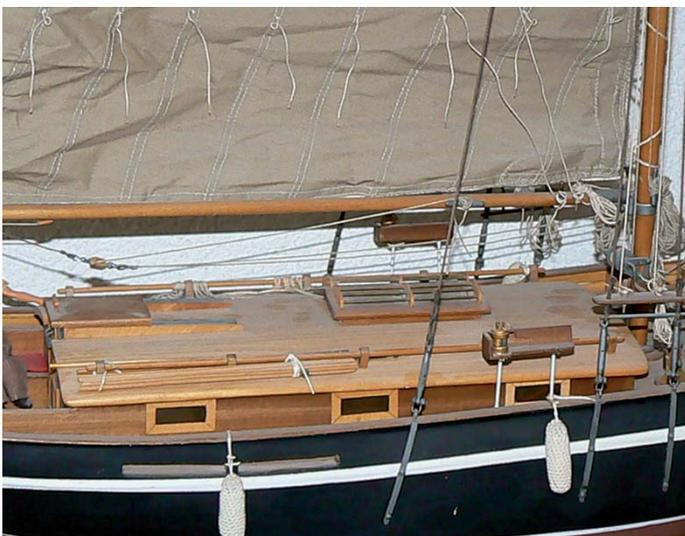
Fertiger Aufbau mit dem als Deckel ausgeführten Dach
