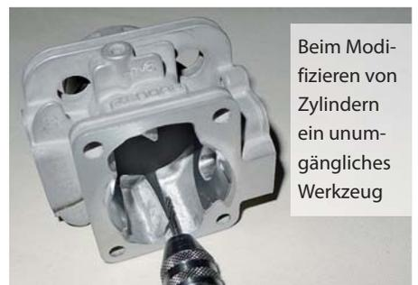
Beim Modifizieren von Zylindern ein unumgängliches Werkzeug
