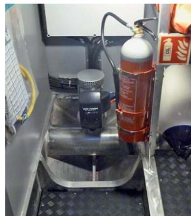
Der Bugraum. Deutlich zu erkennen ist das Bugstrahlruder. Linker Hand befindet sich die Toilette, rechts der Stauraum für Fender
