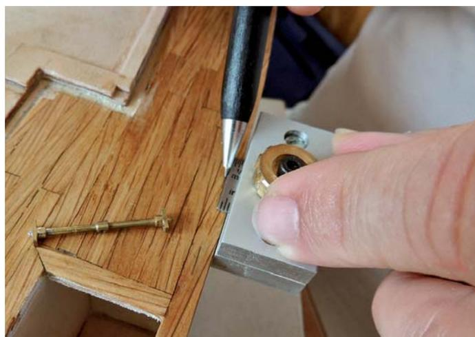
Anzeichnen der Bohrungen für Rellingstützen
