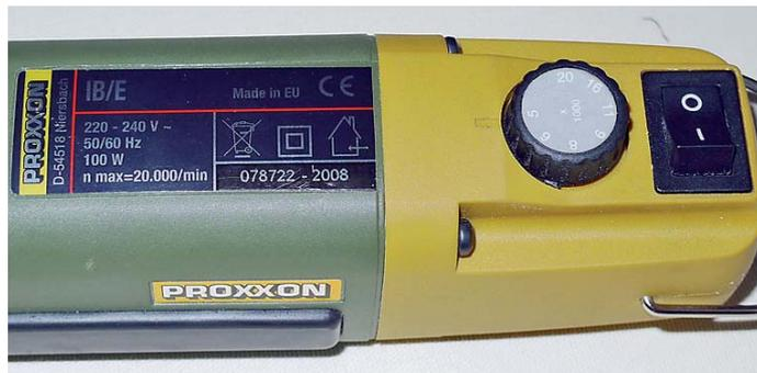
Die Drehzahl ist stufenlos per Drehschalter verstellbar
