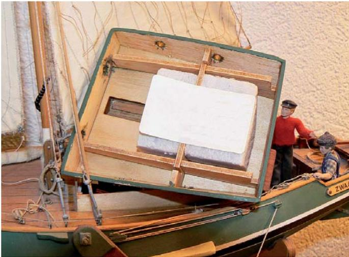
Decksaufbau mit Quer- und Längsspannten sowie eingearbeiteten Schlitzten
