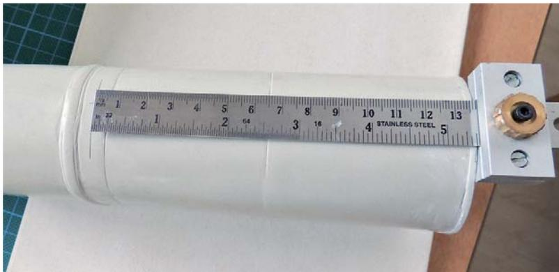
Anzeichnen der Bohrungen für die Rohrschellen von Abdampfprohren
