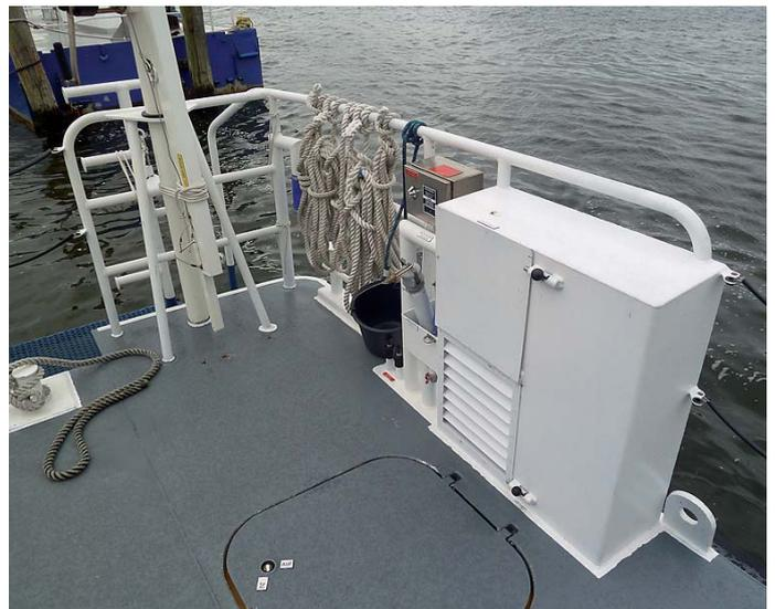
Auf dem Achterdeck befindet sich beiderseits je ein Belüftungsschacht für den Motorraum; in das Deck eingelassen sind die Zugänge zu den Motoren
