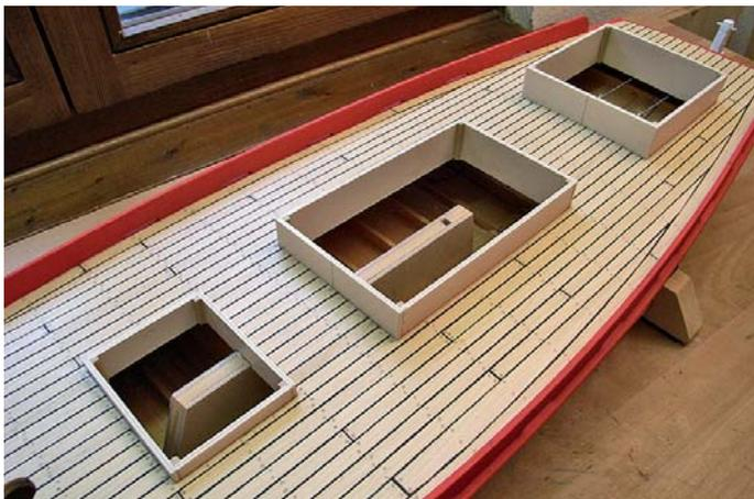
Die massiven Sülle für die Aufbauten der USS Target
