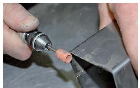
Mit dem passenden Aufsatz lassen sich abstehende Metallspäne im Nu entfernen
