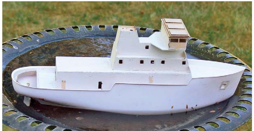
die später den nahtlosen Einsatz des Verschnitts ermöglichte. Weil das Material sehr dünn ist, sollte man beim Verkleben von Rumpfschale und Deck unbedingt auf Plastikkleber verzichten und Epoxydharzkleber benutzen. Billing Boats verwendet außerdem zwei verschiedene Kunststoffarten, von denen jene, aus der die Zubehörteile bestehen, sowieso nur mit Epoxydharz sicher zu kleben ist.
