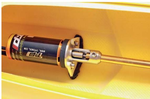
Der fertig verklebte Antrieb
