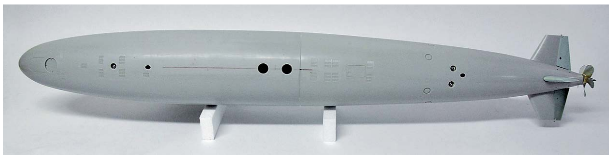
► Verschraubungen der Rumpfschalen und „Flutlöcher“ unten
