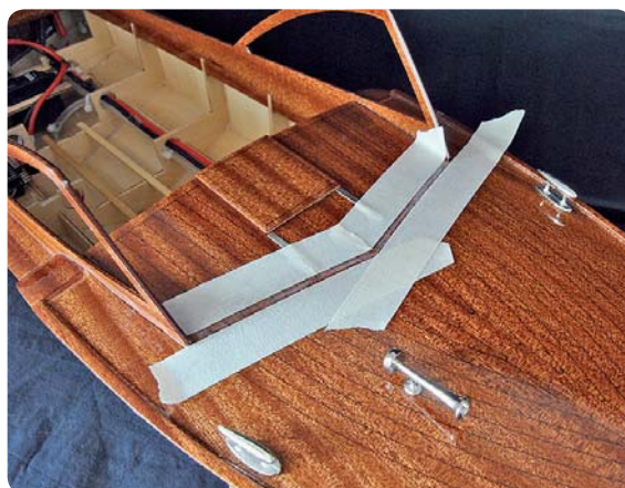
Schutz des Decks beim Schleifen
