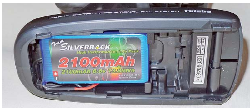
◀ Der neue LiFe-Akku hat eine höhere Kapazität bei gleichzeitig geringerem Gewicht
