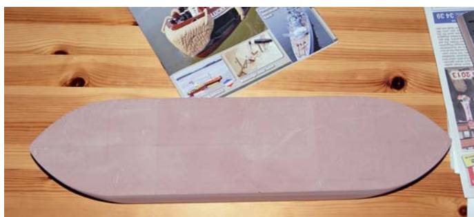
Der angefertigte Tiefziehkern
