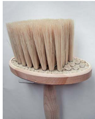
◀ Fassaden-Streichbürste mit schon teilweise entnommenen Borsten
