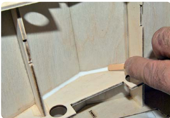
Glattziehen des Klebstoffes beim Verkleben der Bodenplatten
