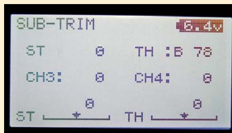
Im Menü Sub-Trim kann die Mittelstellung des Servos korrigiert werden, ohne die normale Trimmung zu benutzen
