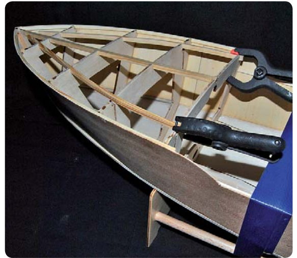
Einbau der Decksleisten
