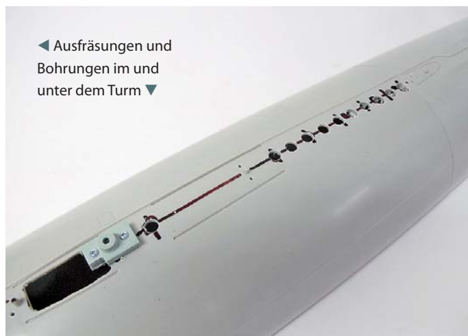
Montage des Schnorchels direkt hinter der Ausfräsung
