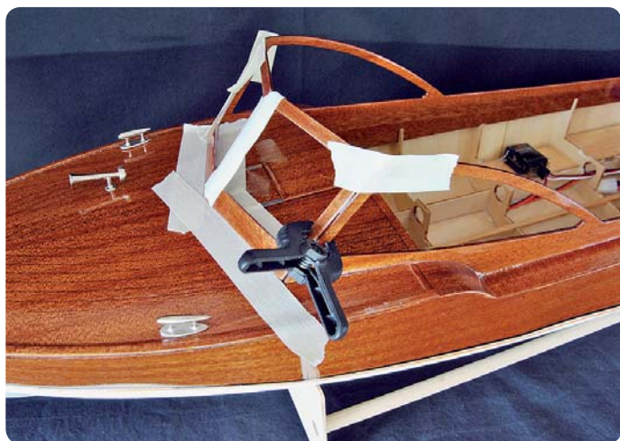
Einbau der Scheibenrahmen
