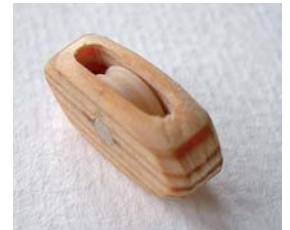
Selbst hergestellter Rollenblock ohne Halteösen und noch nicht gebeizt
