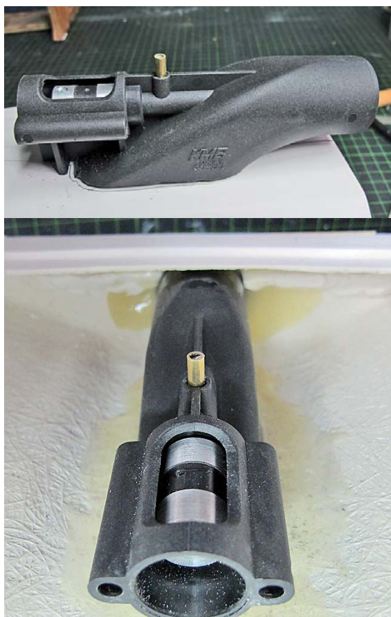
Der 28er-Jet von Kehrer im Einbau
