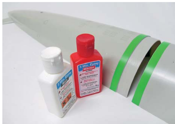
◀ Zusammenkleben der Rumpfvorder- und -hinterteile
