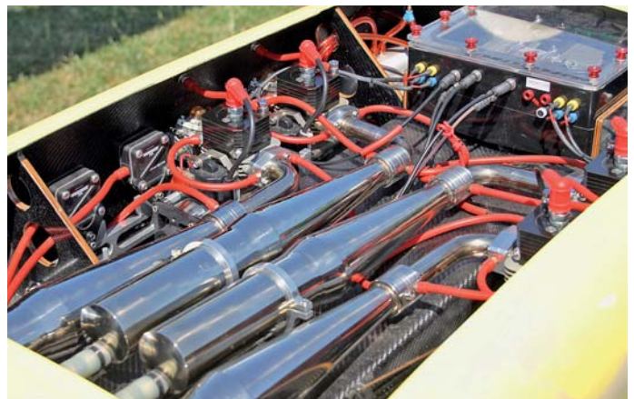
Rennocat mit zwei 2-Zylinder-Benzinern, ca. 100 cm 3 . Hier hat jeder Zylinder ein eigenes Reso-Rohr
