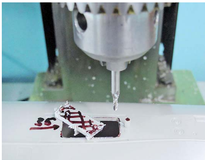
Ausfräsung für die Anlenkung der Turmruder
