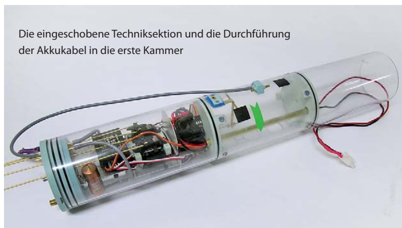
Servoeinbau mit kleinen Modifikationen
