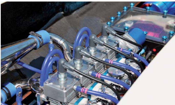
Monorennboot mit 4-Zylinder-Reihenmotor, Benziner mit ca. 100 cm 3 . Besonders ist hier, dass die Abgase von je zwei Zylindern in ein Resonanzrohr geleitet werden
