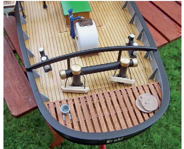
Die Grating aus Mahagoni kann jederzeit entfernt werden, um Einstellungen am Ruder vorzunehmen
