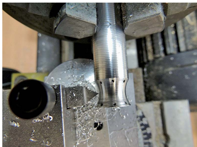
Die Hohlkehle des Spillpfostens entsteht
