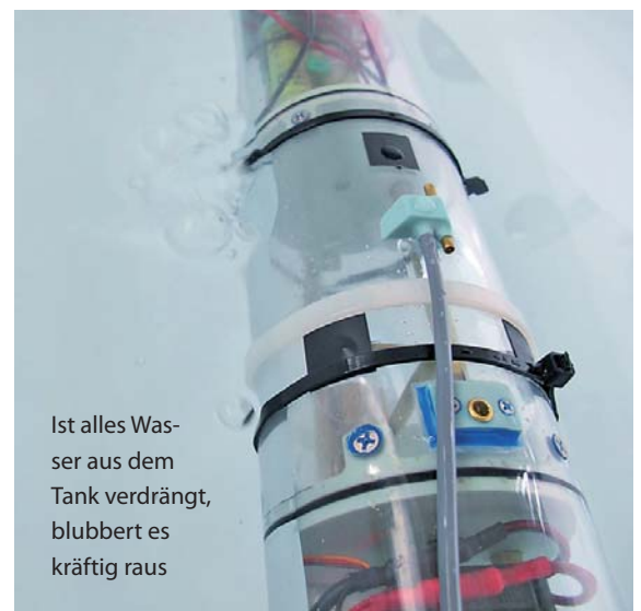
Mit einer Messingstange an den Kabelbändchen austariert, sinkt die Mechanik bei vollem Tank waagrecht ab
