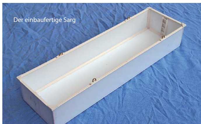
Der angefertigte Tiefziehkern
