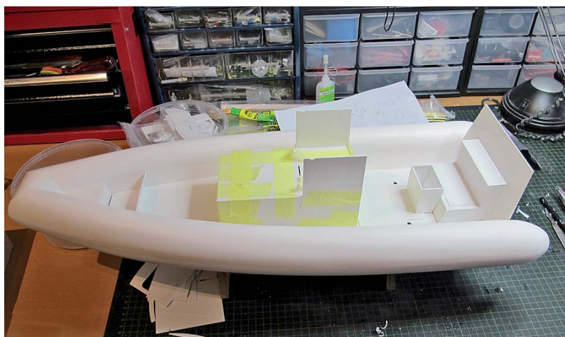
Aus passgenauen Frästeilen entsteht der Aufbau
