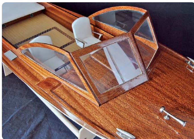
Die Verglasung am fertigen Boot
