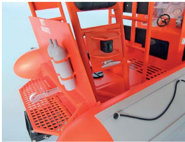
Druckflaschen an der Rückwand für den „Airbag“
