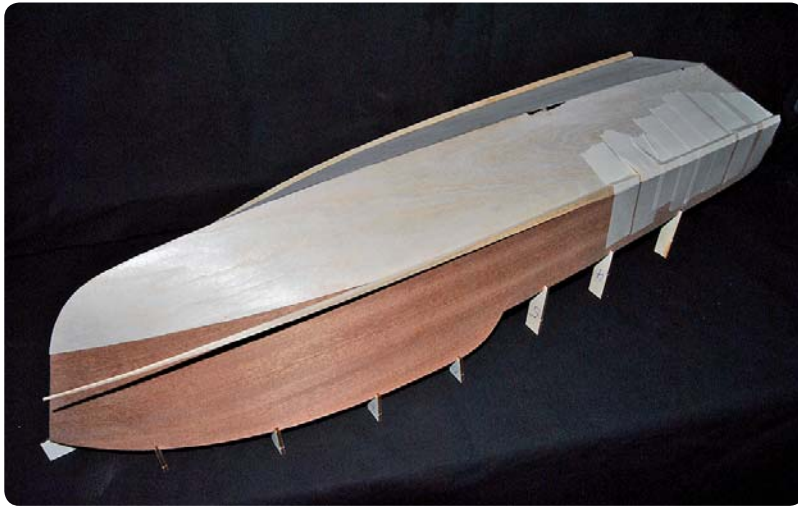
Aufkleben der Dreikantleiste zur Verbesserung der Seitenführung
