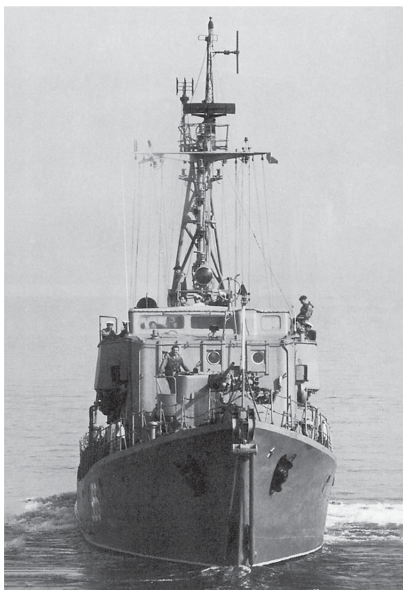
Foto 9: Bugansicht eines rückwärts fahrenden Boots. Die Saling samt Radargerät und die lange Stenge dahinter sind deutlich nach Backbord versetzt (Foto: Sammlung Eichardt)
