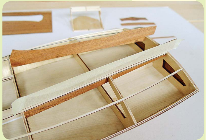
Kreppband verhindert, dass Klebstoff an die Seitenteile des Cockpits gelangt
