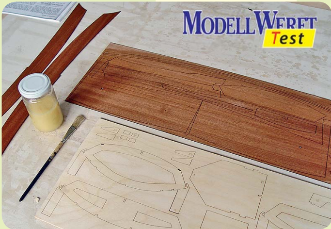
Vor Baubeginn werden die Bauteile mit G1 grundiert
