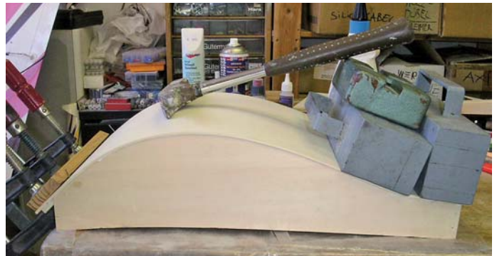
Verzugsfreier Aufbau ganz ohne Helling – die Konstruktion ist sehr gut durchdacht
