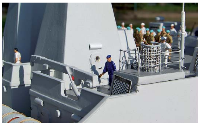
Beispiele für die nachträgliche Detaillierung: Vorreiber an den Türen, Lüftungsgitter aus Streckmetall
