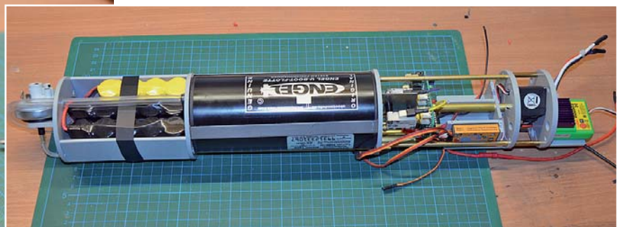
▲ Das fertig montierte komplette Technikgerüst des U 33; die Elektronik muss noch angeschlossen werden
