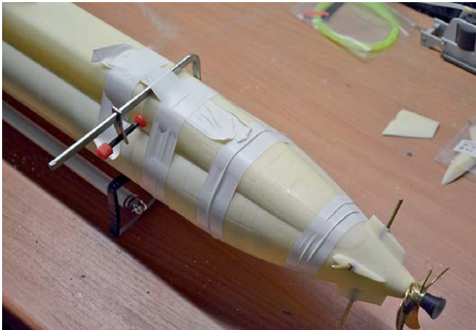
Der Rücken wird ausgerichtet und anschließend mit dem Heck verklebt
