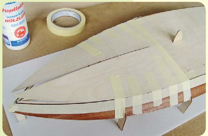
Einkleben der vorderen Bodenplatte: die Seitenteile sind sicherheitshalber mit Kreppband gegen überquellenden Klebstoff geschützt
