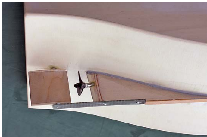
So ist's besser: Ruder nach vorne versetzt und mit Ruderhacke gestützt
