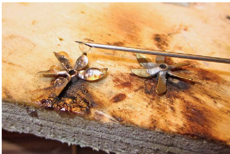
Bei komplexen Propellern ist gute Kühlung besonders wichtig
