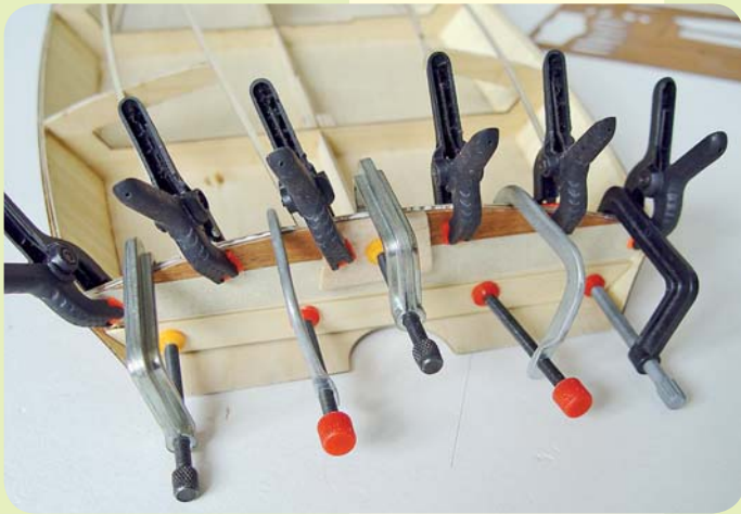
Einkleben des Heckspiegels: hier dient die Verstärkung des Heckspiegels als Unterlage für die Schraubzwingen
