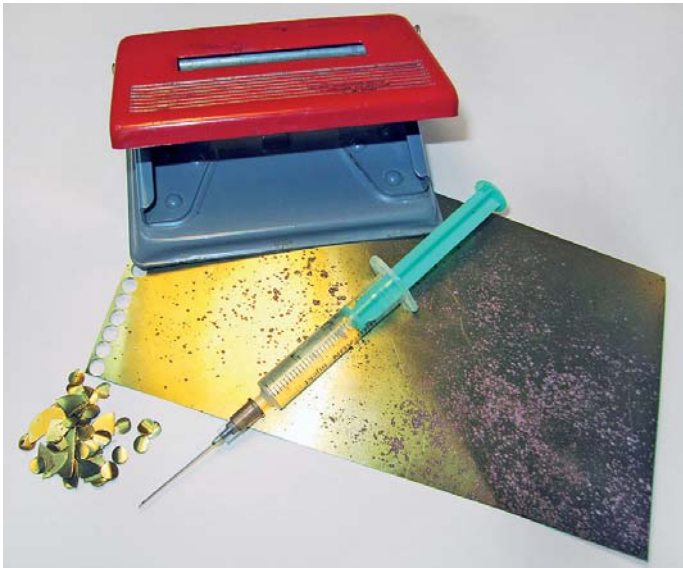
Beim Stanzen mit dem Locher entsteht „Messingkonfetti“
