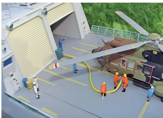
Die Hangartore wurden aus 0,5 mm starkem Wellaluminium angefertigt
