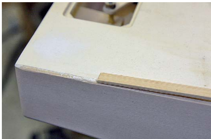
Ein bisschen Übermaß rundum wäre gut gewesen. So musste ich einige Lücken mit Scheuerleisten kaschieren
