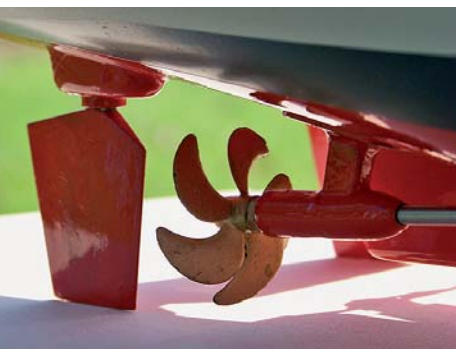
Die Propeller wurden durch 5-flüglige Skewed-Propeller ersetzt
