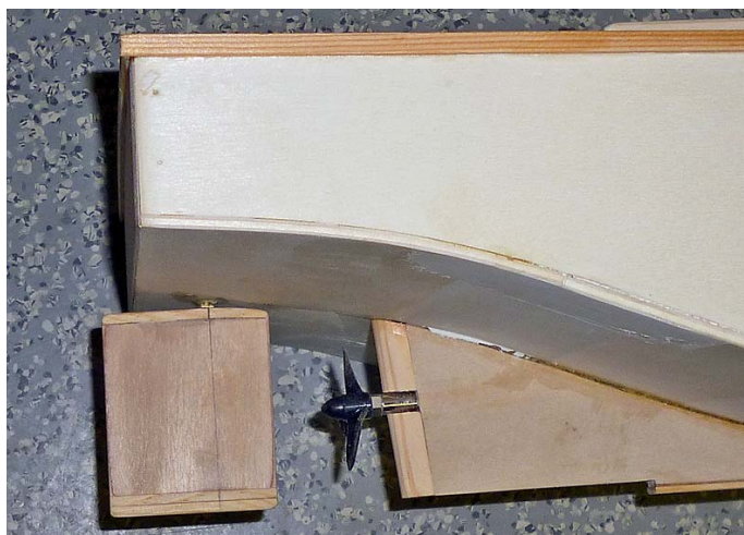
Nach Plan steht das Ruder ungeschützt nach hinten über
