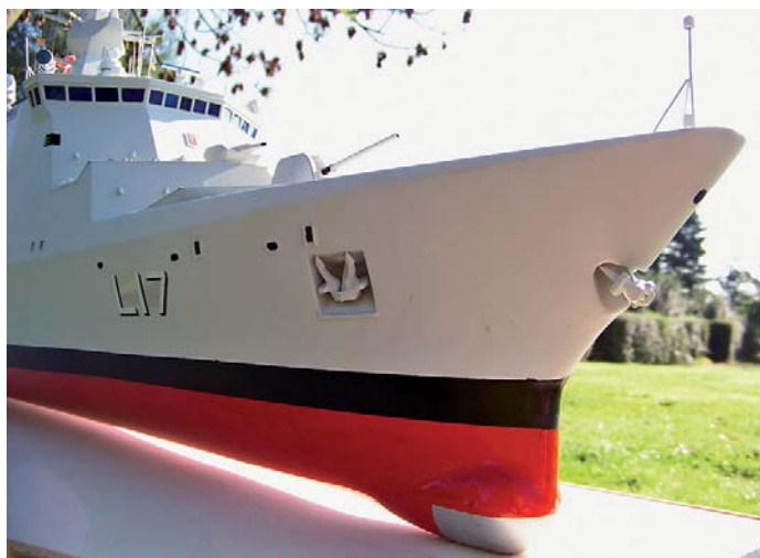
Anstelle der Aufkleber wurden Steuerbord- und Bug-Ankertasche in den Rumpf gefräst
