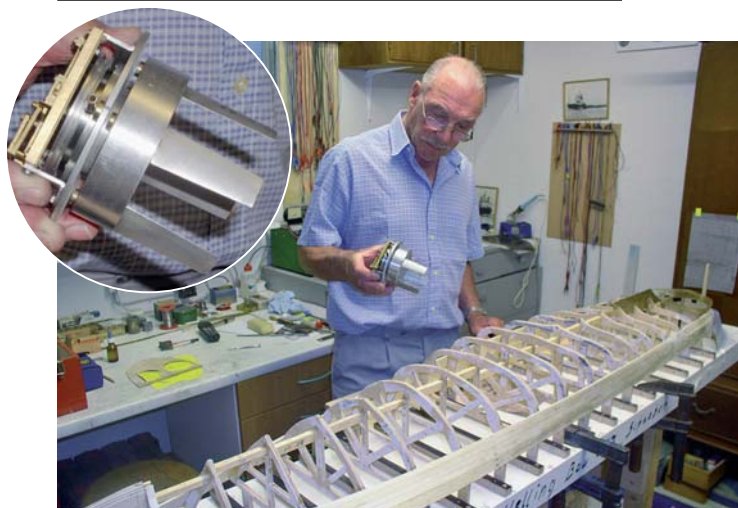
In der Werkstatt: der Erbauer bei Arbeiten am Rumpf, als Antrieb sind Voith-Schneider-Propeller vorgesehen
