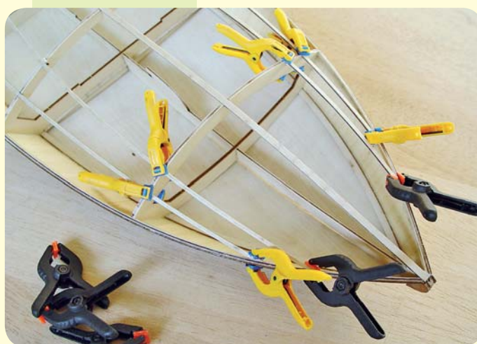
Die vorgeformten Decksstringer aus Birkenisperrholz werden eingeklebt
