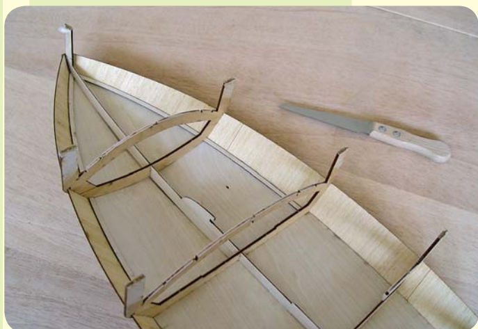
Nach dem Durchtrocknen wird das Spantgerüst von der Unterlage gelöst
