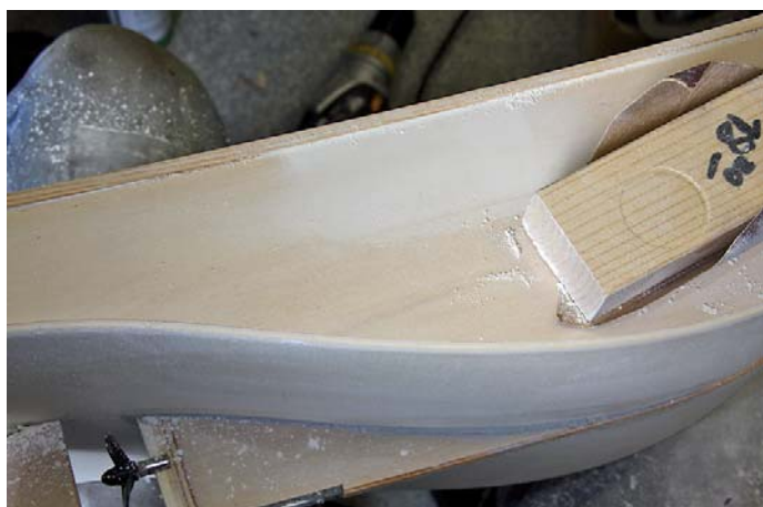
Der Rohbau ist schnell zusammen – Spachteln und Schleifen brauchen dagegen Zeit
