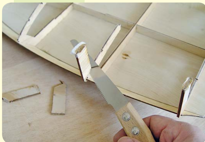
Die Stützfüße werden mit einer Feinsäge abgetrennt
