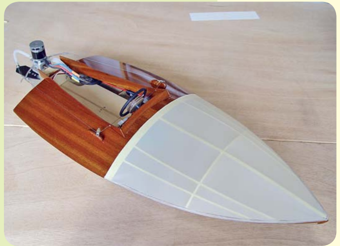
Der Bug wird mit Oratex-Gewebefolie bespannt
