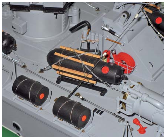
Foto 21: Die feinen, selbst gemachten Ketten, Schäkkel und Spannschrauben, welche die Grundminen am Oberdeck halten, wurden für das Spritzen mit Silberlack an Fäden in einen Rahmen gespannt. Die Feuerlösch-Spritze am Niedergang wurde aus mehreren, einzeln gespritzten Teilen hergestellt (Foto: Jürgen Eichardt)
