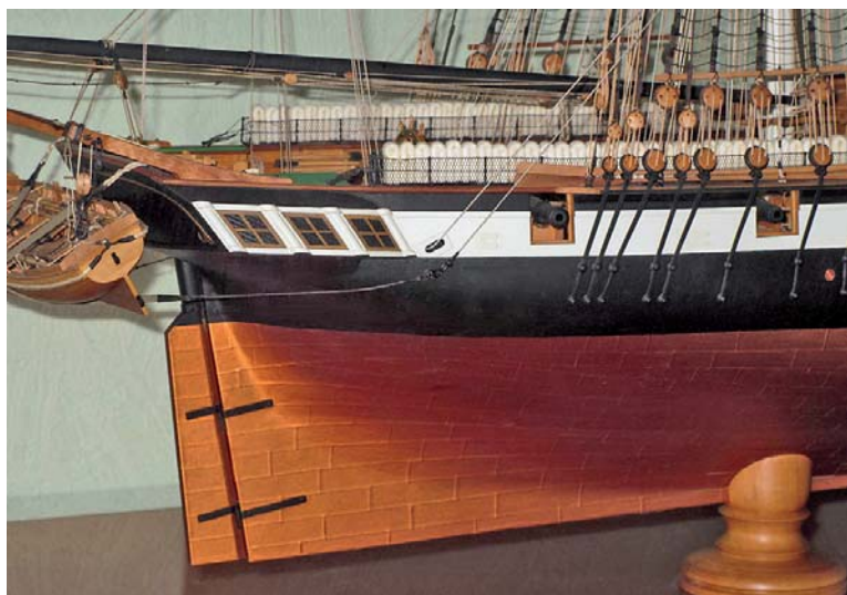
Foto 16: Die Unterwasser-Kupferung meiner 1:50-Kriegsbrigg wurde mit Tesafilm-Streifen aufgeklebt und danach mit dem Pinsel kupferfarben gestrichen, hier Werft-neu, denn nach kurzer (See-)Zeit dürften diese Platten nicht mehr so metallblank aussehen (Foto: Jürgen Eichardt)
