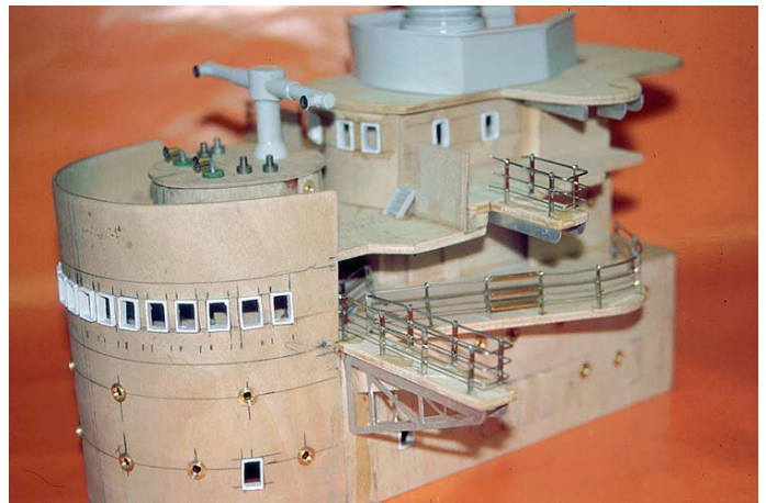
Die rechteckigen Fensterrahmen entstehen mithilfe einer Eigenbaulehre
