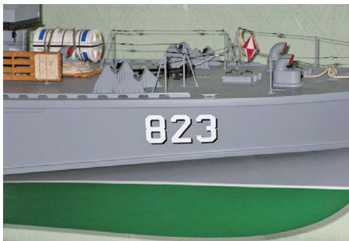
Foto 15: Für das Abkleben wurden hier die drei Zahlen „823“ in der richtigen Dimension und Form mehrfach größer gezeichnet. Nach dieser Vorlage konnten sie bei einem Betrieb für Werbeschriften als Klebefolien mit einem Schneidplotter ausgeschnitten werden. Die schwarzen Schlagschatten habe ich nach dem Grau-Spritzen mit einem Tuschefüller angezeichnet (Foto: Jürgen Eichardt)
