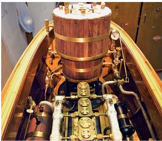
Der zweite Kessel: rechts daneben das Rückschlagventil und das Oderventil
