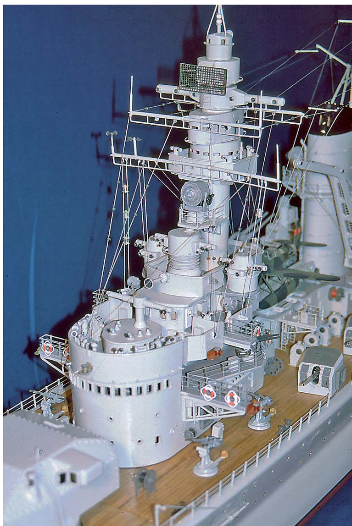
Der komplette vordere Aufbau mit Gefechtsmast zwischen Turm „Anton“ und Schlot
