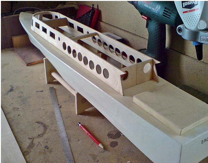
Der Rumpf wurde lackiert – es geht mit dem Aufbau weiter
