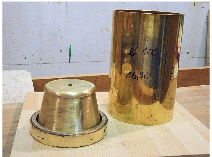
Die Siederohrkammer im Bau und das Kesselmantelblech (erster Kessel)
