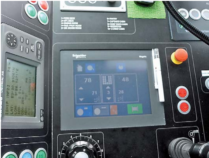
Links steht die Zuglast der Winde in Tonnen, rechts die ausgelegte Leinenlänge in Metern. Wir sind bei 78 Tonnen Last auf der Leine – die Boxer liegt jetzt etwas schräg im Wasser
