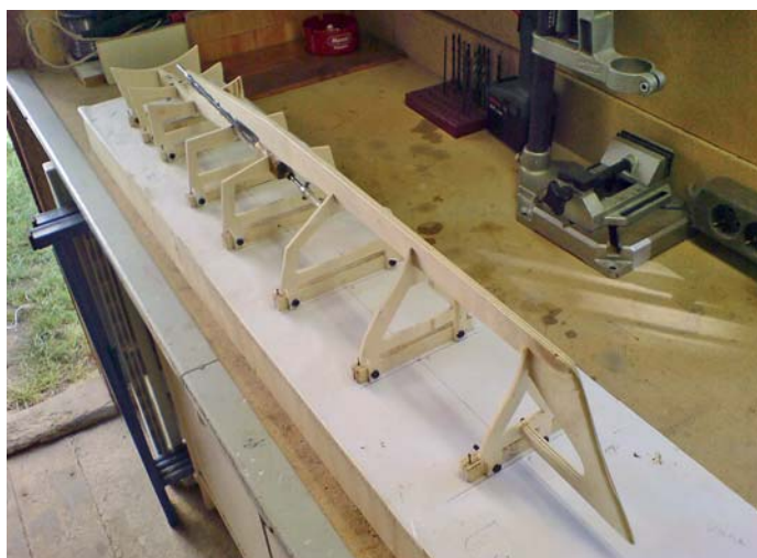
Das Spantengerüst wurde auf der Helling aufgestellt
