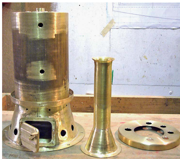
Die Brennerkammer unter dem ersten Kessel, daneben der Kamin mit Rauchkammer und der obere Abschlussdeckel
