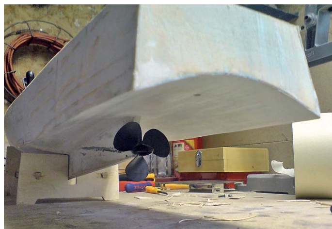
Die nach innen gebogene Unterseite des Hecks mit der 50-mm-Schiffsschraube
