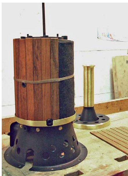
Isolierung und Holzverkleidung werden am Kessel angebracht
