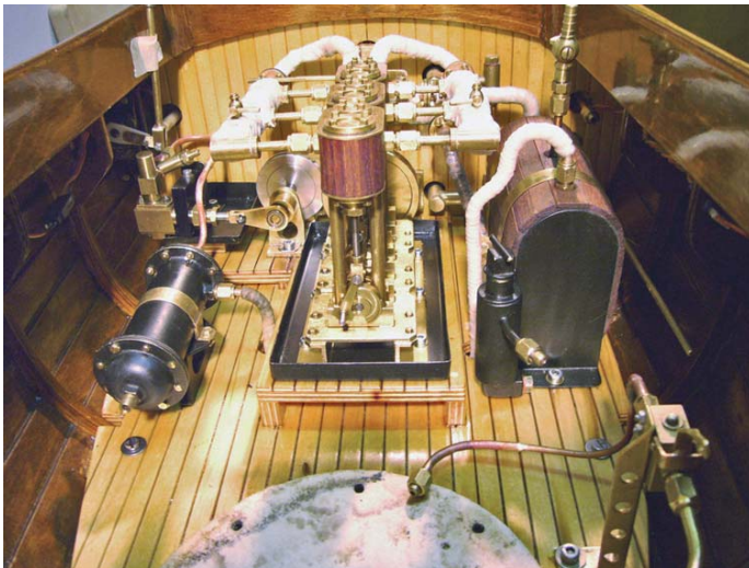
Links oben die Speisepumpe mit Auffangbecken, davor der Wärmetauscher
