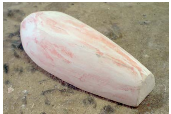
Fertig beplankt und gespachtelt kann das Beiboot lackiert werden
