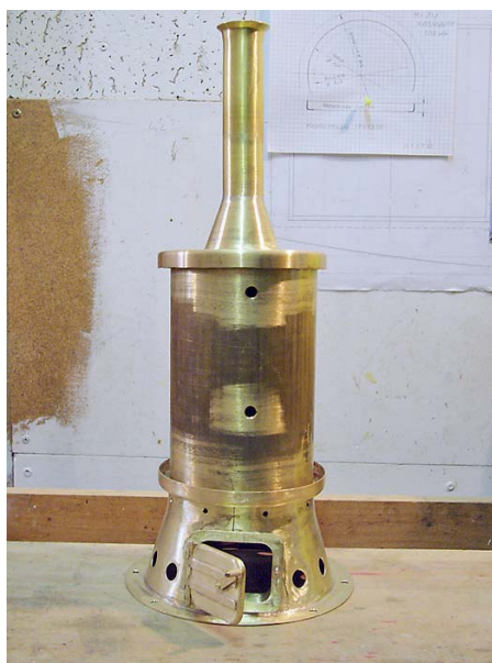
Der erste Kessel ist fertig, muss aber noch verkleidet werden
