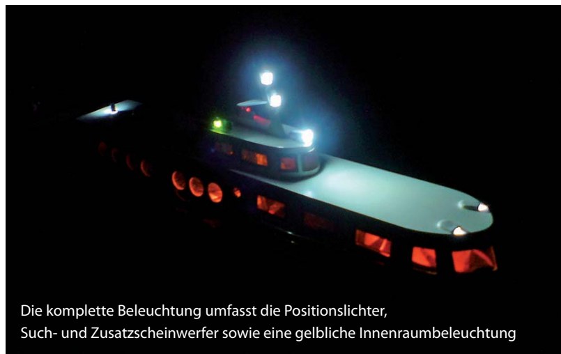
Der Suchscheinwerfer wurde aus einer Kugelschreiberkappe hergestellt; die Lampengehäuse entstanden aus den Köpfen von Tintenpatronen
