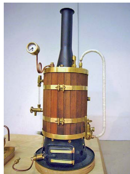
Der verkleidete und mit Armaturen bestückte Kessel
