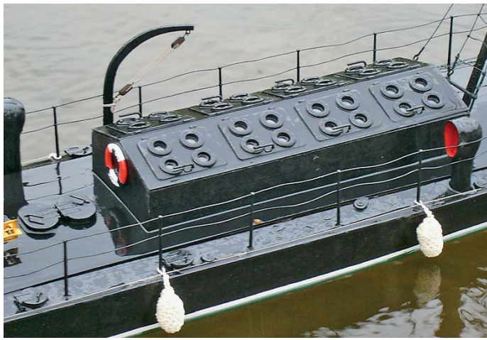
Das Maschinenraumoberlicht musste wesentlich vergrößert werden, um Überhitzung im Bootsinneren zu vermeiden
