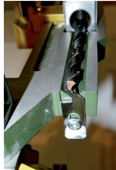
◀ Der Bohrer muss genau ausgerichtet werden!
