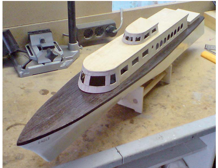
Das Deck wurde mit lackierten Holzleisten beplankt
