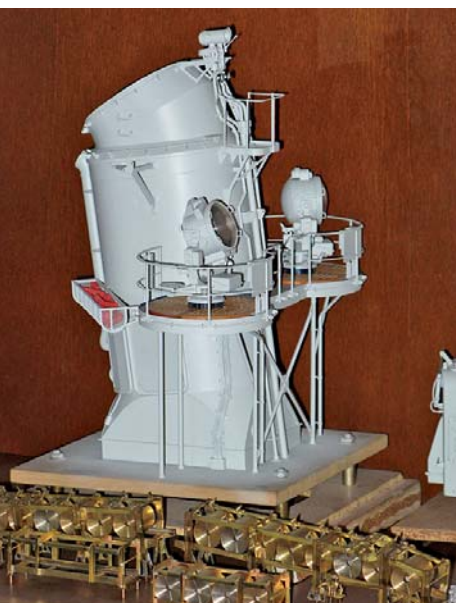
Foto 27: Der achterliche Kamin für meinen Fletcher steht auf dem schrägen Grundbrett (Deckssprung!), auf dem er auch gespritzt wurde. Es fehlt noch die Leiter zum Scheinwerferpodest (Foto: Jürgen Eichardt)
