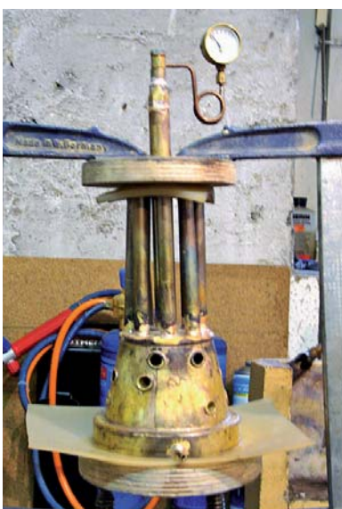
Die Siederohrkammer mit den Rauchrohren beim Drucktest (erster Kessel)
