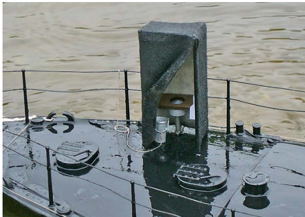
Das Maschinenraumoberlicht musste wesentlich vergrößert werden, um Überhitzung im Bootsinneren zu vermeiden
