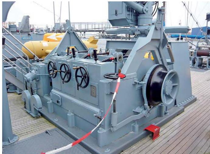
Foto 8: Bei der Räumwinde war früher oben eine Rolle eingebaut, heute ist dort nur ein Draht gespannt (Foto: Günther Heine)
