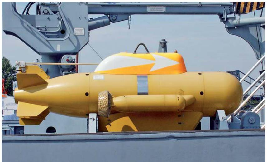
Foto 6: Minenjagddrohne PAP-104. Durch den Stab, der zur OK Leitwerk fährt, verläuft beim Einsatz das Steuerkabel (Foto: Ernst Frey)
