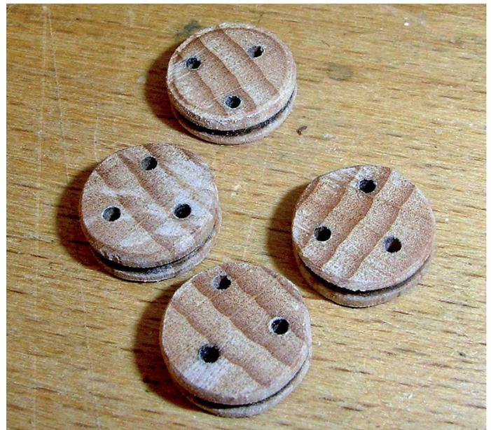
Bild 9: Fertig bearbeitete Juffern
