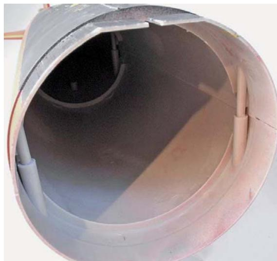
Dank der kräftigen Steckverbindungen und der regelmäßigen Wandverstärkungen bleibt der Bootskörper auch nach dem Verkleben gut in Form
