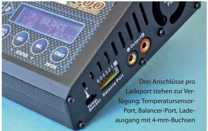
Drei Anschlüsse pro Ladeport stehen zur Verfügung: Temperatursensor-Port, Balancer-Port, Ladeausgang mit 4-mm-Buchsen
