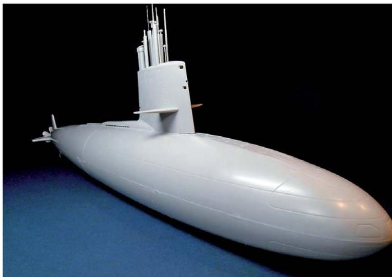
Das U-Boot im Rohbauzustand: Rumpfober- und -unterhälfte müssen noch verspachtelt und verschliffen werden
