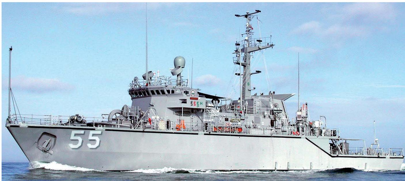
Foto 1: USS Oriole. Die beiden „Schüsseln“ auf der Brücke sind die Antennen der Satellitennavigationsanlage. Auf der Spule vor der Brücke ist wahrscheinlich der Lenkdraht für die Minendrohne SLQ-48 (ab 1982 fronttreif) aufgeschossen (Foto: US-Marine)
