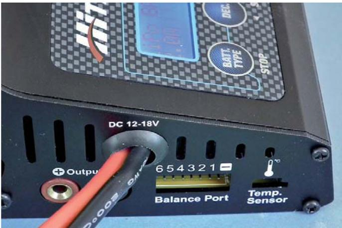
Die linke Seite ist wegen der Stromzuführung mit dicken Kabeln etwas benengt als die rechte Seite, bietet aber die gleichen Anschlüsse
