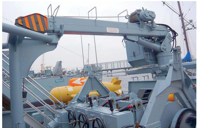
Foto 10: Der eingefahrene Drohnenkran. Im Hintergrund das Heck der Mölders (Foto: Günther Heine)
