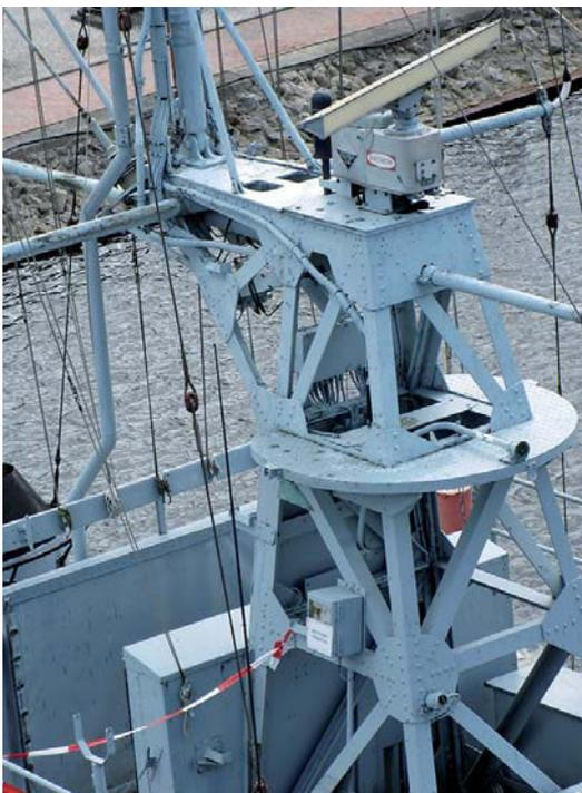
Foto 5: Der (Alu-)Vierbein-Mast mit der Raytheon-Radar-Drehantenne (Foto: Jürgen Eichardt)
