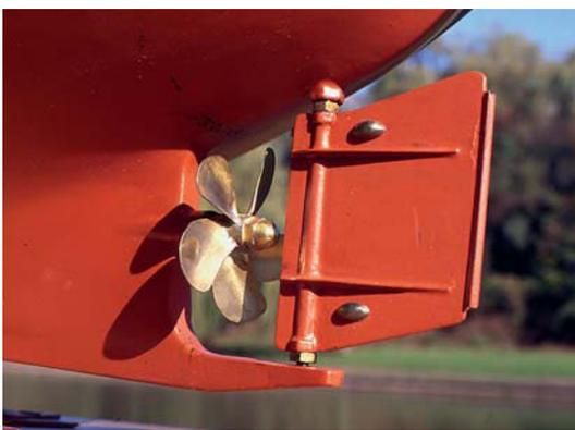
Ruder, Opfer-Anoden sowie die selbstgefertigte Schraube, eine exakte Wiedergabe des Originals
