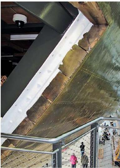
Der Zugangsbereich im Heck des Schiffs – hier sieht man die Planken unter der Kupferhaut
