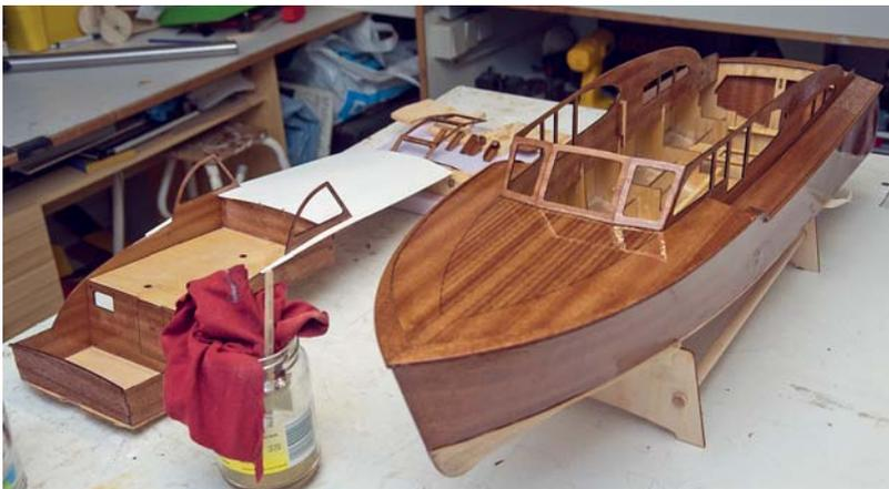
Nach dem Verschleifen wird der Rumpf mehrfach mit Bootslack lackiert
