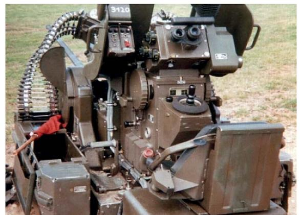
Foto 5: Steuereinheit mit Joystick an einer Heeres-Flak (Foto: Sammlung Eichardt)
