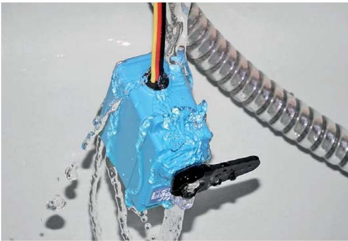
Knifflig wird die Sache mit dem Wasser, wenn es mit einem gewissen Schwung, der ja Druck erzeugt, auf das Servo trifft. Aber auch dieser Test ging folgenlos am Hitec-WP-Servo vorbei
