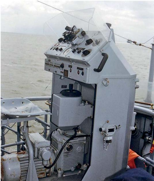
Foto 03: OGR 7 auf dem Hohlstab-Lenkboot *Konstanz*. Das Gerät ist offenbar weitgehend aus Leichtmetallen gebaut (Minensucher!) (Foto: Gerhard Frenzel)
