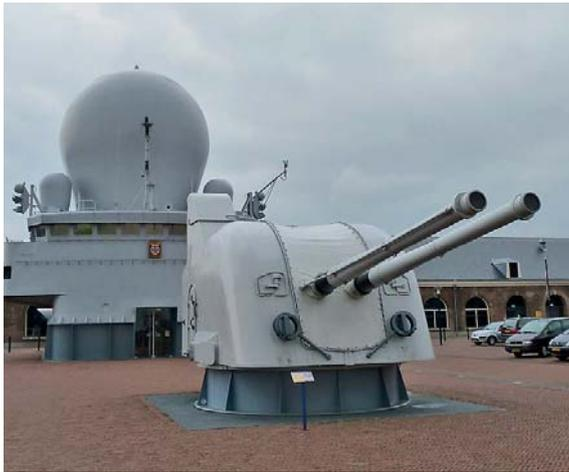
Die GFK-Brücke mit Radardom der *De Ruyter*
