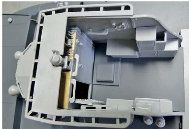
den Motoren verbunden und danach komplett mit 2-Komponenten-Kleber in den Rumpf geklebt. Um den Neigungswinkel zu erhalten, hatte ich für die Motoren passende Unterlegkeile aus ABS-Platten erstellt.
