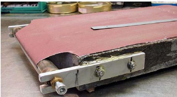
▲ Das passend ausgeschnittene Schleifleinen wird in den Rohrschlitz eingeschoben
