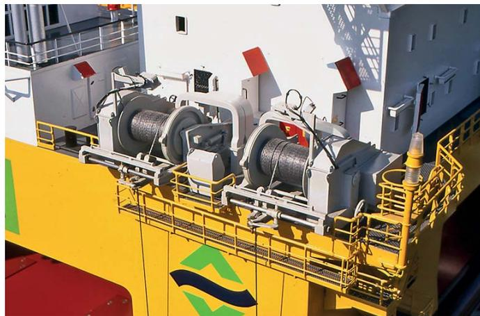
Zwei der Ankerwinden mit ihren beweglichen Kabelführungen zum perfekten Abrollen der Ankerkabel
