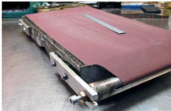
◀ Mittels Inbusschlüssel dreht man das Rohr im Uhrzeigersinn und spannt so das Schleifleinen; die Sechskantmuttern halten es in Position
