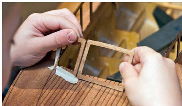
Die Fensterrahmen werden angeklebt und bis zum Aushärten fixiert
