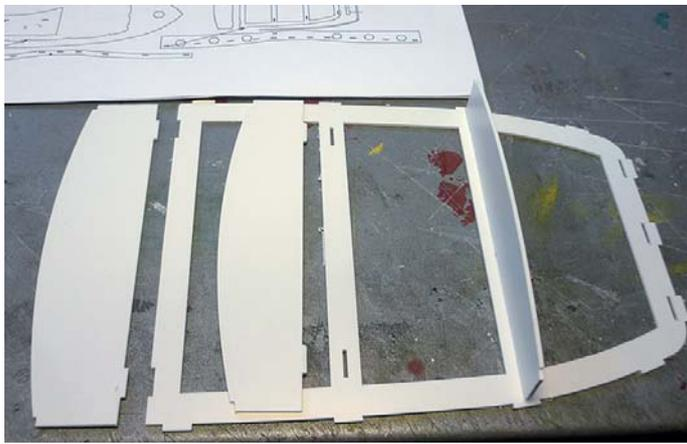
Unterkonstruktion für Kajüte mit drei Spanten
