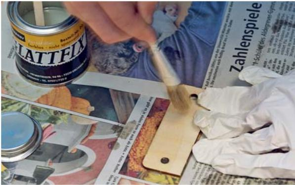
Die Holzteile werden mit Porenfüller vorbehandelt
