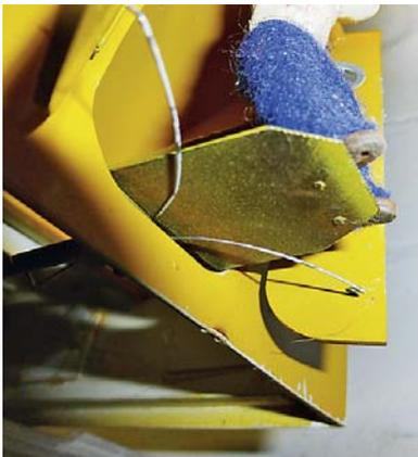
◀ Zwei Stahldrähte drücken unter dem Matrosen fast unsichtbar die Türe/n auf
