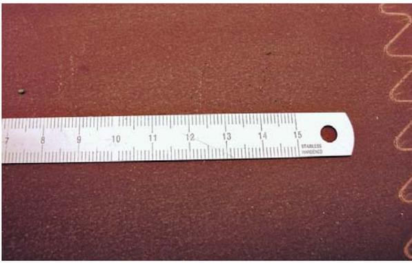
▲ Das Schleifleinen ist eingespannt; der Messstab liegt völlig eben auf
