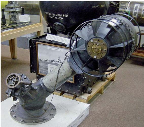
**Foto 4:** US-Stempelwerfer Mk6, besser bekannt als „K-Gun“. Aufnahme aus dem Bremerton Naval Museum, in dem auch ein gut erhaltener *Forrest-Sherman*-Zerstörer zu sehen ist (Foto: Klaus Mecking)
