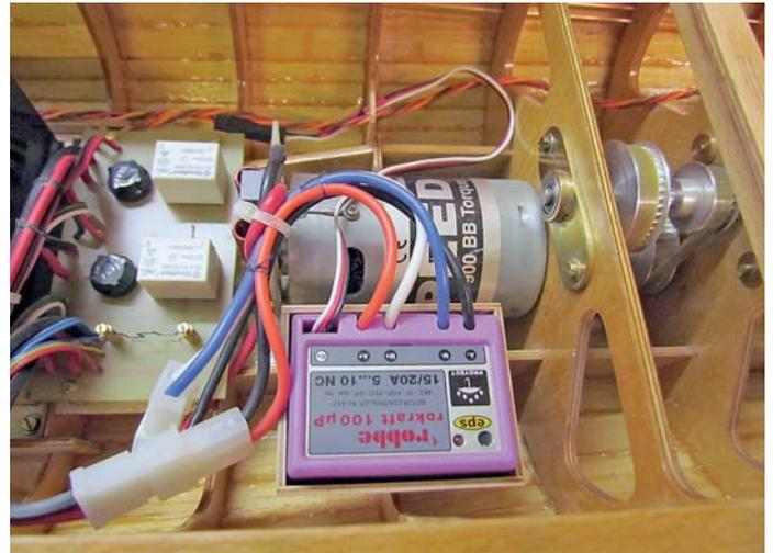
E-Motor, Fahrregler, Relais, Sicherungen
