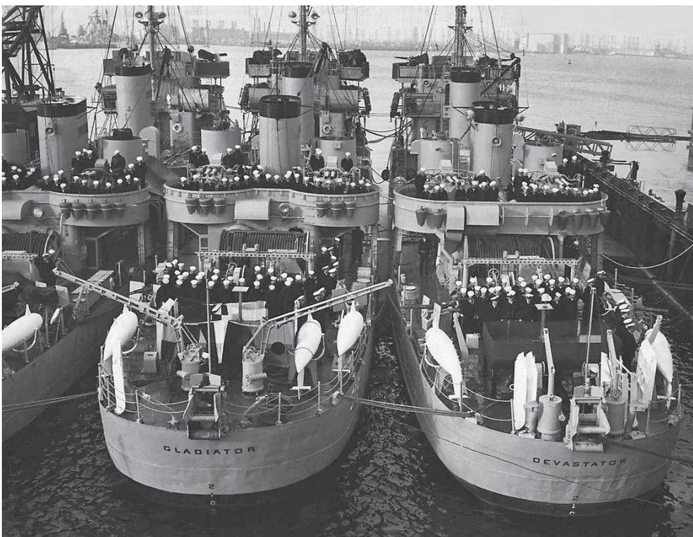
**Foto 7:** Drei Auk-Schiffe in einem US-Stützpunkt. Anstelle der Stempelwerfer stehen hier weitere 20-mm-Oerlikons neben den Räumwinden. Beide Boote (*Gladiator*, *Devastator*) wurden 1973 an Mexiko abgegeben (Foto: Sammlung Eichardt)
