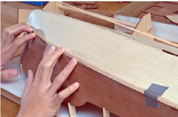
Die Dreiecksleisten werden erst im Heckbereich und dann Stück für Stück bis zum Bug festgeklebt
