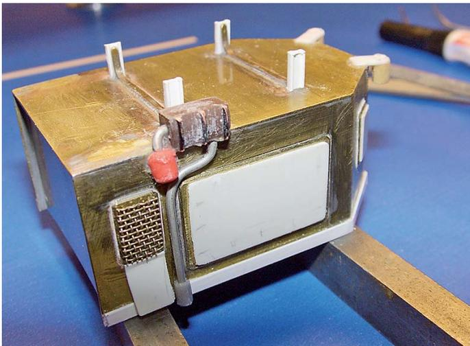
In diesem Deckshaus befindet sich die Lüftungsanlage der Maschinenräume, seitlich der Landanschlusskasten und auf dem Dach die Halterung für das Schlauchboot
