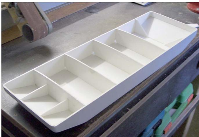
Grundkörper: Ponton mit Spanten
