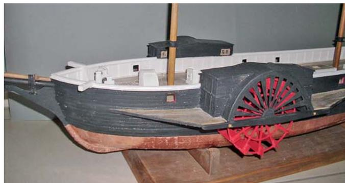
Der Rohbau ist abgeschlossen – der Schiffsantrieb ist relativ weit vorne untergebracht
