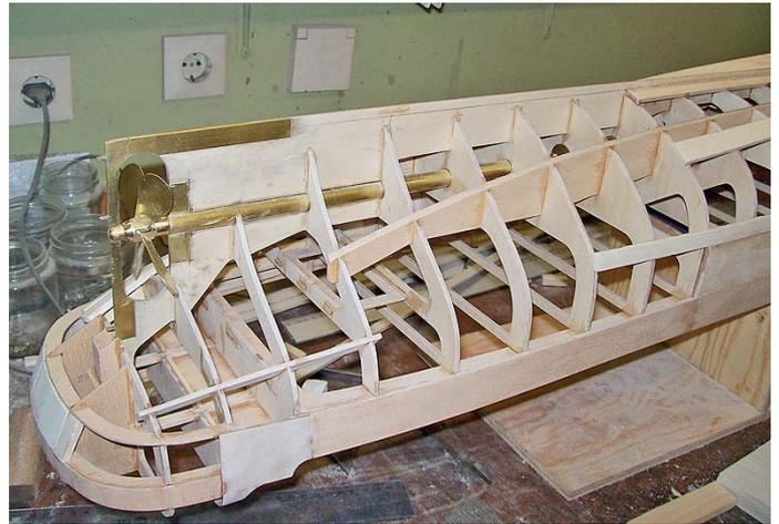
Heck mit Stevenrohr, Propeller und Ruderhacke
