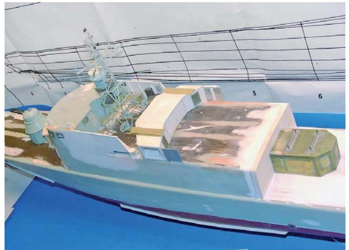
Der neu aufgebaute Turbinenabgas-Schacht
