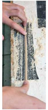
▲ Dreiecksleisten werden mit einem auf dem Tisch geklebten Sandpapier verjüngt
