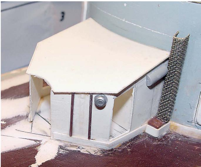
Das Deckshaus im Vorschiffbereich dient zur Aufnahme von Persenings, Lecksegel und Fendern dort befindet sich auch die Lüftungsanlage der Vorschiffräume
