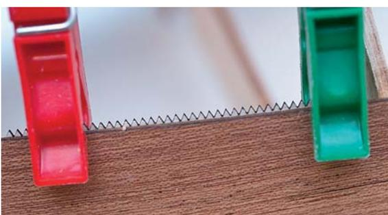
Beim Anpassen der beiden Sperrholzbretter des Unterwasserschiffes helfen kleine Zackenleisten beim Ausrichten
