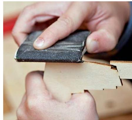
Die einzelnen Spanten werden mit einem scharfen Cutter herausgetrennt und alle Klebestellen mit Schleifpapier bearbeitet
