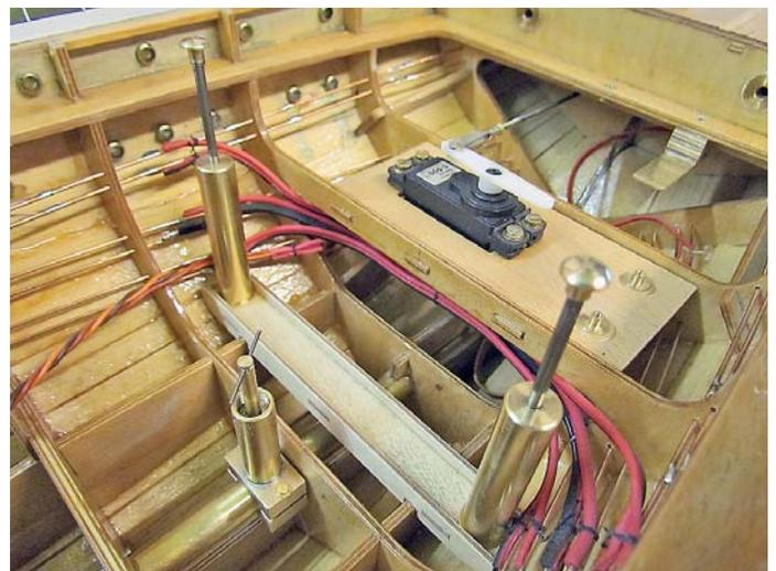
Stevenrohr mit Fettpresse, Federelemente zum Abdrücken des Deckskastens, Rudermaschine
