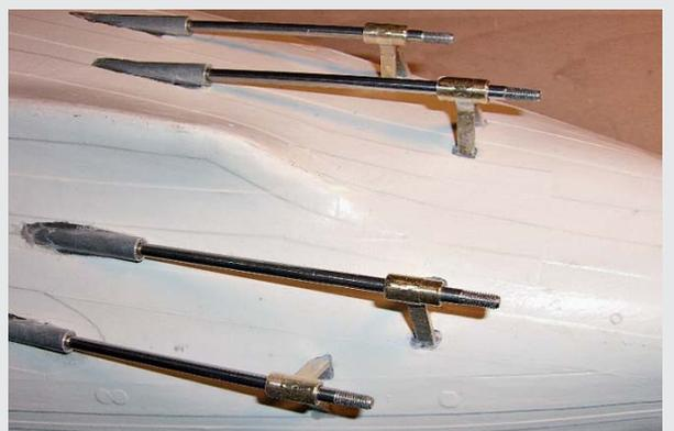
Der 4-Schrauben-Antrieb am Unterwasserschiff
