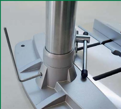
◀ Die Befestigung der Säule an der Grundplatte erfolgt über eine Inbus-schraube
