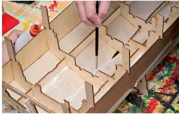
Die beiden Teile des Unterwasserschiffs werden mit Weißleim angeklebt
