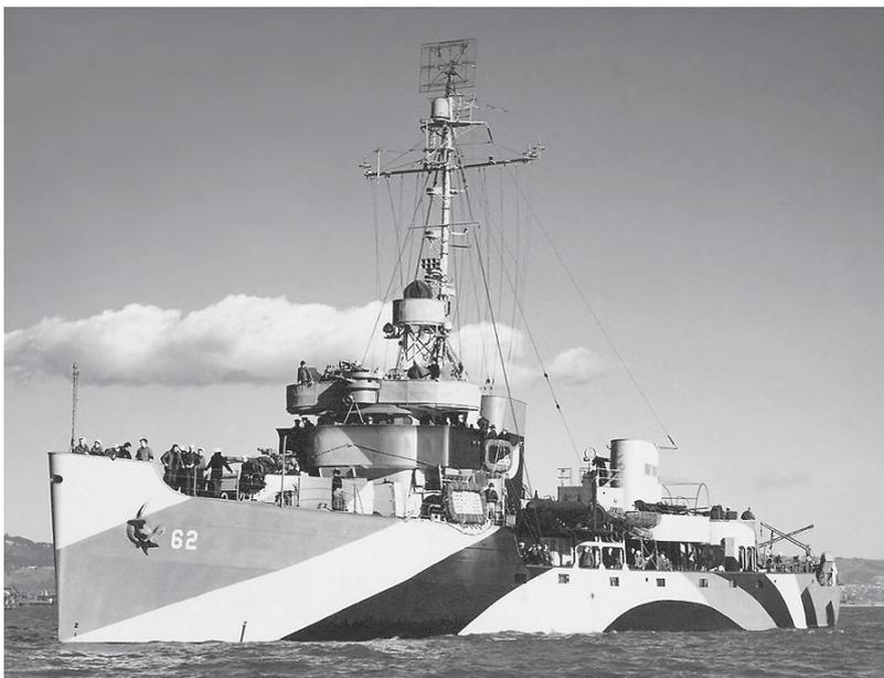
Foto 9: Klare Aufnahme von *Sheldrake* mit SC-Radar-Antenne im Masttopp. Die 2,6x2,3 m große Antenne drehte sich mit 5 min<sup>-1</sup>, Jagdflugzeuge konnten auf 25 sm erfasst werden (Foto: US-Marine)
