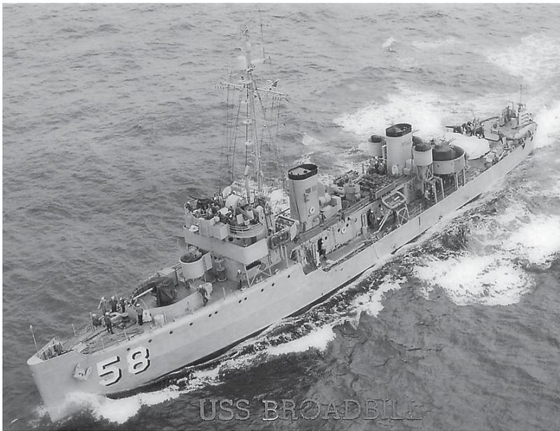
Foto 8: AM58 *Broadbill* 1940. Bei der Luftaufnahme erkennt man gut die Rundung zwischen Bordwand und Deck bei der Back. Die drei Zielsäulen für die beiden 40-mm-Zwillinge hinter dem achterlichen Kamin stehen etwas erhöht in Wannen (neben dem Kamin und vor der Brücke) (Foto: Sammlung Eichardt)
