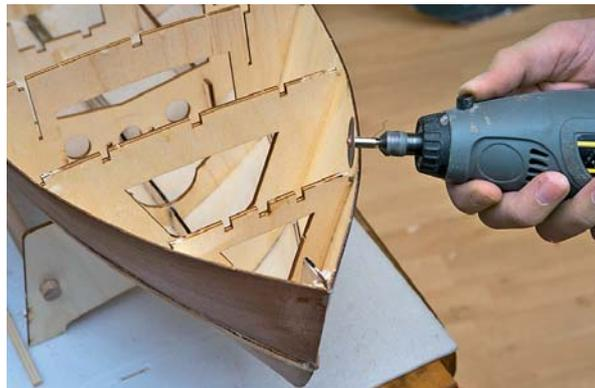
Die Decksleisten werden angepasst und eingeklebt
