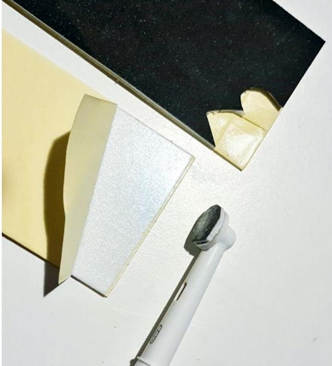
Dann das so beschichtete Schleif-Pad in der gewünschte Größe grob ausschneiden, das Schutzpapier auf der verbliebenen Klebeseite abziehen und das Pad auf den Bürstenkopf kleben
