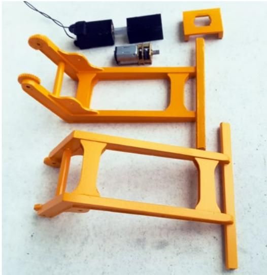
Die lackierten Bauteile des Palettengreifers
