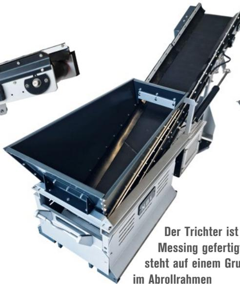
Der Trichter ist aus Messing gefertigt und steht auf einem Grundgestell im Abrollrahmen
