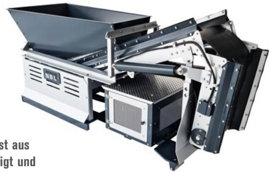
Im abgeklappten Zustand ist die Anlage transportfähig
