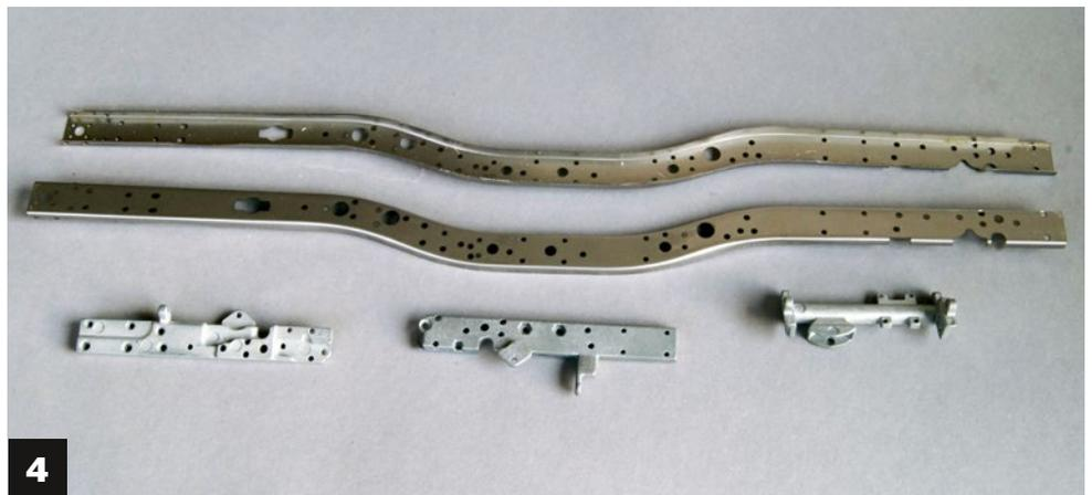
3) In der soliden Transportkiste aus Sperrholz findet erst der Bausatz und später das fertige Modell seinen Platz. 4) Der Rahmen wird aus diesen detaillierten Teilen aus Edelstahl und Guss entstehen
