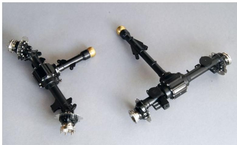
Die beiden Portalachsen mit den Schubrohren sind bereits fertig montiert und zeugen von einer hohen Fertigungsqualität
