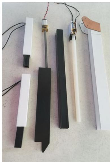
Spindelantriebe für Ausschub und Stützen
