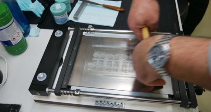
Die Platinen werden mit Zinnpaste beschichtet
