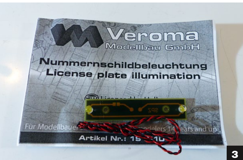
3) Fertig verdrahtete Nummernschildbeleuchtung von Veroma Modellbau. 4) Der Nummernschildhalter gehört zum Baukasten
