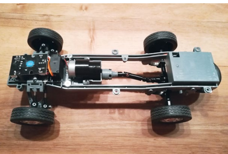
Das Fahrgestell vor der Radstandsverlängerung
