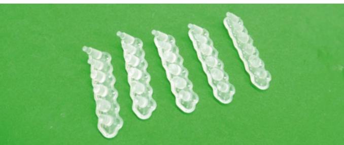
Am 3D-Drucker entstehen Kleinteile wie Leuchten für Lkw
