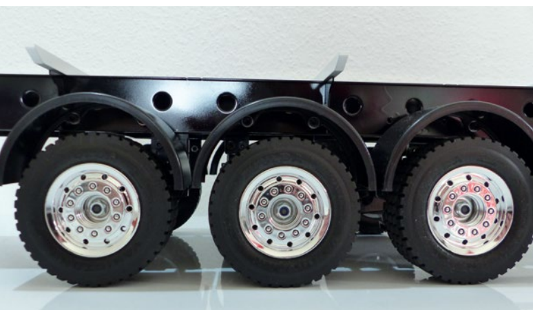
Auf diesem Bild sehr gut zu erkennen ist, dass die um 8 mm höher gelegte Variante verbaut wurde
