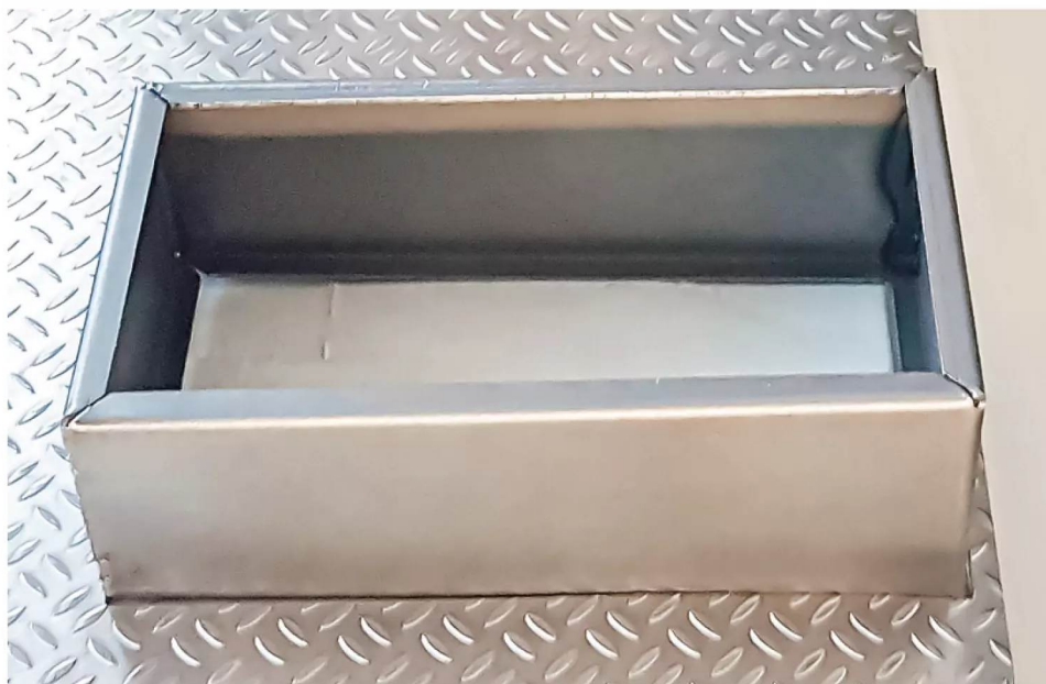
Dachkiste fertig gekantet und verschweißt. Noch ohne M2-Löcher für die Planen-Befestigung
