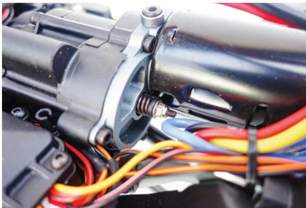
Das ist der Gewindestummel, über den die Federvorspannung auf die Rutschkupplung wirkt. Wenn alles funktioniert, nicht berühren!
