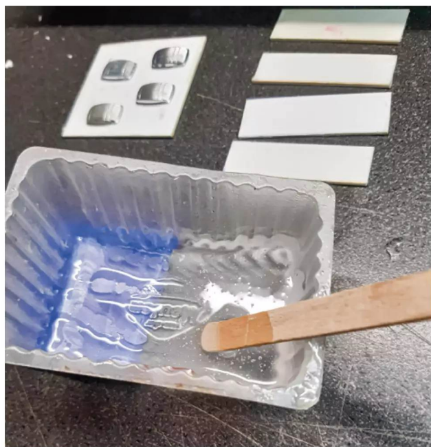
Vermischt werden Harz und Härter in einem Einwegbehälter
