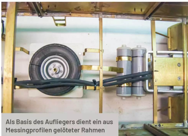
Durch die Verbindung von Kupferdraht, Messingprofil und Messingblechen entstand eine vorbildgetreue Oberfläche des Trailers
