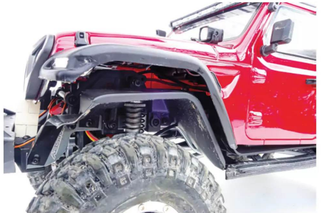
Die Idee mit den doppelten Radläufen ist gut. Die genaue Anpassung ließ allerdings zu wünschen übrig
