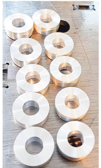
Alurohlinge für die Storz-Kupplung-Fertigung mit der ersten Bohrung
