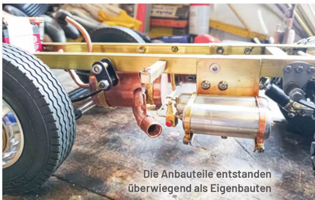
Montage der Hinterachse an dem aus Messing-U-Profil gelöteten Rahmen
