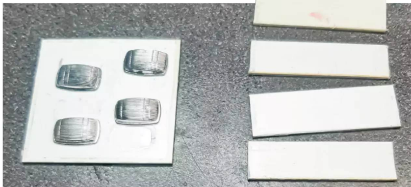
Aus Kunststoffplatten wird eine Form erstellt und auf die Bodenplatte die abzugeießenden Originale aufgeklebt
