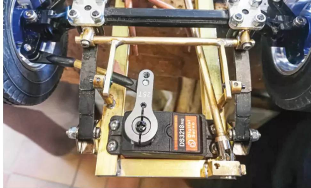
Vorderachse und Konstruktion mit 20-kg-Lenkservo
