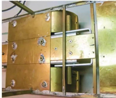
Die Messingmuttern zur Befestigung des Aufbaus auf dem Rahmen wurden aufgelötet
