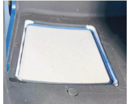
Das Einkleben der Scheiben erfolgte mit Holzleim
