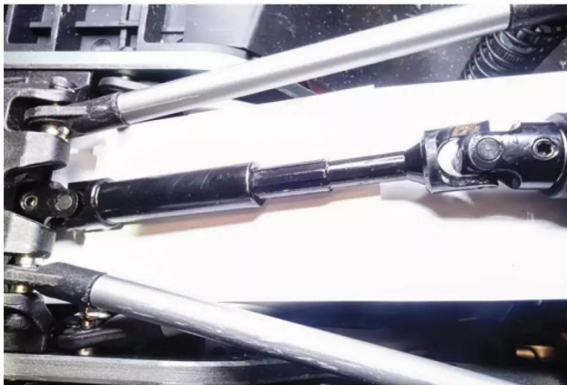
Gebeugte Kardanwellen mit zwei Gelenken müssen immer parallel zueinander stehen. Das heißt, beide Madenschrauben zeigen nach oben. Ansonsten droht ein unrunder Lauf
