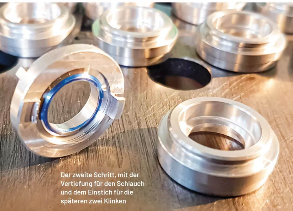
Hülsenfertigung für das spätere Spannen im Teilapparat. Mit dem Bund, sodass sie in der Spannbacke ihre Position halten
