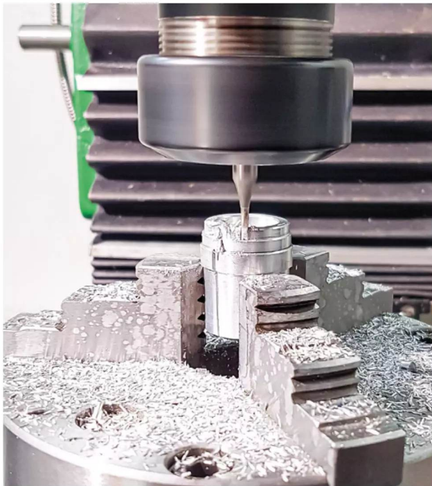
Hier werden die vier Nocken gefräst
