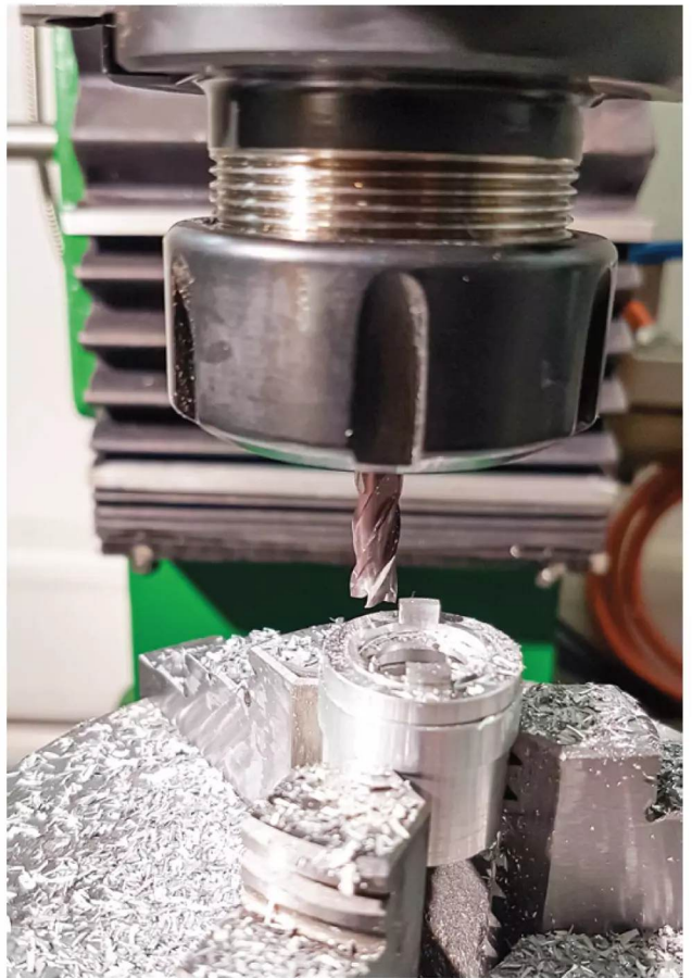
Die letzte Spannung um die Haltenocken zu fräsen
