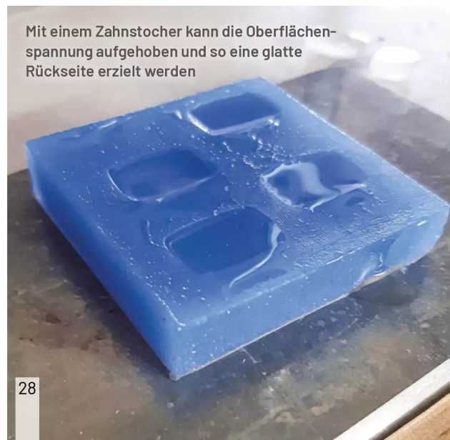
Beim ersten Abguss ergab sich durch die Oberflächenspannung des Materials eine unerwünschte konvexe Rückseite
