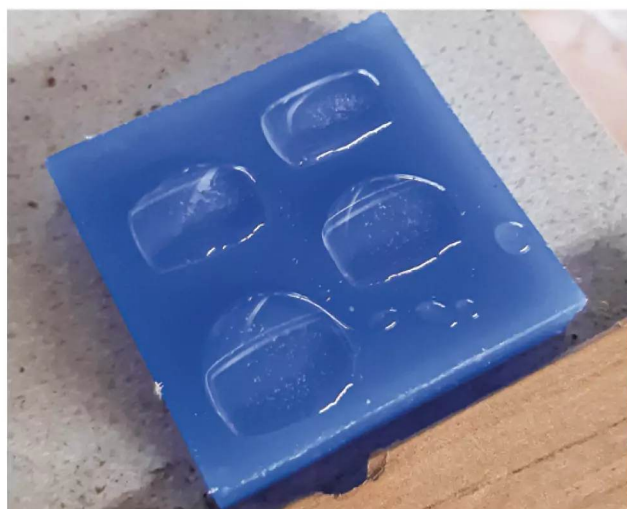
Beim ersten Abguss ergab sich durch die Oberflächenspannung des Materials eine unerwünschte konvexe Rückseite
