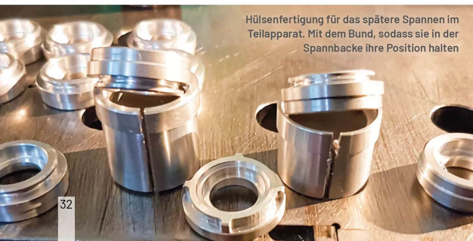
Der zweite Schritt, mit der Vertiefung für den Schlauch und dem Einstich für die späteren zwei Klinken
